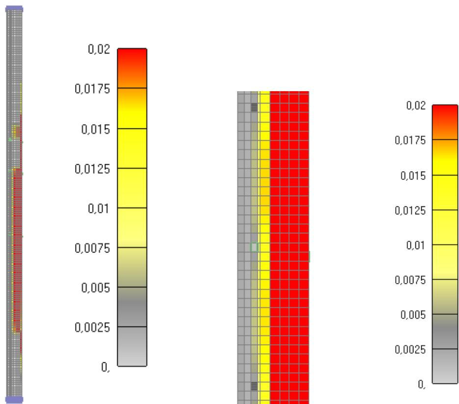
Slika 6.89: Prikaz pukotina za jednu četvrtinu stupa nakon 60 minuta
