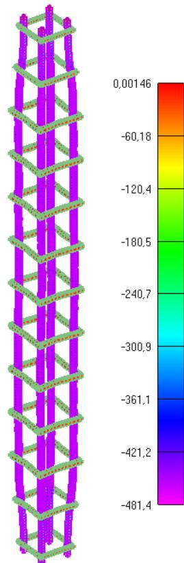
Slika 6.74: Prikaz naprezanja glavne uzdužne armature za djelovanje požara od 60min
