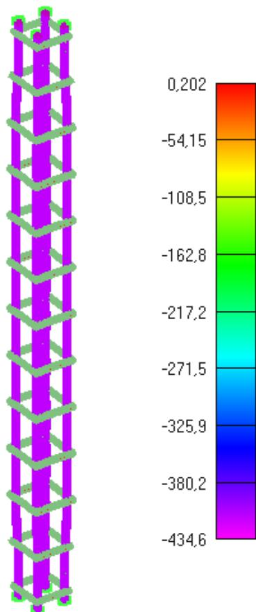
Slika 6.209: Prikaz naprezanja glavne uzdužne armature za djelovanje požara od 60min
