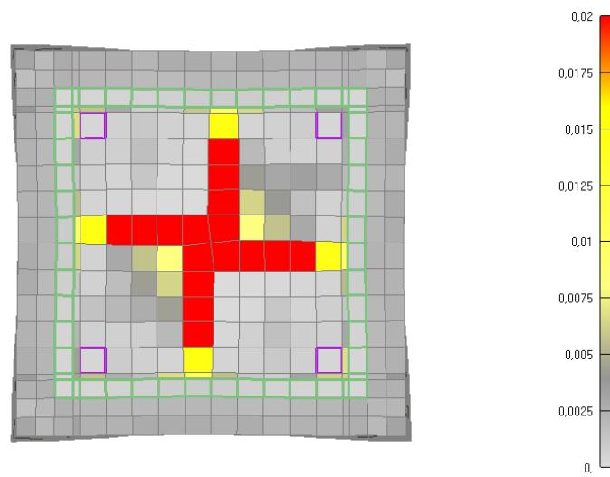
Slika 6.12: Prikaz pukotina za poprečni presjek stupa nakon 60 minuta požara
