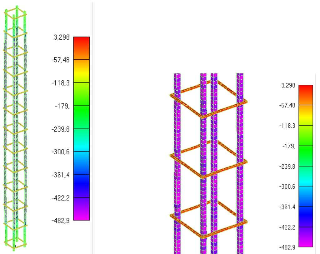
Slika 6.36: Prikaz naprezanja glavne uzdužne armature i spona za djelovanje požara od 60min
