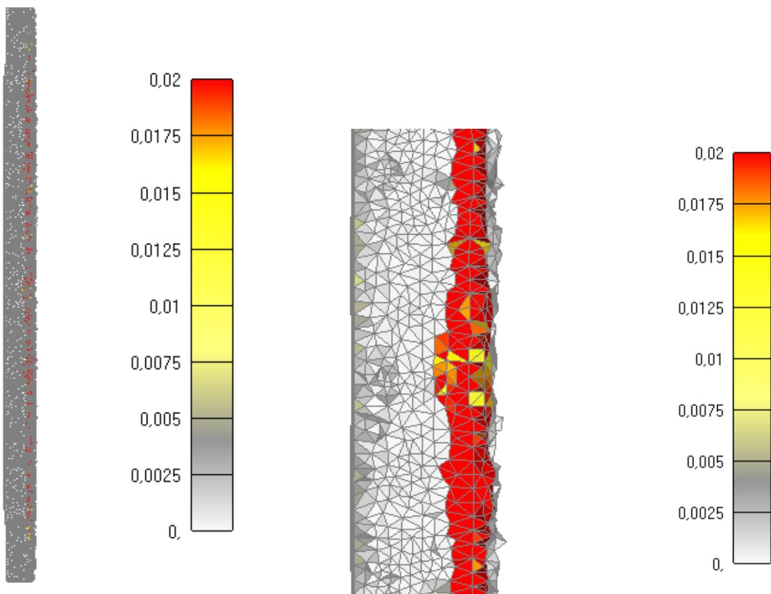
Slika 6.57: Prikaz pukotina za jednu četvrtinu stupa nakon 90 minuta
