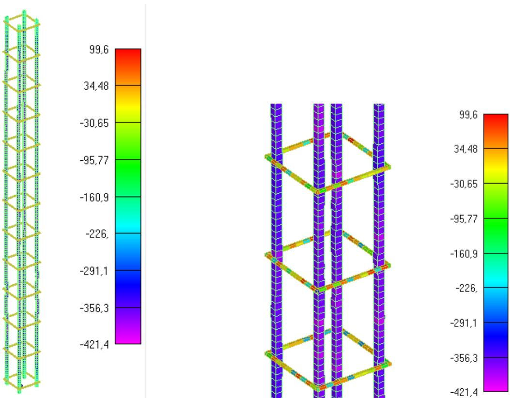
Slika 6.40:Prikaz naprezanja glavne uzdužne armature i spona za djelovanje požara od 370min
