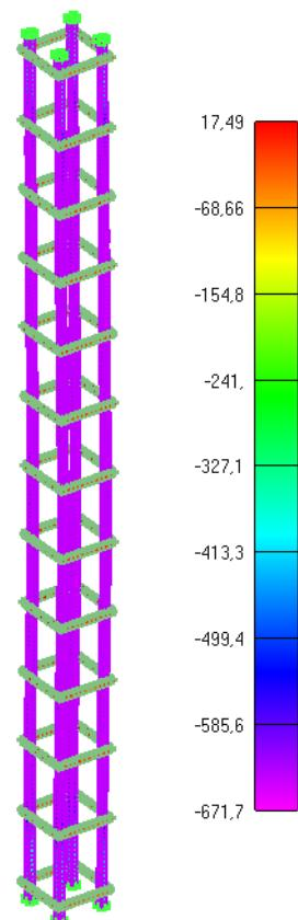
Slika 6.105:Prikaz naprezanja glavne uzdužne armature za djelovanje požara od 1615min
