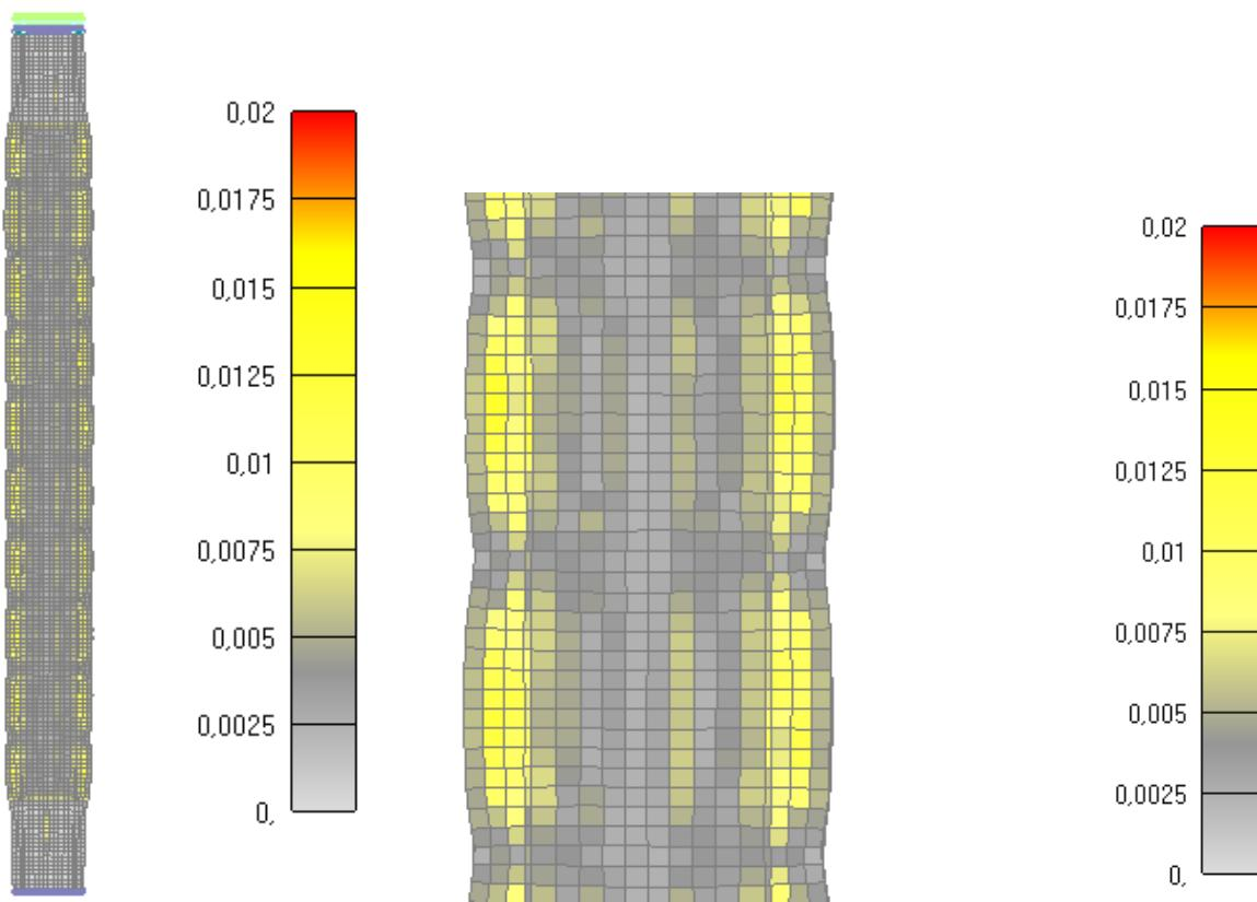
Slika 6.186: Prikaz pukotina za cijeli stup nakon 90 minuta
