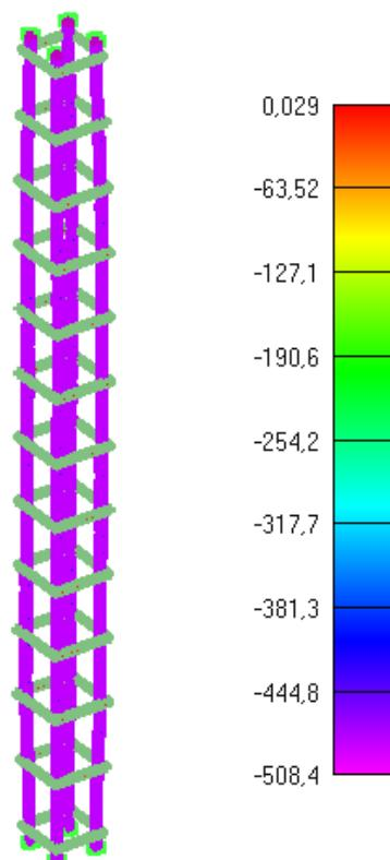
Slika 6.163: Prikaz naprezanja glavne uzdužne armature za djelovanje požara od 180min
