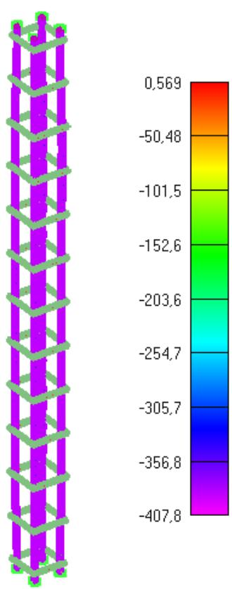
Slika 6.131: Prikaz naprezanja glavne uzdužne armature za djelovanje požara od 90min
