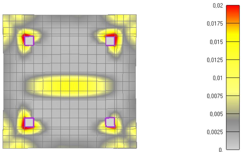
Slika 6.252: Prikaz pukotina za poprečni presjek stupa nakon 90 minuta
