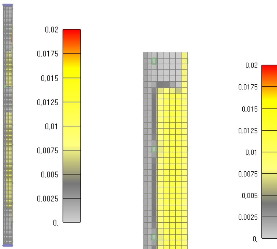
Slika 6.254: Prikaz pukotina za jednu četvrtinu stupa nakon 30 minuta
