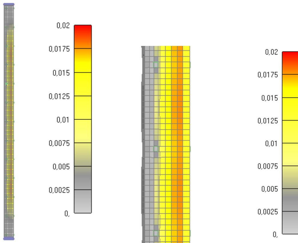
Slika 6.228: Prikaz pukotina za jednu četvrtinu stupa nakon 30 minuta
