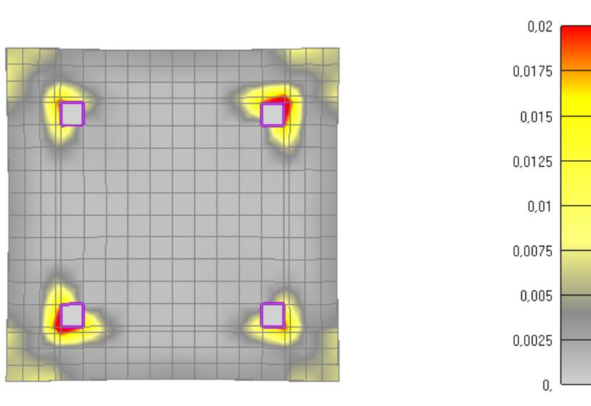
Slika 6.251: Prikaz pukotina za poprečni presjek stupa nakon 60 minuta požara
