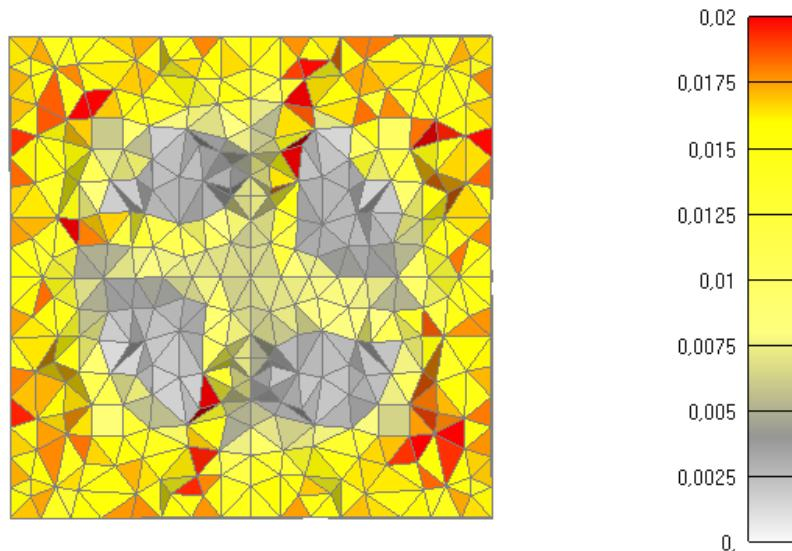
Slika 6.54: Prikaz pukotina za poprečni presjek stupa nakon 1810 minuta
