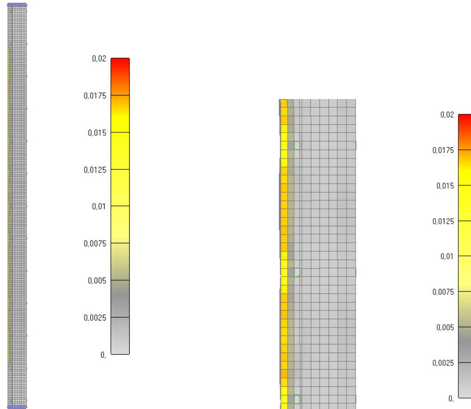
Slika 6.24: Prikaz pukotina za jednu četvrtinu stupa nakon 1615 minuta
