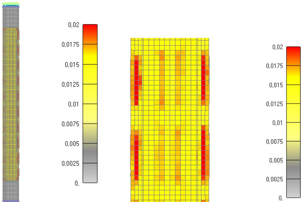
Slika 6.99: Prikaz pukotina za cijeli stup nakon 1615 minuta
