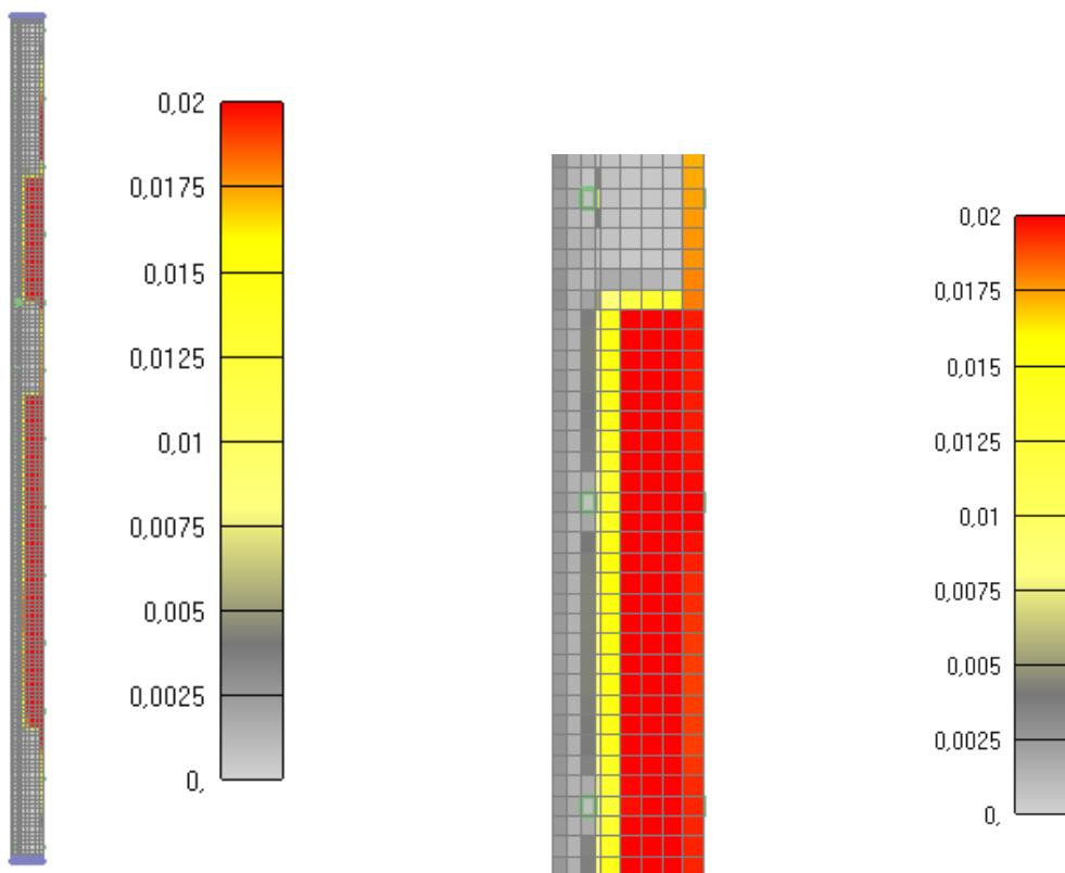
Slika 6.256: Prikaz pukotina za jednu četvrtinu stupa nakon 90 minuta
