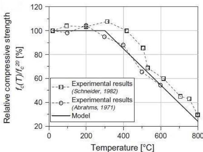
Slika 2.1. Prikaz tlačne čvrstoće u ovisnosti o temperaturi
