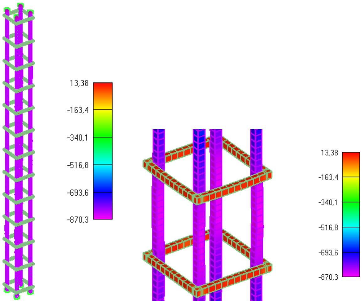
Slika 6.136: Prikaz naprezanja glavne uzdužne armature i spona u trenutku popuštanja stupa
