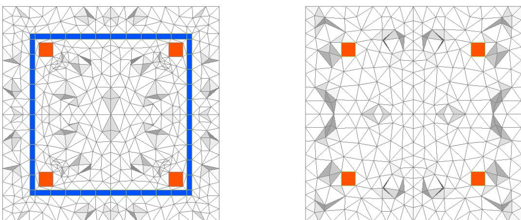
Slika 3.3: Prikaz poprečnog presjeka osnovnog modela (sa sponama-lijevo) i (bez spone-desno)
