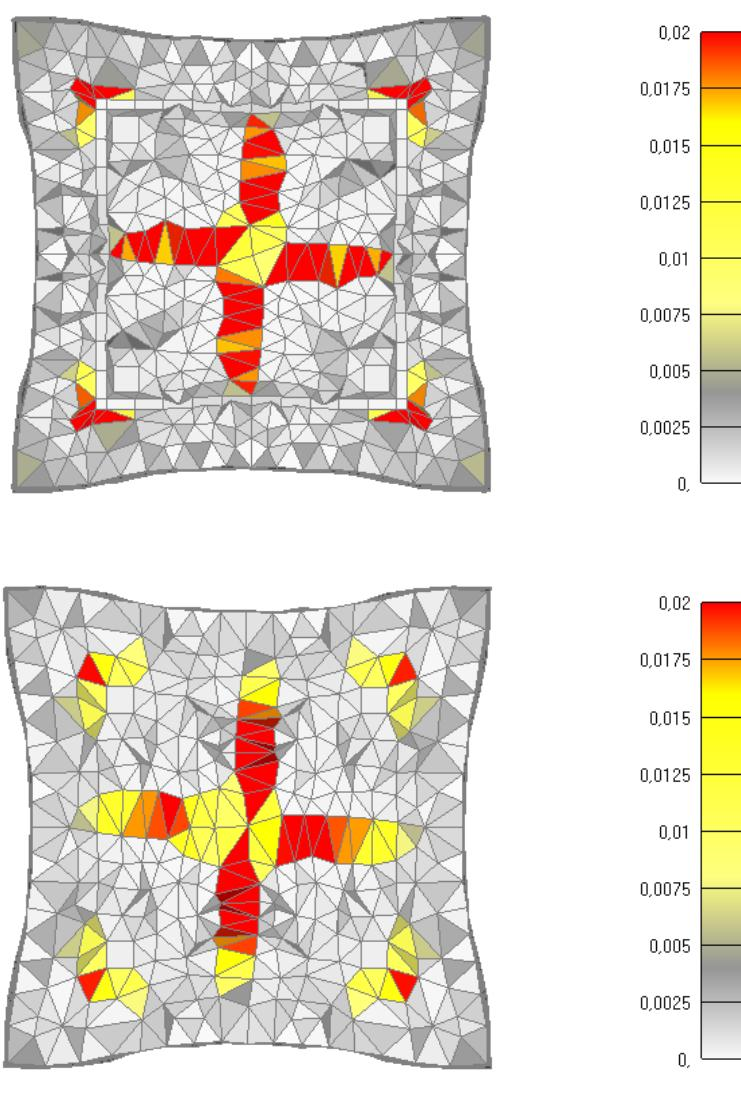
Slika 6.44: Prikaz pukotina za poprečni presjek stupa nakon 30 minuta požara
