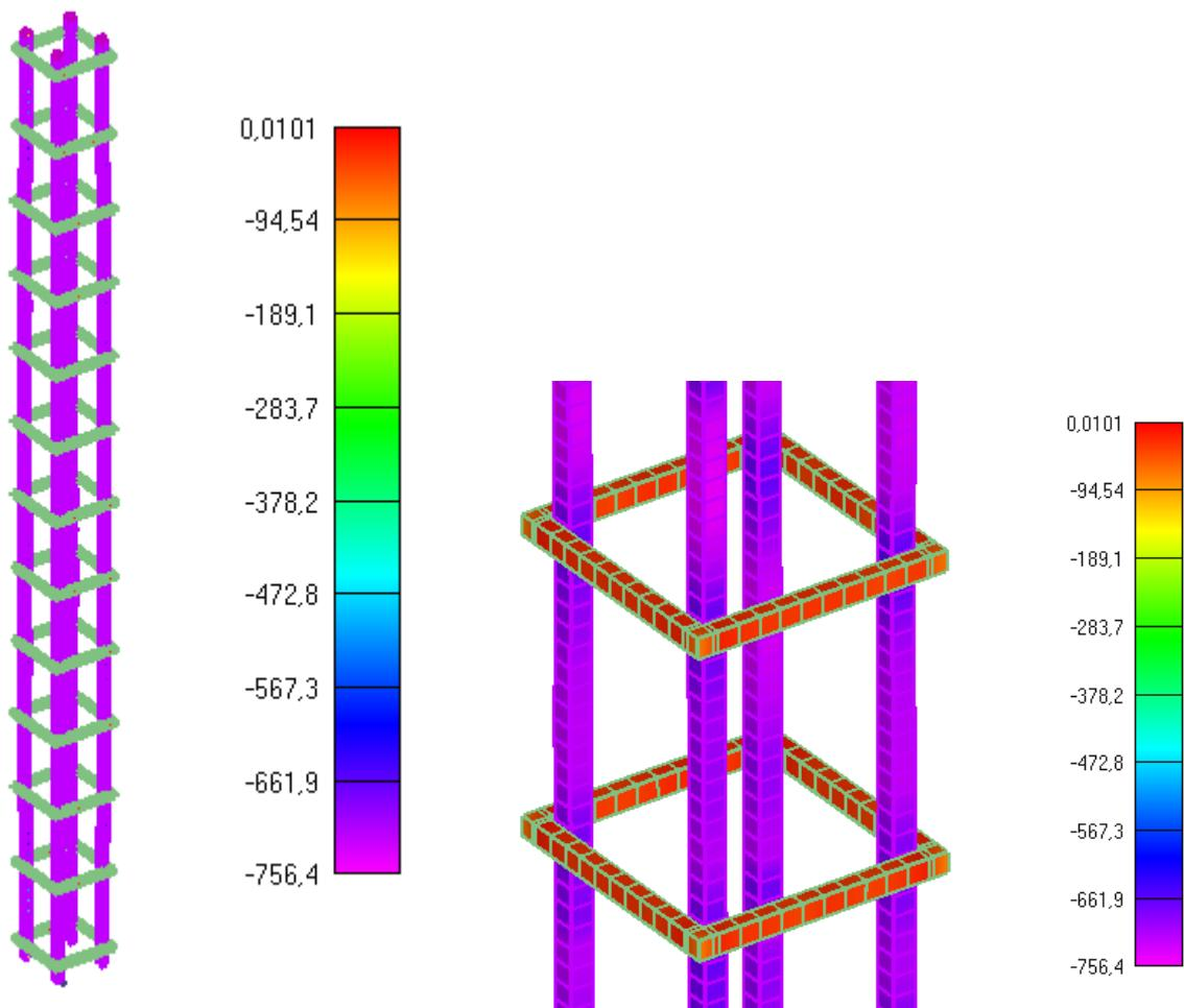
Slika 6.266: Prikaz naprezanja glavne uzdužne armature i spona u trenutku popuštanja stupa
