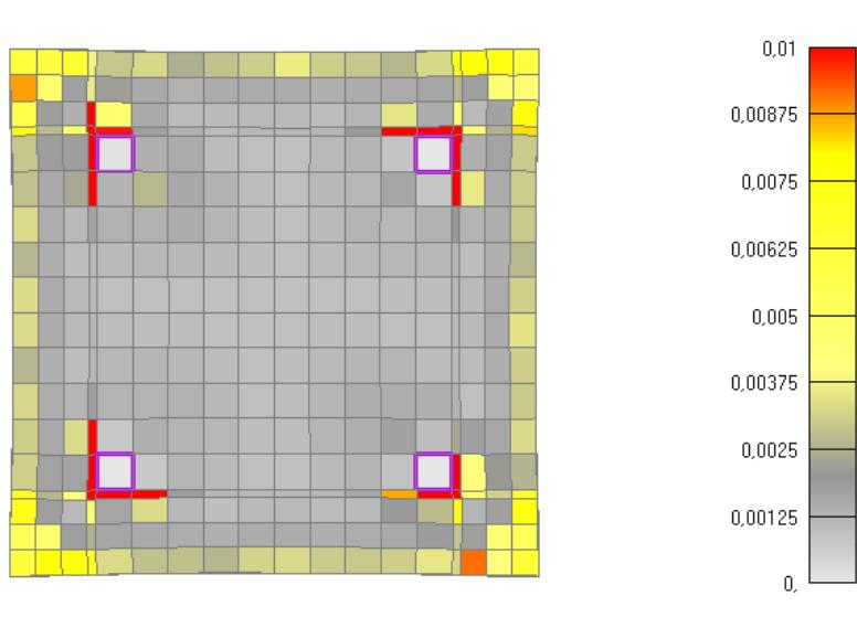
Slika 6.269: Prikaz pukotina za poprečni presjek stupa nakon 60 minuta požara
