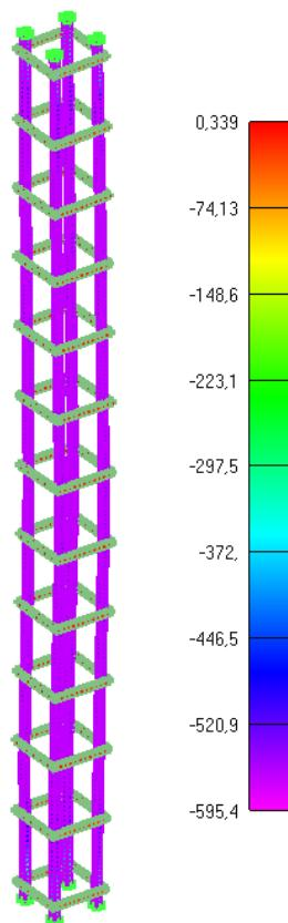
Slika 6.103:Prikaz naprezanja glavne uzdužne armature za djelovanje požara od 175min
