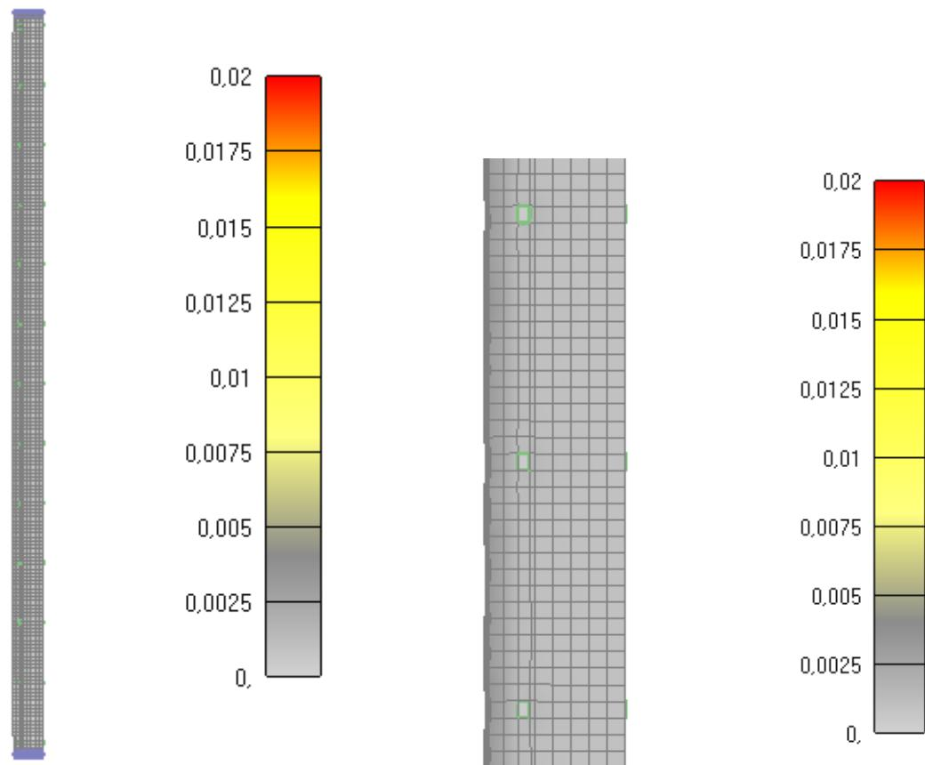
Slika 6.273: Prikaz pukotina za jednu četvrtinu stupa nakon 60 minuta
