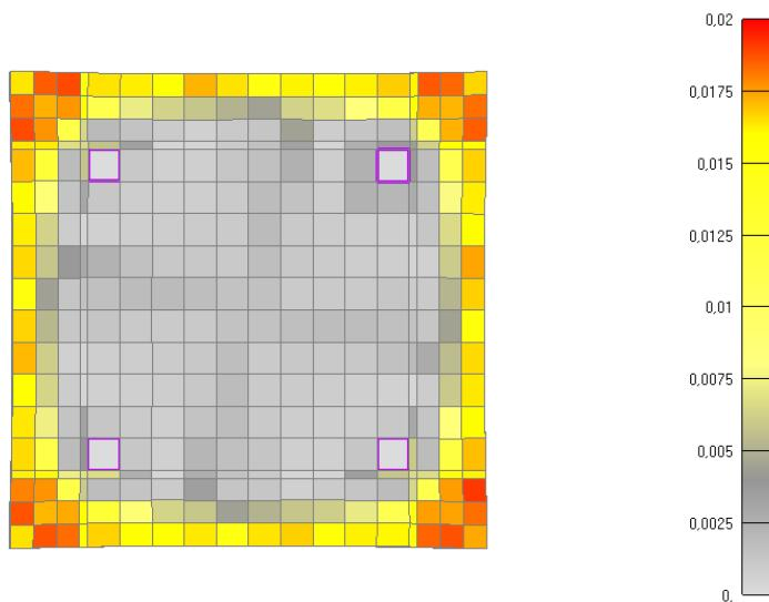
Slika 6.17: Prikaz pukotina za poprečni presjek stupa nakon 895 minuta
