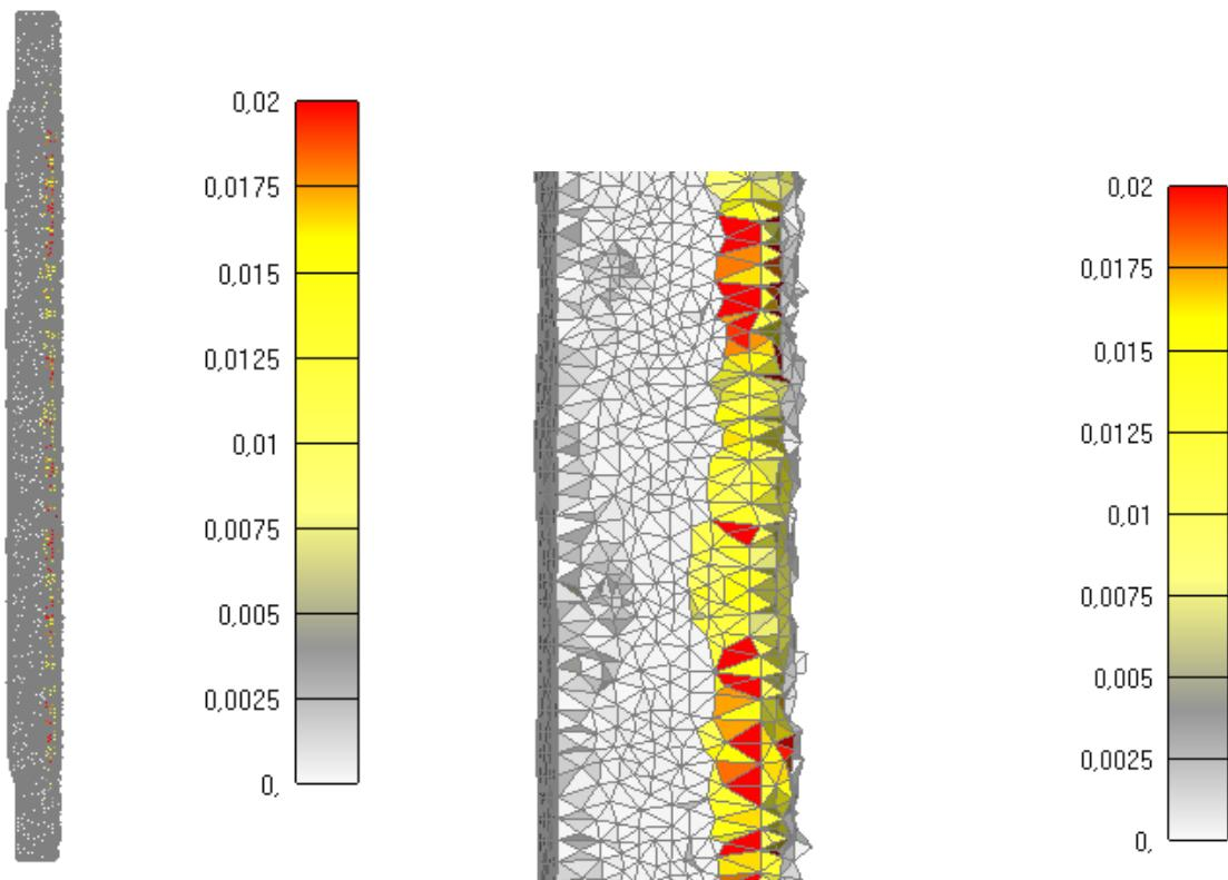
Slika 6.55: Prikaz pukotina za jednu četvrtinu stupa nakon 30 minuta
