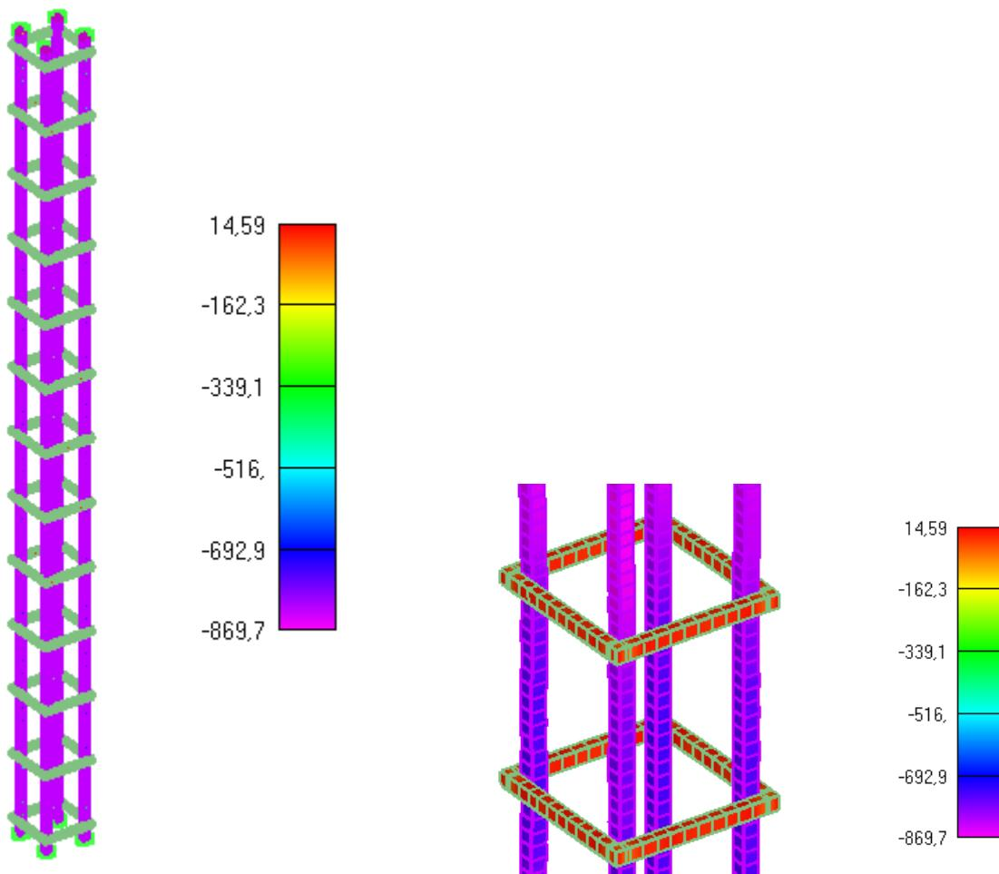
Slika 6.2.3.5.167: Prikaz naprezanja glavne uzdužne armature i spona u trenutku popuštanja stupa (lijevo-cijeli stup, desno-detajl stupa)
