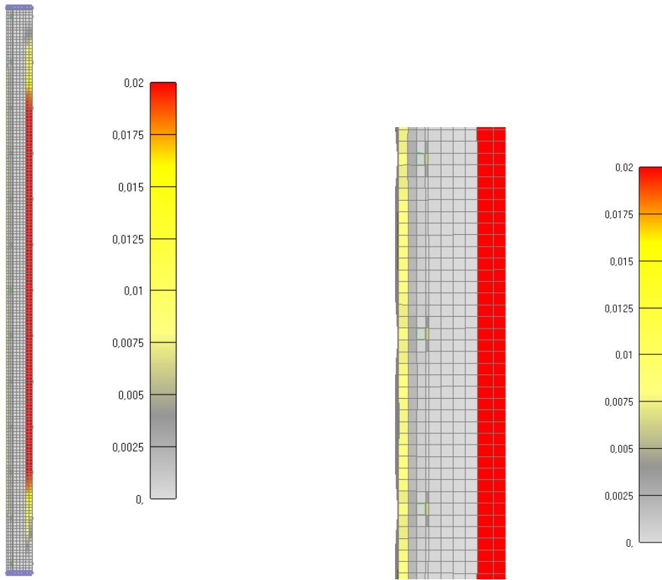
Slika 6.21: Prikaz pukotina za jednu četvrtinu stupa nakon 115 minuta
