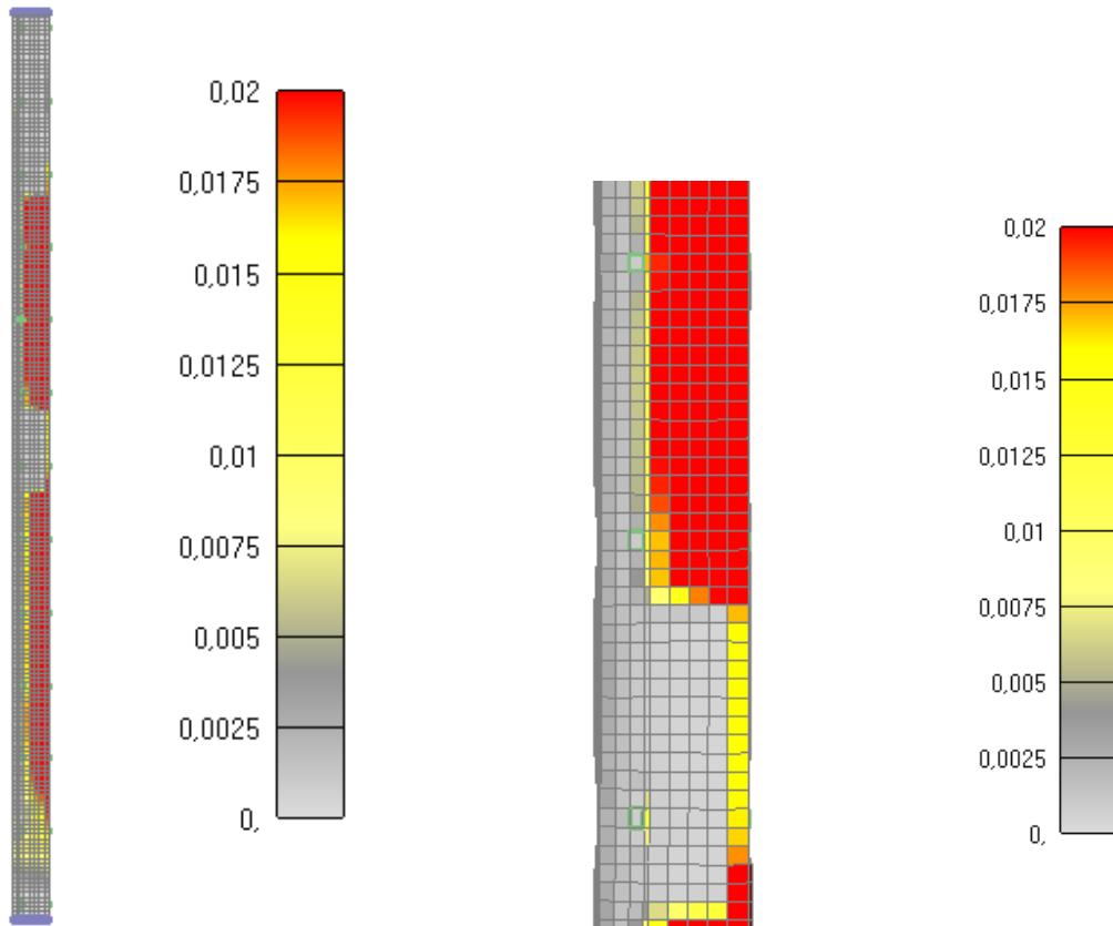
Slika 6.179: Prikaz pukotina za jednu četvrtinu stupa nakon 90 minuta
