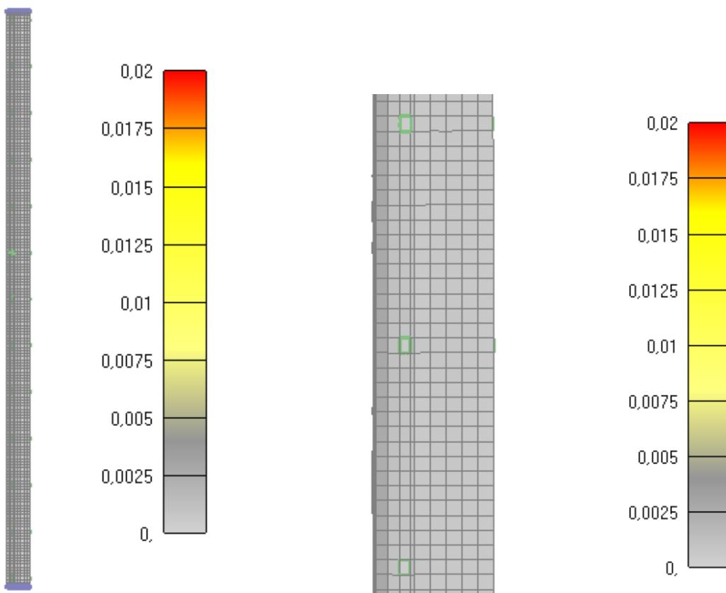
Slika 6.115: Prikaz pukotina za jednu četvrtinu stupa nakon 30 minuta
