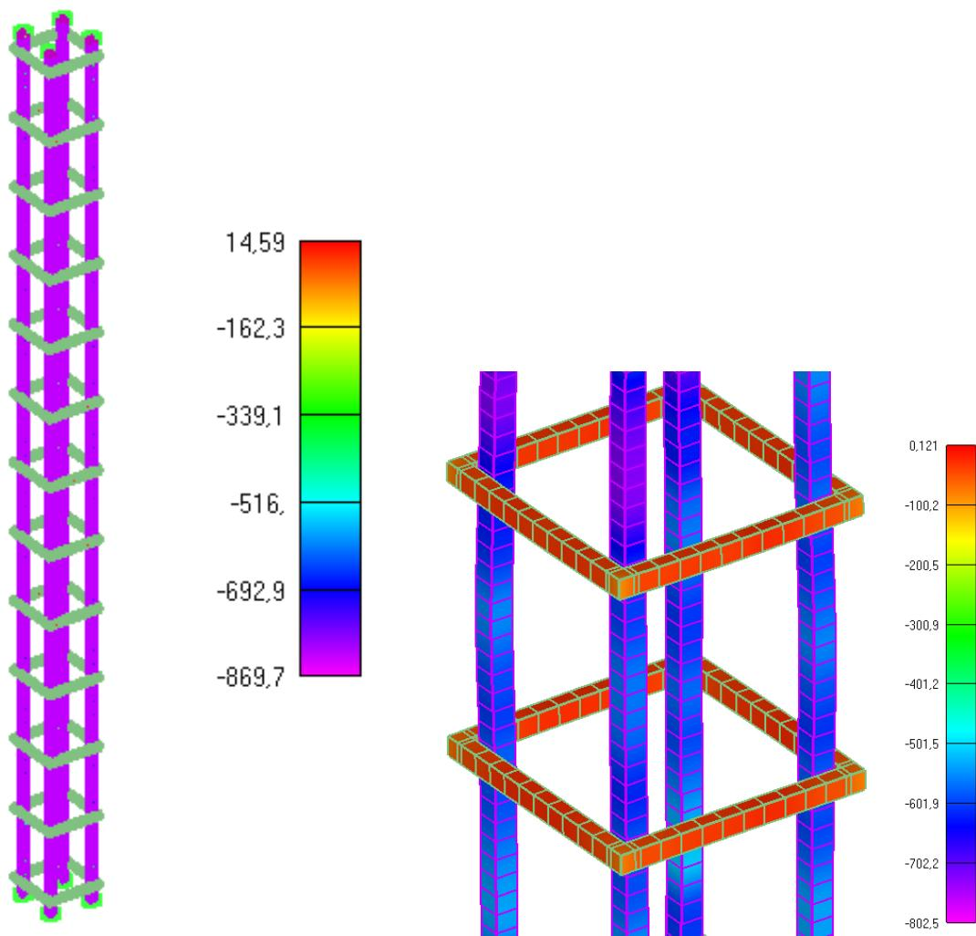
Slika 6.194: Prikaz naprezanja glavne uzdužne armature i spona u trenutku popuštanja stupa
