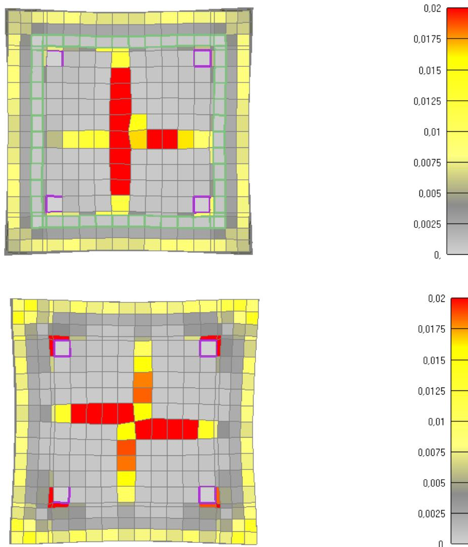
Slika 6.83: Prikaz pukotina za poprečni presjek stupa nakon 115 minuta požara
