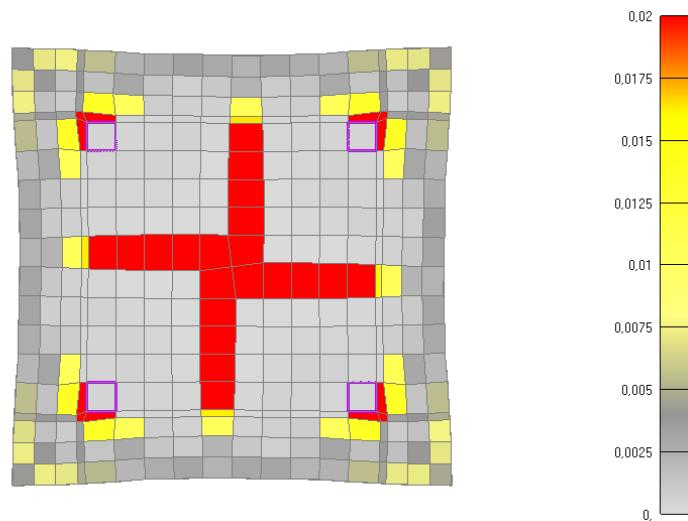
Slika 6.13: Prikaz pukotina za poprečni presjek stupa nakon 60 minuta požara
