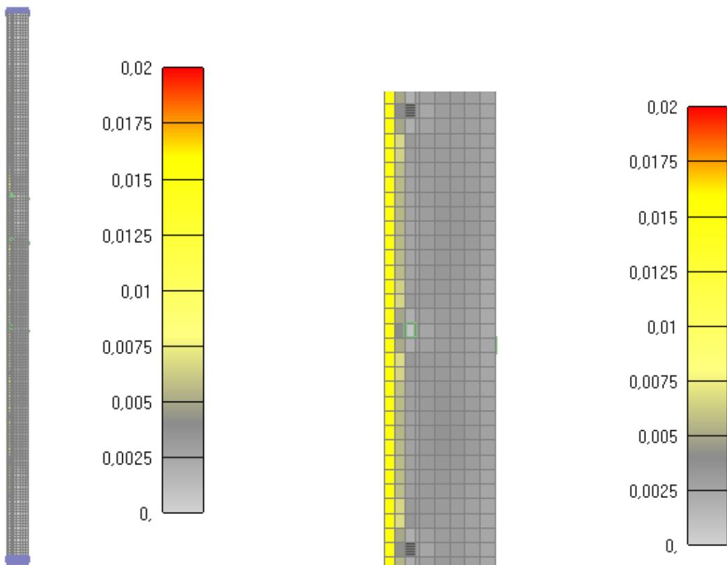
Slika 6.93: Prikaz pukotina za jednu četvrtinu stupa nakon 1615 minuta
