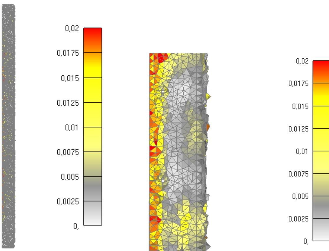
Slika 6.62: Prikaz pukotina za jednu četvrtinu stupa nakon 1810 minuta
