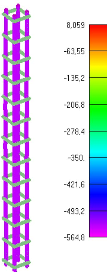
Slika 6.215: Prikaz naprezanja glavne uzdužne armature za djelovanje požara od 1810min
