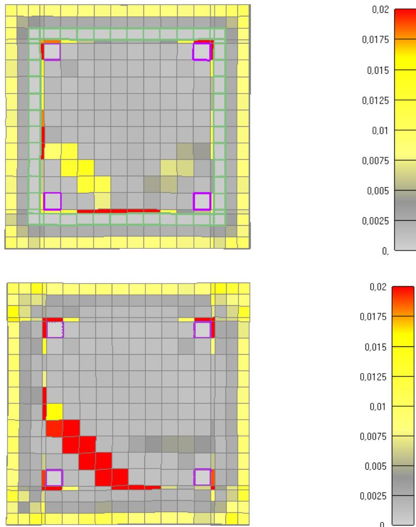
Slika 6.110: Prikaz pukotina za poprečni presjek stupa nakon 115 minuta požara
