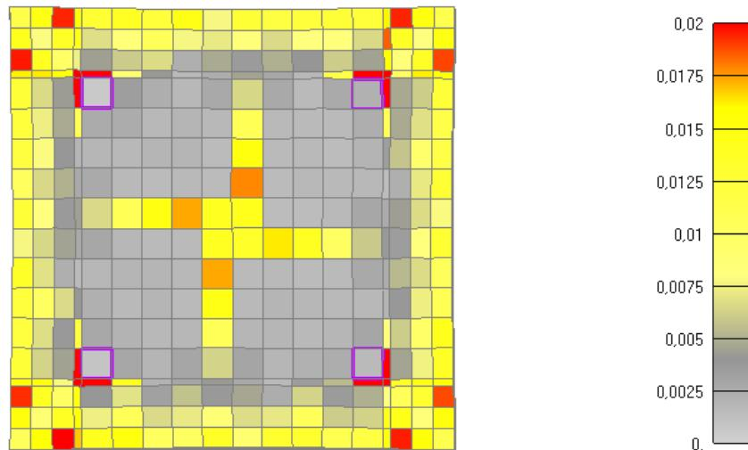
Slika 6.223: Prikaz pukotina za poprečni presjek stupa nakon 275 minuta požara
