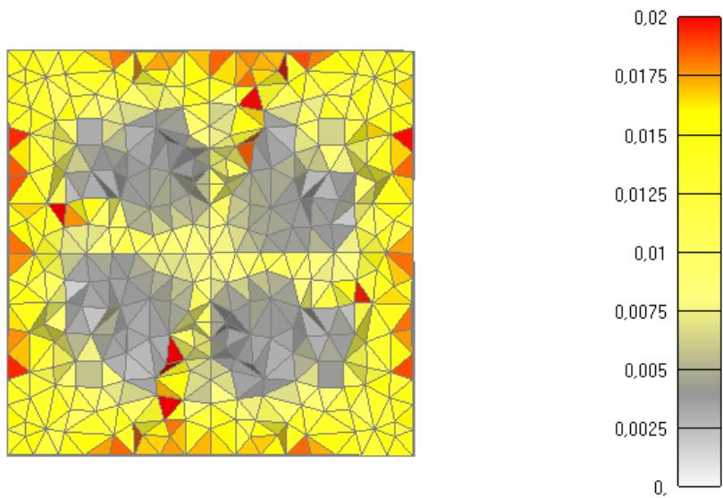
Slika 6.51: Prikaz pukotina za poprečni presjek stupa nakon 370 minuta
