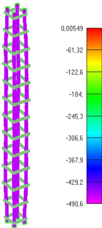
Slika 6.162: Prikaz naprezanja glavne uzdužne armature za djelovanje požara od 90min
