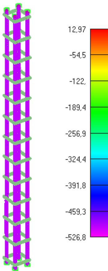
Slika 6.135:Prikaz naprezanja glavne uzdužne armature za djelovanje požara od 1690min
