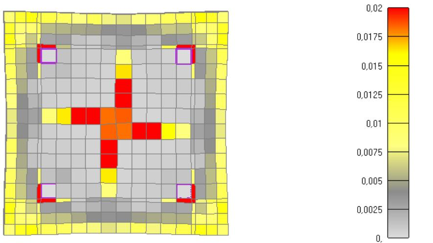
Slika 6.141: Prikaz pukotina za poprečni presjek stupa nakon 180 minuta požara
