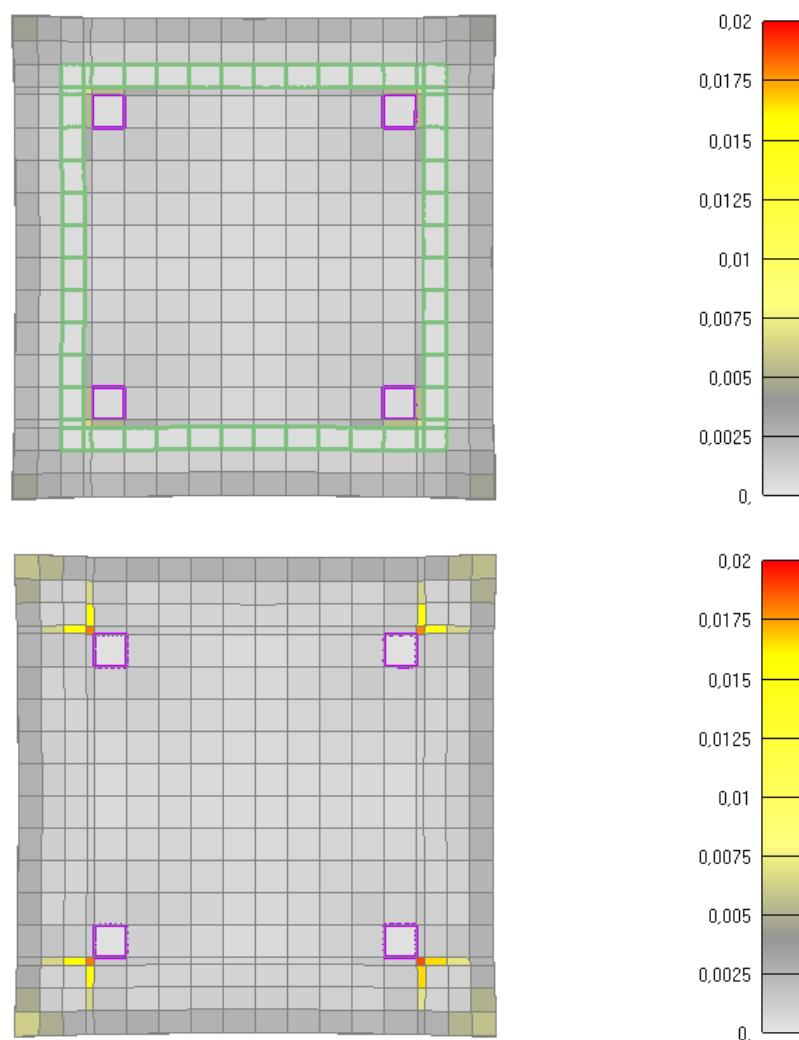
Slika 6.195: Prikaz pukotina za poprečni presjek stupa nakon 30 minuta požara
