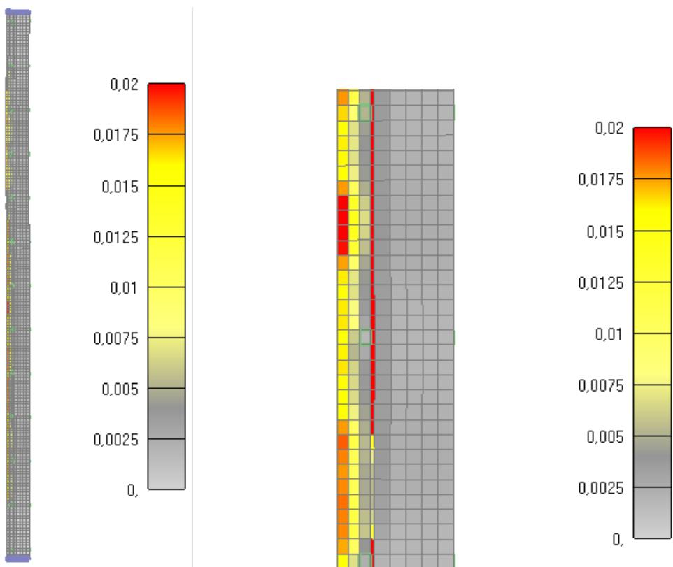
Slika 6.119: Prikaz pukotina za jednu četvrtinu stupa nakon 895 minuta
