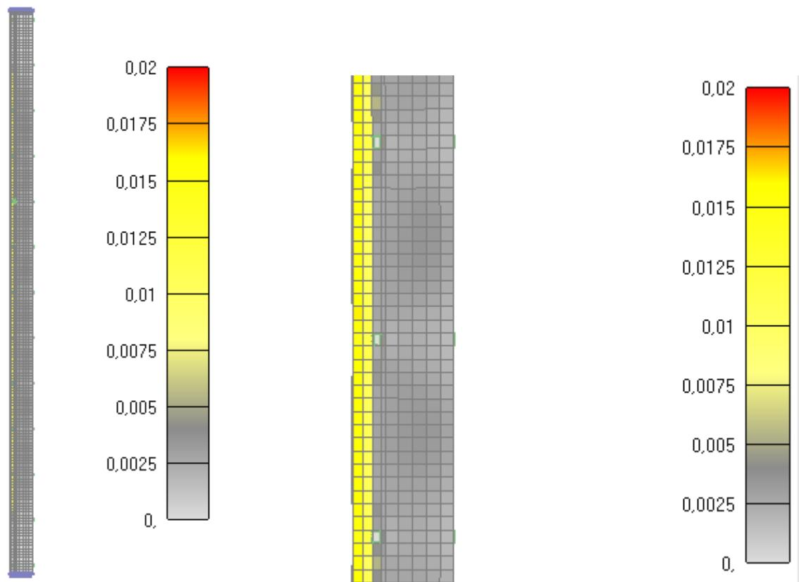
Slika 6.151: Prikaz pukotina za jednu četvrtinu stupa nakon 1030 minuta
