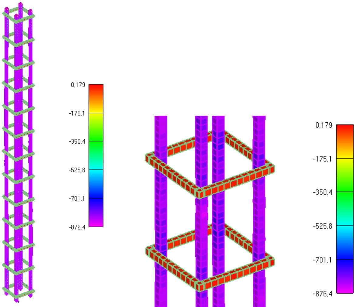
Slika 6.79: Prikaz naprezanja glavne uzdužne armature i spona u trenutku popuštanja stupa
