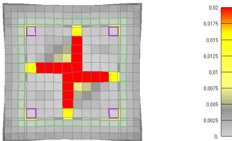
Slika 6.218: Prikaz pukotina za poprečni presjek stupa nakon 60 minuta požara
