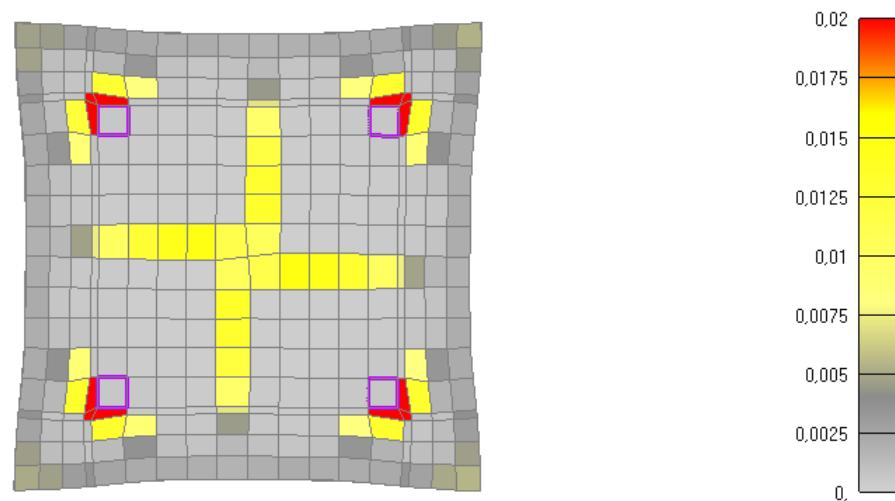
Slika 6.80: Prikaz pukotina za poprečni presjek stupa nakon 30 minuta požara
