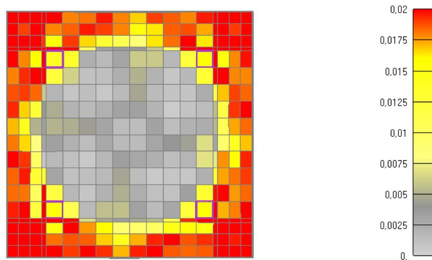
Slika 6.225: Prikaz pukotina za poprečni presjek stupa nakon 1090 minuta
