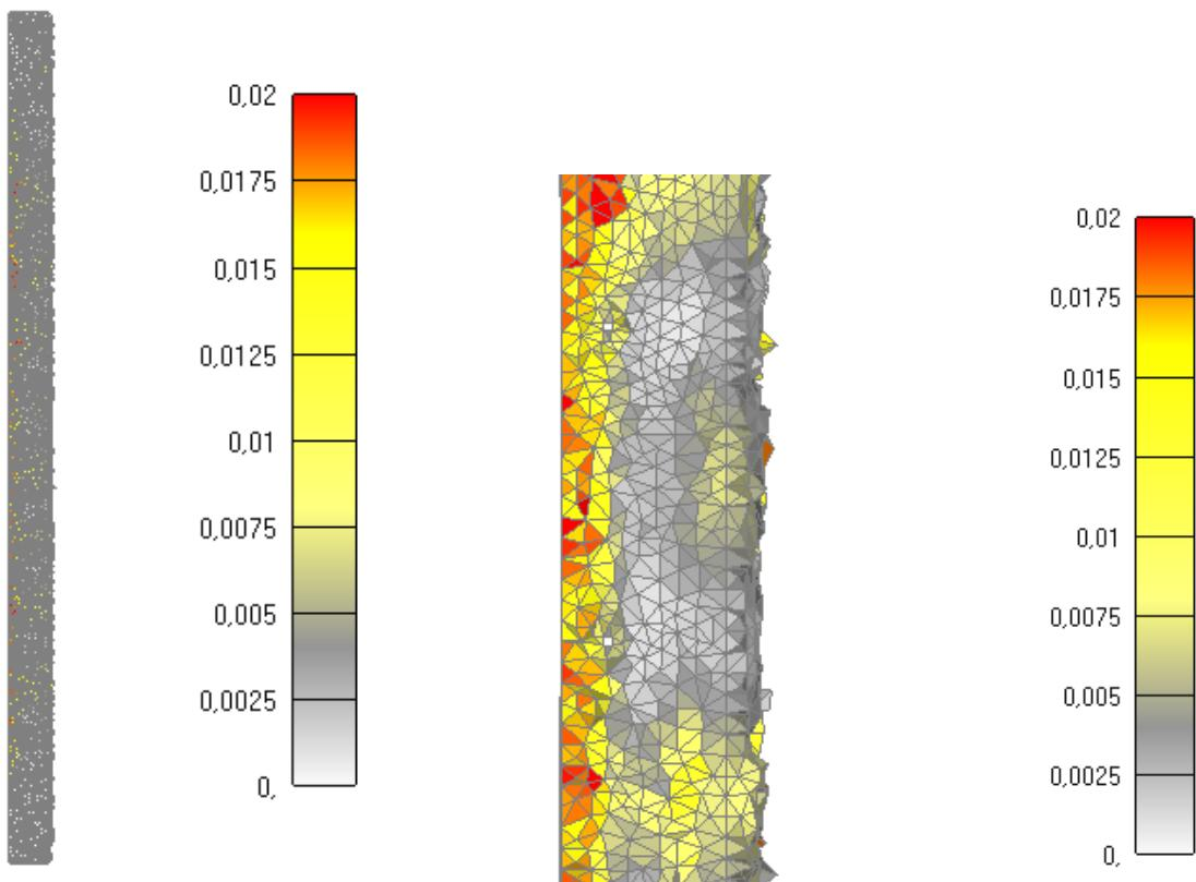
Slika 6.61: Prikaz pukotina za jednu četvrtinu stupa nakon 1090 minuta
