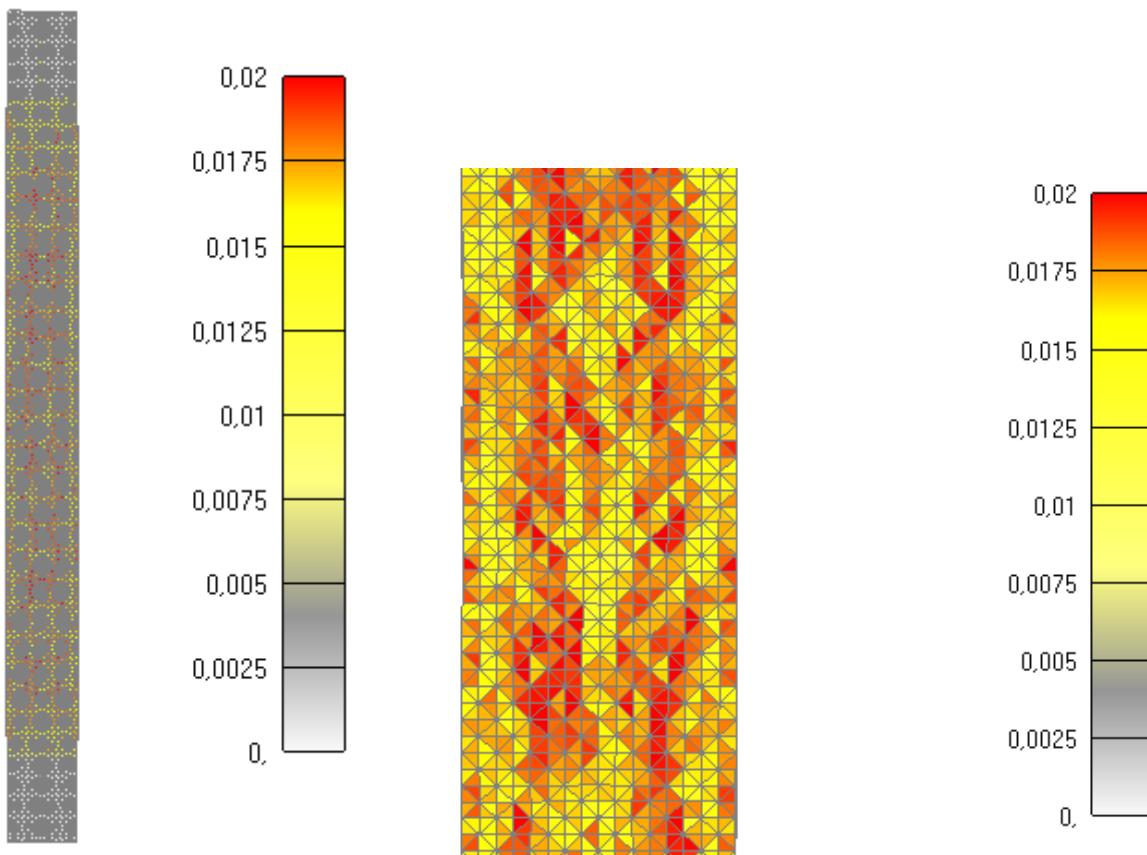
Slika 6.68: Prikaz pukotina za cijeli stup nakon 370 minuta
