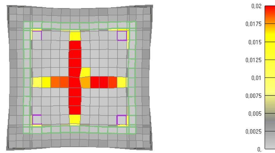
Slika 6.81: Prikaz pukotina za poprečni presjek stupa nakon 60 minuta požara
