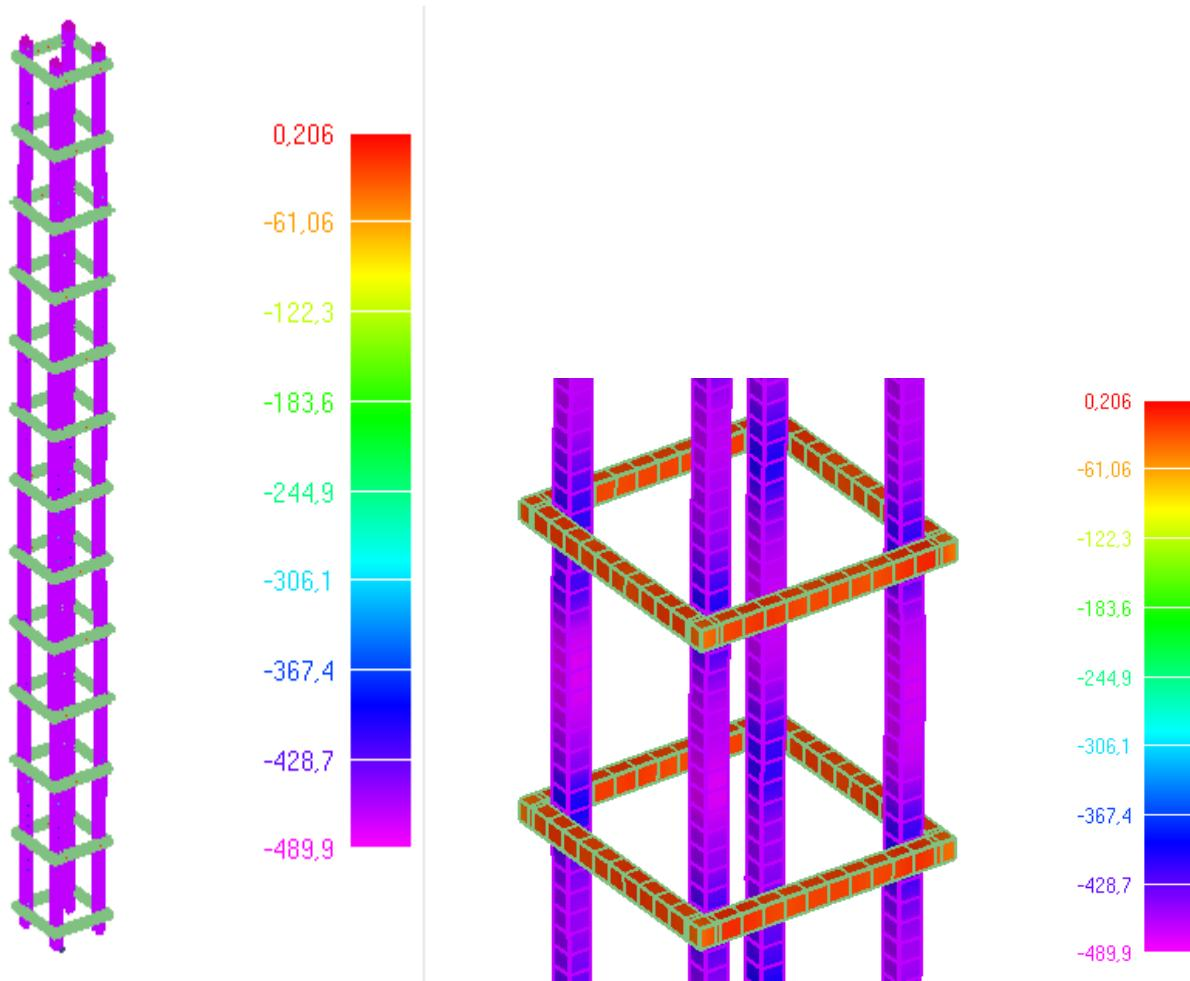
Slika 6.248: Prikaz naprezanja glavne uzdužne armature i spona u trenutku popuštanja stupa
