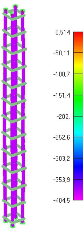
Slika 6.132: Prikaz naprezanja glavne uzdužne armature za djelovanje požara od 180min
