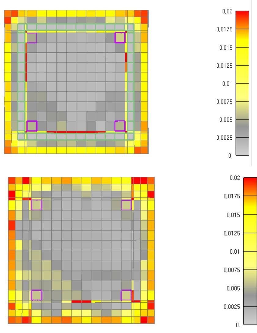
Slika 6.114: Prikaz pukotina za poprečni presjek stupa nakon 1615 minuta
