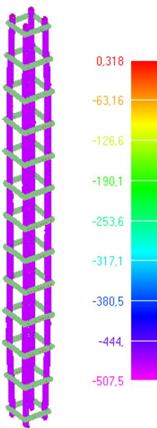
Slika 6.247: Prikaz naprezanja glavne uzdužne armature za djelovanje požara od 120min
