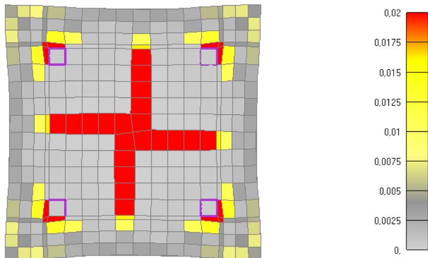
Slika 6.219: Prikaz pukotina za poprečni presjek stupa nakon 60 minuta požara
