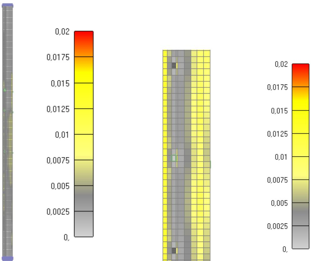
Slika 6.91: Prikaz pukotina za jednu četvrtinu stupa nakon 175 minuta
