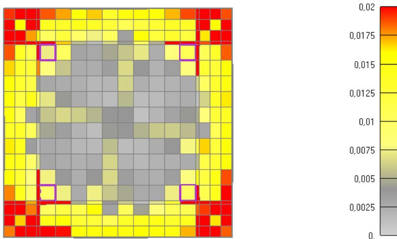
Slika 6.224: Prikaz pukotina za poprečni presjek stupa nakon 370 minuta
