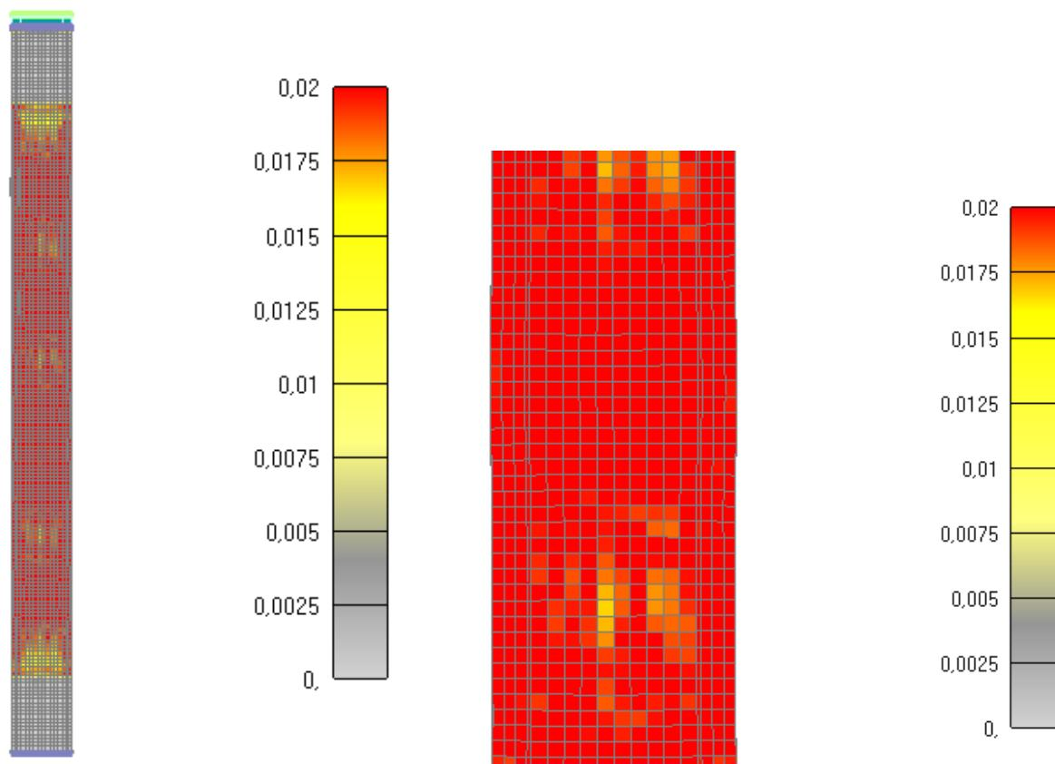
Slika 6.242: Prikaz pukotina za cijeli stup nakon 1090 minuta
