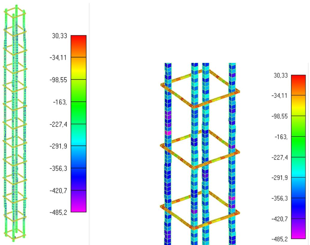
Slika 6.38:Prikaz naprezanja glavne uzdužne armature i spona za djelovanje požara od 120min
