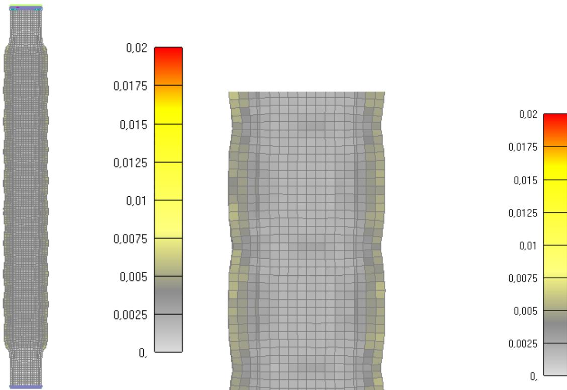
Slika 6.153: Prikaz pukotina za cijeli stup nakon 30 minuta
