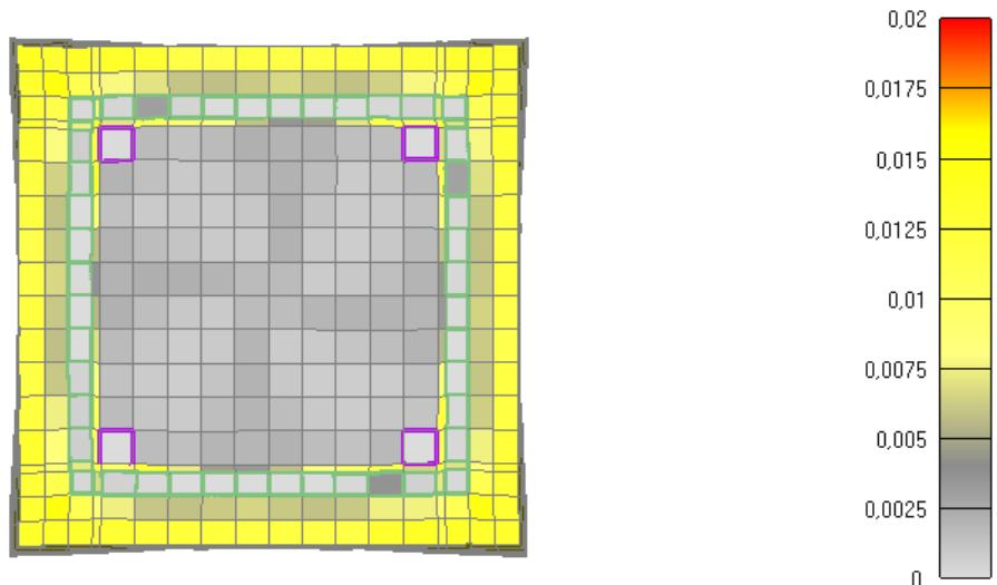
Slika 6.142: Prikaz pukotina za poprečni presjek stupa nakon 250 minuta požara
