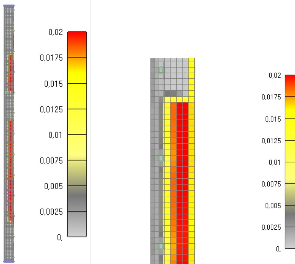
Slika 6.255: Prikaz pukotina za jednu četvrtinu stupa nakon 60 minuta
