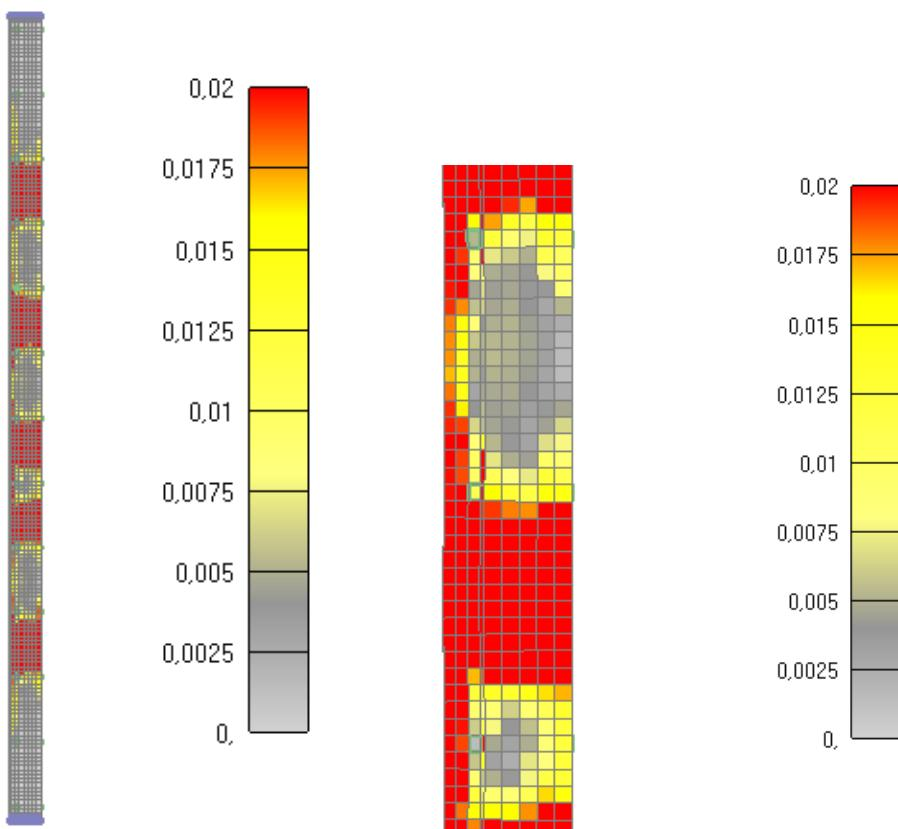
Slika 6.234: Prikaz pukotina za jednu četvrtinu stupa nakon 1090 minuta
