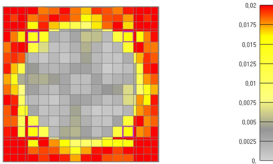
Slika 6.227: Prikaz pukotina za poprečni presjek stupa nakon 1810 minuta
