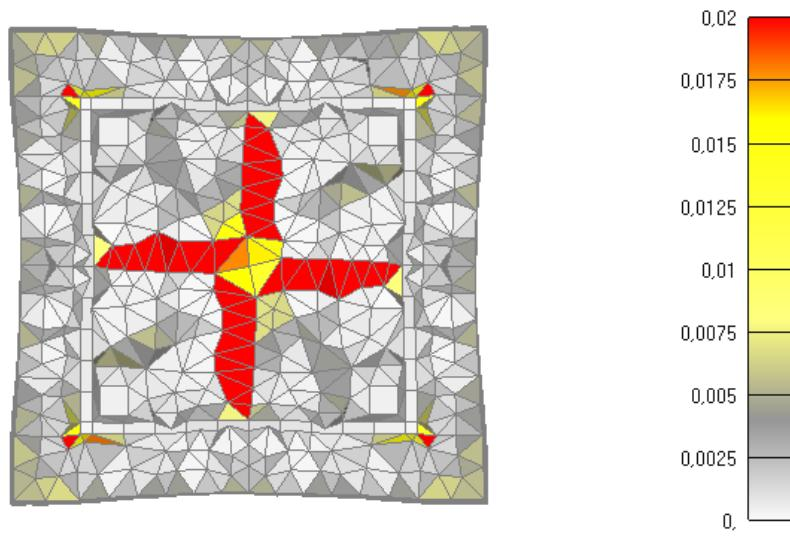
Slika 6.45: Prikaz pukotina za poprečni presjek stupa nakon 60 minuta požara
