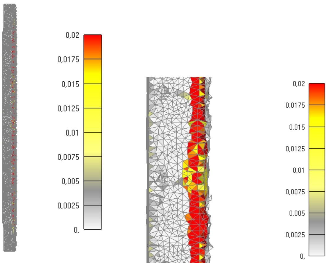
Slika 6.56: Prikaz pukotina za jednu četvrtinu stupa nakon 60 minuta
