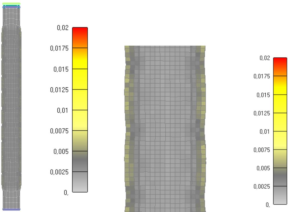
Slika 6.258: Prikaz pukotina za cijeli stup nakon 30 minuta
