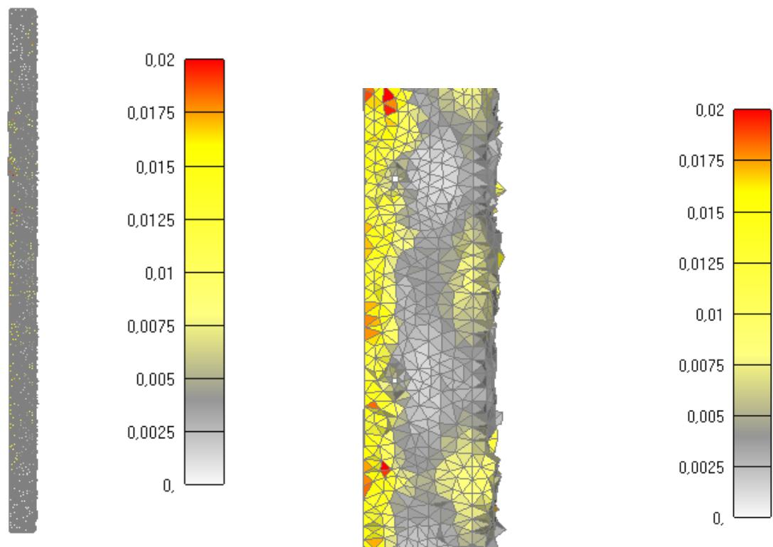
Slika 6.60: Prikaz pukotina za jednu četvrtinu stupa nakon 370 minuta
