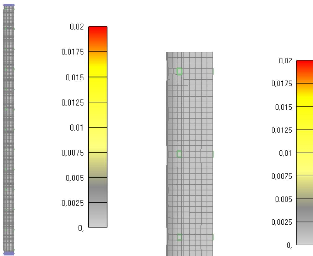
Slika 6.272: Prikaz pukotina za jednu četvrtinu stupa nakon 30 minuta
