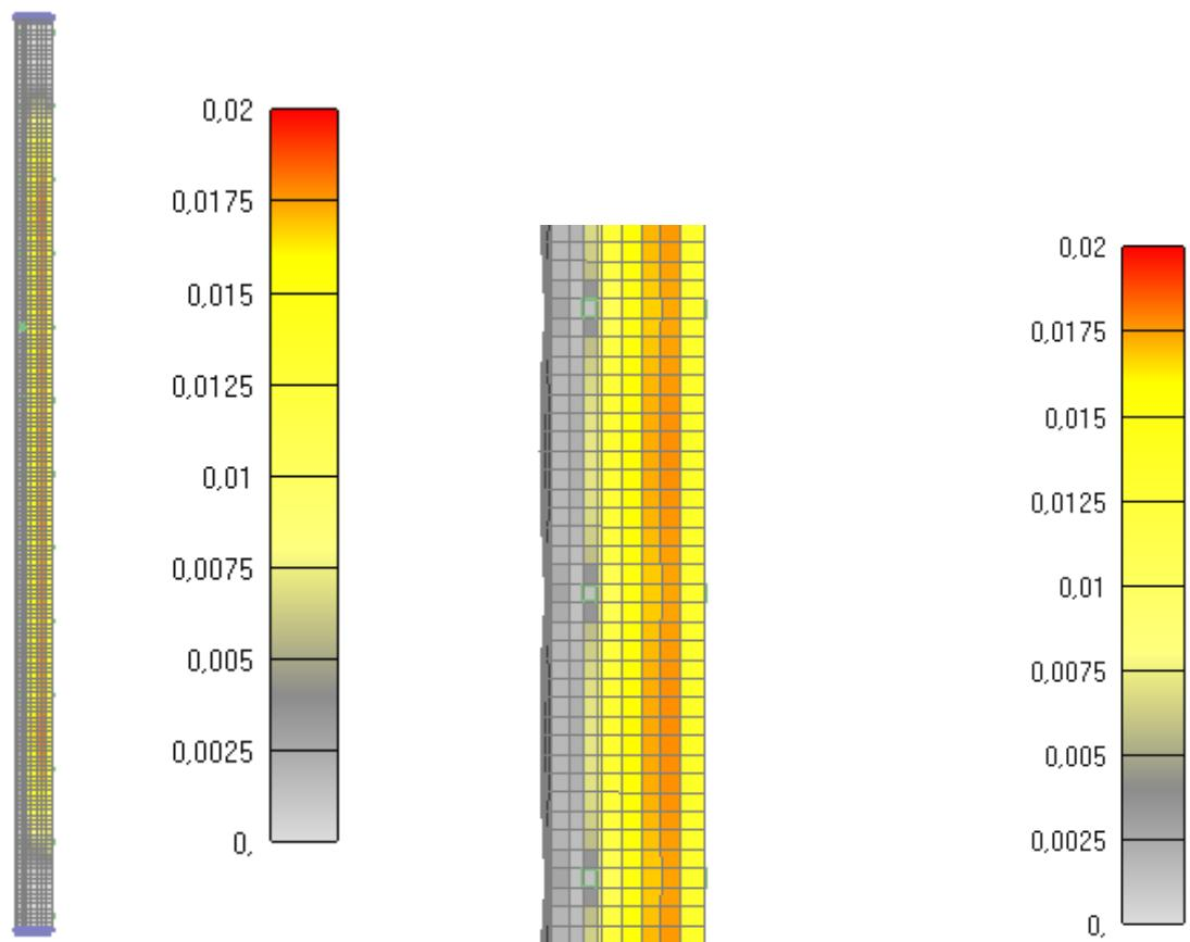
Slika 6.146: Prikaz pukotina za jednu četvrtinu stupa nakon 30 minuta
