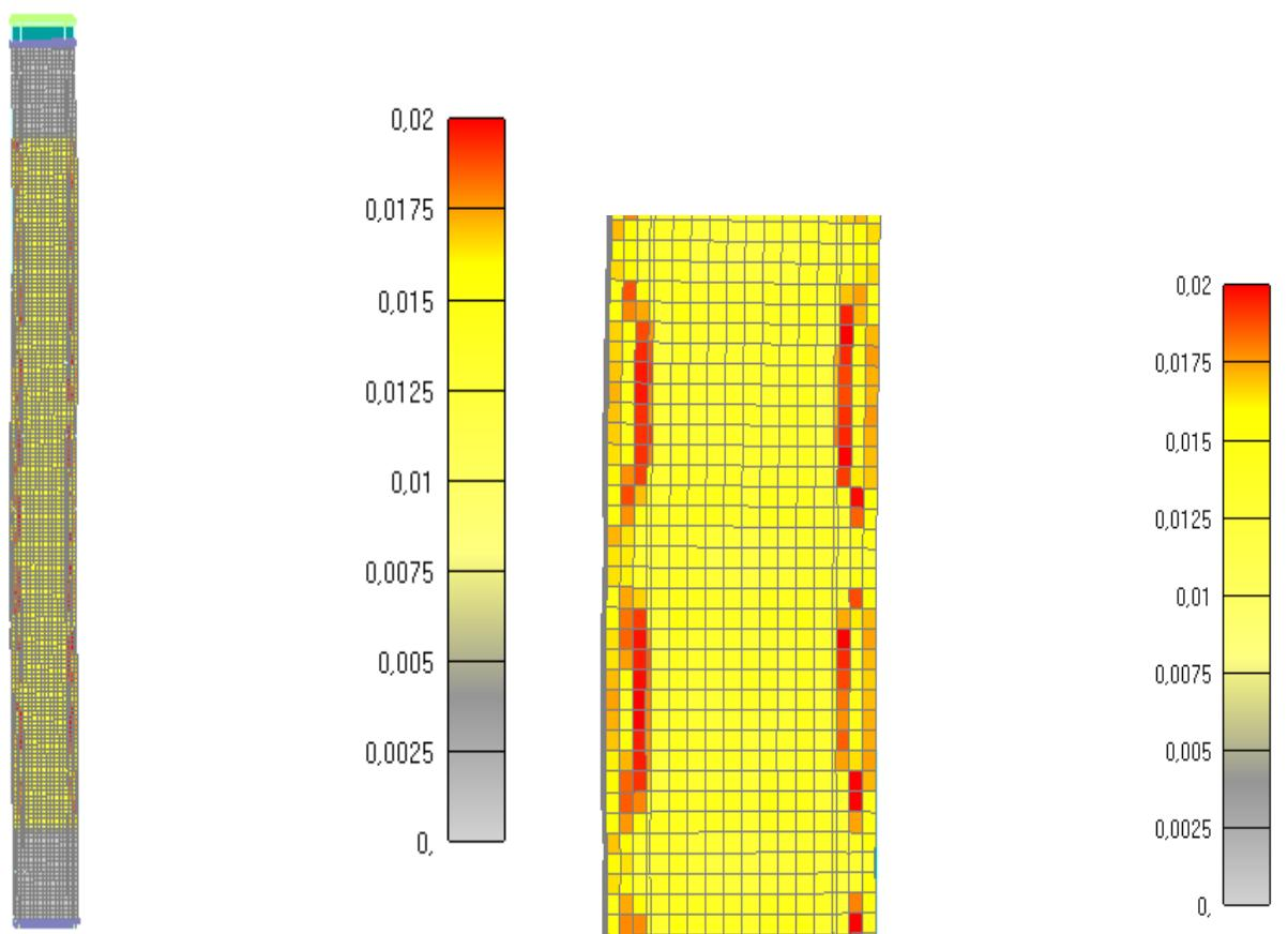
Slika 6.124: Prikaz pukotina za cijeli stup nakon 175 minuta
