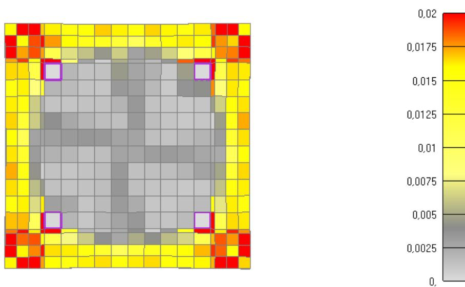
Slika 6.144: Prikaz pukotina za poprečni presjek stupa nakon 1030 minuta
