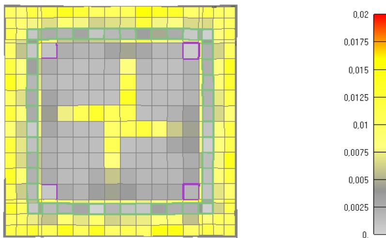
Slika 6.222: Prikaz pukotina za poprečni presjek stupa nakon 275 minuta požara
