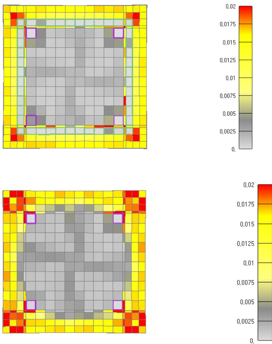
Slika 6.145: Prikaz pukotina za poprečni presjek stupa nakon 1690 minuta
