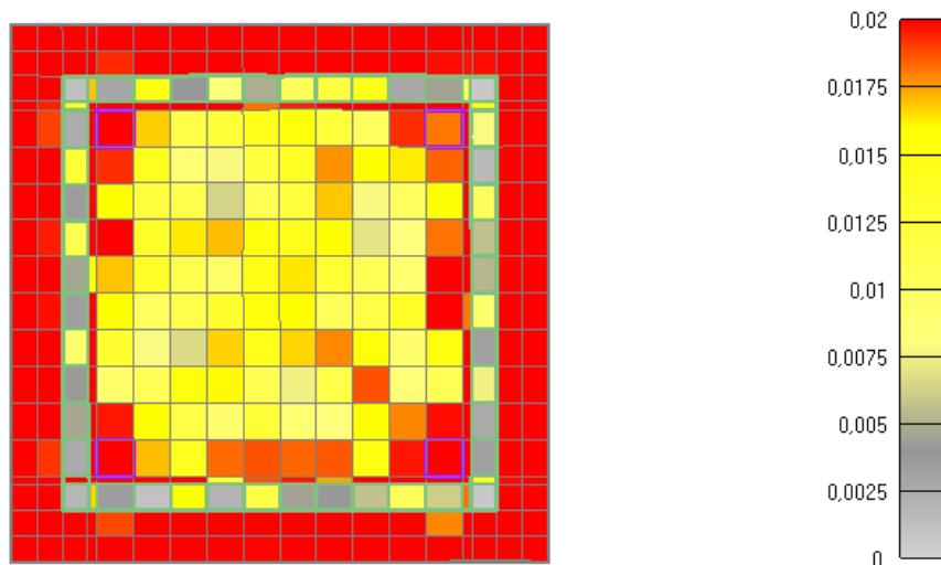
Slika 6.226: Prikaz pukotina za poprečni presjek stupa nakon 1810 minuta
