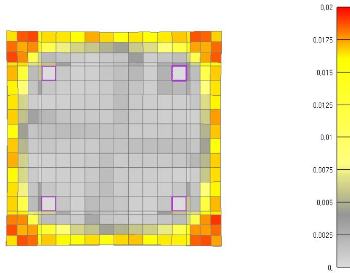
Slika 6.18: Prikaz pukotina za poprečni presjek stupa nakon 1615 minuta
