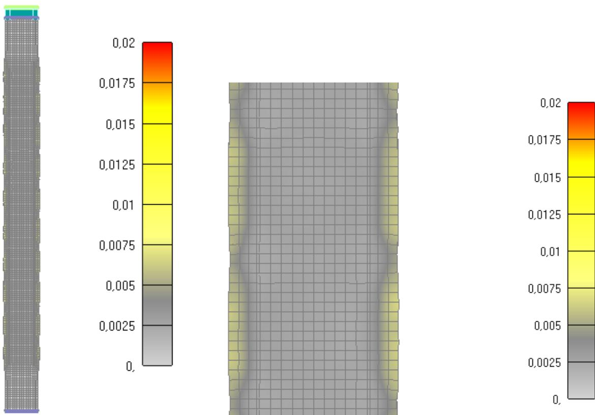
Slika 6.276: Prikaz pukotina za cijeli stup nakon 30 minuta
