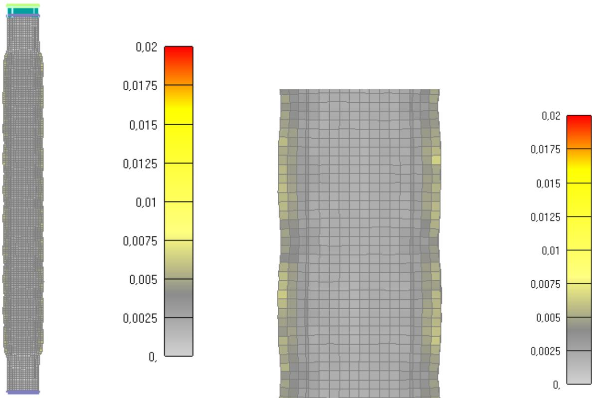
Slika 6.94: Prikaz pukotina za cijeli stup nakon 30 minuta
