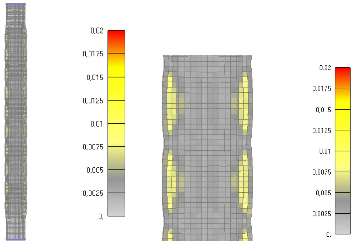
Slika 6.237: Prikaz pukotina za cijeli stup nakon 60 minuta
