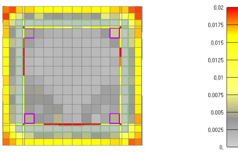
Slika 6.112: Prikaz pukotina za poprečni presjek stupa nakon 895 minuta požara
