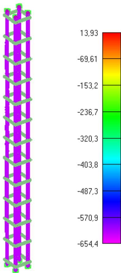
Slika 6.166: Prikaz naprezanja glavne uzdužne armature za djelovanje požara od 1690min
