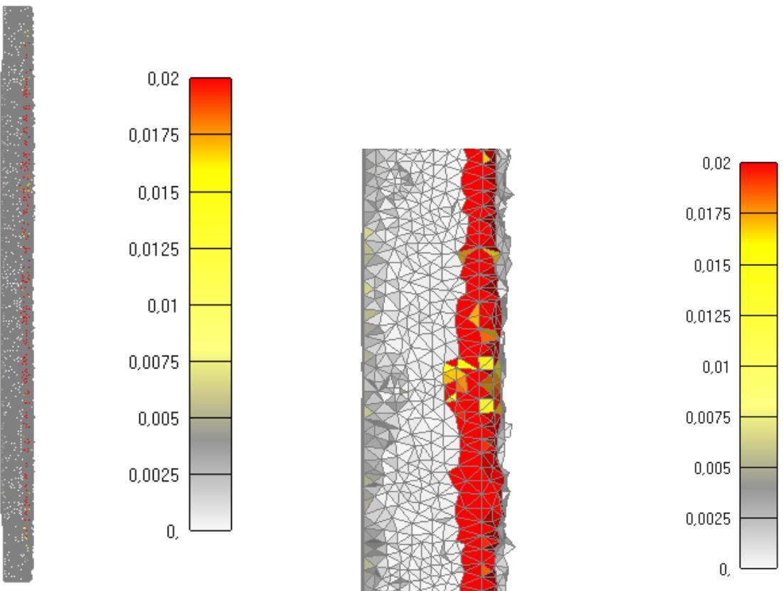
Slika 6.58:Prikaz pukotina za jednu četvrtinu stupa nakon 120 minuta
