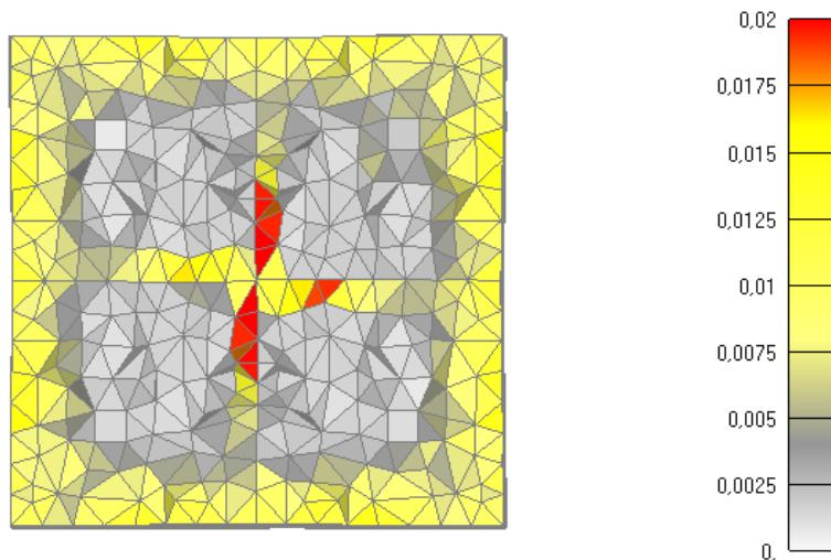
Slika 6.50: Prikaz pukotina za poprečni presjek stupa nakon 275 minuta požara
