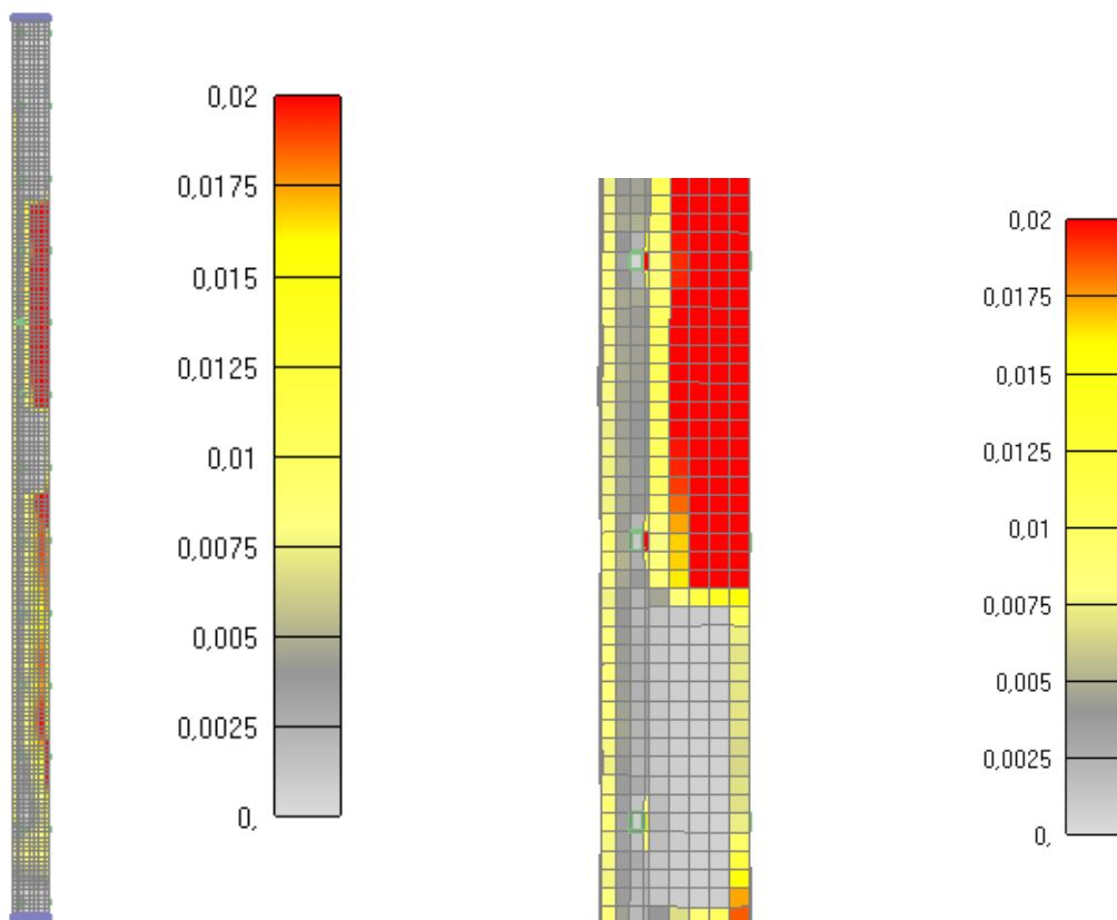
Slika 6.180: Prikaz pukotina za jednu četvrtinu stupa nakon 180 minuta
