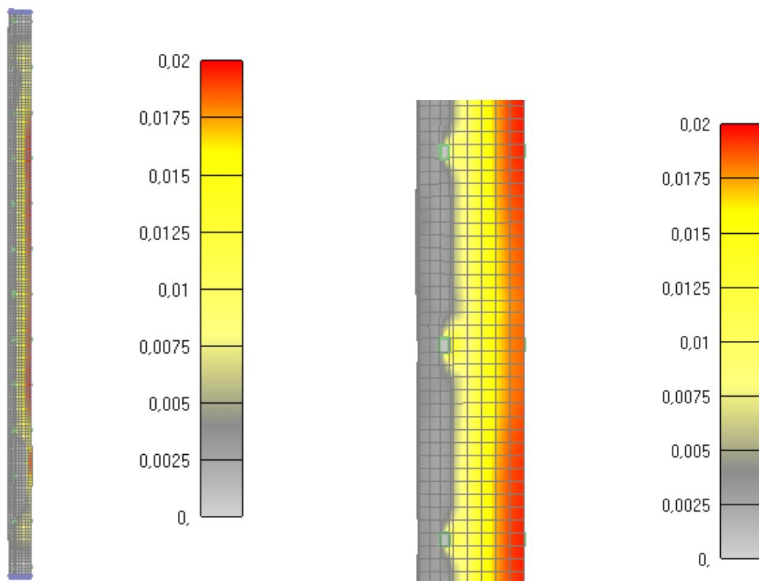
Slika 6.275: Prikaz pukotina za jednu četvrtinu stupa nakon 120 minuta
