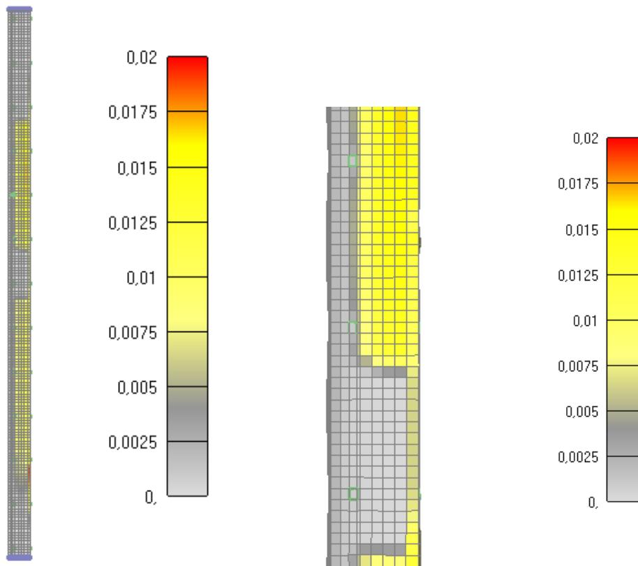
Slika 6.177: Prikaz pukotina za jednu četvrtinu stupa nakon 30 minuta
