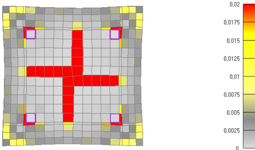
Slika 6.140: Prikaz pukotina za poprečni presjek stupa nakon 90 minuta požara
