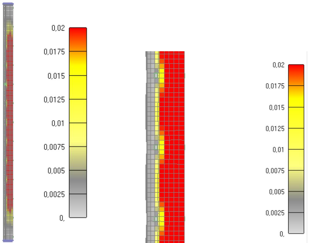
Slika 6.147: Prikaz pukotina za jednu četvrtinu stupa nakon 60 minuta
