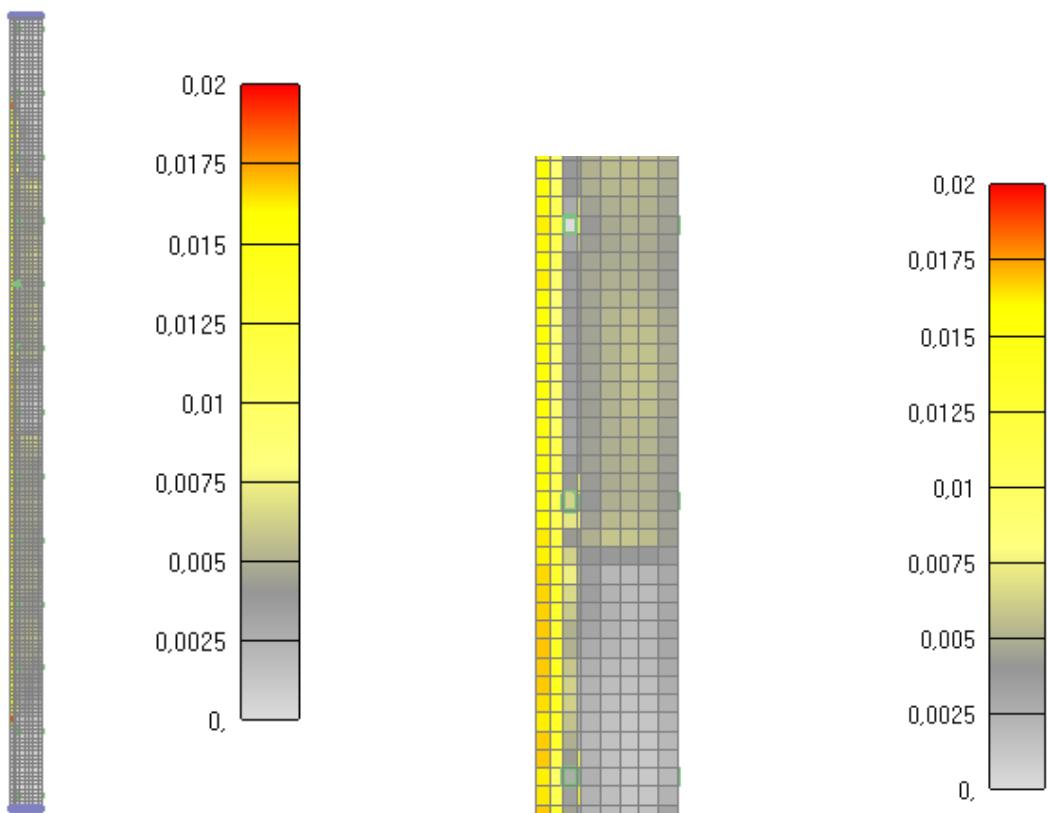
Slika 6.182: Prikaz pukotina za jednu četvrtinu stupa nakon 1030 minuta
