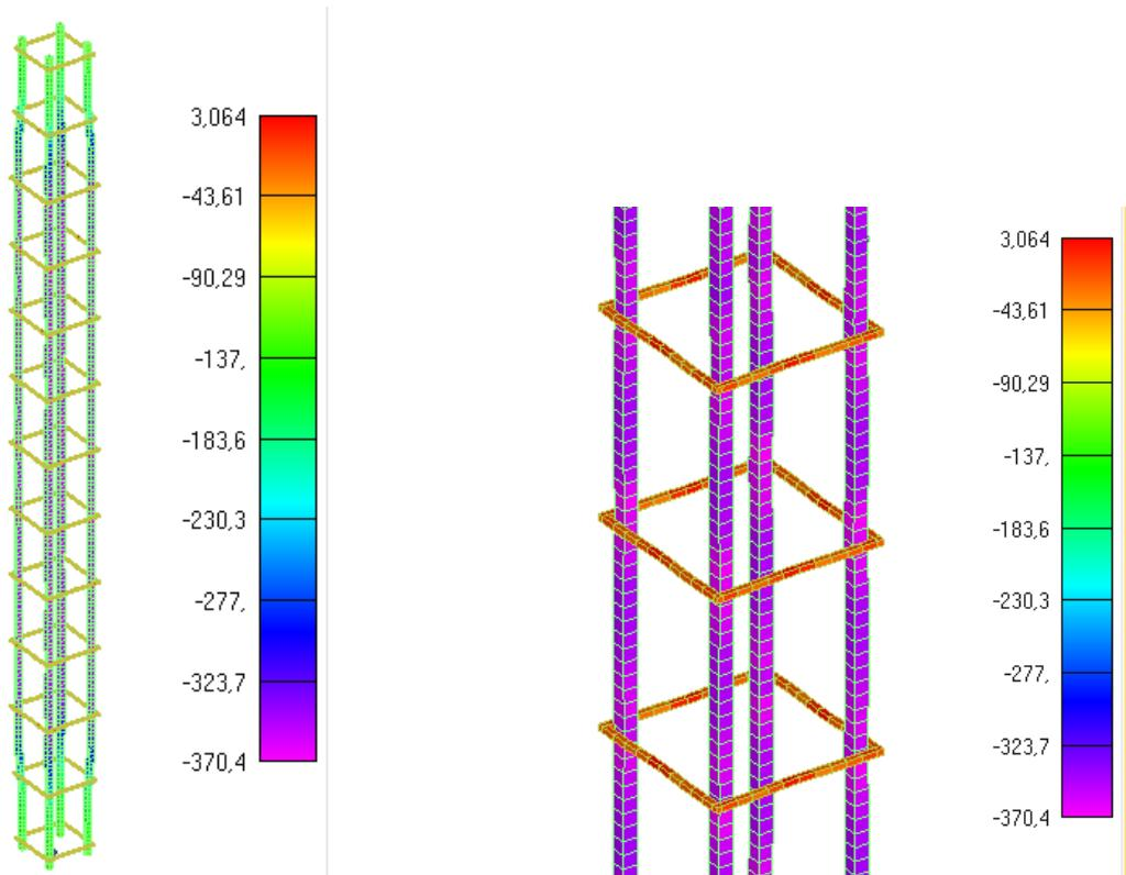
Slika 6.35: Prikaz naprezanja glavne uzdužne armature i spona za djelovanje požara od 30min
