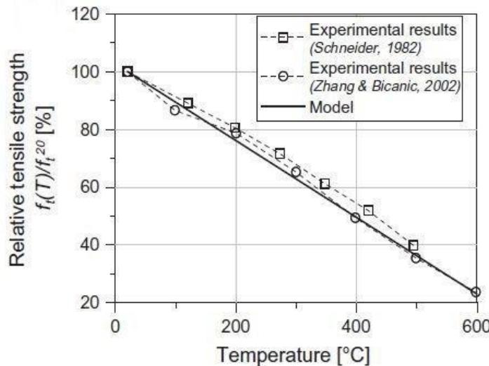
Slika 2.2. Prikaz vlačne čvrstoće u ovisnosti o temperaturi
