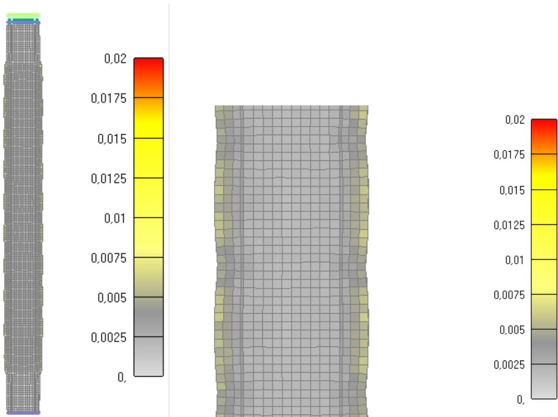
Slika 6.184: Prikaz pukotina za cijeli stup nakon 30 minuta
