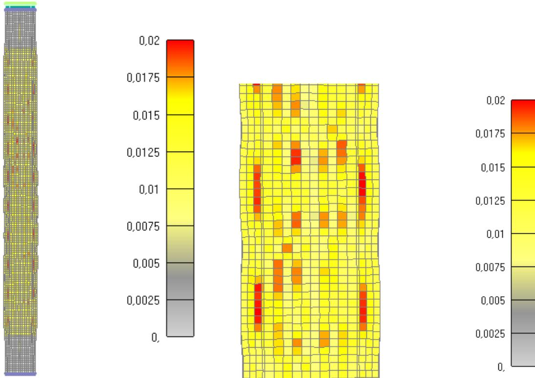
Slika 6.240: Prikaz pukotina za cijeli stup nakon 275 minuta
