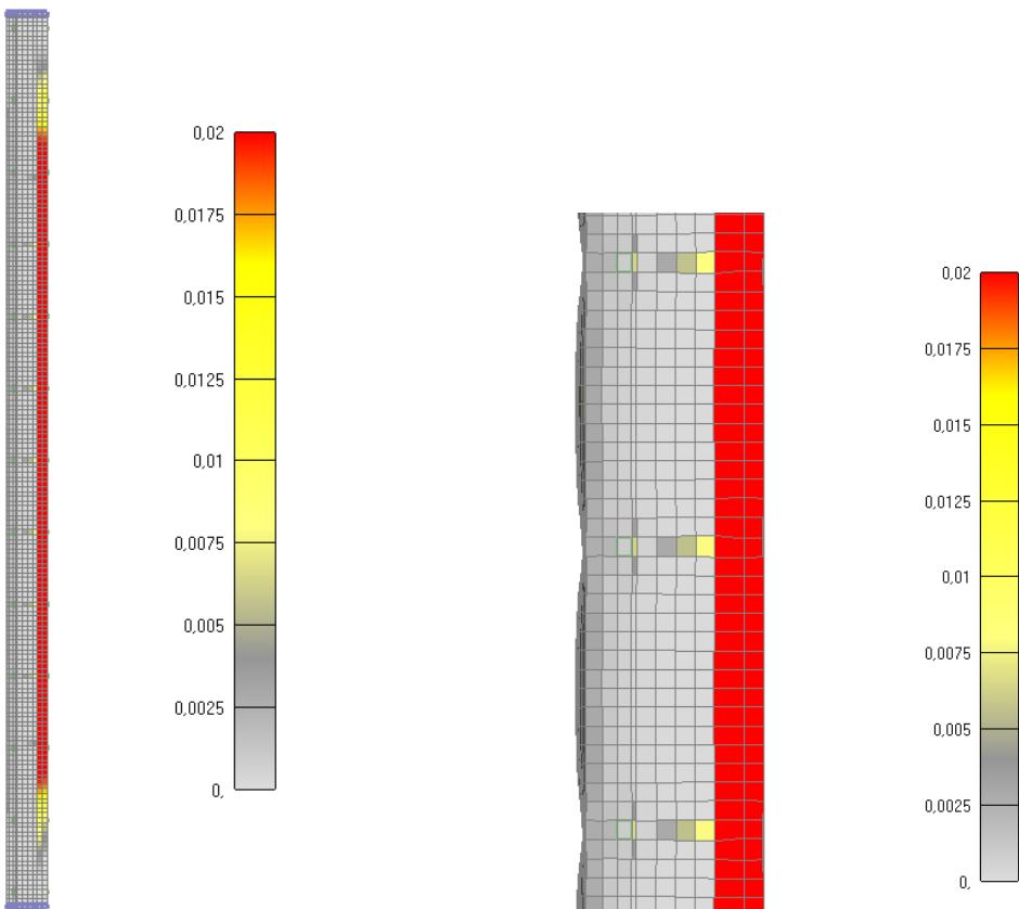
Slika 6.20: Prikaz pukotina za jednu četvrtinu stupa nakon 60 minuta
