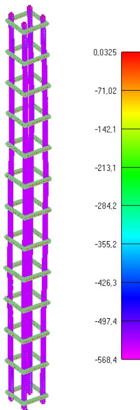
Slika 6.193: Prikaz naprezanja glavne uzdužne armature za djelovanje požara od 90min
