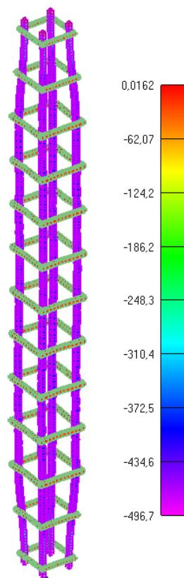
Slika 6.75:Prikaz naprezanja glavne uzdužne armature za djelovanje požara od 115min
