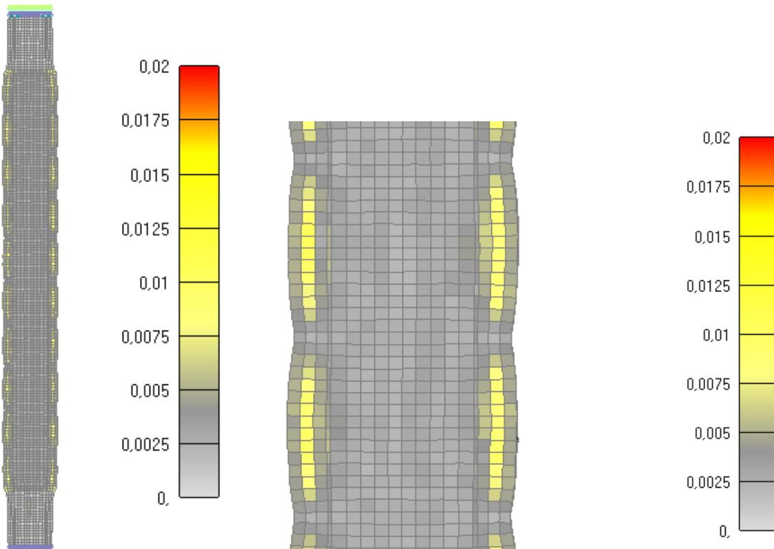
Slika 6.185: Prikaz pukotina za cijeli stup nakon 60 minuta
