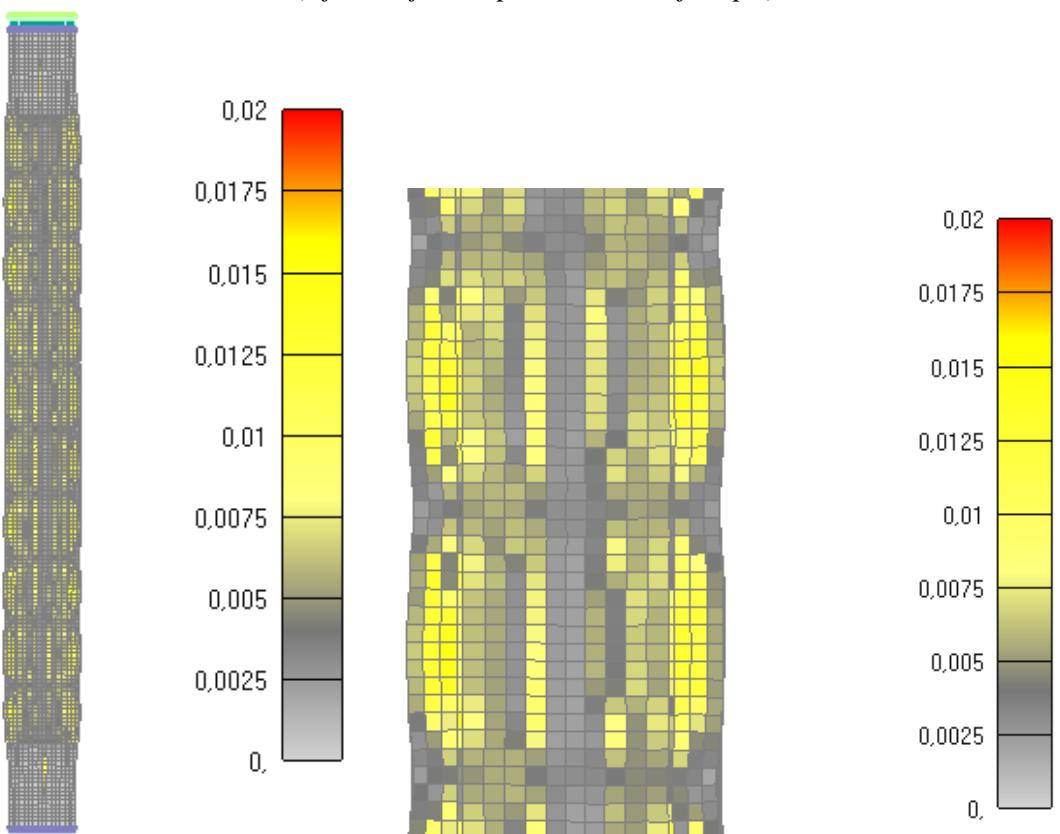
Slika 6.261: Prikaz pukotina za cijeli stup nakon 120 minuta
