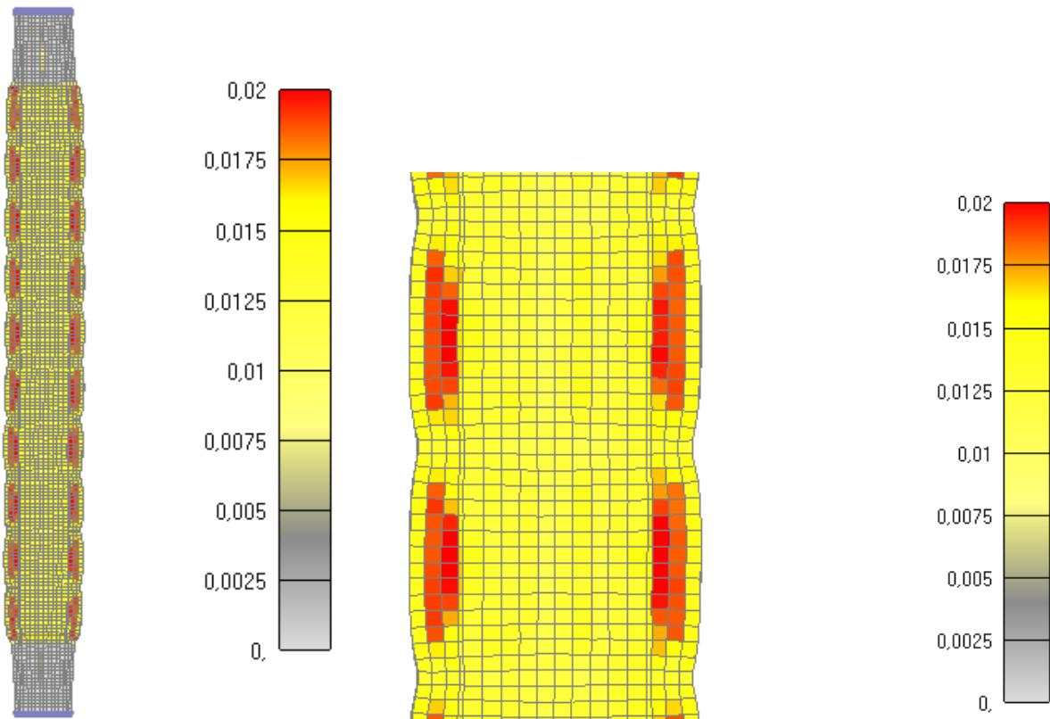
Slika 6.157: Prikaz pukotina za cijeli stup nakon 250 minuta
