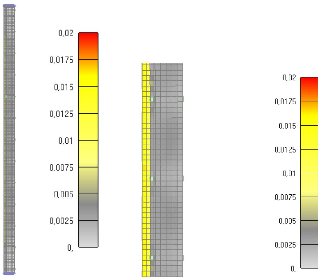
Slika 6.152: Prikaz pukotina za jednu četvrtinu stupa nakon 1690 minuta
