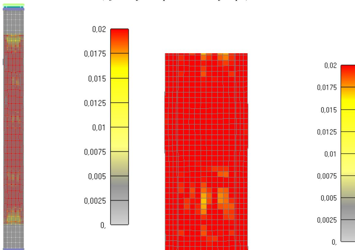
Slika 6.243: Prikaz pukotina za cijeli stup nakon 1810 minuta
