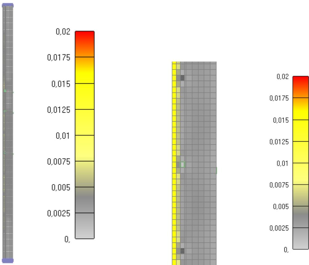
Slika 6.92: Prikaz pukotina za jednu četvrtinu stupa nakon 895 minuta
