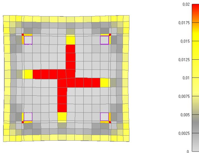
Slika 6.14: Prikaz pukotina za poprečni presjek stupa nakon 115 minuta
