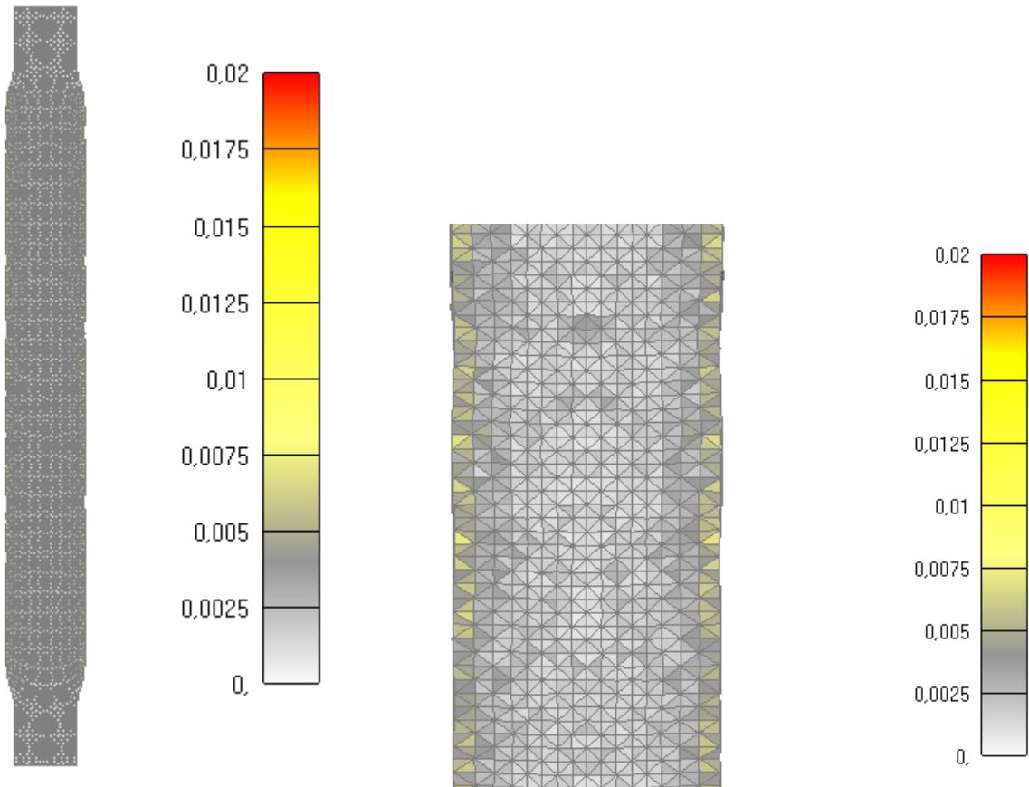
Slika 6.63: Prikaz pukotina za cijeli stup nakon 30 minuta
