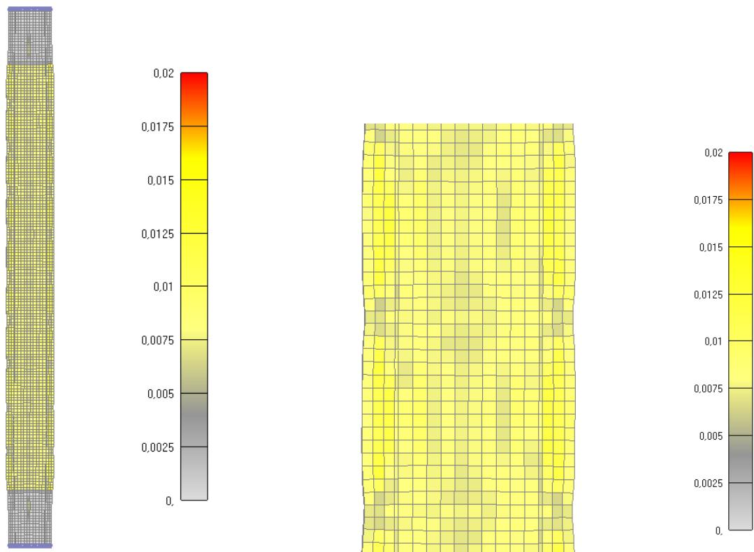
Slika 6.27: Prikaz pukotina za cijeli stup nakon 115 minuta
