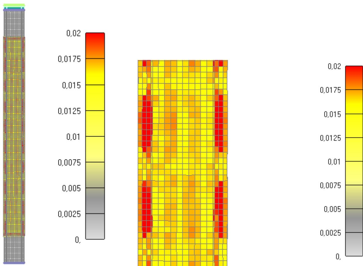
Slika 6.190: Prikaz pukotina za cijeli stup nakon 1690 minuta
