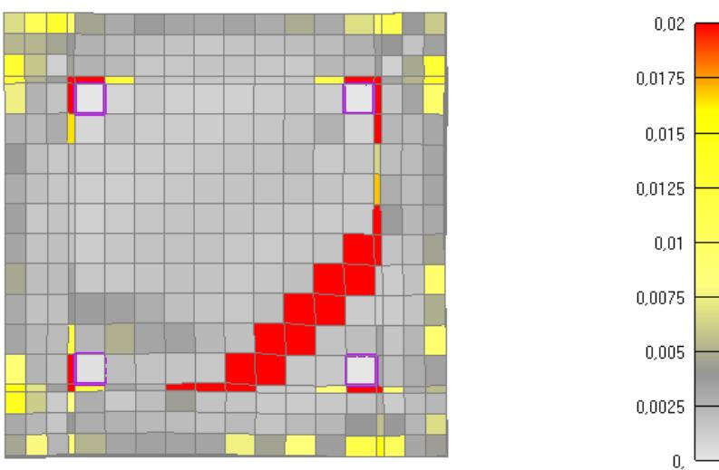
Slika 6.198: Prikaz pukotina za poprečni presjek stupa nakon 90 minuta požara
