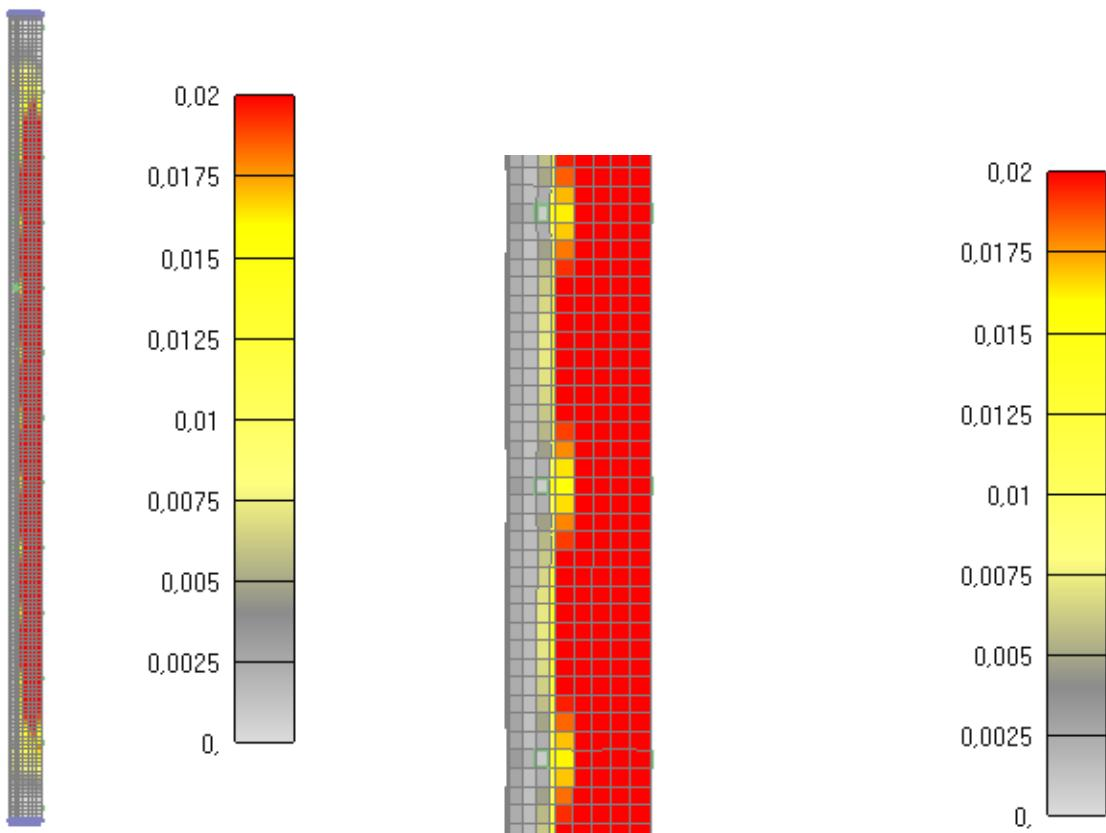
Slika 6.148: Prikaz pukotina za jednu četvrtinu stupa nakon 90 minuta
