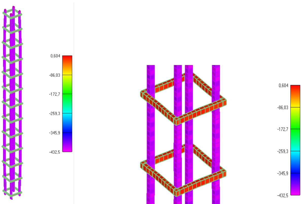
Slika 6.5: Prikaz naprezanja glavne uzdužne armature i spona za djelovanje požara od 60min
