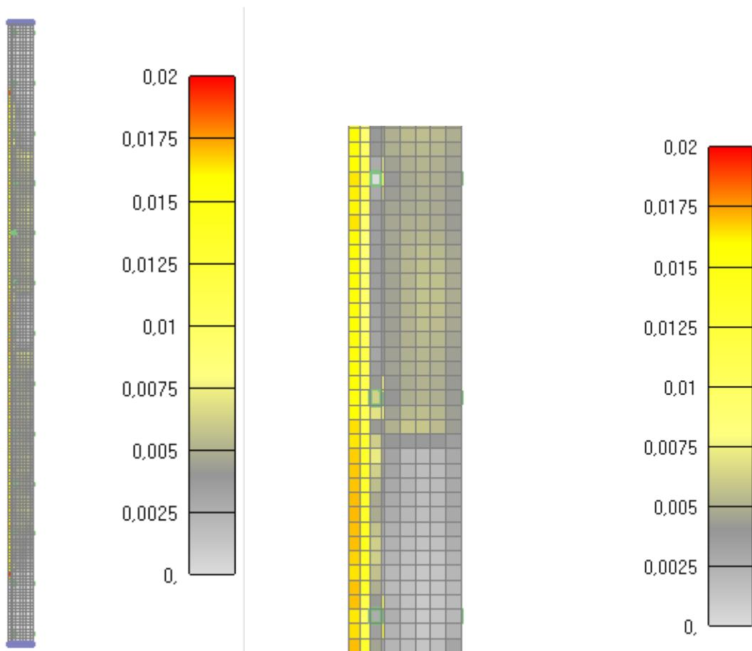
Slika 6.183: Prikaz pukotina za jednu četvrtinu stupa nakon 1690 minuta
