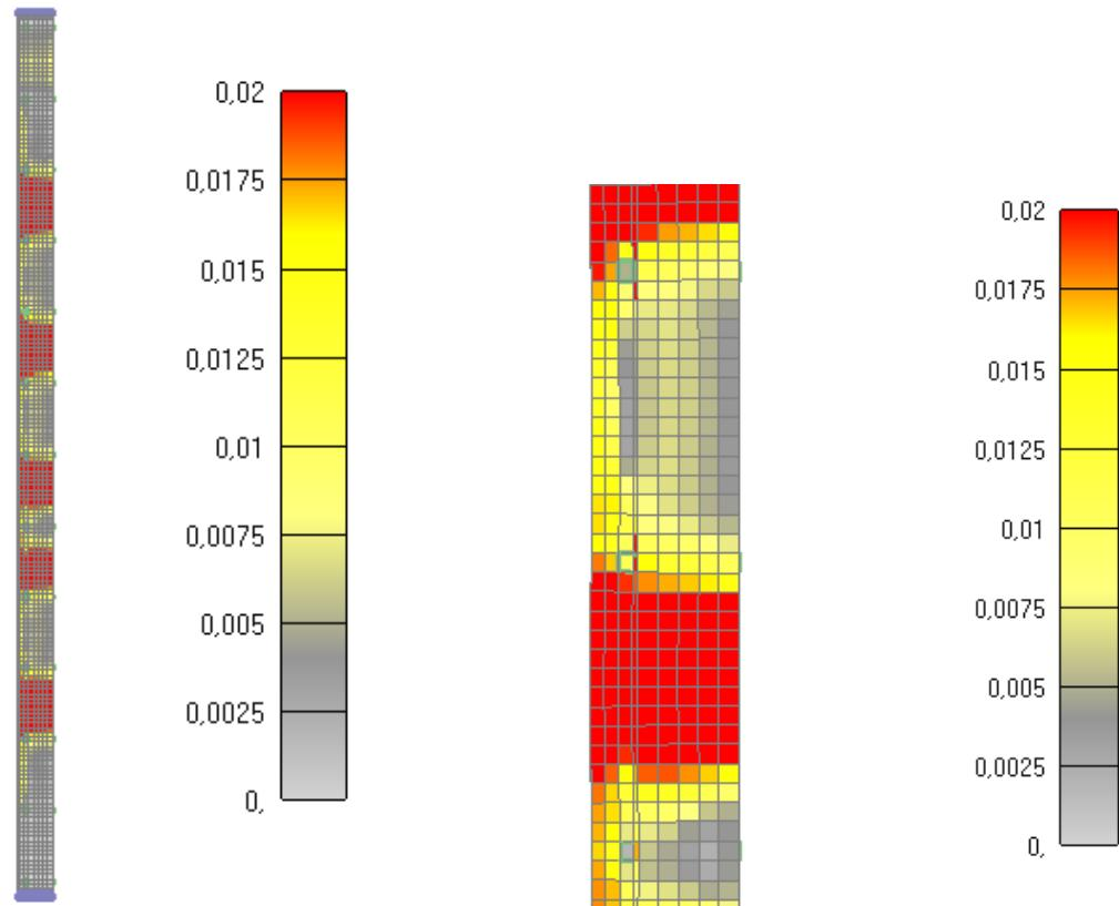
Slika 6.233: Prikaz pukotina za jednu četvrtinu stupa nakon 370 minuta
