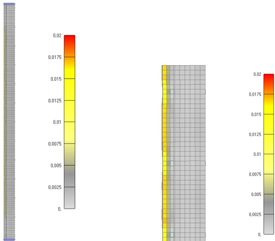
Slika 6.23: Prikaz pukotina za jednu četvrtinu stupa nakon 895 minuta
