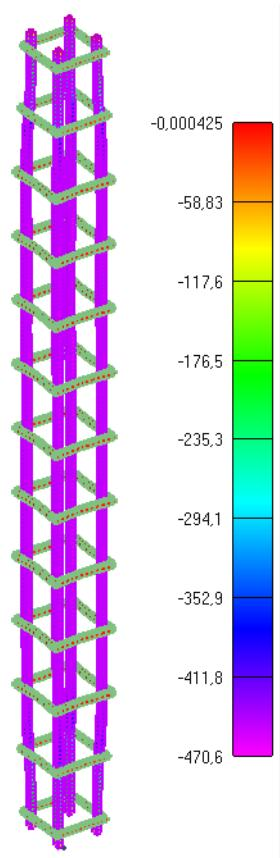
Slika 6.73: Prikaz naprezanja glavne uzdužne armature za djelovanje požara od 30min
