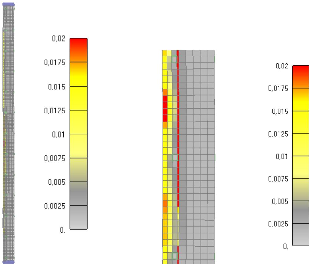
Slika 6.118: Prikaz pukotina za jednu četvrtinu stupa nakon 175 minuta
