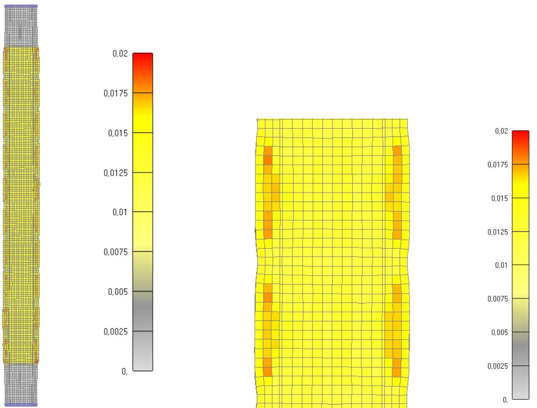
Slika 6.28: Prikaz pukotina za cijeli stup nakon 175 minuta
