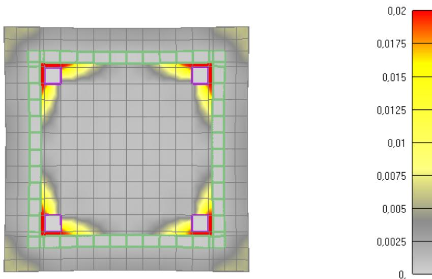
Slika 6.250: Prikaz pukotina za poprečni presjek stupa nakon 60 minuta požara
