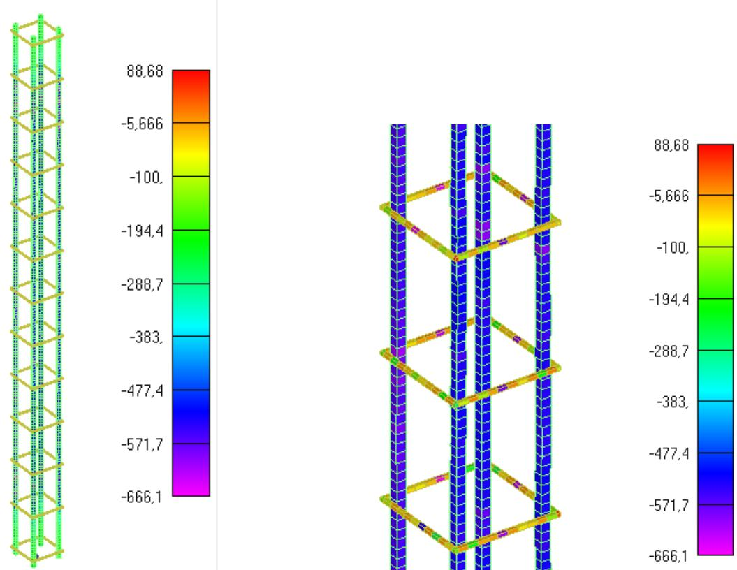
Slika 6.42:Prikaz naprezanja glavne uzdužne armature i spona za djelovanje požara od 1810min
