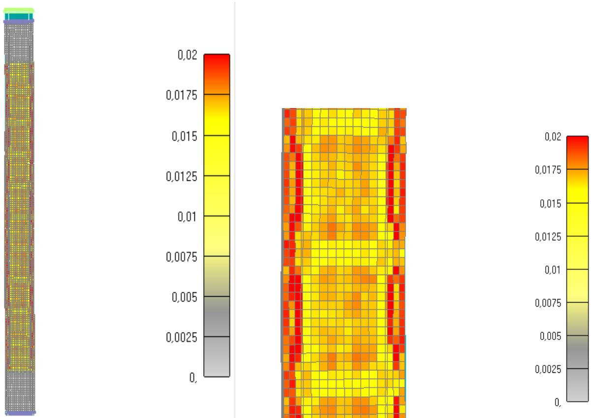
Slika 6.126: Prikaz pukotina za cijeli stup nakon 1615 minuta
