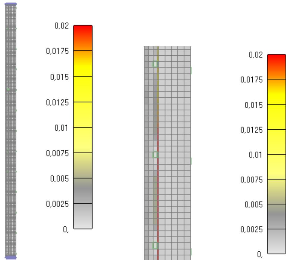
Slika 6.200: Prikaz pukotina za jednu četvrtinu stupa nakon 60 minuta
