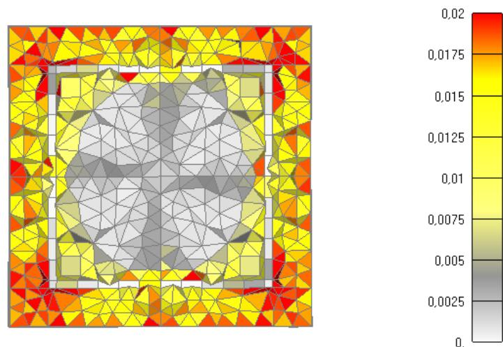
Slika 6.53: Prikaz pukotina za poprečni presjek stupa nakon 1810 minuta
