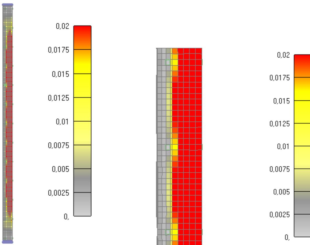
Slika 6.230: Prikaz pukotina za jednu četvrtinu stupa nakon 90 minuta
