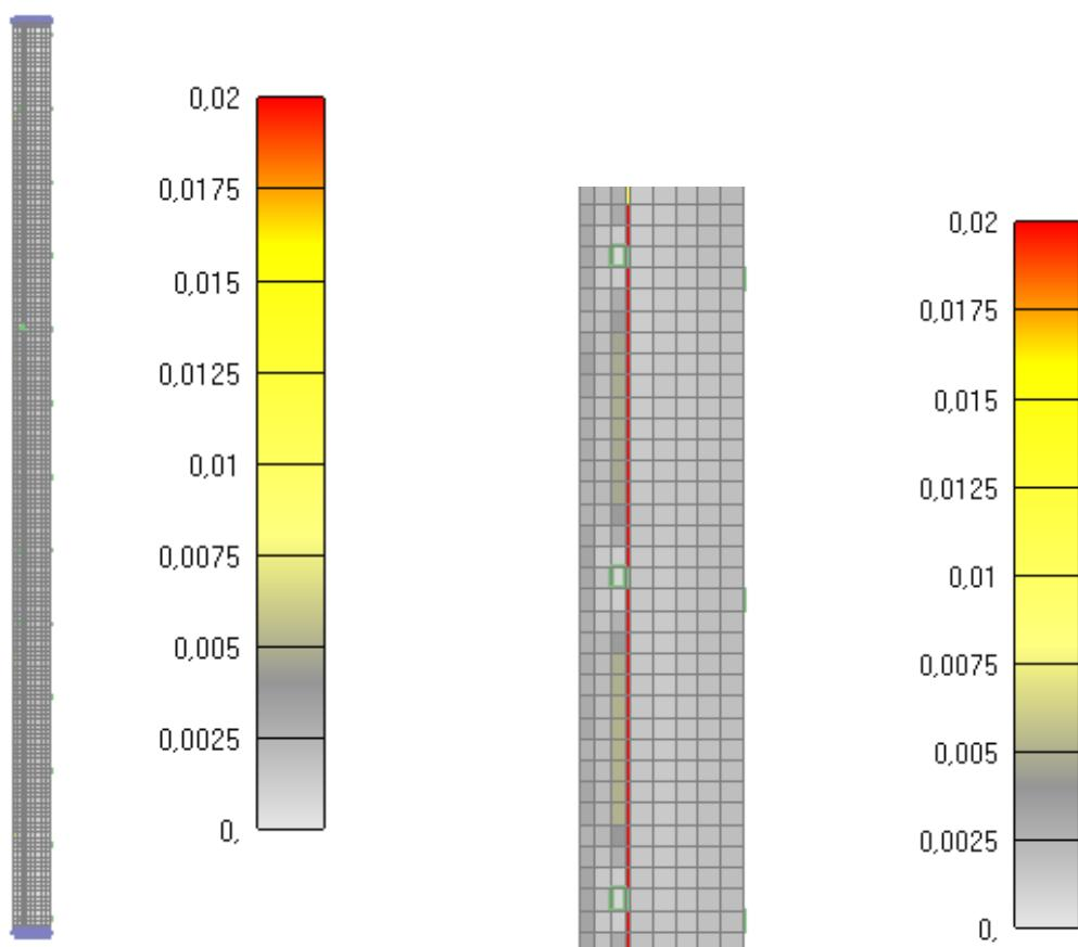
Slika 6.201: Prikaz pukotina za jednu četvrtinu stupa nakon 90 minuta
