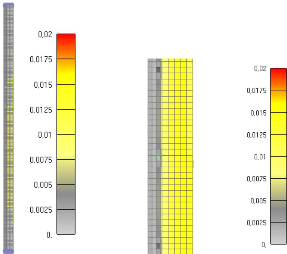
Slika 6.88: Prikaz pukotina za jednu četvrtinu stupa nakon 30 minuta
