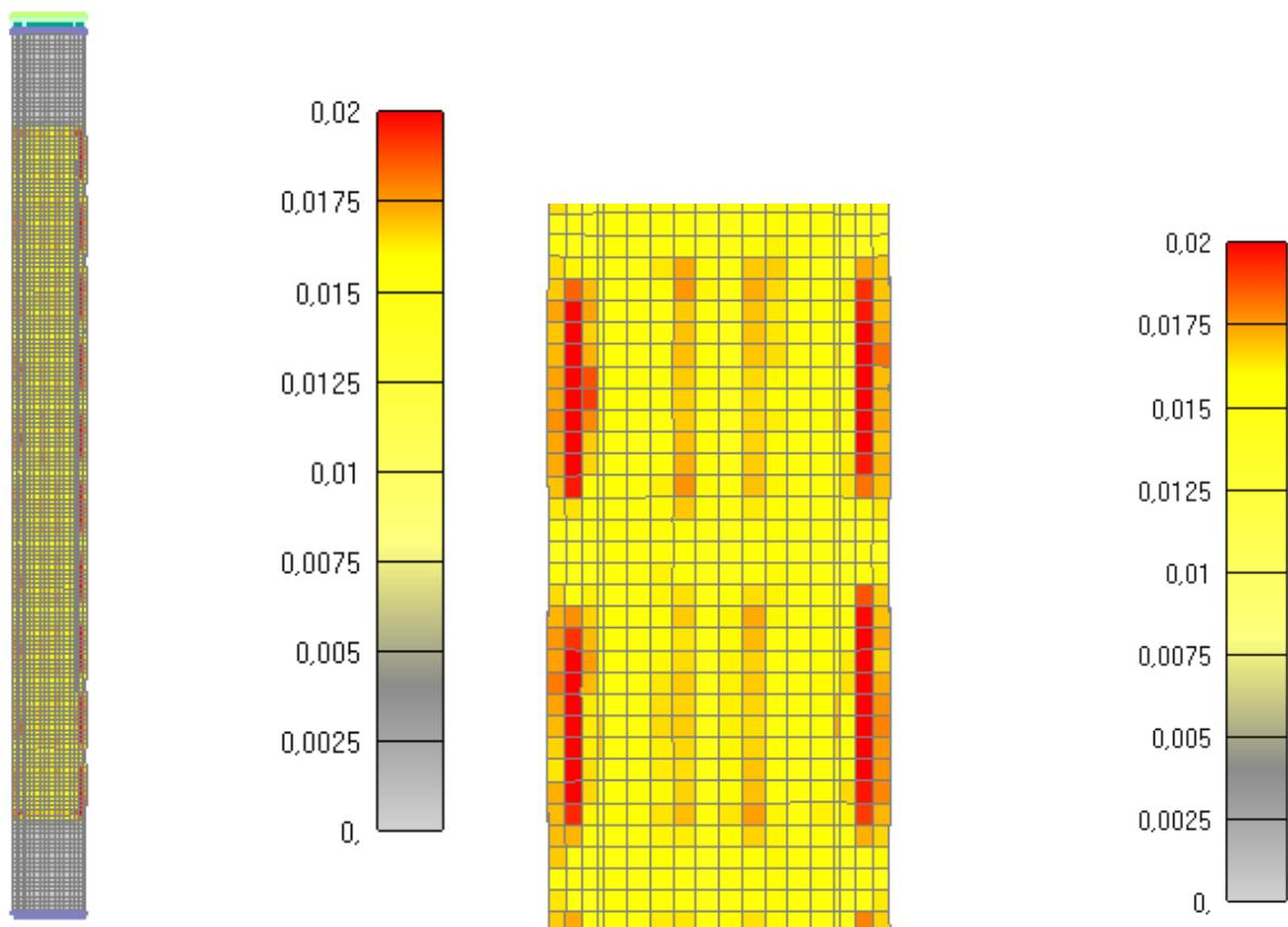
Slika 6.98: Prikaz pukotina za cijeli stup nakon 895 minuta
