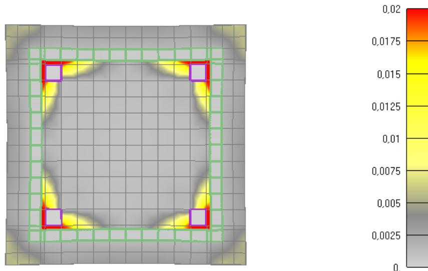
Slika 6.268: Prikaz pukotina za poprečni presjek stupa nakon 60 minuta požara
