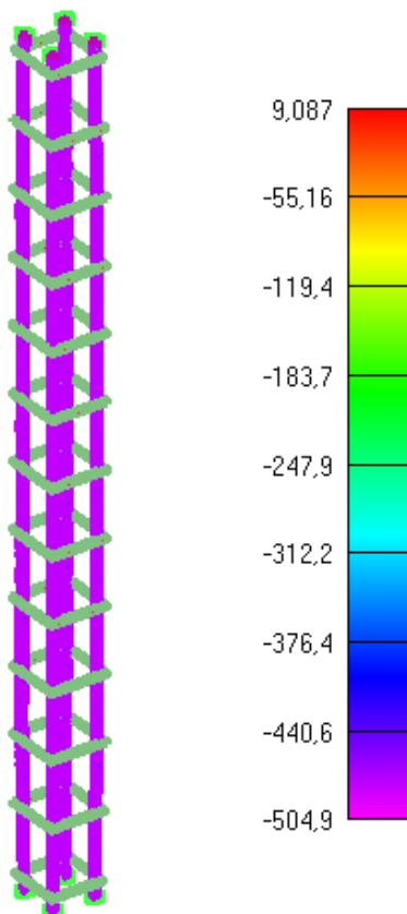
Slika 6.164:Prikaz naprezanja glavne uzdužne armature za djelovanje požara od 250min
