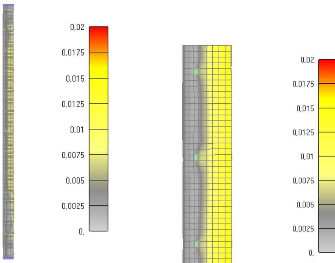
Slika 6.274: Prikaz pukotina za jednu četvrtinu stupa nakon 90 minuta
