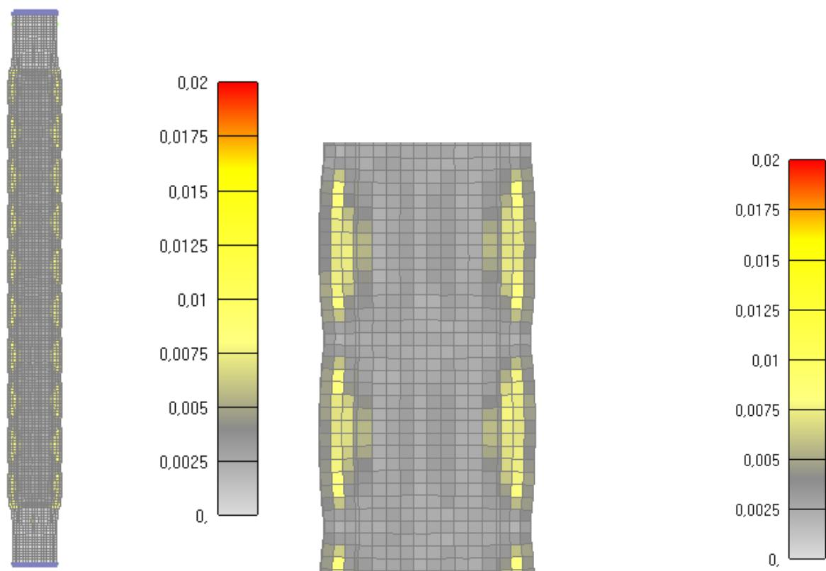
Slika 6.154: Prikaz pukotina za cijeli stup nakon 60 minuta
