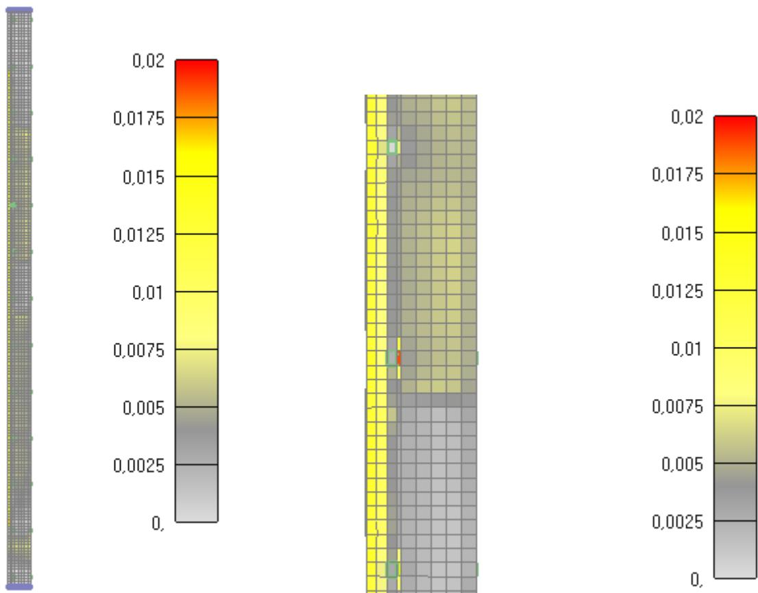
Slika 6.181: Prikaz pukotina za jednu četvrtinu stupa nakon 250 minuta
