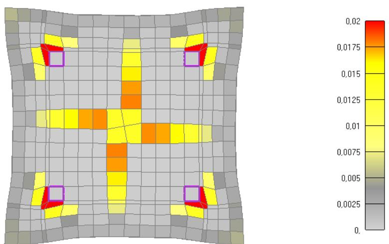
Slika 6.217: Prikaz pukotina za poprečni presjek stupa nakon 30 minuta požara
