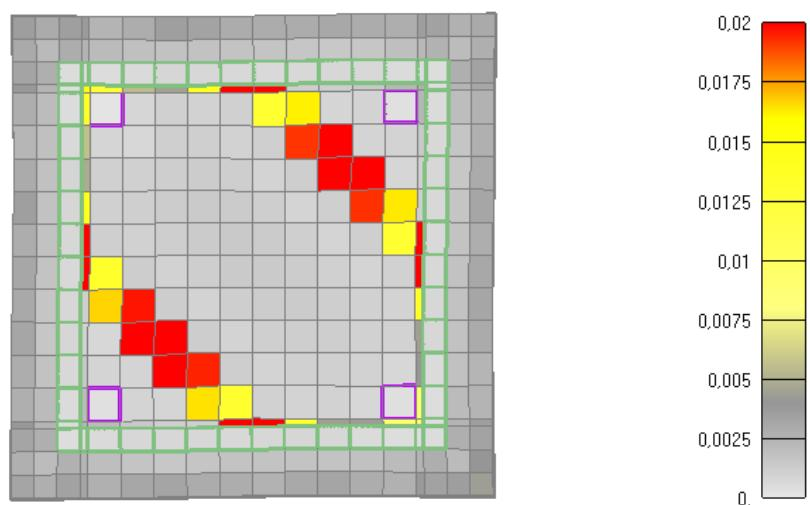
Slika 6.196: Prikaz pukotina za poprečni presjek stupa nakon 60 minuta požara
