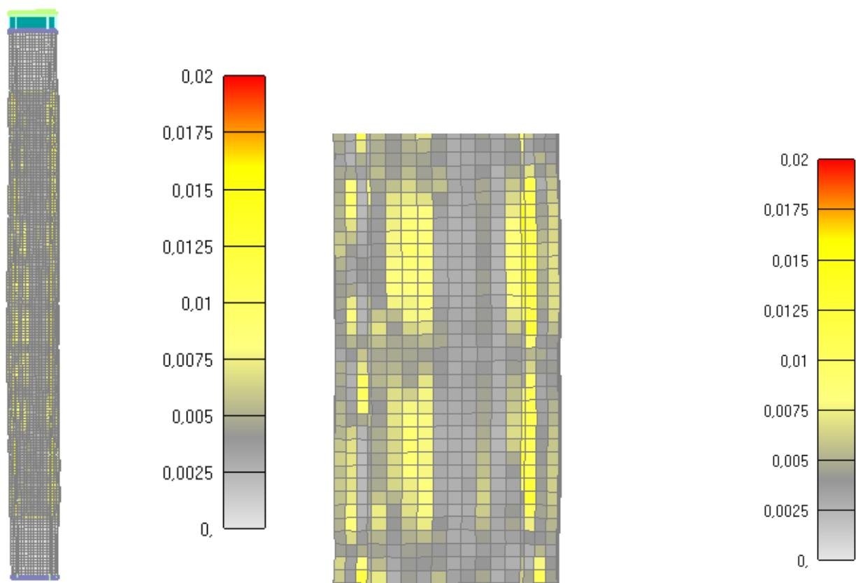
Slika 6.204: Prikaz pukotina za cijeli stup nakon 90 minuta
