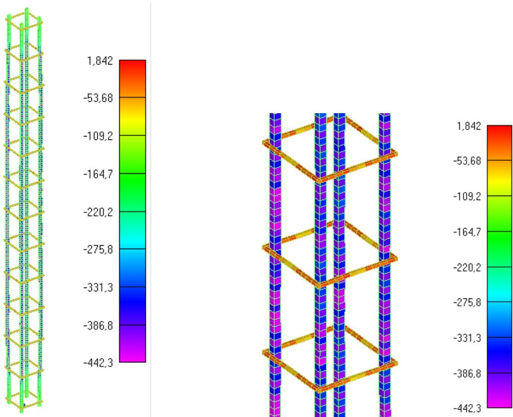
Slika 6.37: Prikaz naprezanja glavne uzdužne armature i spona za djelovanje požara od 90min
