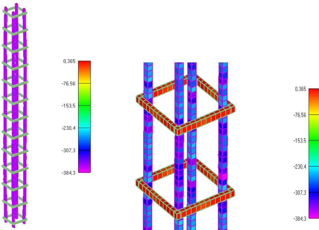
Slika 6.7:Prikaz naprezanja glavne uzdužne armature i spona za djelovanje požara od 175min
