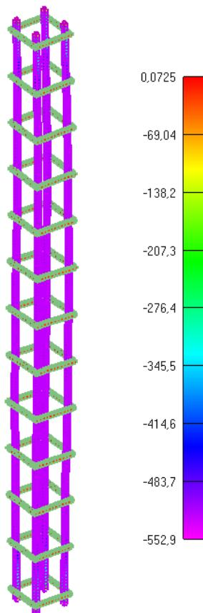
Slika 6.192: Prikaz naprezanja glavne uzdužne armature za djelovanje požara od 60min
