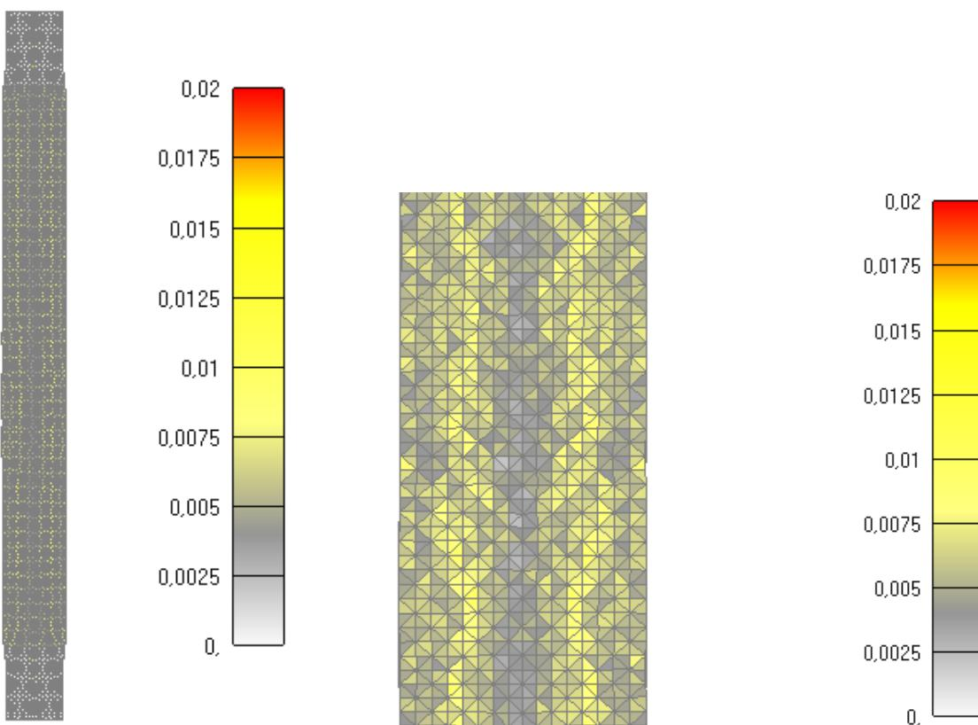
Slika 6.66: Prikaz pukotina za cijeli stup nakon 120 minuta
