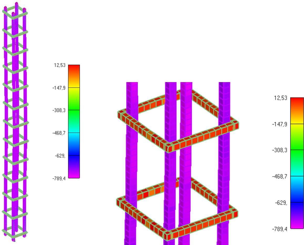
Slika 6.106: Prikaz naprezanja glavne uzdužne armature i spona u trenutku popuštanja stupa
