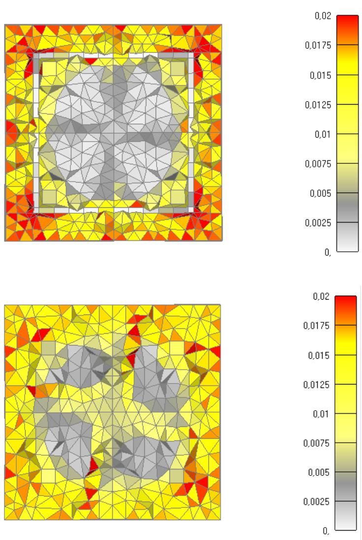
Slika 6.52: Prikaz pukotina za poprečni presjek stupa nakon 1090 minuta požara
