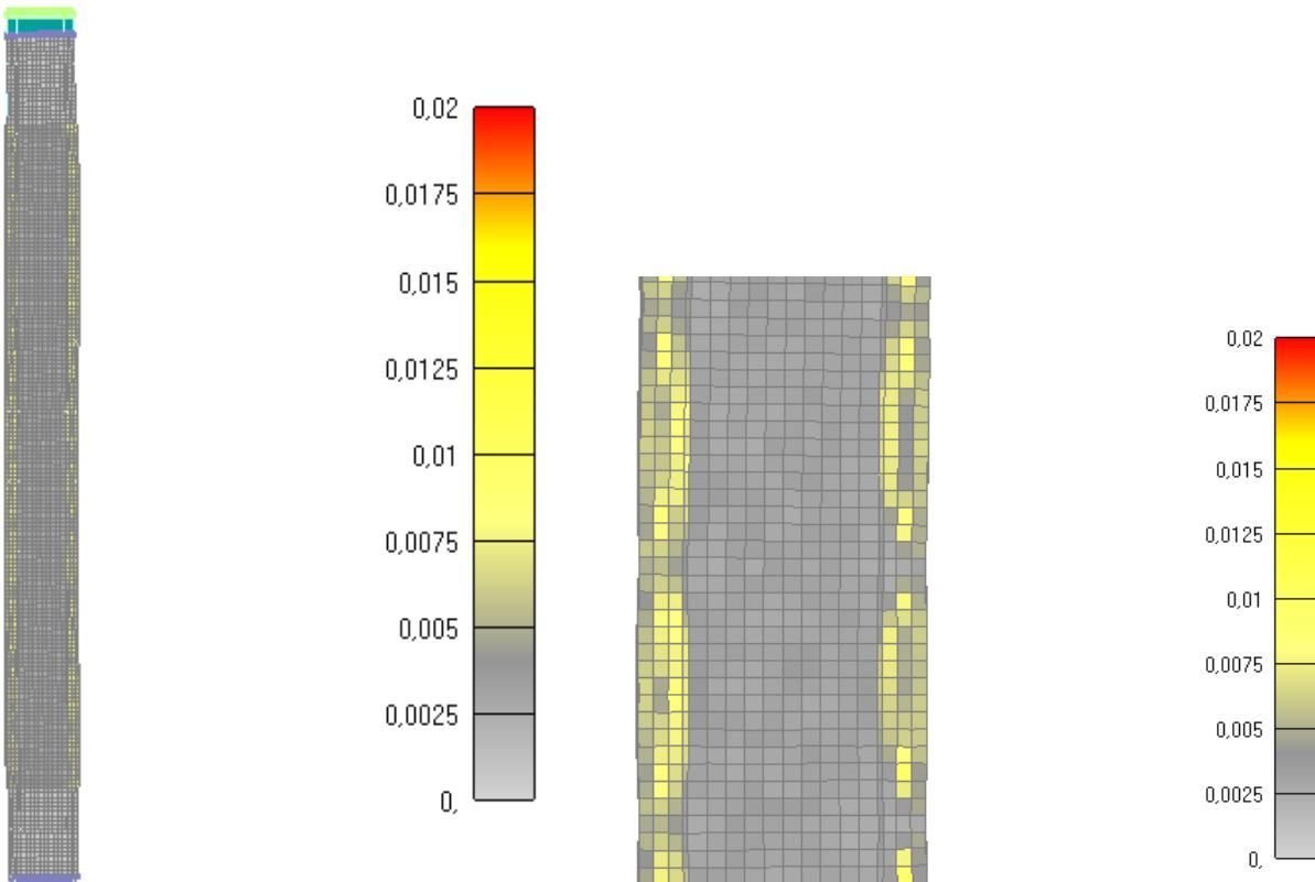
Slika 6.122: Prikaz pukotina za cijeli stup nakon 60 minuta
