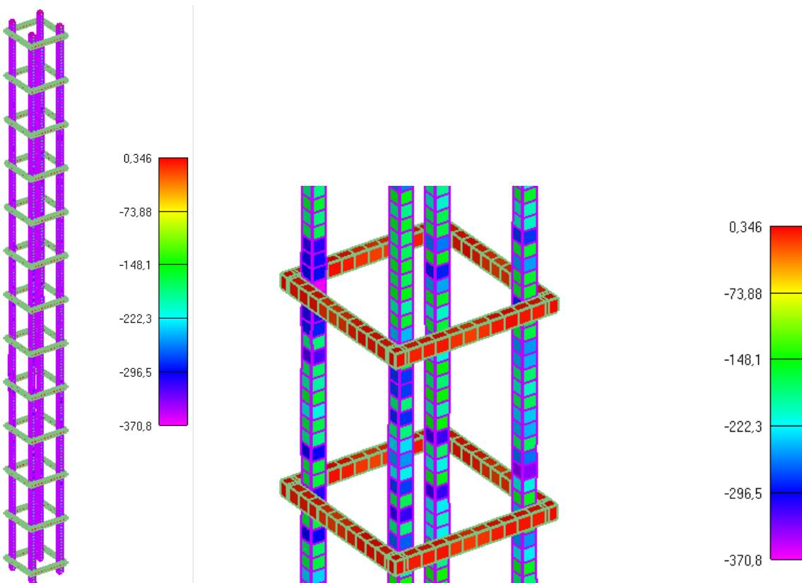
Slika 6.9:Prikaz naprezanja glavne uzdužne armature i spona za djelovanje požara od 1615min
