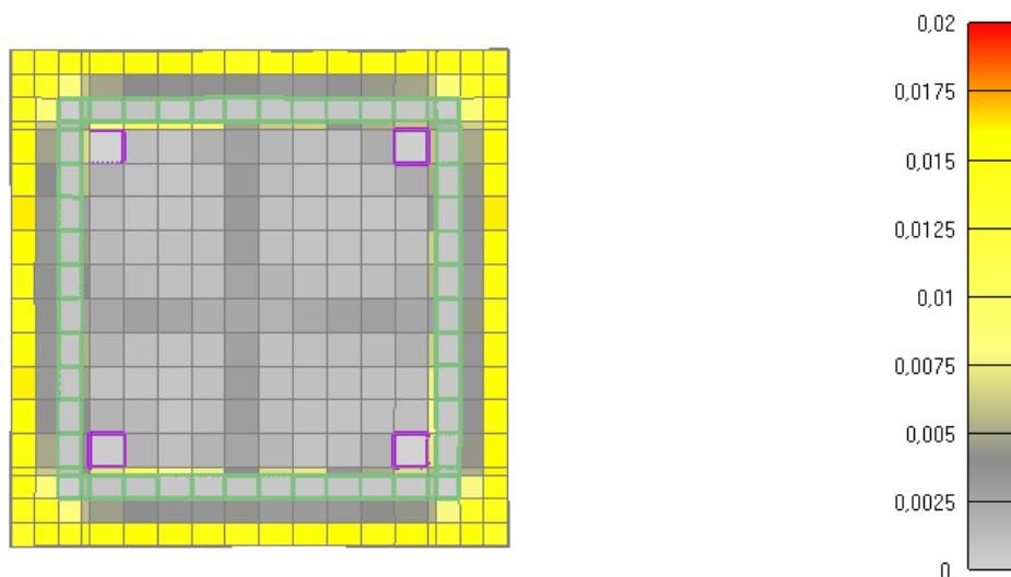
Slika 6.85: Prikaz pukotina za poprečni presjek stupa nakon 895 minuta požara
