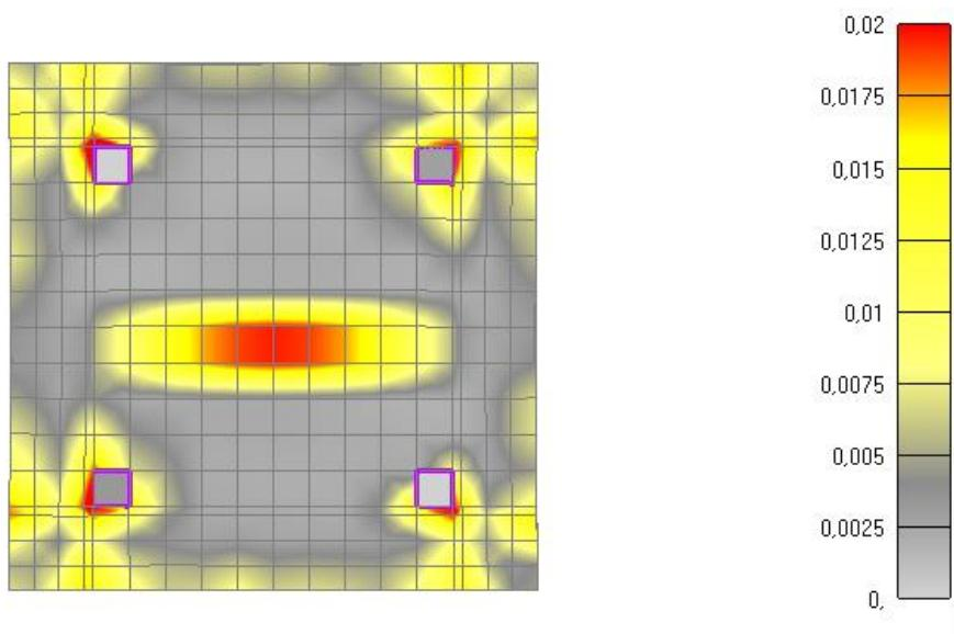
Slika 6.253: Prikaz pukotina za poprečni presjek stupa nakon 120 minuta požara
