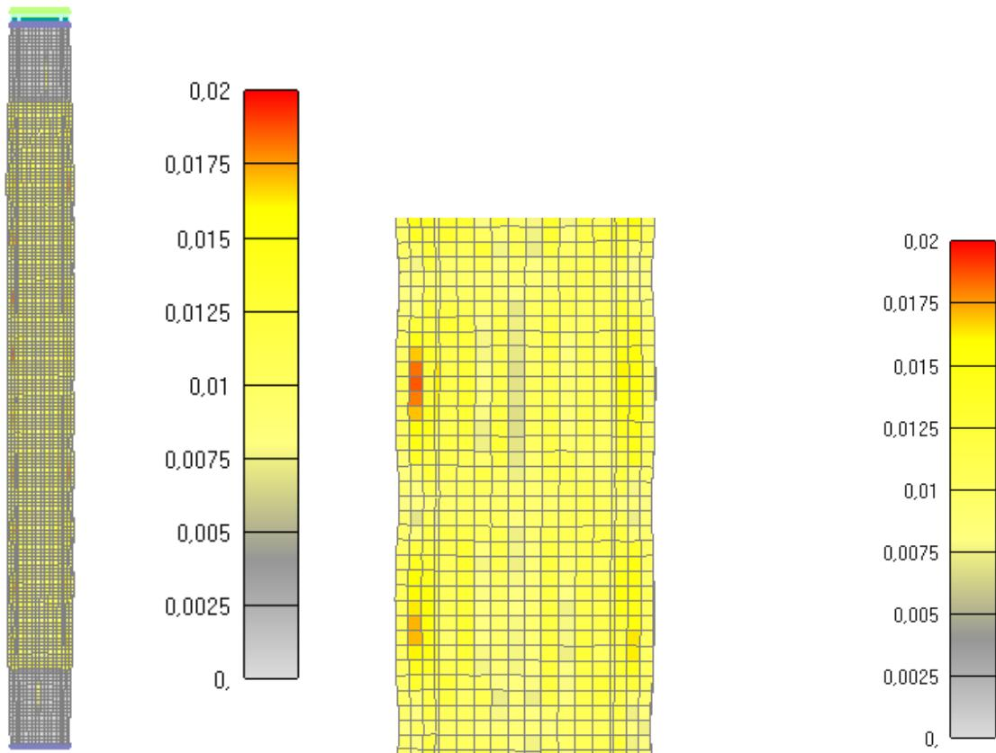
Slika 6.187: Prikaz pukotina za cijeli stup nakon 180 minuta
