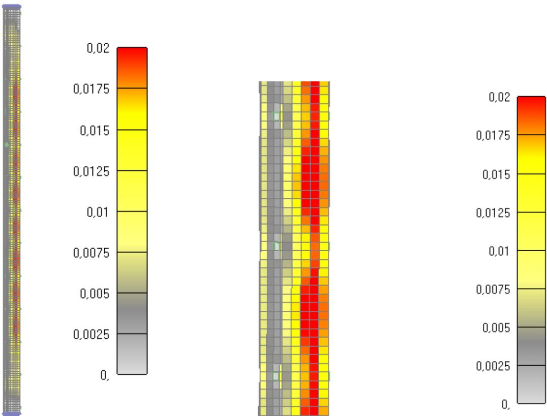
Slika 6.149: Prikaz pukotina za jednu četvrtinu stupa nakon 180 minuta
