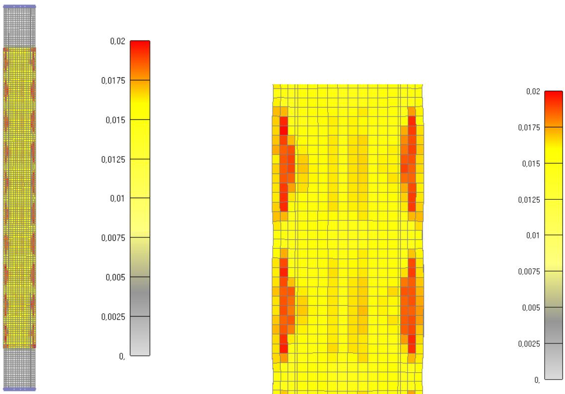
Slika 6.29: Prikaz pukotina za cijeli stup nakon 895 minuta
