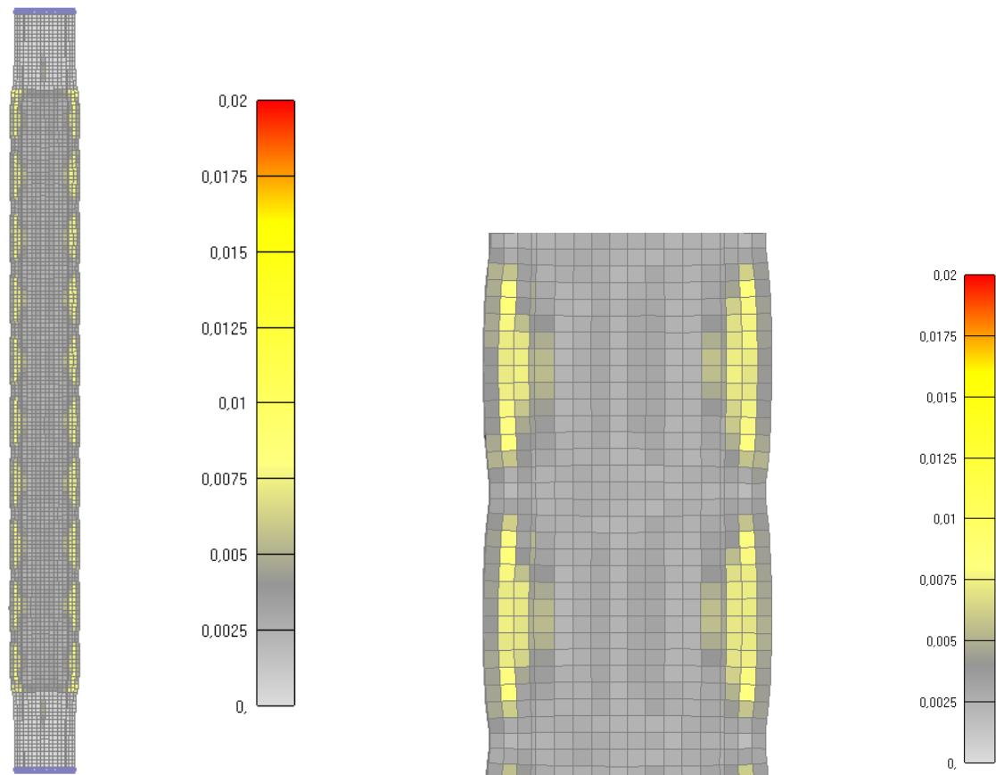
Slika 6.26: Prikaz pukotina za cijeli stup nakon 60 minuta
