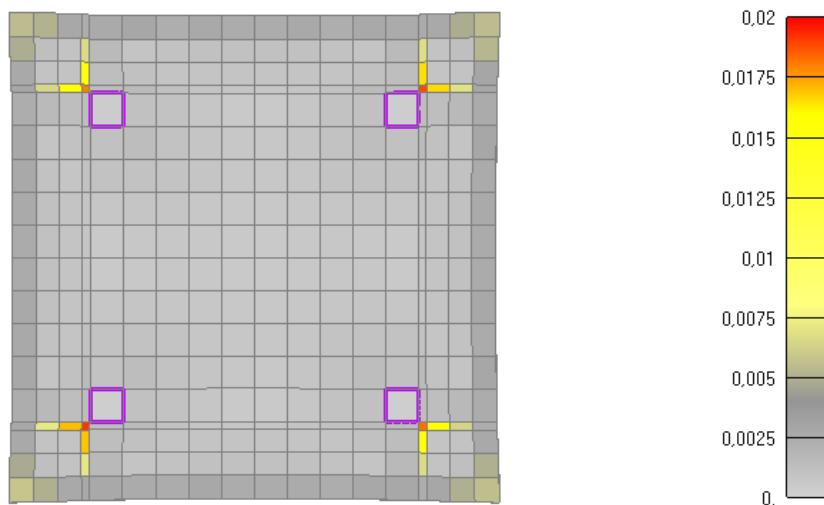
Slika 6.107: Prikaz pukotina za poprečni presjek stupa nakon 30 minuta požara
