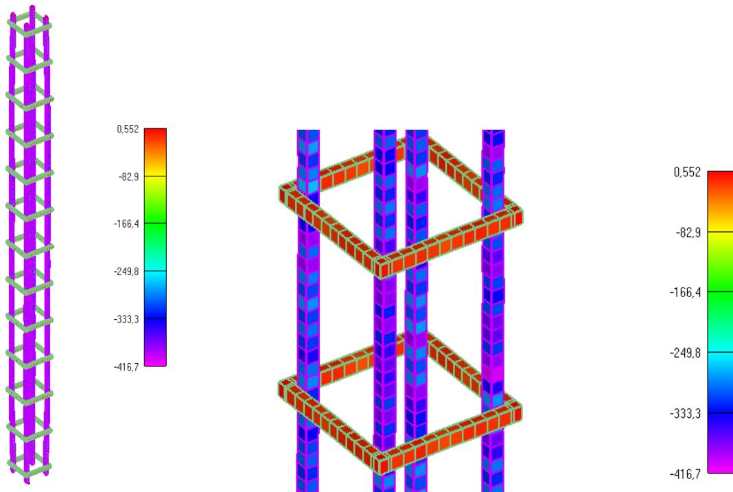
Slika 6.6:Prikaz naprezanja glavne uzdužne armature i spona za djelovanje požara od 115min
