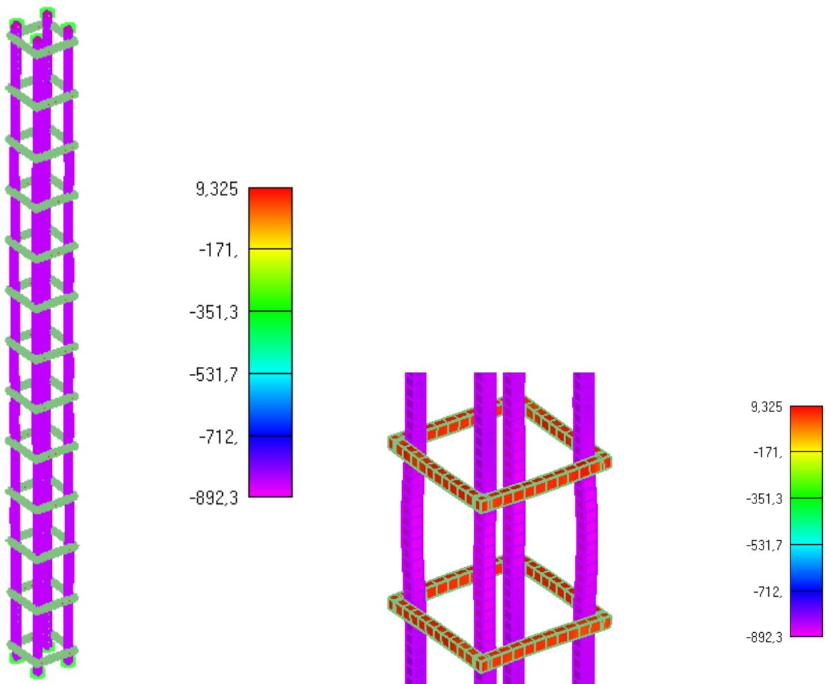
Slika 6.216: Prikaz naprezanja glavne uzdužne armature i spona u trenutku popuštanja stupa
