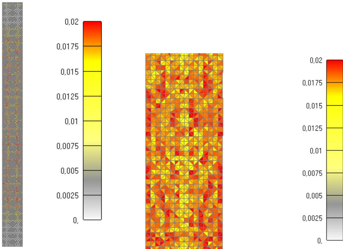
Slika 6.69: Prikaz pukotina za cijeli stup nakon 1090 minuta
