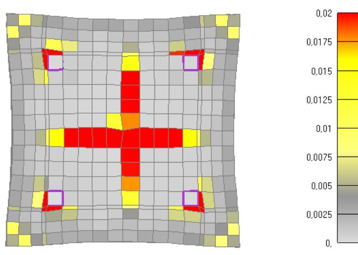
Slika 6.170: Prikaz pukotina za poprečni presjek stupa nakon 60 minuta požara
