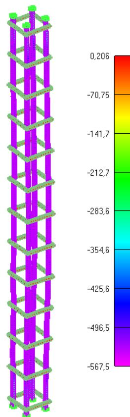
Slika 6.101: Prikaz naprezanja glavne uzdužne armature za djelovanje požara od 60min
