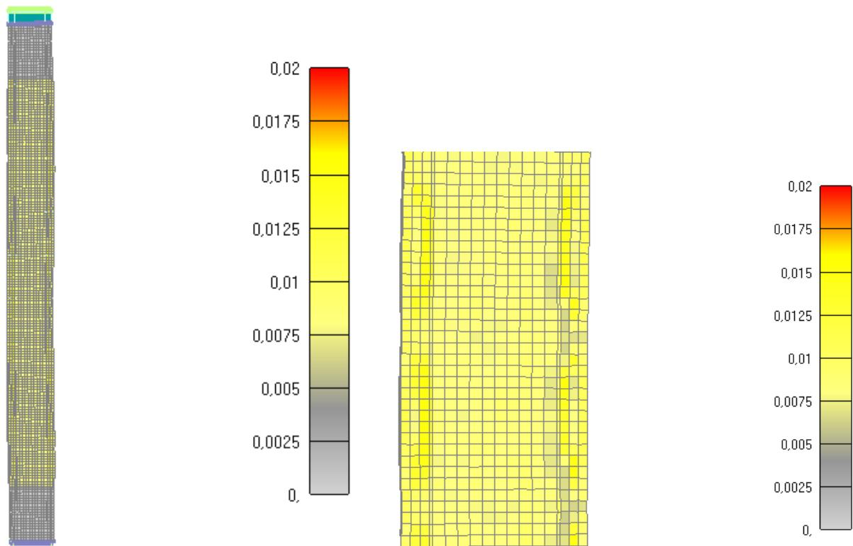
Slika 6.123: Prikaz pukotina za cijeli stup nakon 115 minuta
