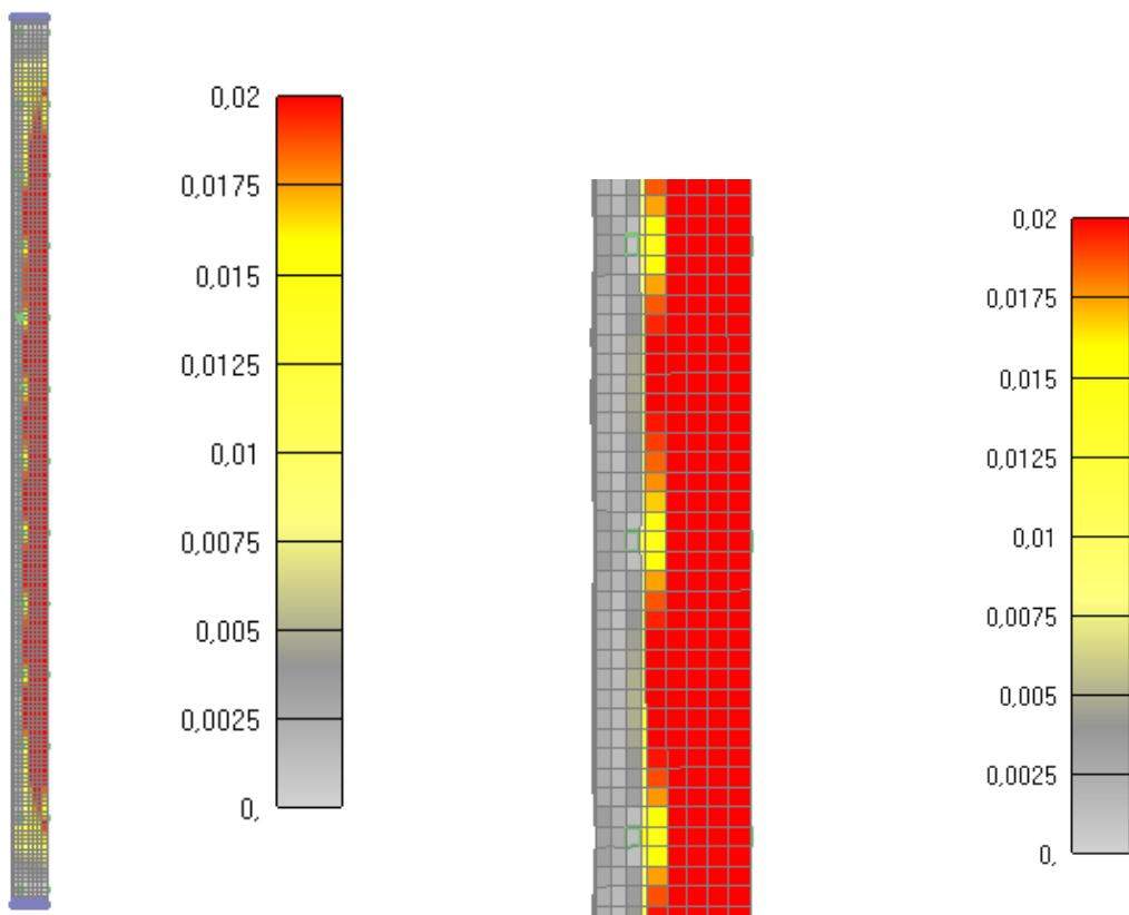
Slika 6.231: Prikaz pukotina za jednu četvrtinu stupa nakon 120 minuta
