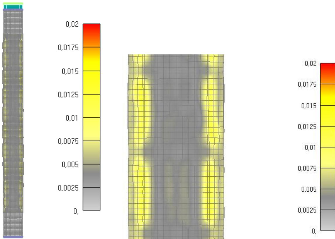
Slika 6.278: Prikaz pukotina za cijeli stup nakon 90 minuta
