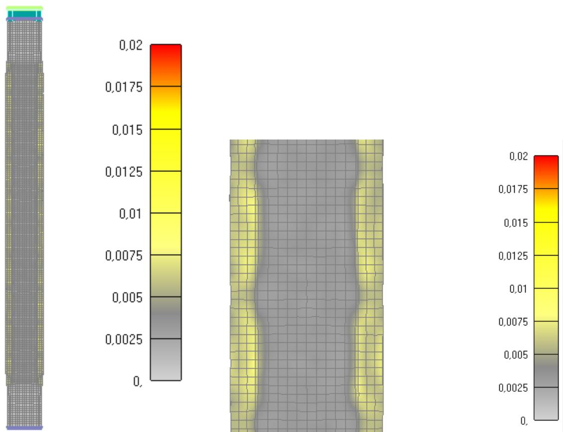
Slika 6.277: Prikaz pukotina za cijeli stup nakon 60 minuta
