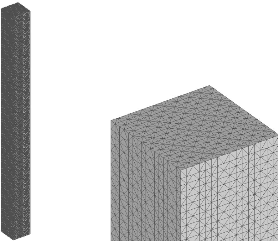
Slika 3.5: Prikaz mreže osnovnog modela (cijeli stup-lijevo) i (detalj stupa-desno)
