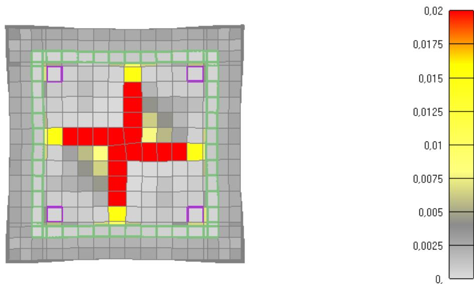
Slika 6.138: Prikaz pukotina za poprečni presjek stupa nakon 60 minuta požara
