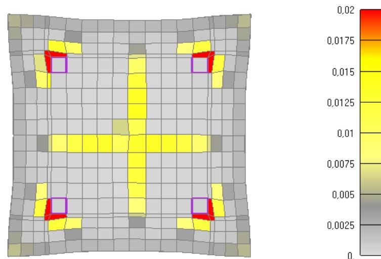
Slika 6.168: Prikaz pukotina za poprečni presjek stupa nakon 30 minuta požara
