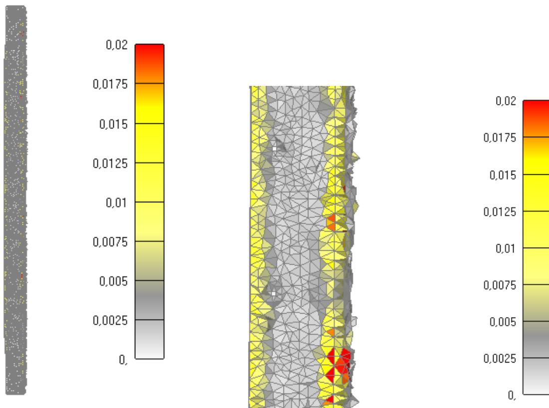
Slika 6.59: Prikaz pukotina za jednu četvrtinu stupa nakon 275 minuta
