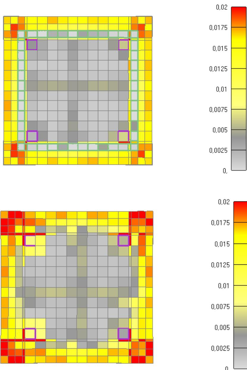
Slika 6.176: Prikaz pukotina za poprečni presjek stupa nakon 1690 minuta (*gore-sa sponama, dolje-bez spona*)-KRAJ KONSTANTNOG HLADENJA
