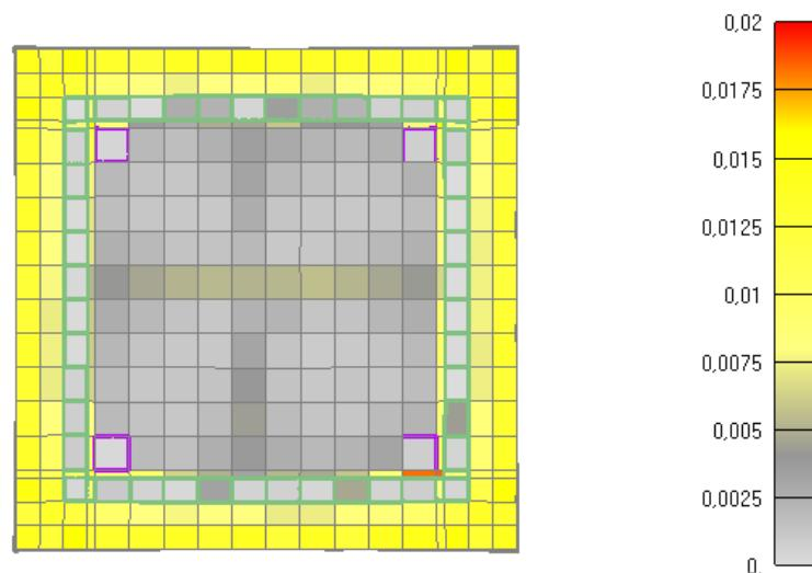
Slika 6.173: Prikaz pukotina za poprečni presjek stupa nakon 250 minuta požara
