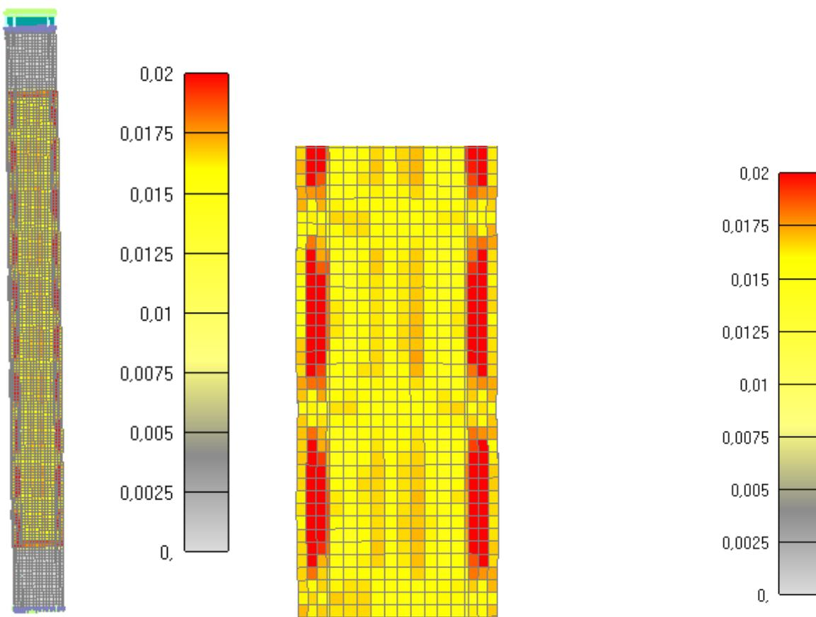
Slika 6.159: Prikaz pukotina za cijeli stup nakon 1690 minuta
