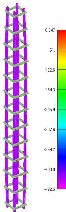
Slika 6.76:Prikaz naprezanja glavne uzdužne armature za djelovanje požara od 175min
