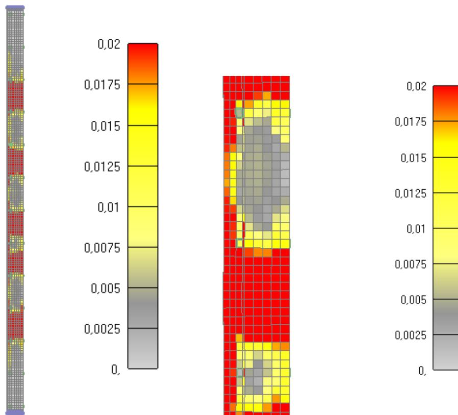
Slika 6.235: Prikaz pukotina za jednu četvrtinu stupa nakon 1810 minuta
