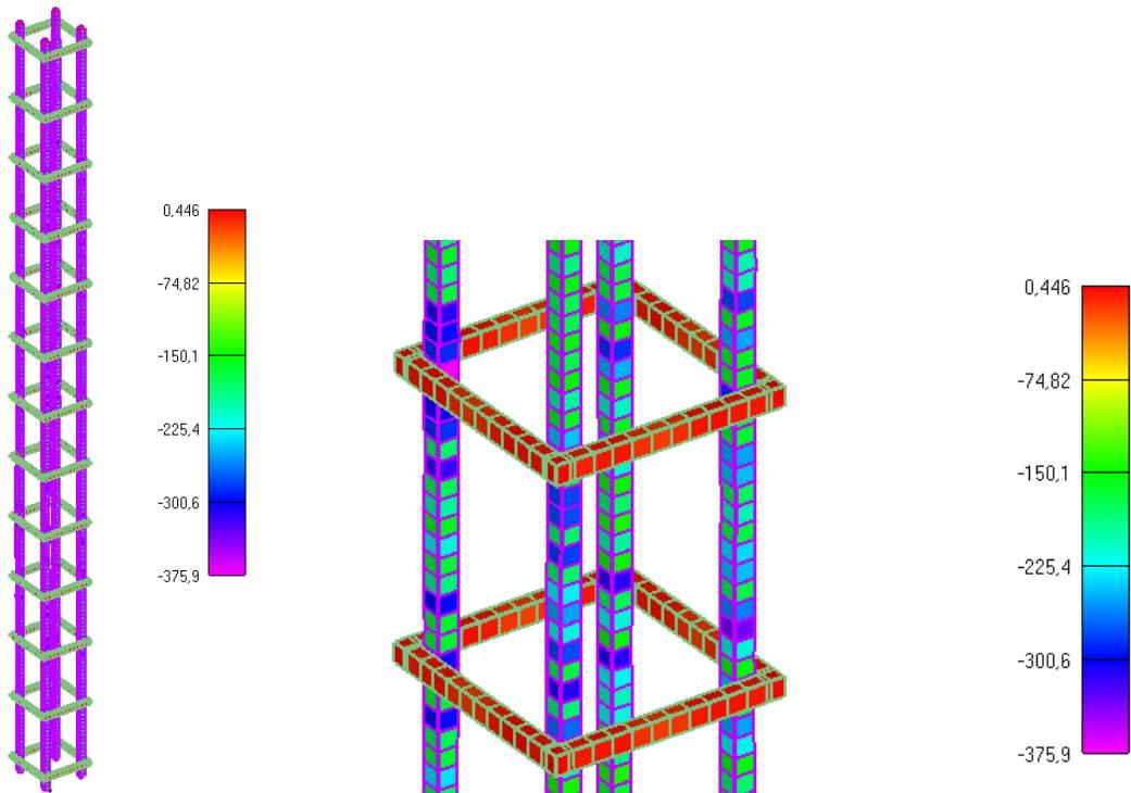
Slika 6.8:Prikaz naprezanja glavne uzdužne armature i spona za djelovanje požara od 895min
