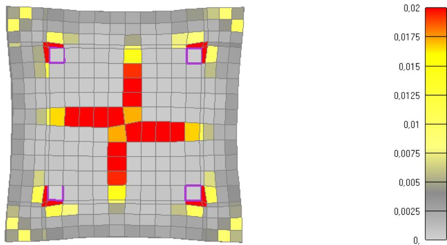
Slika 6.82: Prikaz pukotina za poprečni presjek stupa nakon 60 minuta požara
