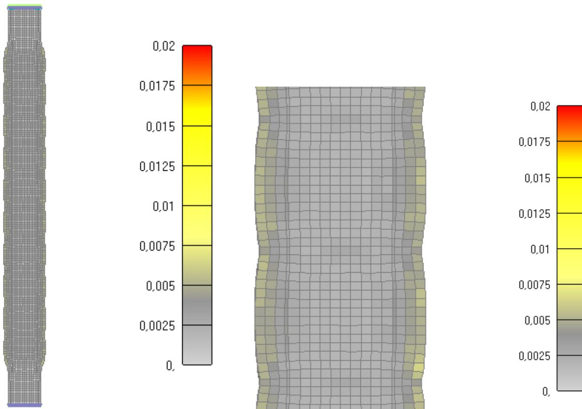
Slika 6.236: Prikaz pukotina za cijeli stup nakon 30 minuta
