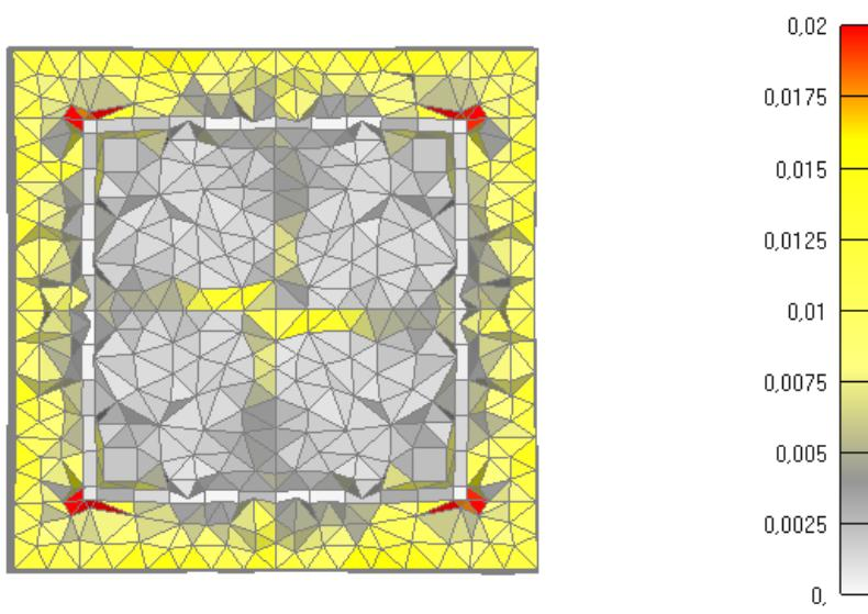
Slika 6.49: Prikaz pukotina za poprečni presjek stupa nakon 275 minuta požara
