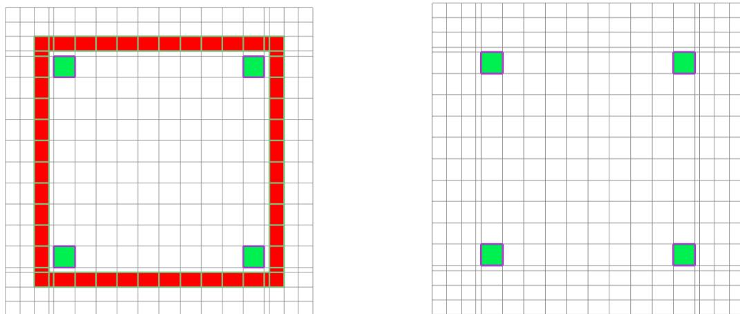
Slika 3.2: Prikaz poprečnog presjeka osnovnog modela (sa sponama-lijevo) i (bez spone- desno)
