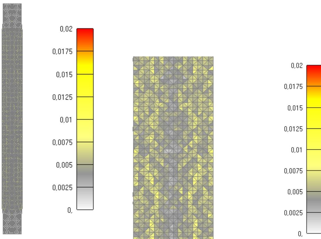
Slika 6.65: Prikaz pukotina za cijeli stup nakon 90 minuta
