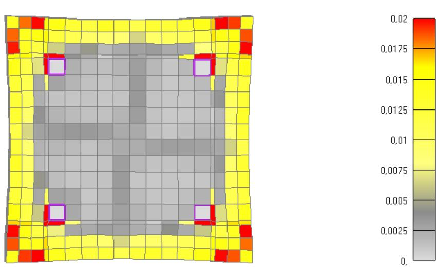
Slika 6.143: Prikaz pukotina za poprečni presjek stupa nakon 250 minuta požara
