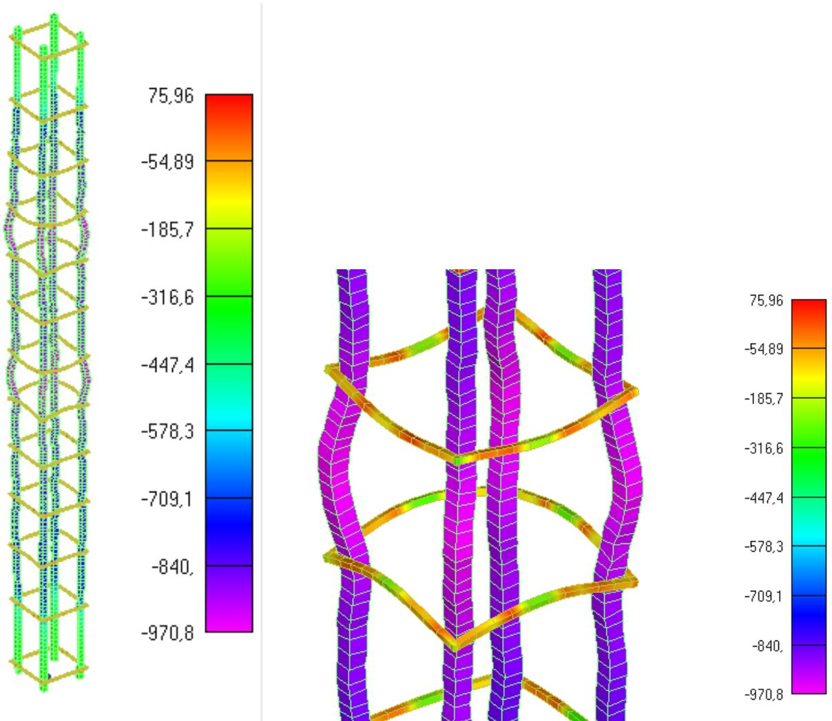
Slika 6.43: Prikaz naprezanja glavne uzdužne armature i spona u trenutku popuštanja stupa
