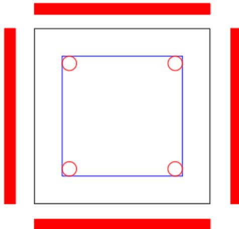
Slika 3.2: Prikaz površina koje su izložene utjecaju visokih temperatura i djelovanju požara
