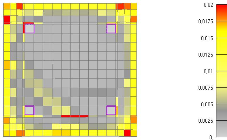
Slika 6.111: Prikaz pukotina za poprečni presjek stupa nakon 175 minuta požara
