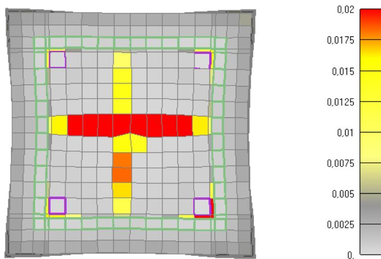
Slika 6.169: Prikaz pukotina za poprečni presjek stupa nakon 60 minuta požara
