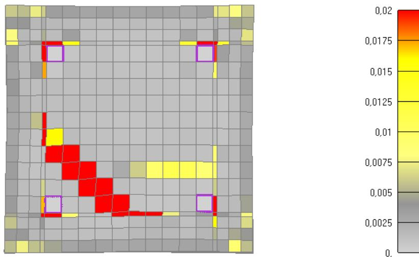
Slika 6.109: Prikaz pukotina za poprečni presjek stupa nakon 60 minuta požara
