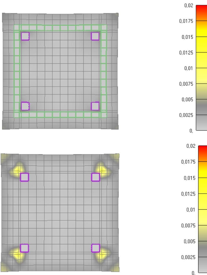
Slika 6.249: Prikaz pukotina za poprečni presjek stupa nakon 30 minuta požara
