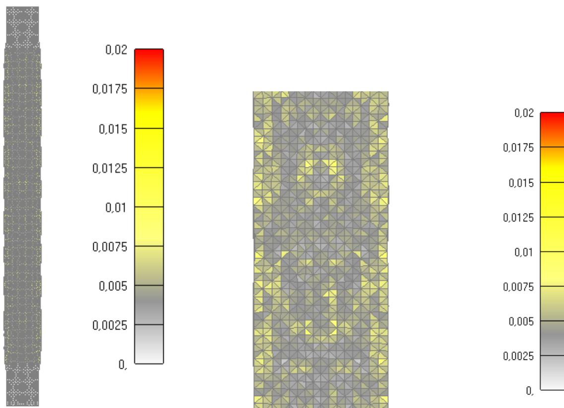
Slika 6.64: Prikaz pukotina za cijeli stup nakon 60 minuta
