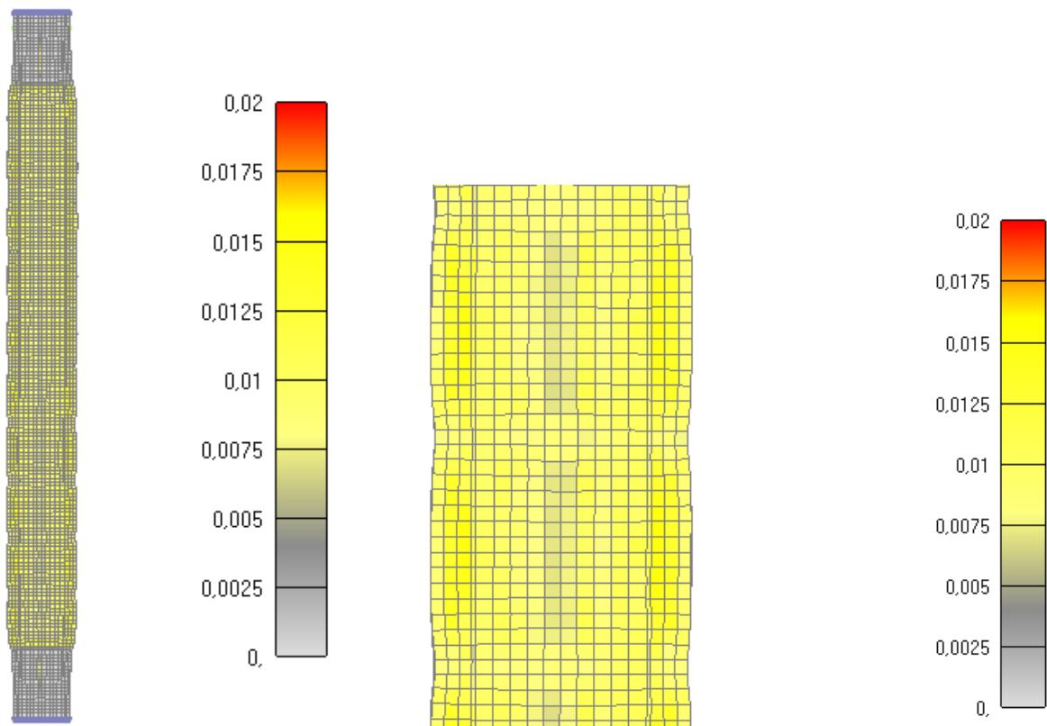
Slika 6.156: Prikaz pukotina za cijeli stup nakon 180 minuta
