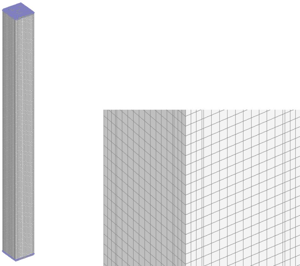
Slika 3.4: Prikaz mreže osnovnog modela (cijeli stup-lijevo) i (detalj stupa-desno)
