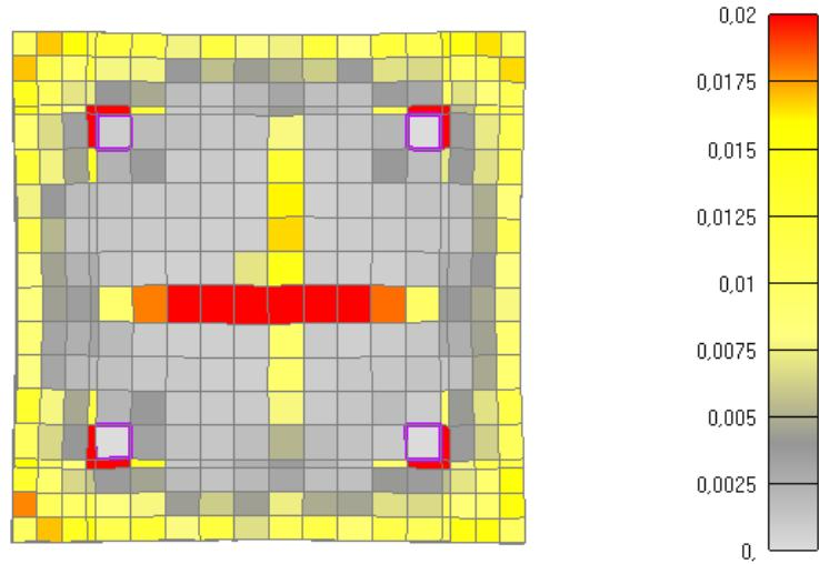
Slika 6.172: Prikaz pukotina za poprečni presjek stupa nakon 180 minuta požara
