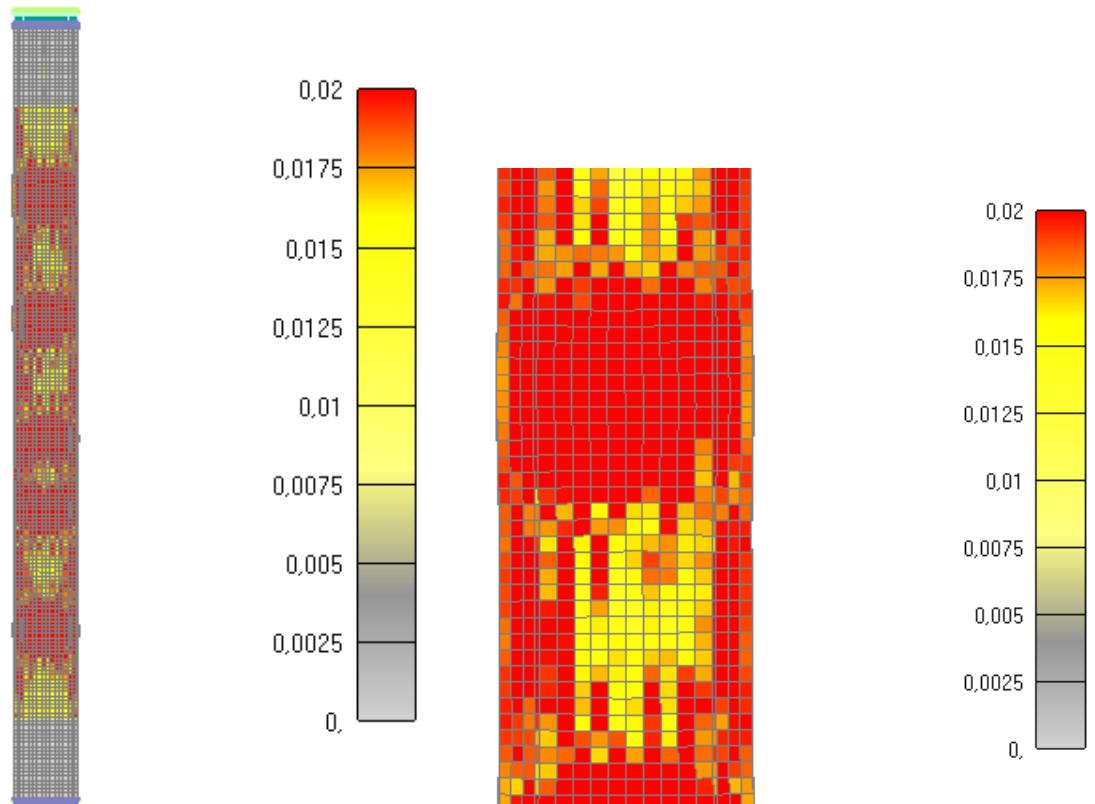
Slika 6.241: Prikaz pukotina za cijeli stup nakon 370 minuta
