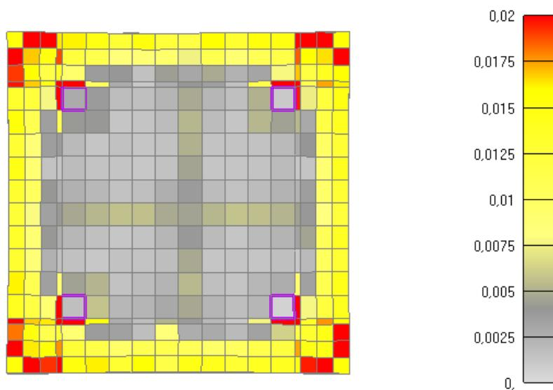
Slika 6.174: Prikaz pukotina za poprečni presjek stupa nakon 250 minuta požara
