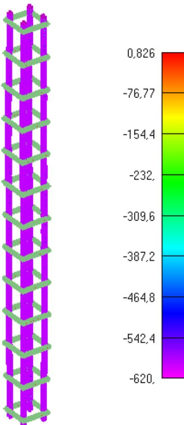
Slika 6.265: Prikaz naprezanja glavne uzdužne armature za djelovanje požara od 120min
