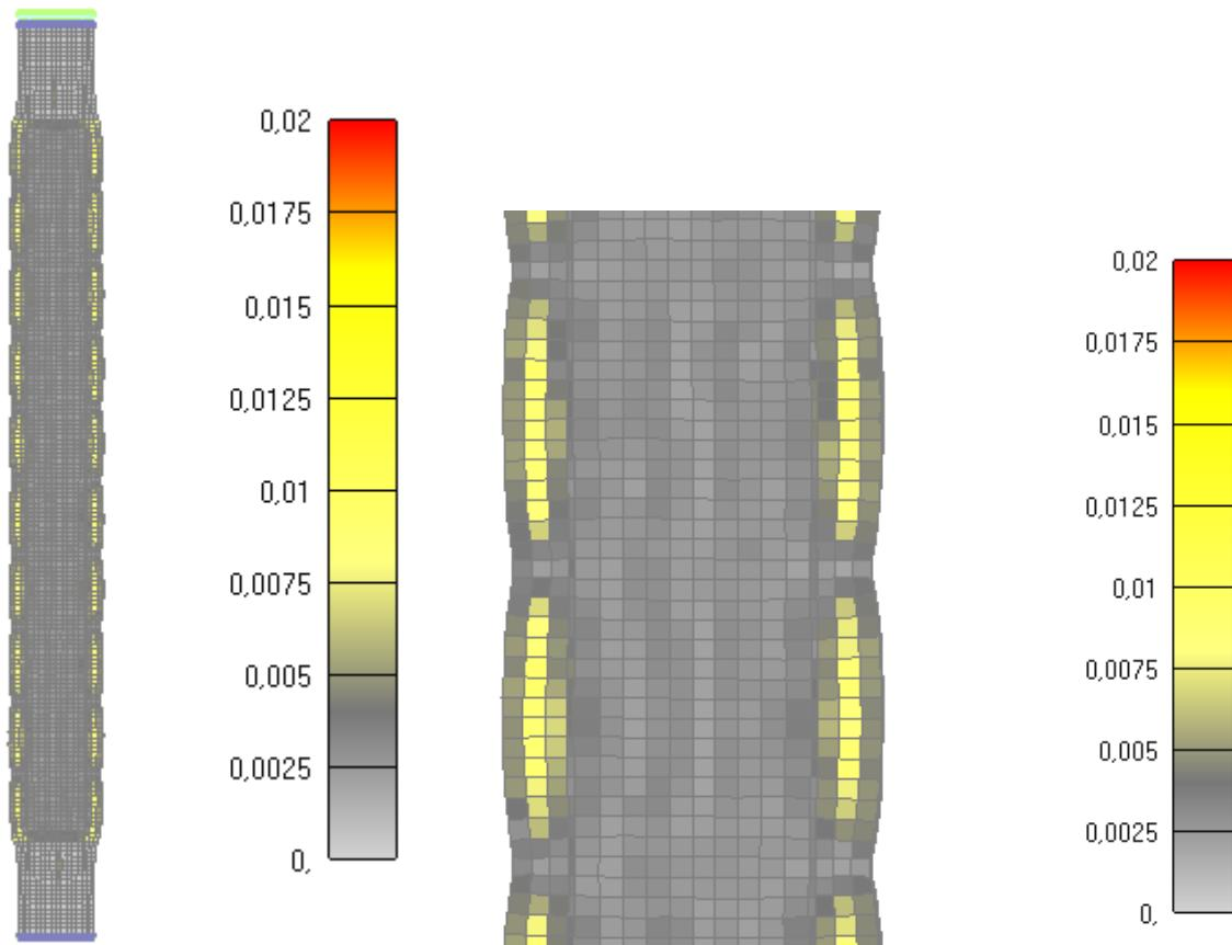
Slika 6.259: Prikaz pukotina za cijeli stup nakon 60 minuta
