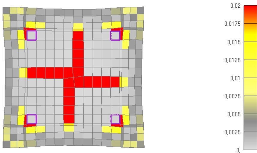
Slika 6.139: Prikaz pukotina za poprečni presjek stupa nakon 60 minuta požara
