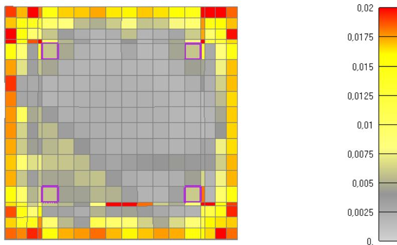
Slika 6.113: Prikaz pukotina za poprečni presjek stupa nakon 895 minuta požara
