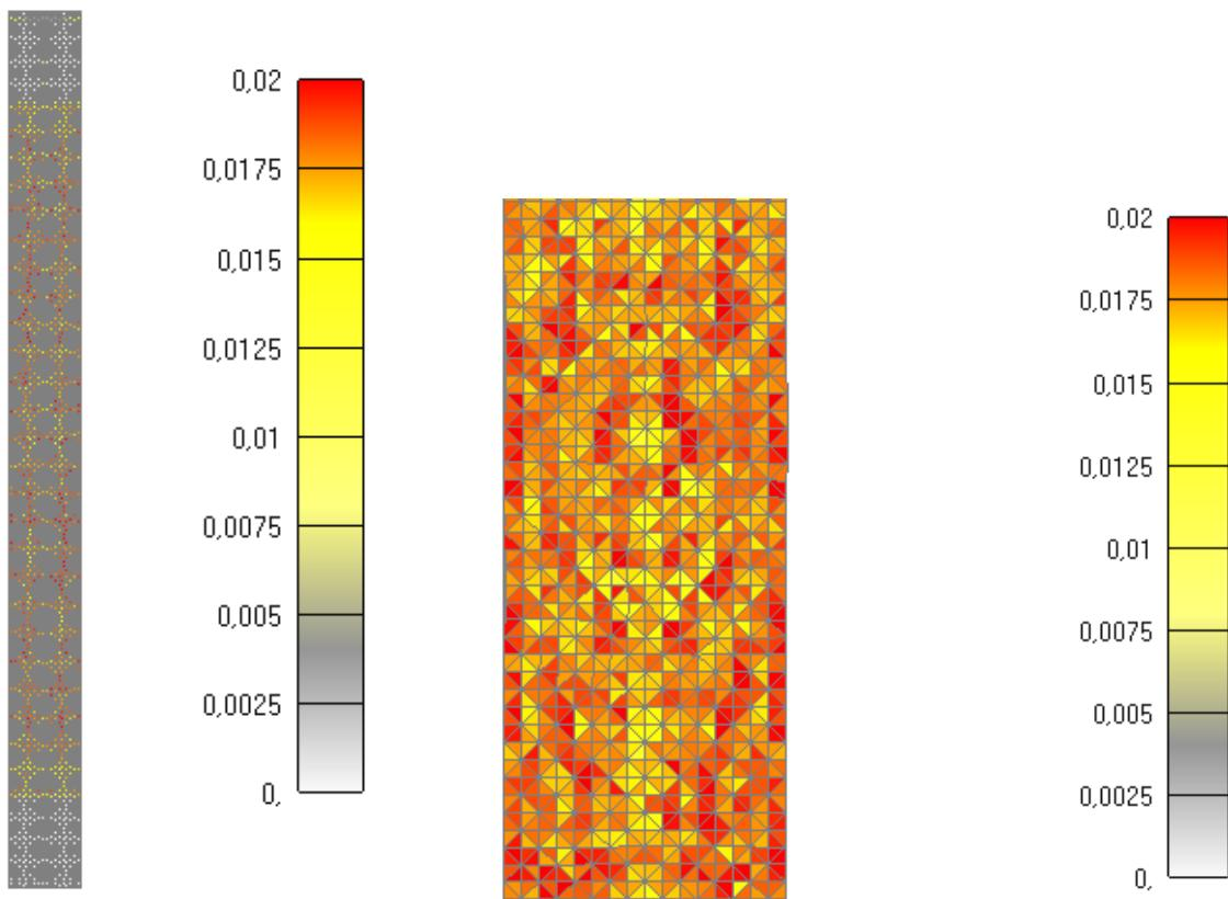
Slika 6.70: Prikaz pukotina za cijeli stup nakon 1810 minuta
