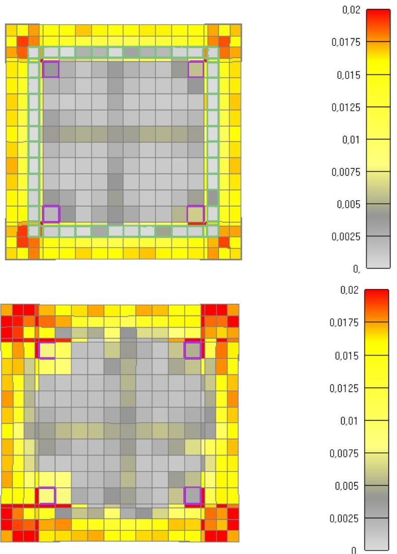
Slika 6.175: Prikaz pukotina za poprečni presjek stupa nakon 1030 minuta
