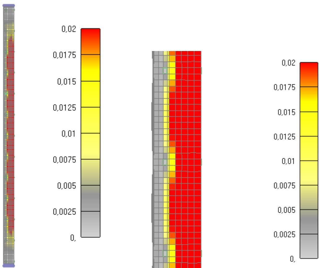
Slika 6.229: Prikaz pukotina za jednu četvrtinu stupa nakon 60 minuta
