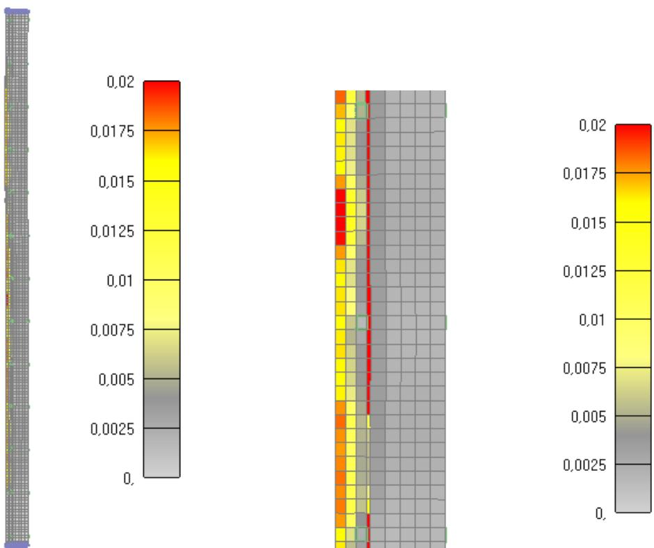
Slika 6.120: Prikaz pukotina za jednu četvrtinu stupa nakon 1615 minuta
