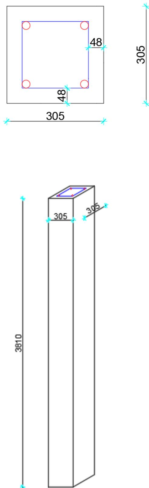
Slika 2.1: Visina i poprečni presjek cijelog AB stupa
