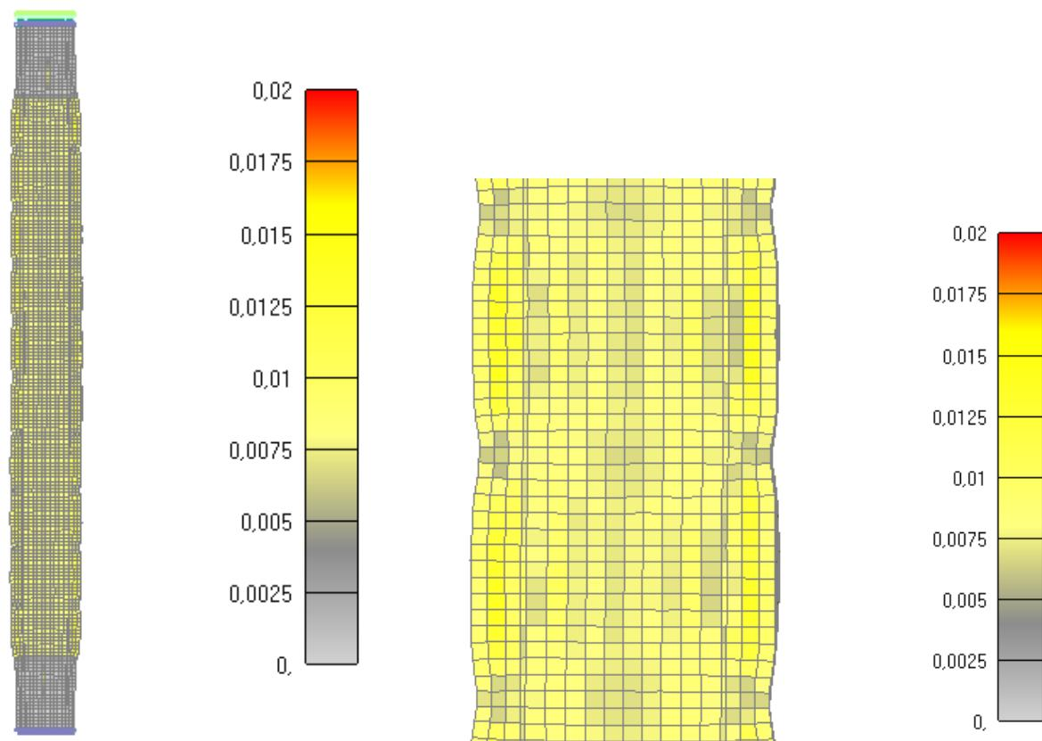
Slika 6.96: Prikaz pukotina za cijeli stup nakon 115 minuta
