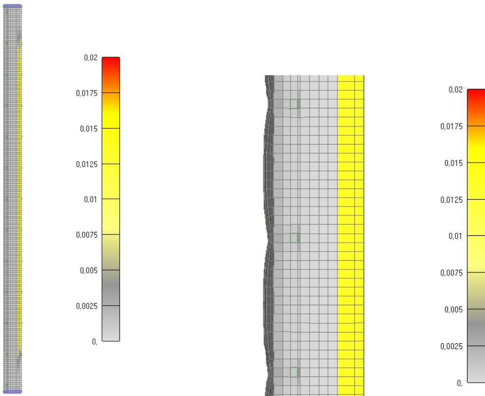
Slika 6.19: Prikaz pukotina za jednu četvrtinu stupa nakon 30 minuta
