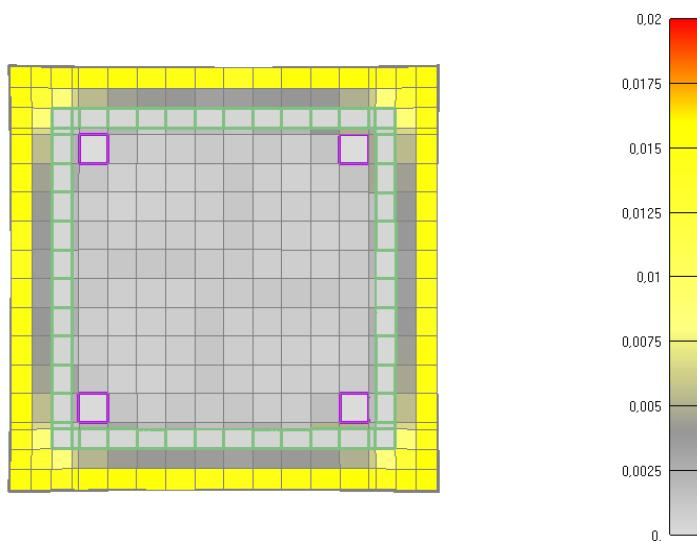
Slika 6.16: Prikaz pukotina za poprečni presjek stupa nakon 895 minuta
