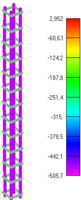
Slika 6.213: Prikaz naprezanja glavne uzdužne armature za djelovanje požara od 370min
