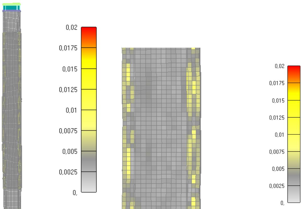
Slika 6.203: Prikaz pukotina za cijeli stup nakon 60 minuta
