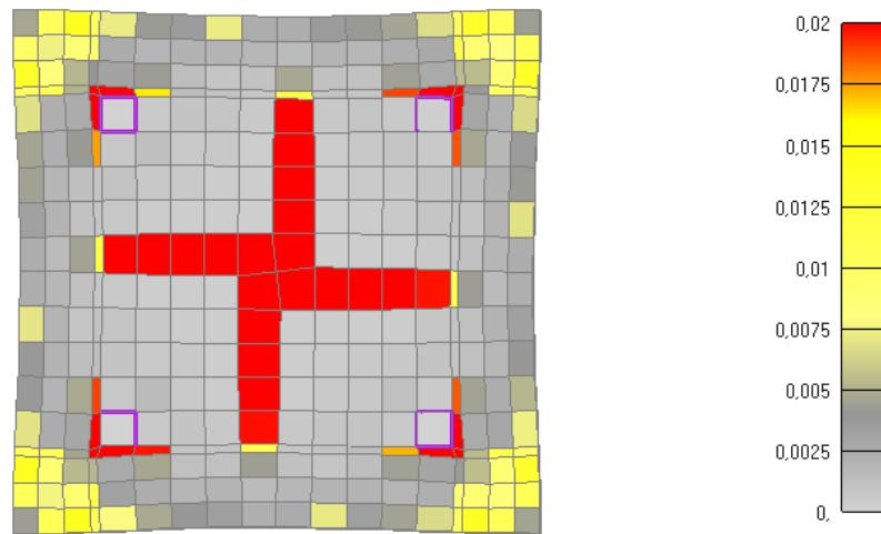
Slika 6.221: Prikaz pukotina za poprečni presjek stupa nakon 120 minuta požara
