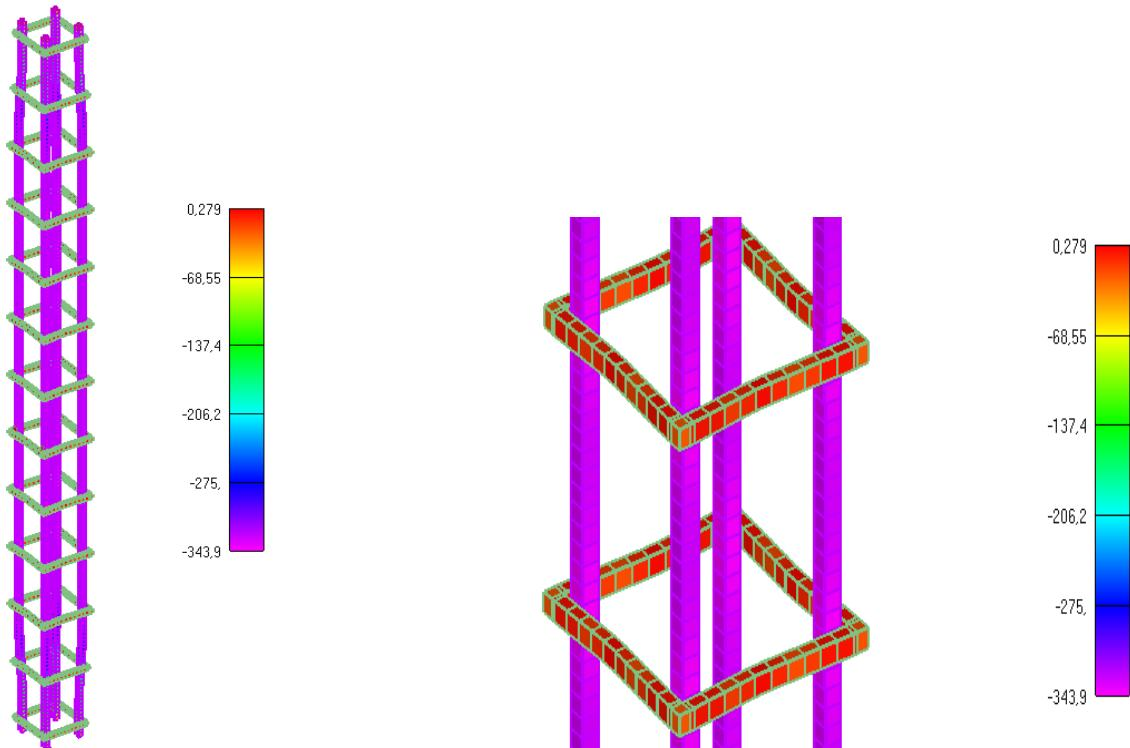
Slika 6.4: Prikaz naprezanja glavne uzdužne armature i spona za djelovanje požara od 30min
