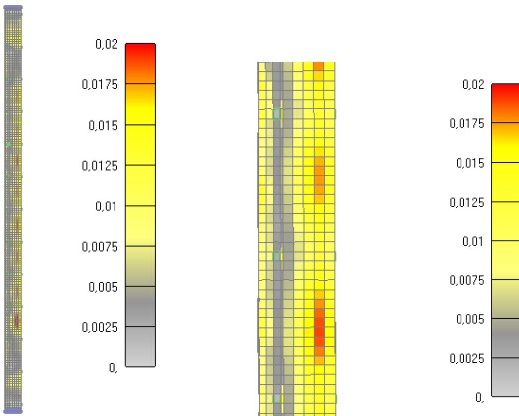
Slika 6.232: Prikaz pukotina za jednu četvrtinu stupa nakon 275 minuta
