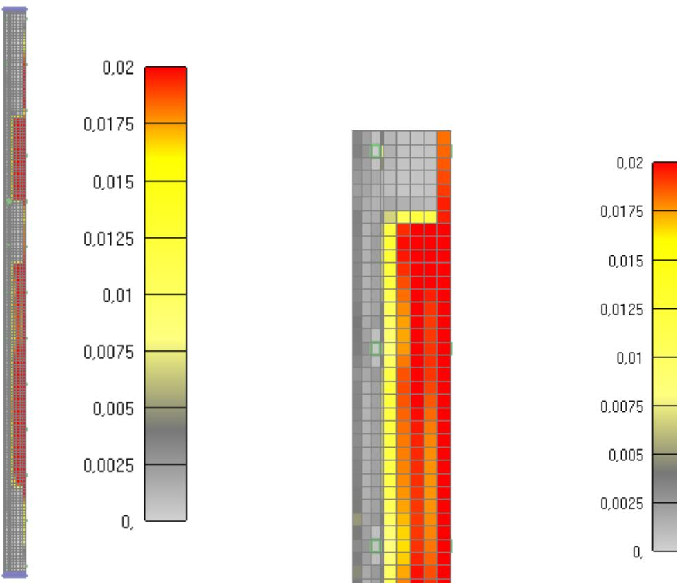
Slika 6.257: Prikaz pukotina za jednu četvrtinu stupa nakon 120 minuta
