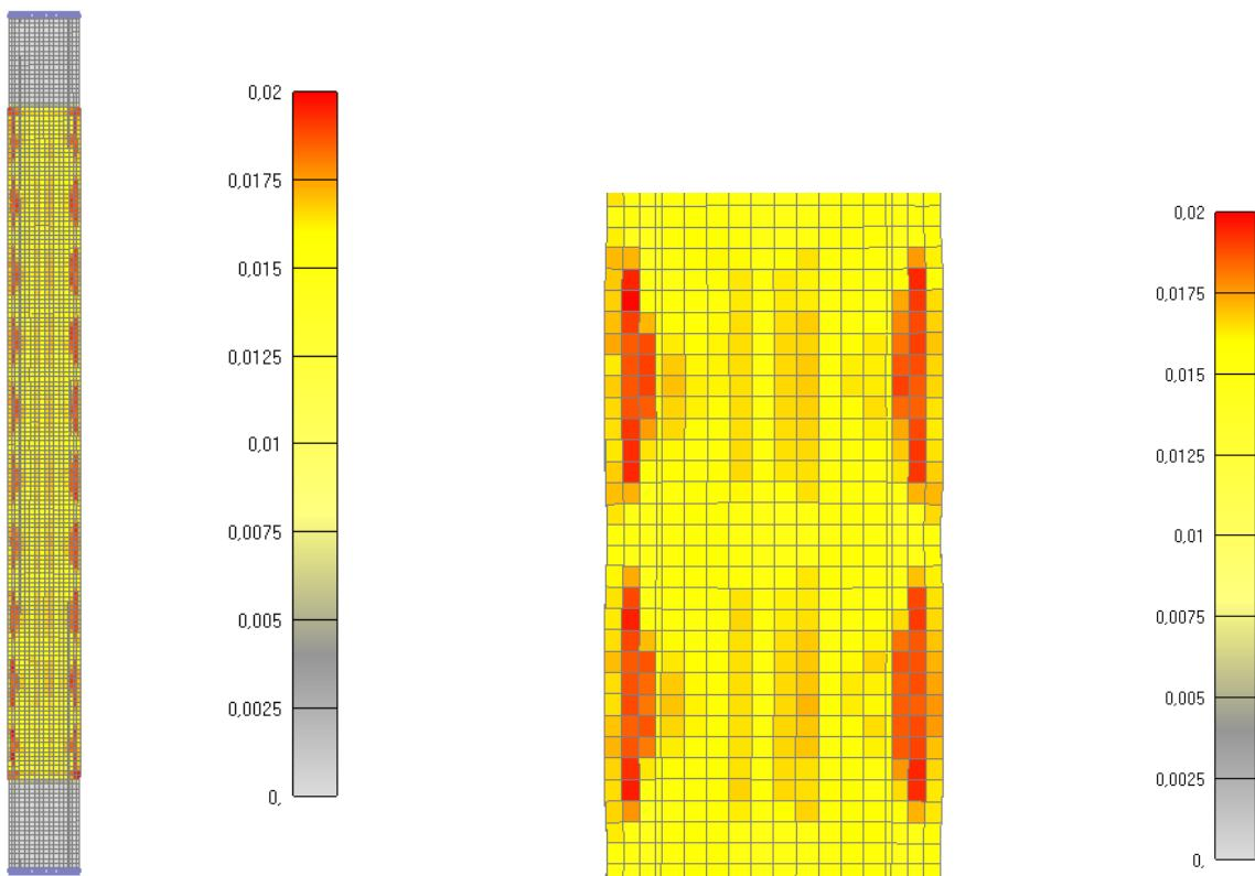
Slika 6.30: Prikaz pukotina za cijeli stup nakon 1615 minuta
