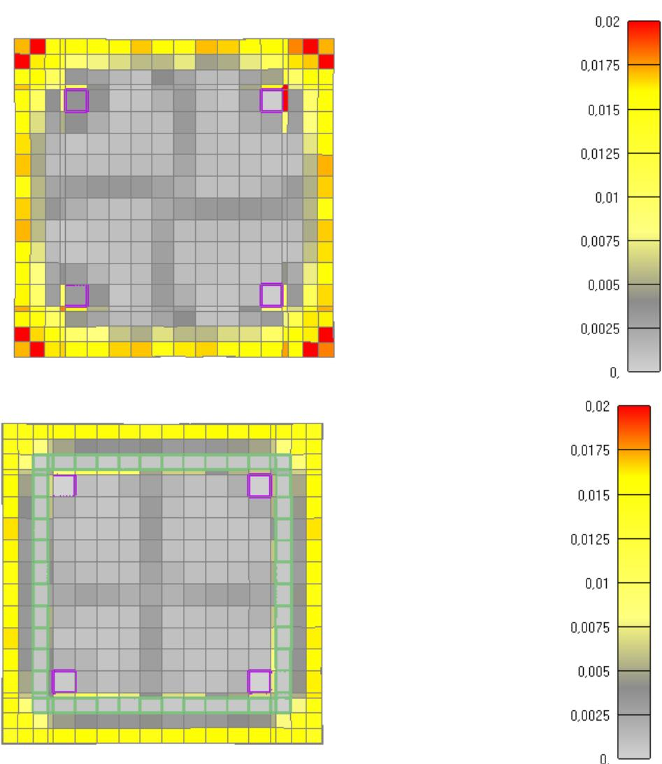
Slika 6.87: Prikaz pukotina za poprečni presjek stupa nakon 1615 minuta
