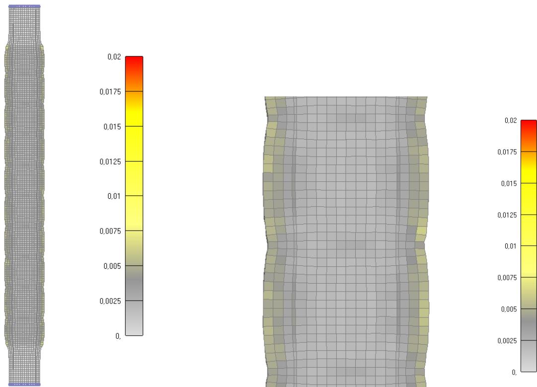
Slika 6.25: Prikaz pukotina za cijeli stup nakon 30 minuta
