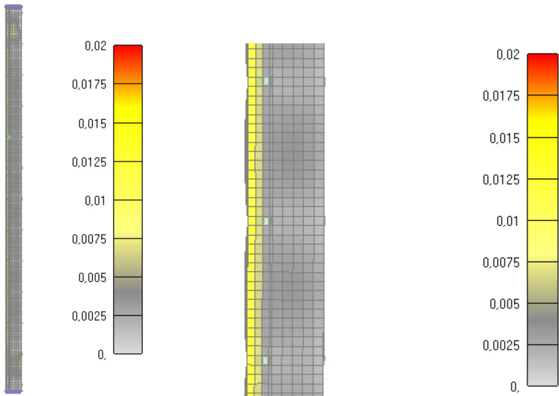
Slika 6.150: Prikaz pukotina za jednu četvrtinu stupa nakon 250 minuta
