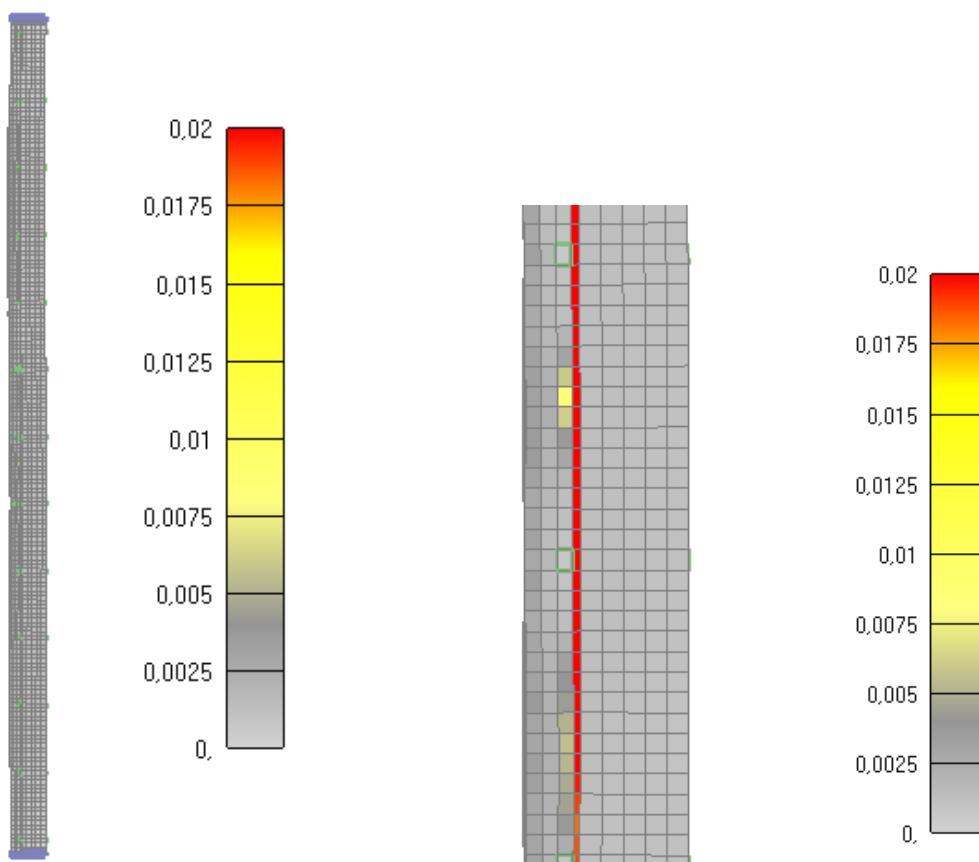
Slika 6.116: Prikaz pukotina za jednu četvrtinu stupa nakon 60 minuta
