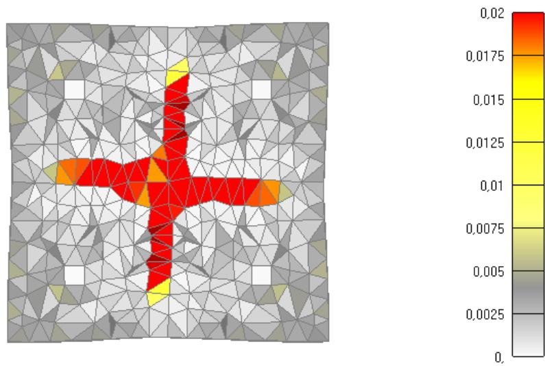
Slika 6.47: Prikaz pukotina za poprečni presjek stupa nakon 90 minuta požara
