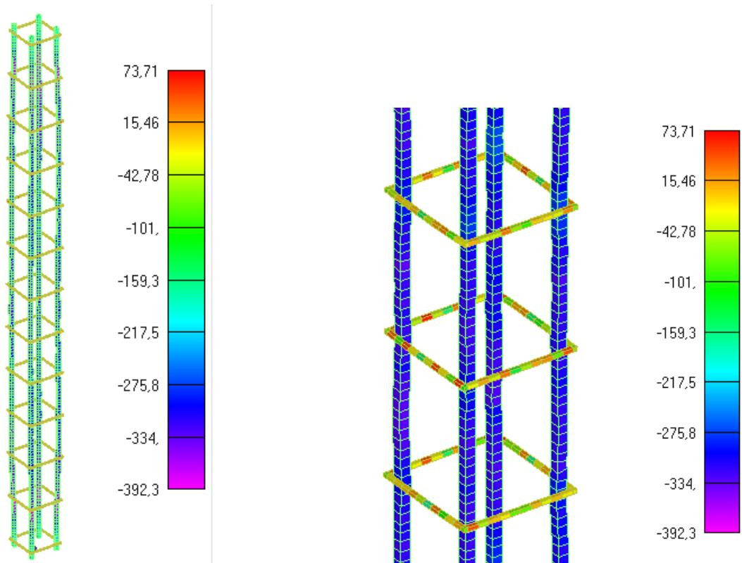
Slika 6.39:Prikaz naprezanja glavne uzdužne armature i spona za djelovanje požara od 275min
