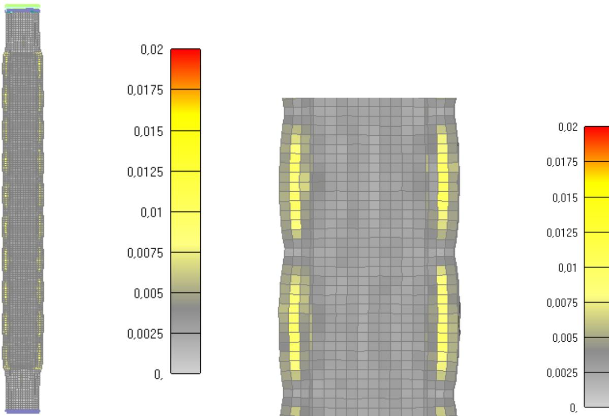
Slika 6.95: Prikaz pukotina za cijeli stup nakon 60 minuta
