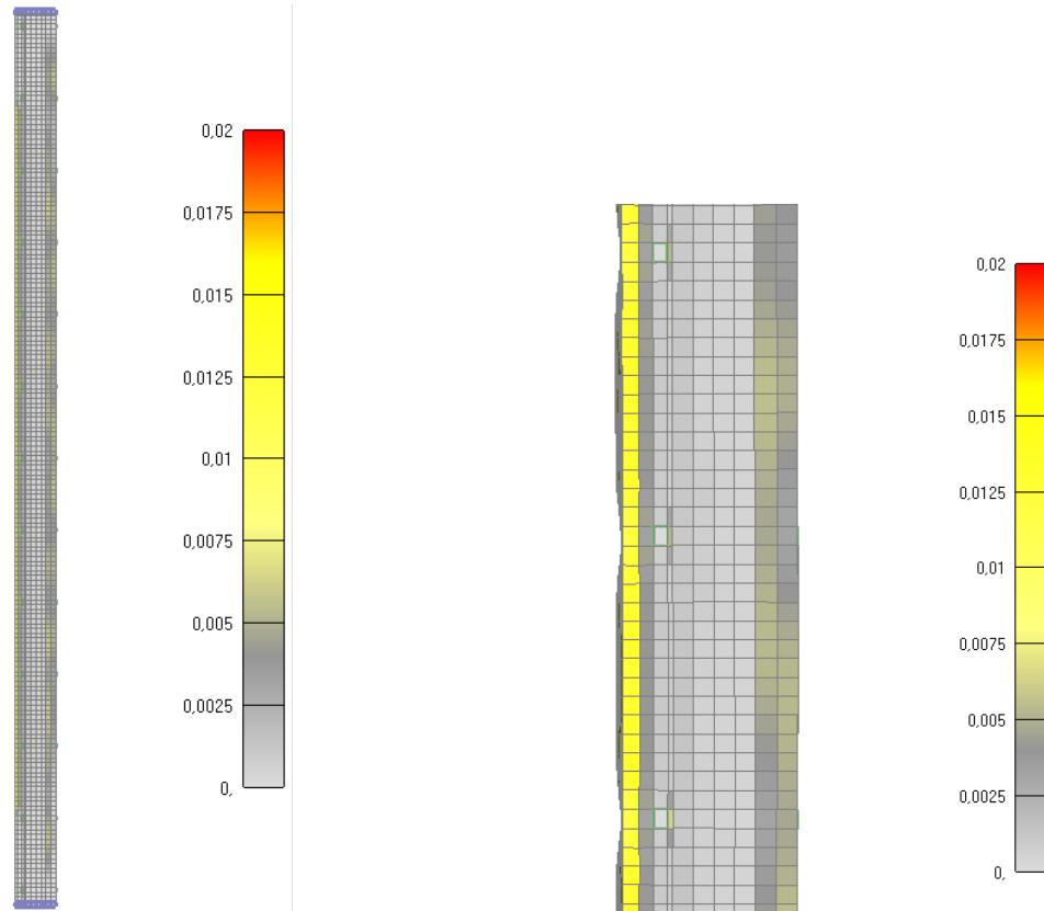
Slika 6.22: Prikaz pukotina za jednu četvrtinu stupa nakon 175 minuta
