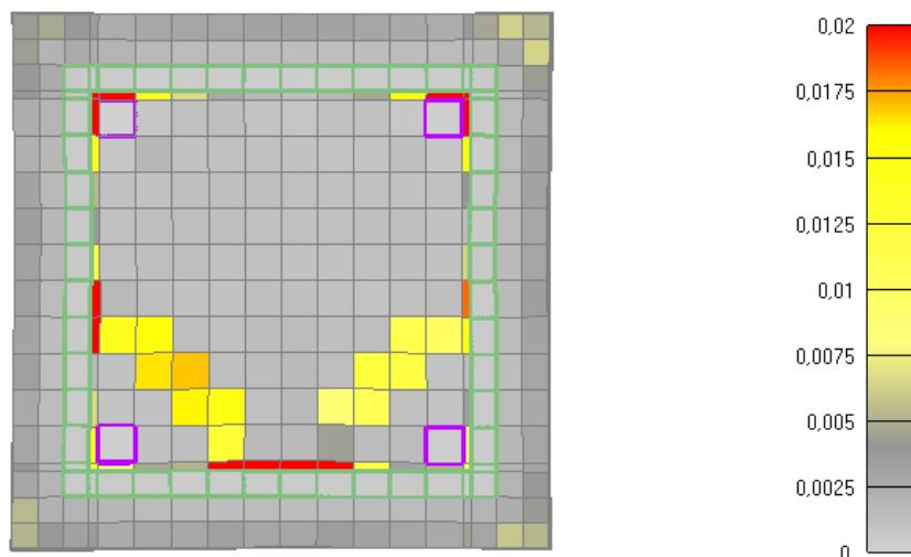
Slika 6.108: Prikaz pukotina za poprečni presjek stupa nakon 60 minuta požara
