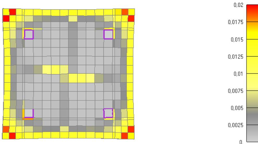
Slika 6.84: Prikaz pukotina za poprečni presjek stupa nakon 175 minuta požara
