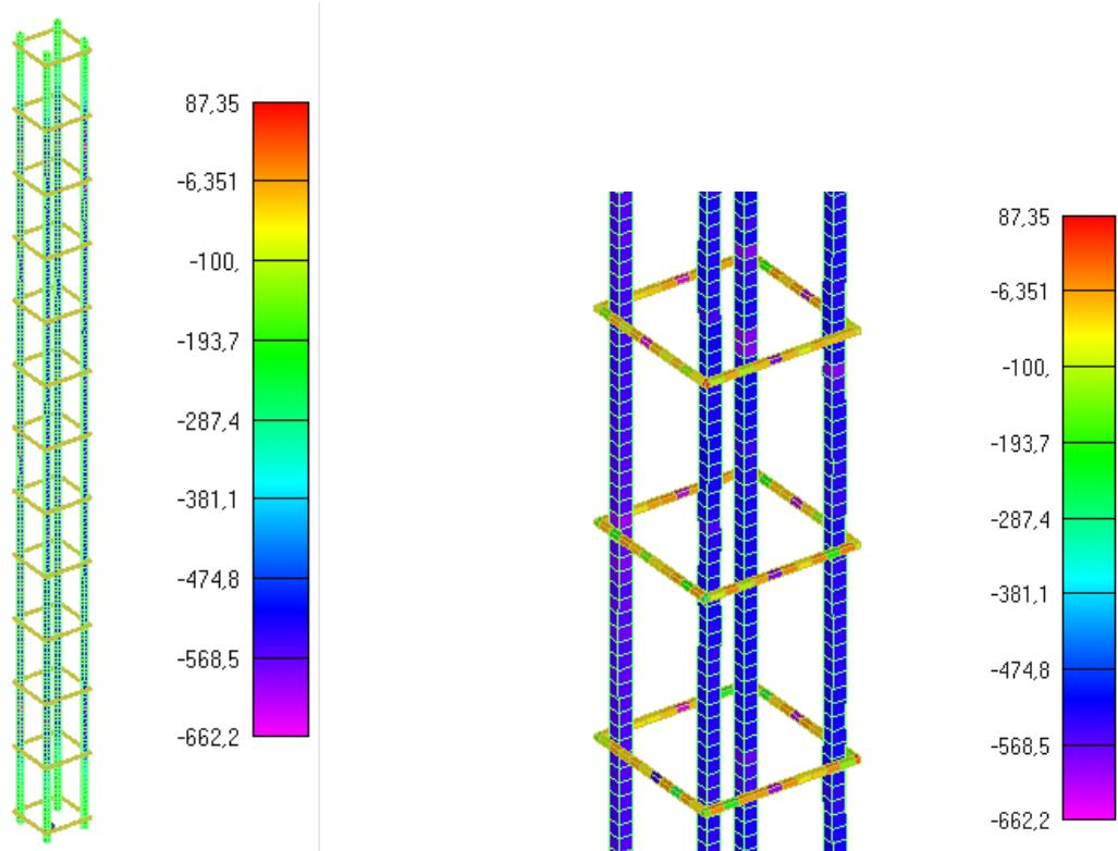
Slika 6.41:Prikaz naprezanja glavne uzdužne armature i spona za djelovanje požara od 1090min
