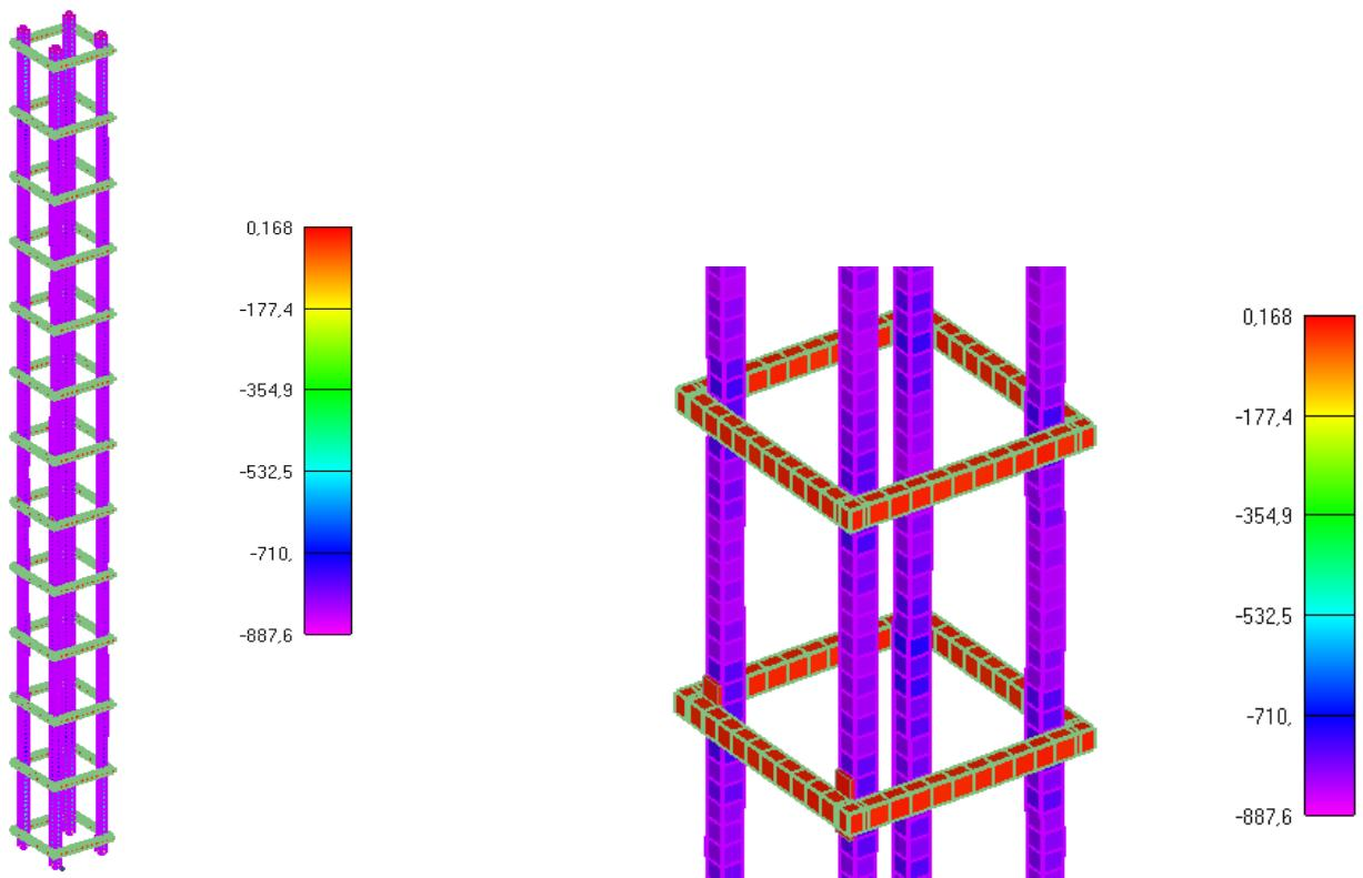
Slika 6.10: Prikaz naprezanja glavne uzdužne armature i spona u trenutku popuštanja stupa
