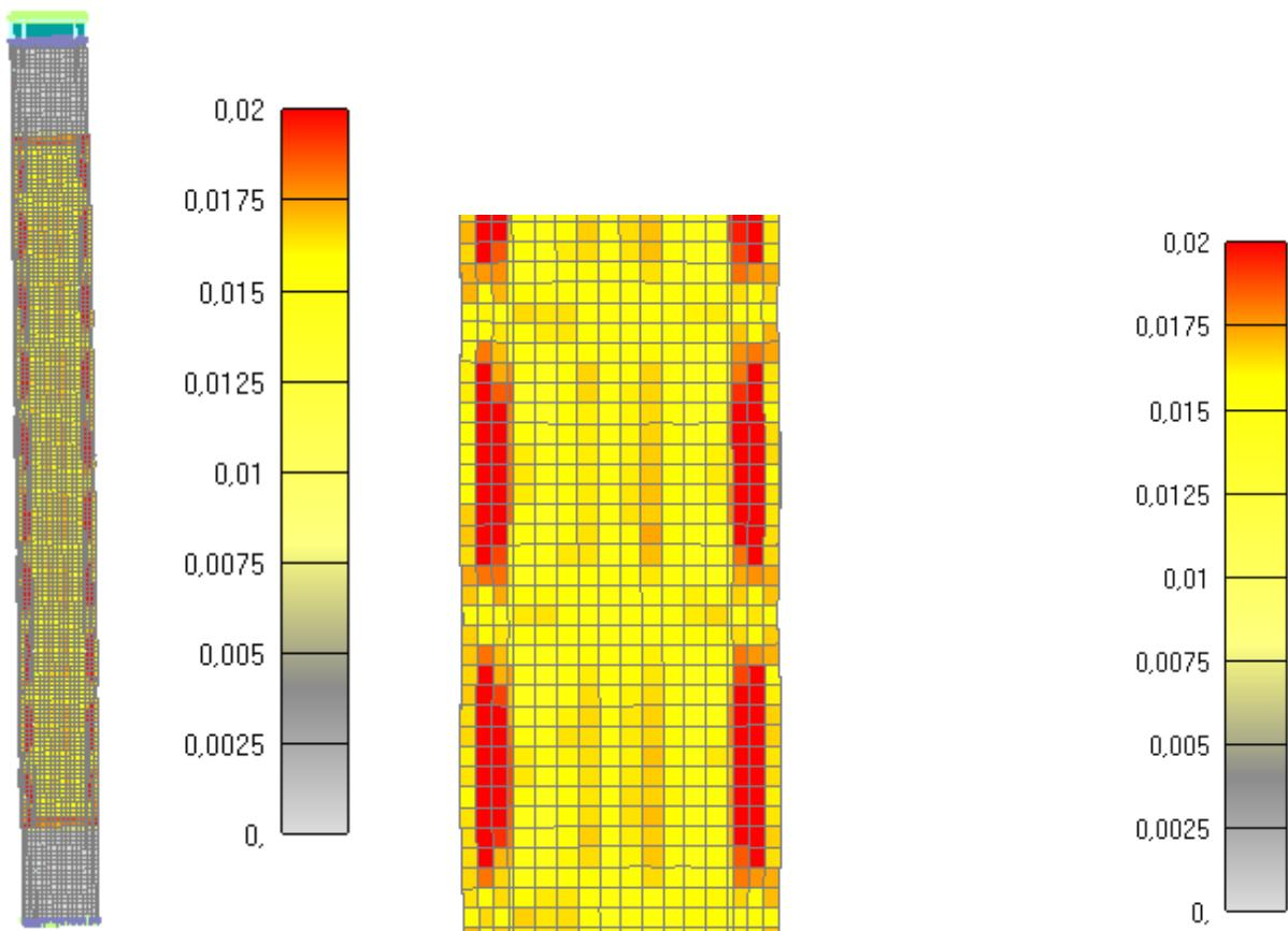
Slika 6.158: Prikaz pukotina za cijeli stup nakon 1030 minuta
