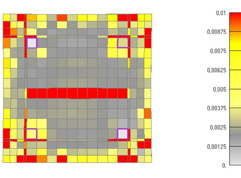
Slika 6.271: Prikaz pukotina za poprečni presjek stupa nakon 120 minuta požara
