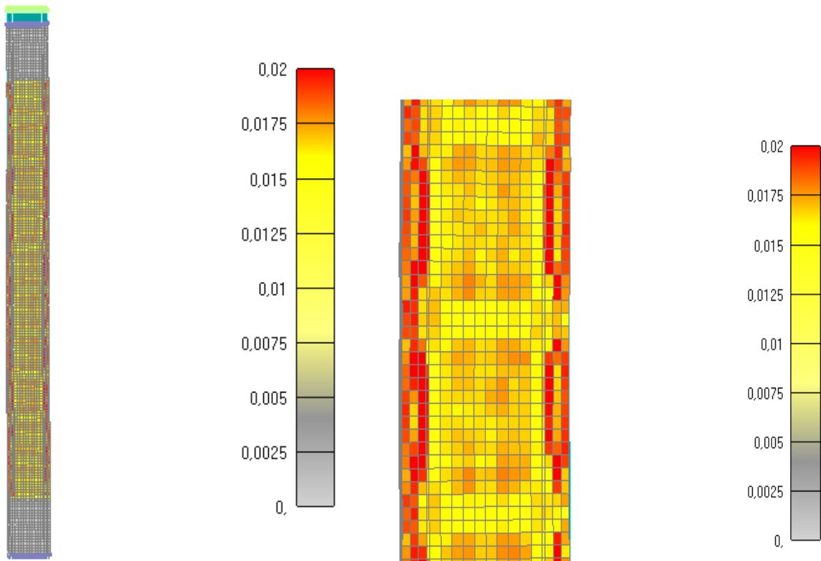
Slika 6.125: Prikaz pukotina za cijeli stup nakon 895 minuta
