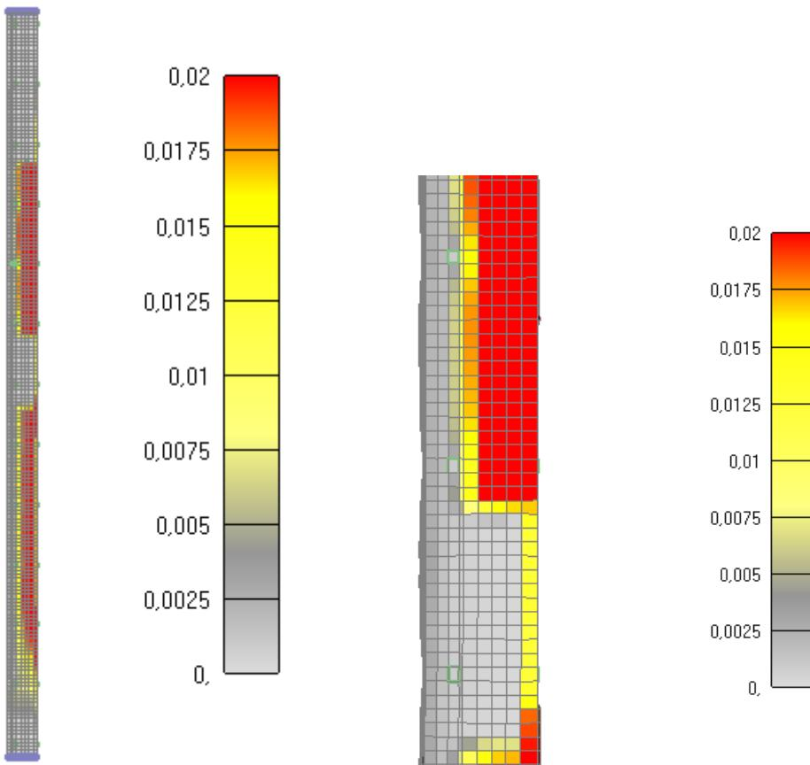
Slika 6.178: Prikaz pukotina za jednu četvrtinu stupa nakon 60 minuta
