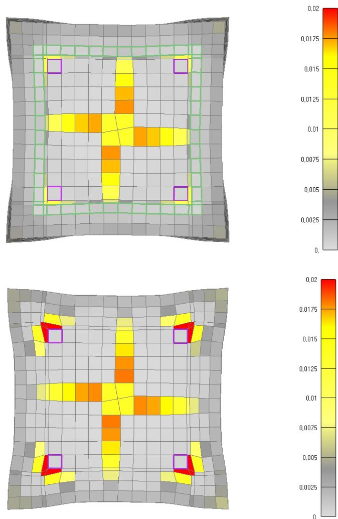
Slika 6.11: Prikaz pukotina za poprečni presjek stupa nakon 30 minuta požara
