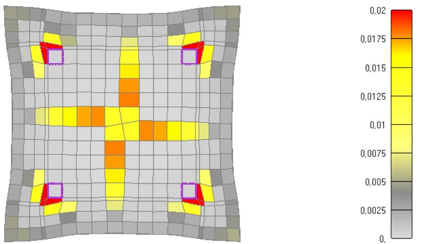
Slika 6.137: Prikaz pukotina za poprečni presjek stupa nakon 30 minuta požara
