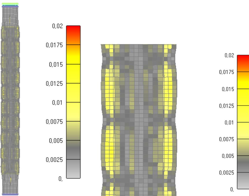
Slika 6.260: Prikaz pukotina za cijeli stup nakon 90 minuta
