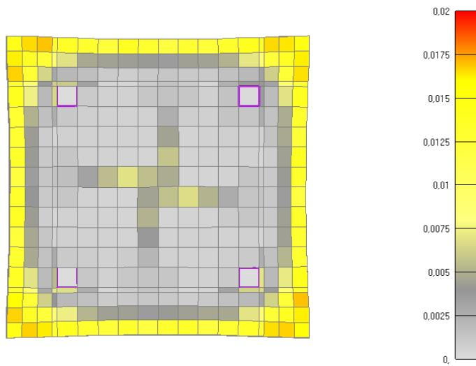
Slika 6.15: Prikaz pukotina za poprečni presjek stupa nakon 175 minuta
