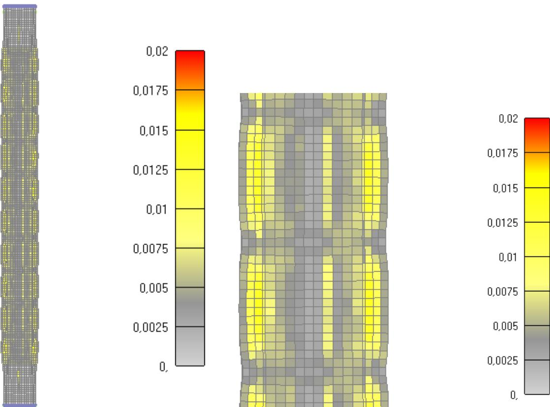
Slika 6.239: Prikaz pukotina za cijeli stup nakon 120 minuta
