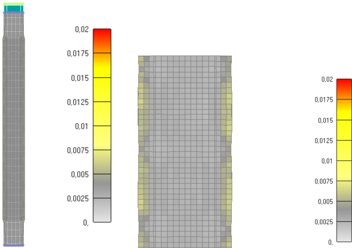
Slika 6.202: Prikaz pukotina za cijeli stup nakon 30 minuta
