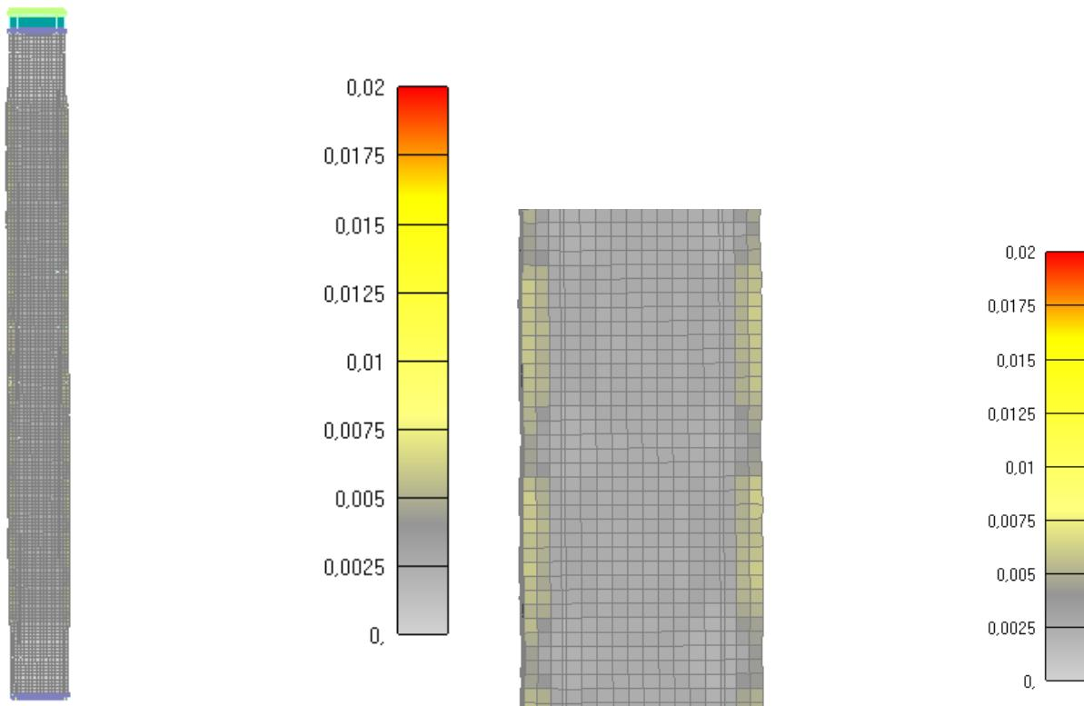
Slika 6.121: Prikaz pukotina za cijeli stup nakon 30 minuta
