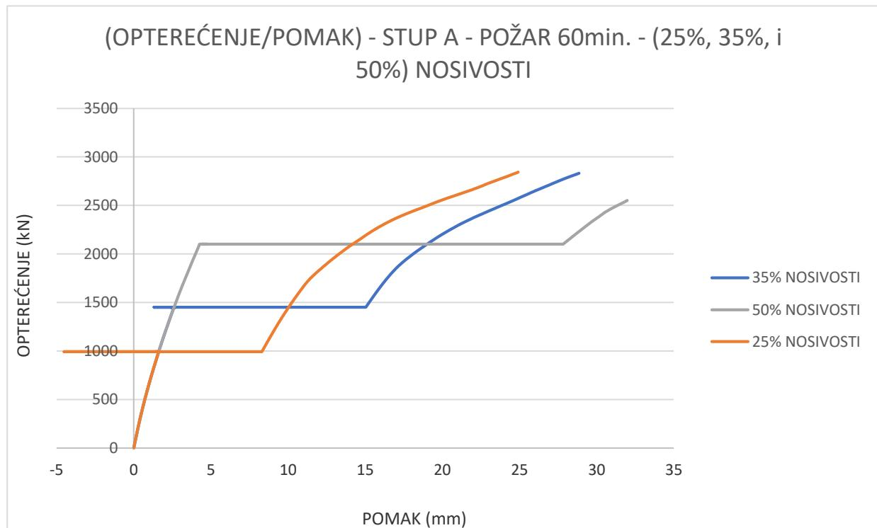
Slika 6.128: Prikaz dijagrama (opterećenje-pomak) za vrijeme požara od 60 minuta i različite intezitete opterećenja sile
