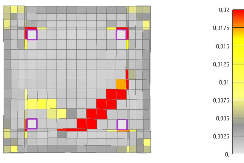
Slika 6.197: Prikaz pukotina za poprečni presjek stupa nakon 60 minuta požara
