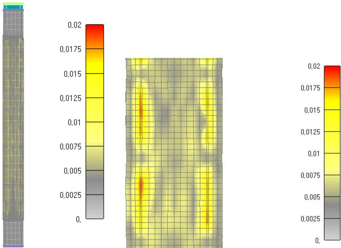
Slika 6.279: Prikaz pukotina za cijeli stup nakon 120 minuta
