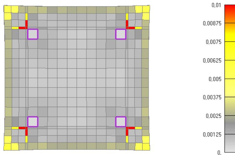
Slika 6.267: Prikaz pukotina za poprečni presjek stupa nakon 30 minuta požara
