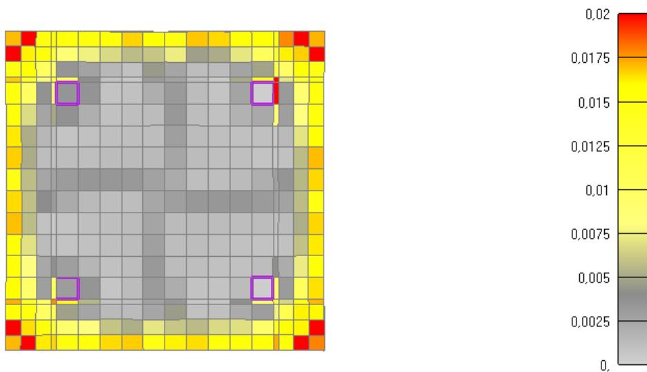
Slika 6.86: Prikaz pukotina za poprečni presjek stupa nakon 895 minuta požara
