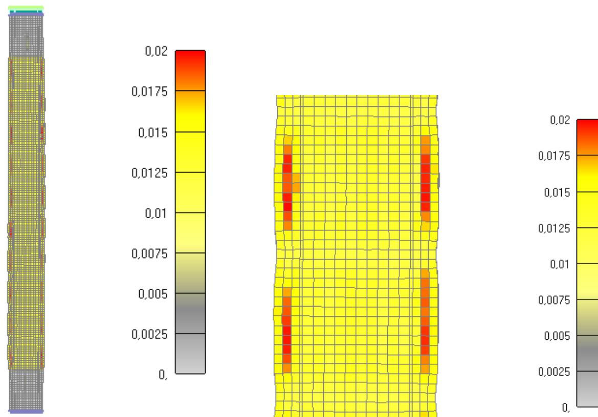
Slika 6.97: Prikaz pukotina za cijeli stup nakon 175 minuta
