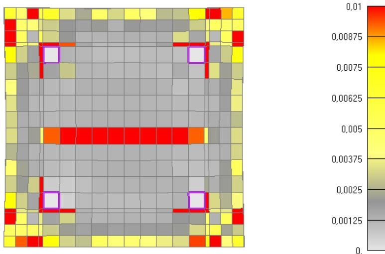
Slika 6.270: Prikaz pukotina za poprečni presjek stupa nakon 90 minuta
