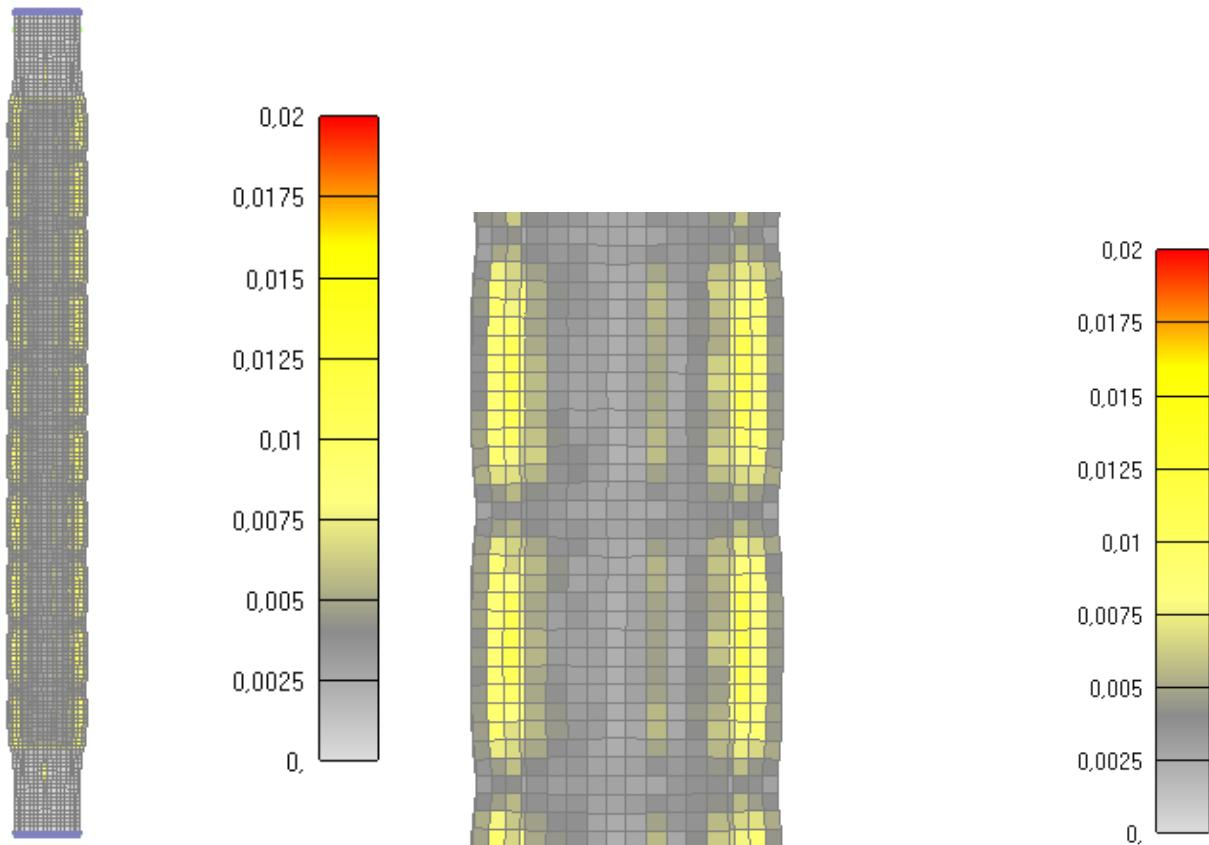
Slika 6.155: Prikaz pukotina za cijeli stup nakon 90 minuta
