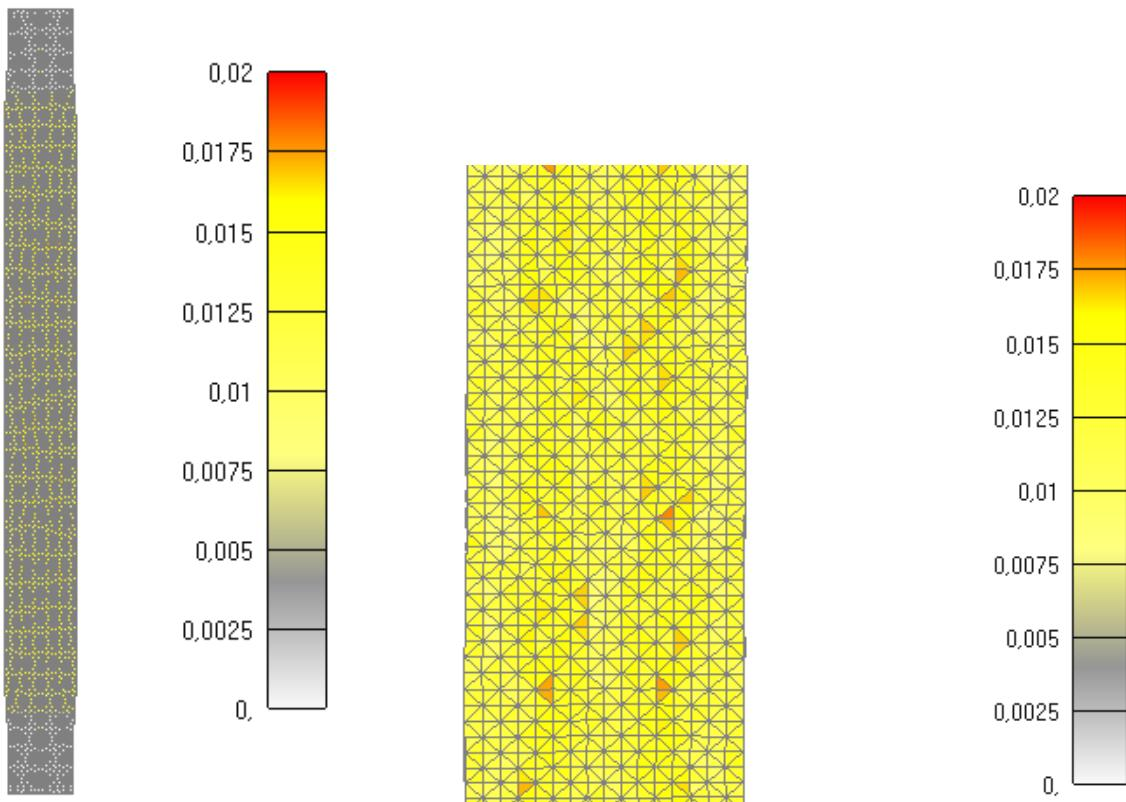
Slika 6.67: Prikaz pukotina za cijeli stup nakon 275 minuta
