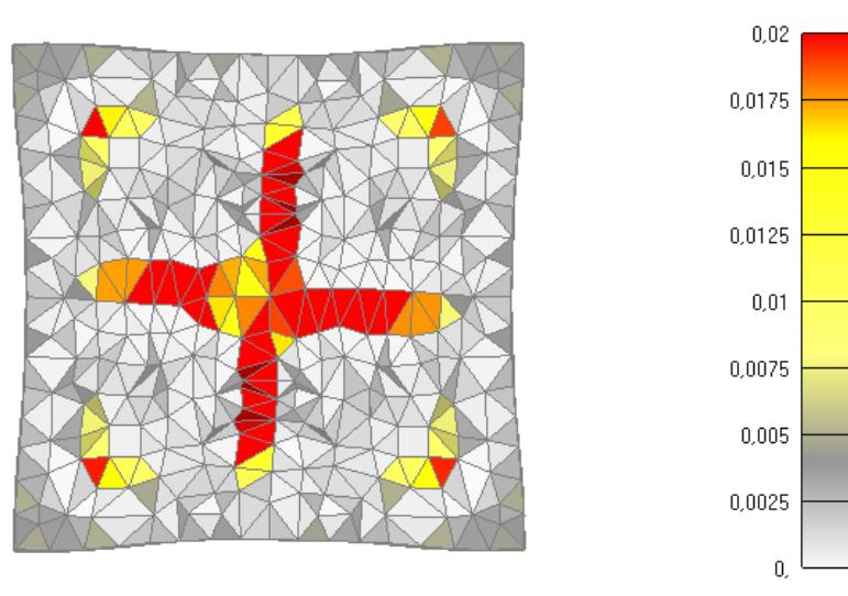
Slika 6.46: Prikaz pukotina za poprečni presjek stupa nakon 60 minuta požara
