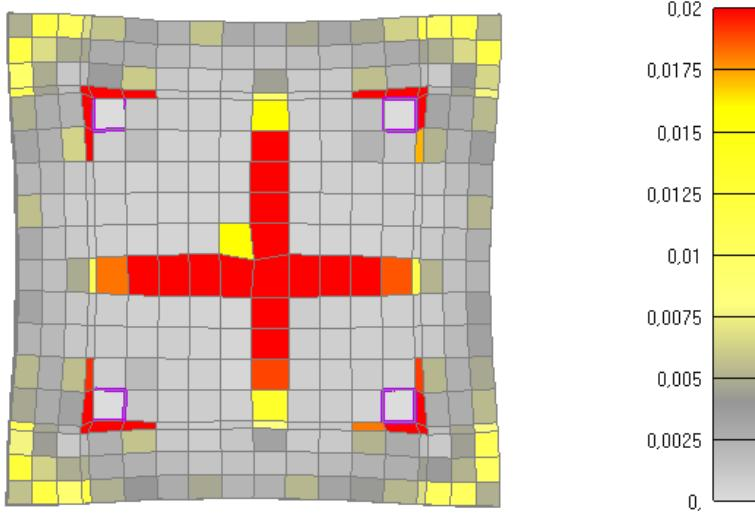
Slika 6.171: Prikaz pukotina za poprečni presjek stupa nakon 90 minuta požara
