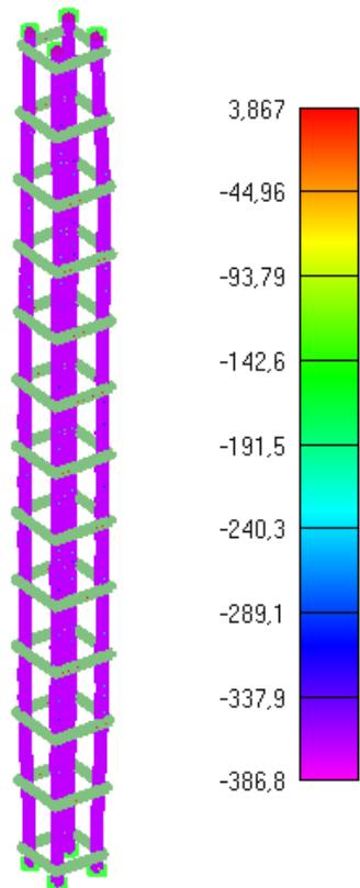
Slika 6.133:Prikaz naprezanja glavne uzdužne armature za djelovanje požara od 250min
