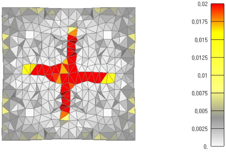
Slika 6.48: Prikaz pukotina za poprečni presjek stupa nakon 120 minuta požara
