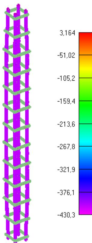
Slika 6.211: Prikaz naprezanja glavne uzdužne armature za djelovanje požara od 120min
