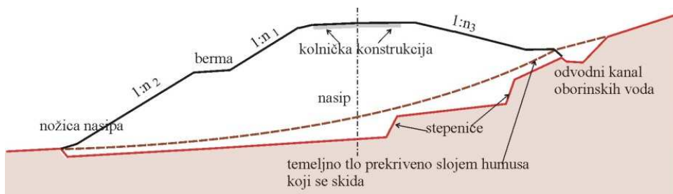
Slika 6.2 Cestovni nasip s bitnim dijelovima
