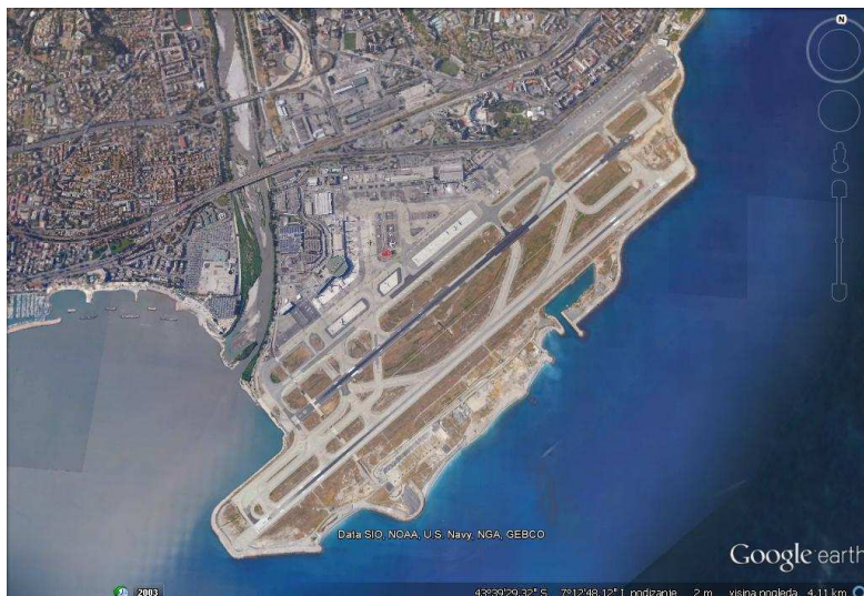
Slika 6.3 Zračna luka u Nici, Francuska, izvedena na nasipu u moru
