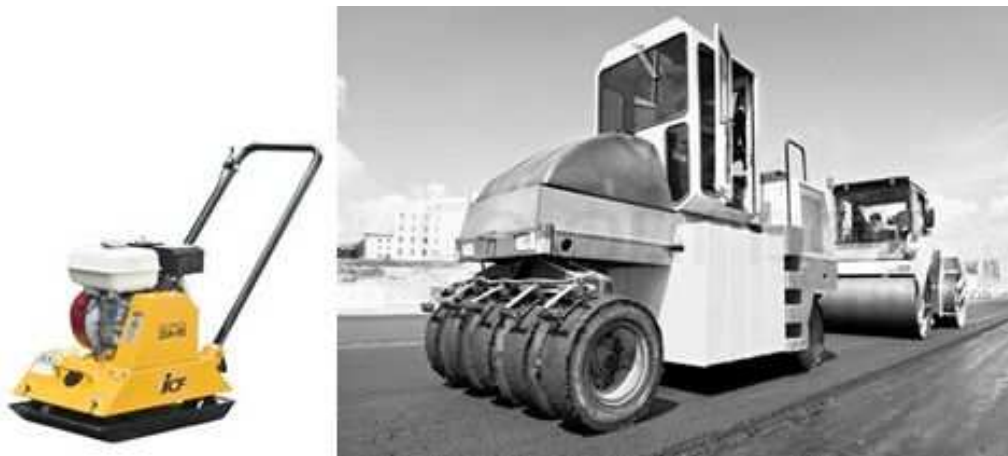
Slika 3.19 Vibroploča, valjak s gumenim kotačima i glatki valjak
