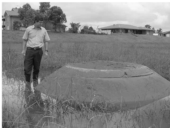
Slika 8.39 Stožac tla na mjestu početka povratne erozije u zaobalju (Fell, 2005.)
