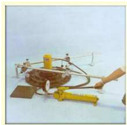
Slika 5.6 Oprema za ispitivanje probnom pločom
