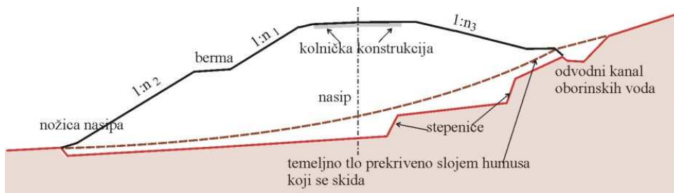
Slika 6.2 Cestovni nasip s bitnim dijelovima
