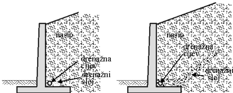
Slika 3.49 Drenaže konzolnih potpornih zidova
