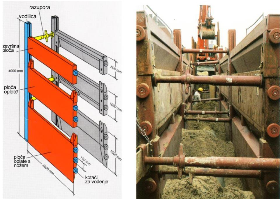
Slika 8.20 Sustav oplata s pločama i vodilicama
