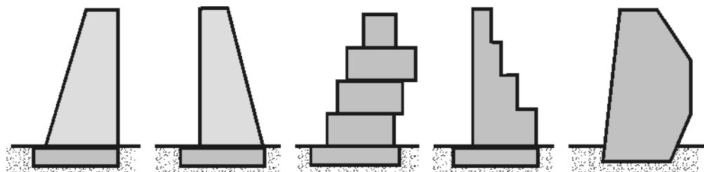
Slika 3.27 Nekoliko oblika masivnih gravitacijskih potpornih zidova
