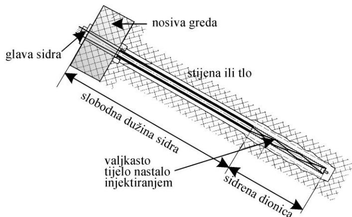
Slika 1.16 Primjer geotehničkog sidra od čelične užadi
