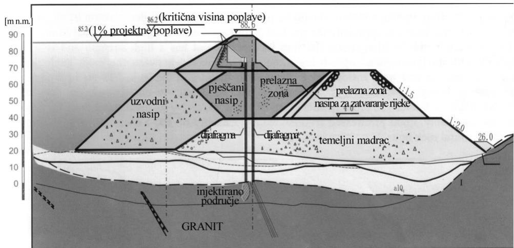
Slika 6.4 Uzvodni zagat brane Tri klanca u Kini (CTGPC, 2002.)
