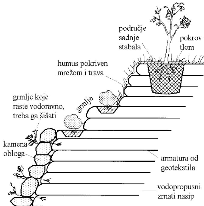
Slika 4.16 Lice građevine armirane geotekstilom (Rankilor, 1994.)
