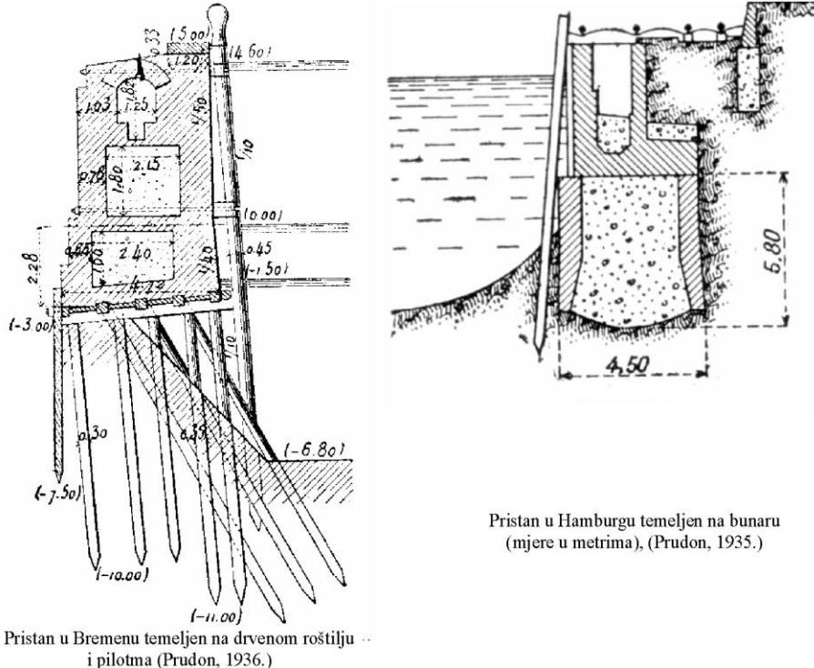
Slika 3.2 Masivni, gravitacijski potporni zidovi na dubokim temeljima
