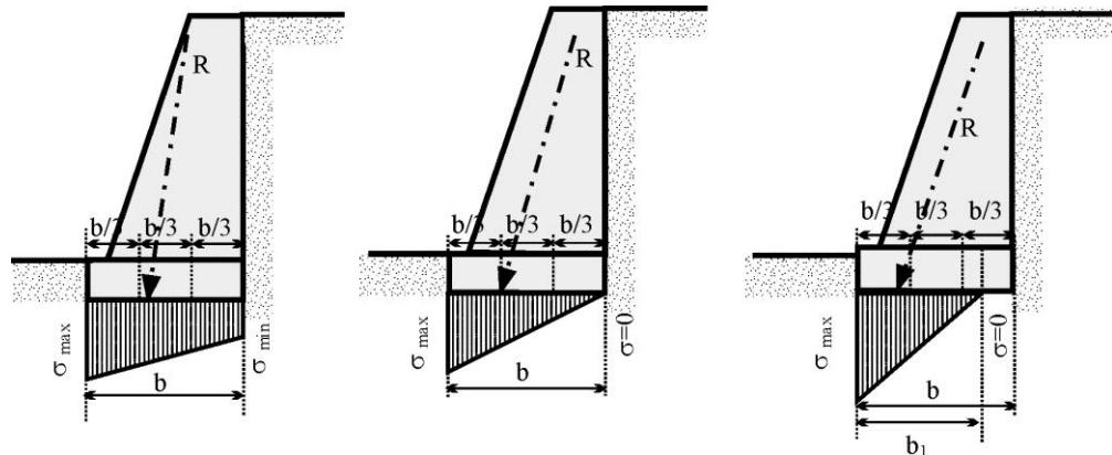
Slika 3.16 Moguće raspodjele naprezanja na plohi temelj – tlo
