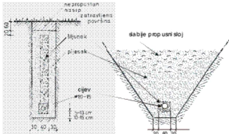
Slika 8.39 Poprečni presjeci drenažnih rovova
