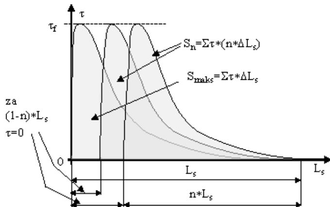
Slika 7.123 Pomak dijagrama posmičnog naprezanja duž sidrišta u slučaju dosega čvrstoće na smicanje na njenom početku
