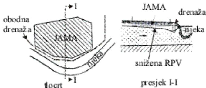
Slika 8.43 Zaštita građevne jame od priobalne podzemne vode
