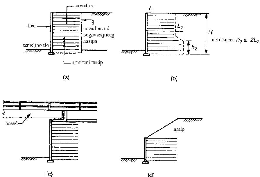
Slika 4.2 Mjesta primjene potpornih građevina od armiranog tla
