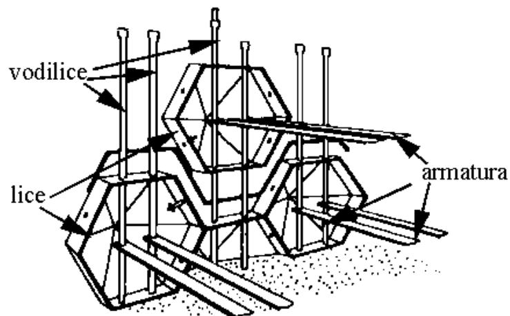
Slika 4.30 Dijelovi (lice, vodilice i armatura) građevine od armiranog tla za kliznu metodu izvedbe (Jones, 1996.)
