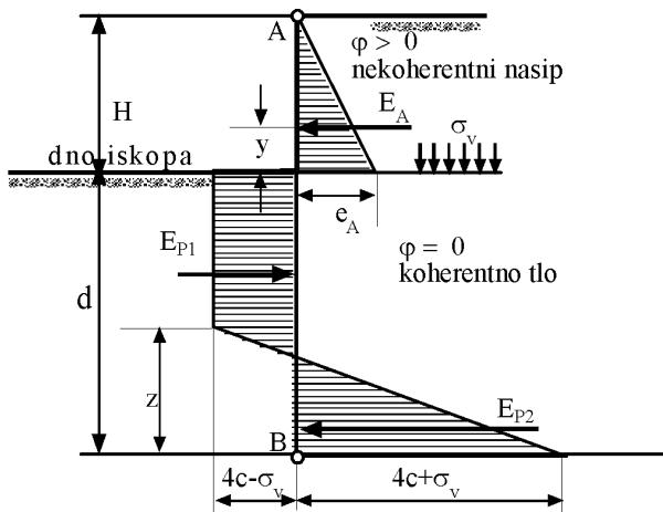
Slika 5.14 Raspodjela pritisaka nekoherentnog nasipa ( $c=0, \varphi$ ) i otpora koherentnog tla ( $c, \varphi=0$ ) potrebna za proračun dubine zabijanja,  $d$  (Cernica, 1995.)
