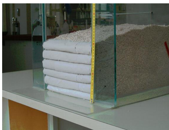
Slika 4.3 b) Model s licem od papira, armiran listovima papira (ispitivanja autora, 2005.)
