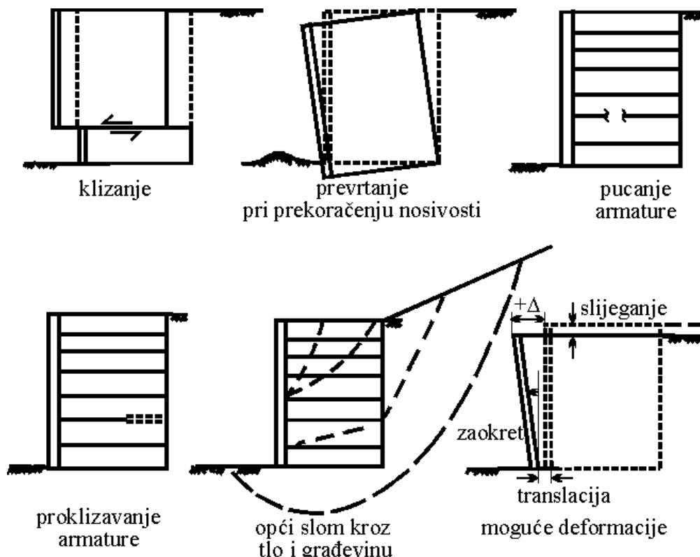
Slika 4.19 Mogući mehanizmi loma za koje treba provesti proračun potporne građevine od armiranog tla (Jones, 1996.).
