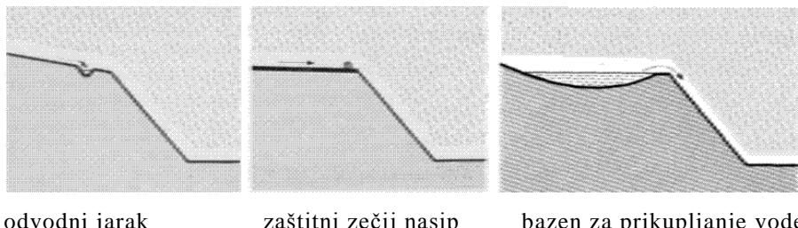
Slika 8.32 Zaštita građevnih jama od vanjske, oborinske vode (Weissenbach, 1975.)
