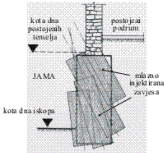
Slika 8.66 Shematski prikaz izvedbe mlazno injektirane zavjese ispod temelja i ujedno kao zaštite građevne jame (Čorko i sur., 1997.)
