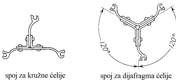
Slika 6.15 Spojne platice za čelijaste zagate od čeličnog žmurja
