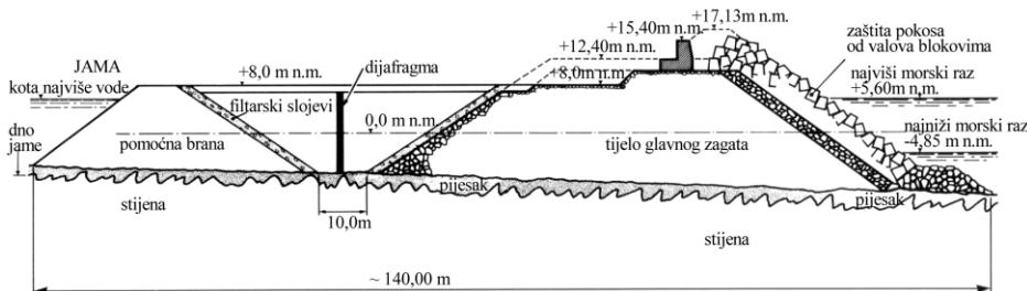
Slika 8.78 Poprečni presjek projektirano zagata (Martin, 1980.)
