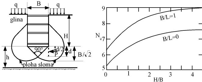
Slika 5.3 Stabilnost dna rova u glini i pripadni dijagram za faktor nosivosti  $N_c$
