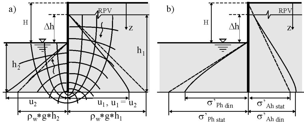
Slika 2.37 Dijagram hidrodinamičkog tlaka u usporedbi s hidrostatičkim a) i njegov utjecaj na promjenu bočnih efektivnih naprezanja b)
