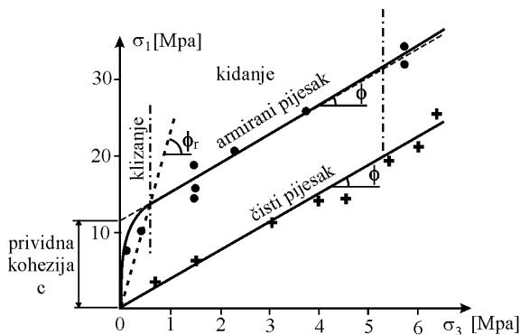
Slika 4.20 Rezultati troosnog ispitivanja (Schlosser i sur., 1972.)
