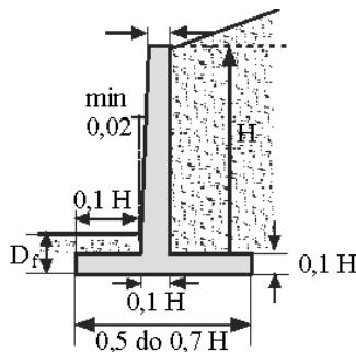
Slika 3.47 Proporcije tankostijenog armiranog konzolnog potpornog zida
