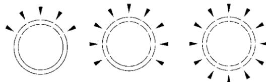
Slika 3.22 Mogući načini postavljanja otvora na drenažnim cijevima
