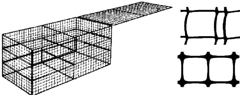
Slika 3.31 Košare za gabione (lijevo) i vrste plastičnih mreža za njihovo izvođenje (desno), Netlon, gore: Tensar, dolje (Werkos, 2002.)
