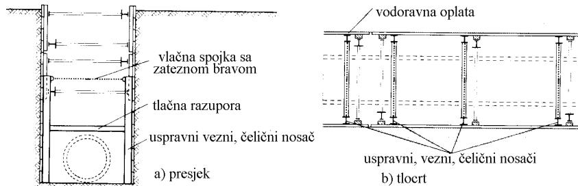
Slika 8.16 Podgrada iskopa za kanal pomoću uspravnih veznih greda, vlačnih spojki i dodatnih tlačnih razupora (Weissenbach, 1975.)
