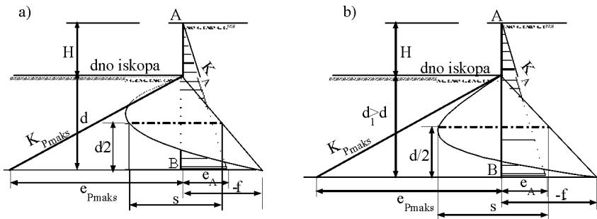
Slika 5.11 Grafička kontrola rezultata dimenzioniranja slobodno stoećeg krutog žmurja: a) ne zadovoljava; b) zadovoljava
