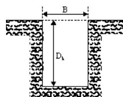
Slika 8.7 Iskop u glini, bez podgrade, do dubine,  $D_k$ , prema jednadžbi 2.9, do koje nema pritiska na podgradu.
