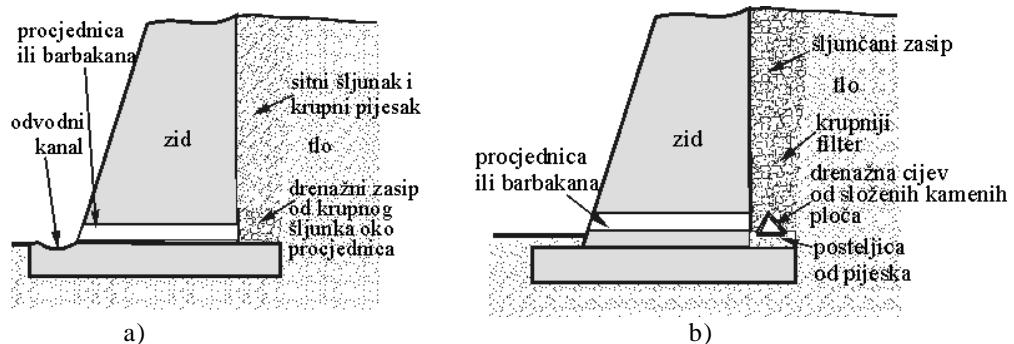
Slika 3.21 Drenaža iza zida: a) bez cijevi; b) cijev od kamenih ploča
