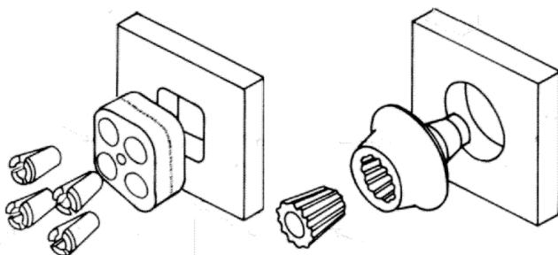
Slika 7.21 Dijelovi vanjske glave sidra za učvršćenje žica (kablova): lijevo pojedinačnim klinovima; desno jednim klinom
