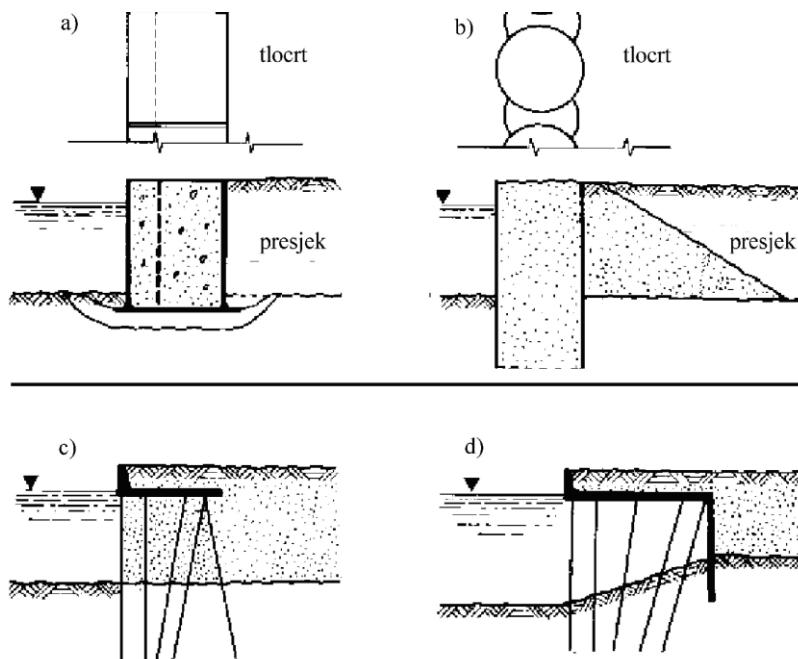
Slika 3.3 Primjeri obalnih građevina: a) obalni zid od plivajućih sanduka punjenih betonom ili zasipom (trajna građevina); b) obalni zid od čelijama izrađenih od čeličnog žmurja punjenih zasipom (trajna ili privremena građevina); c) pristan s odignutom platformom s zagatnom stjenkom od čeličnog žmurja; d) pristan s odignutom platformom na pilotima, s otvorenim licem prema vodi (Tschebotarioff, 1973.)
