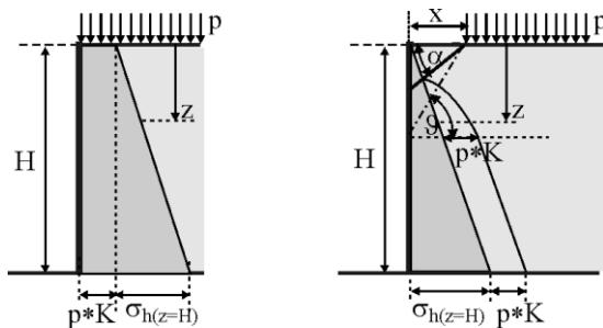
Slika 2.40 Utjecaj plošnog uspravnog opterećenja na poduporu
