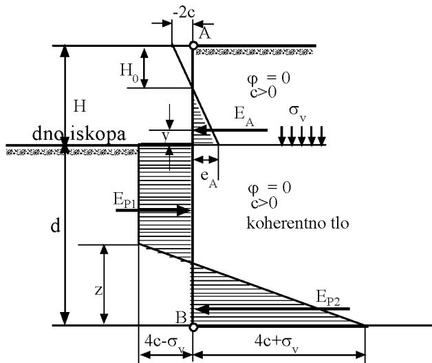
Slika 5.13 Raspodjela pritisaka i otpora tla u koherentnom tlu ( $c, \varphi=0$ ) (Cernica, 1995.)
