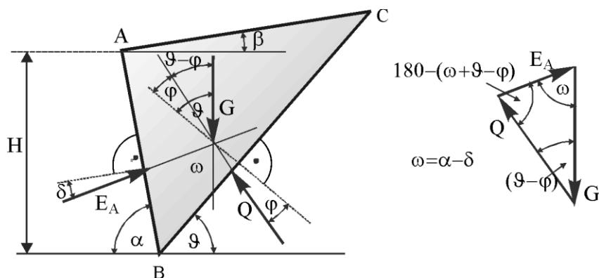
Slika 2.21 Grafički prikaz za Coulombovo rješenje aktivnog pritiska na poduporu A-B za nekoherenntno tlo
