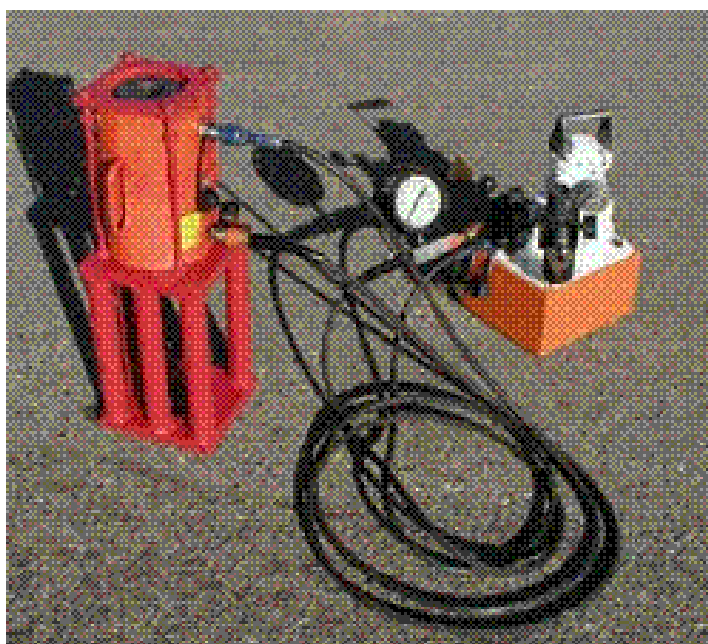
Slika 7.17 Tijesak za ispitivanje pokusnog sidra
