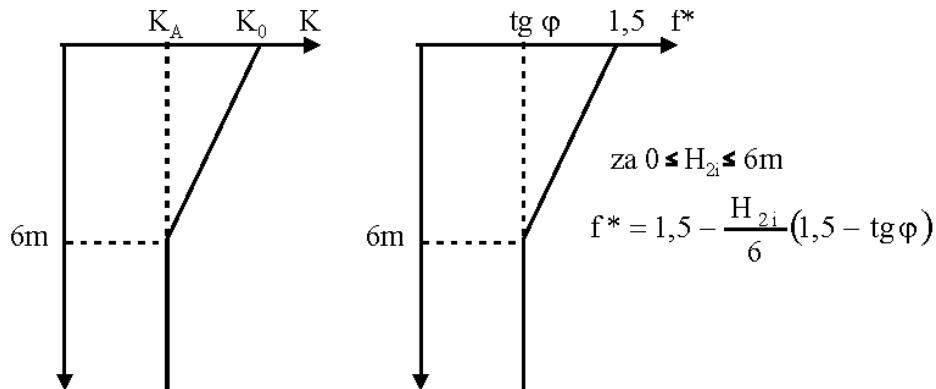
Slika 4.25 Promjena vrijednosti koeficijenta bočnog tlaka i prividnog koeficijenta trenja za proračune unutarnje stabilnosti građevine od armiranog tla (Basma, 2003.)
