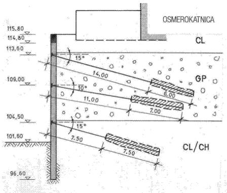
Slika 5.60 Troredno sidrena dijafragma, poprečni presjek (BBR–CONEX, 1996–1998)
