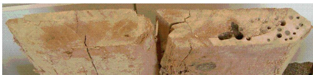
poprečni presjek, riblja kost, vidi se učinak štetočina u drvetu
