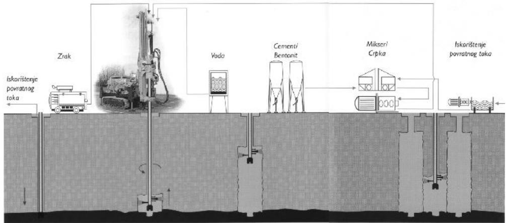
Slika 5.49 Shema izvođenja zagatne stijenke mlaznim injektiranjem (Keller, 2003.)
