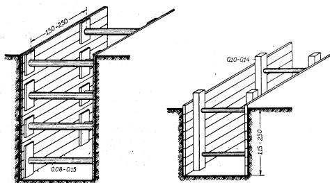
Slika 5.16 Drvene višestruko razuprte oplate kanala
