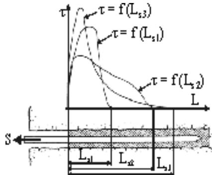
Slika 7.112 Raspodjela posmičnih naprezanja u ovisnosti o dužini sidrišta (Hudec, 1987.)
