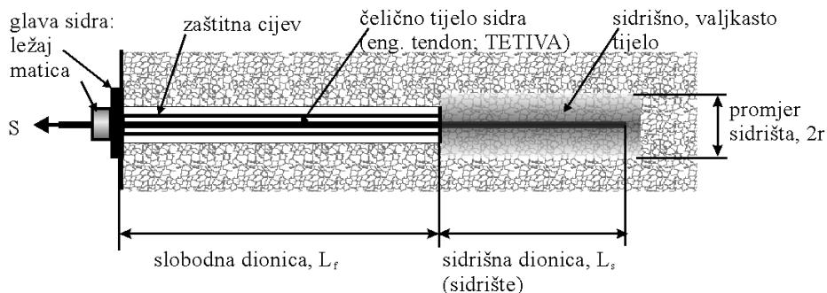
Slika 7.4 Skica dijelova sidra injektiranog na jednom dijelu
