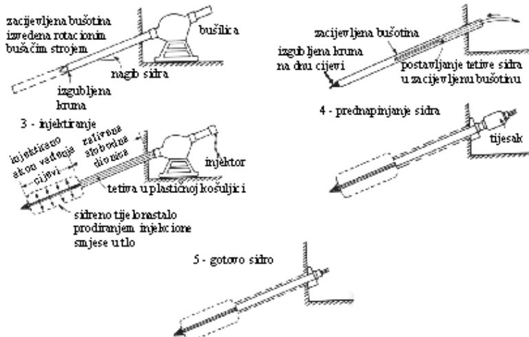
Slika 7.22 Postupci pri ugradnji injektiranog sidra (Hanna, 1985.)
