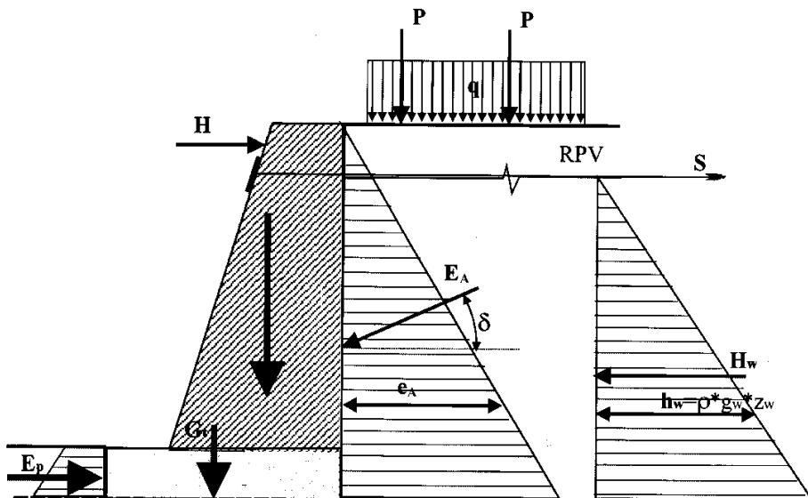
Slika 3.11 Opterećenja i otpori koji ulaze u proračun potpornog zida
