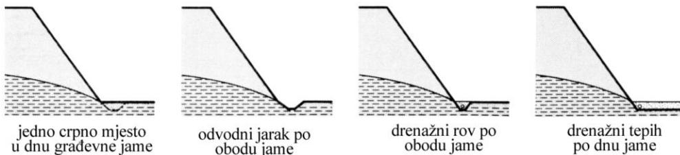
Slika 8.36 Odvodnja procjedne podzemne vode iz građevne jame
