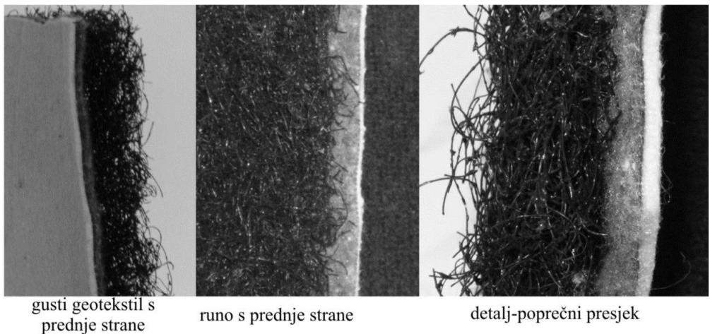
Slika 3.20 Složeni geotekstil za drenaže
