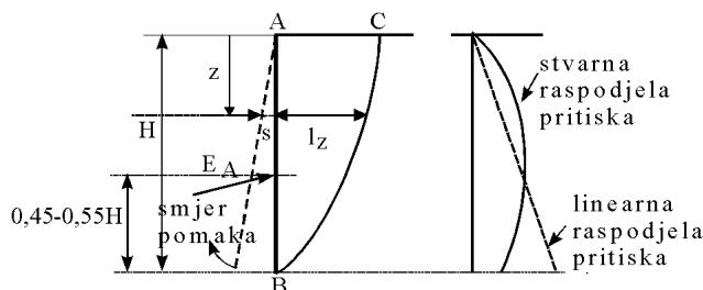
Slika 2.32 Preraspodjela pritiska na poduporu u ovisnosti o deformaciji
