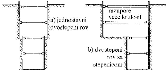
Slika 8.23 Stupnjevana podgrada za duboke kanale do 6m
