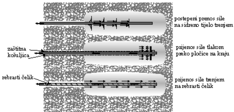
Slika 7.14 Mogući načini prijenosa sile iz tetine na sidrišno tijelo
