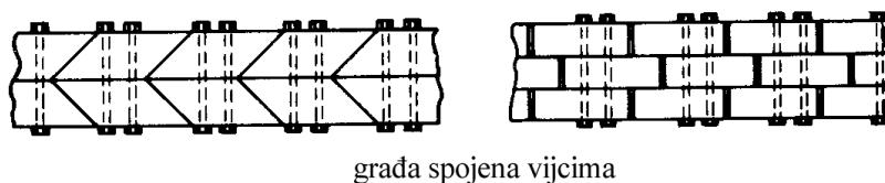
Slika 6.11 Nekoliko primjera spajanja drvene građe u platice
