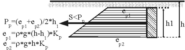
Slika 3.43 Dijagram pasivnog otpora iza sidrenog zida ili bloka
