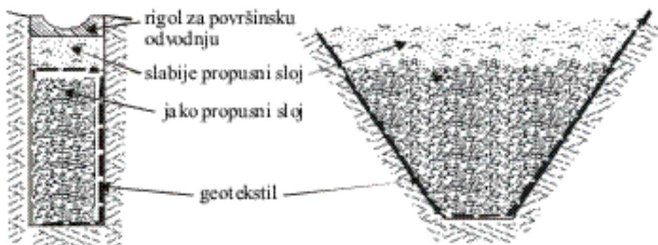
Slika 8.41 Geotekstil umjesto filterskog sloja kod vodoravnih drenaža (bez cijevi)
