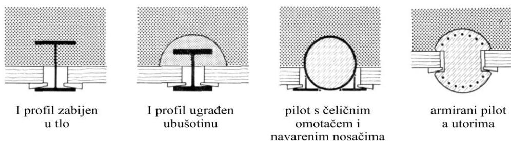
Slika 8.28 Poprečni presjeci uspravnih nosača za oplatu berlinskog ziđa
