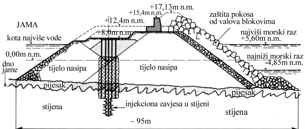
Slika 8.79 Poprečni presjek izvedenog zagata (Martin, 1980.)
