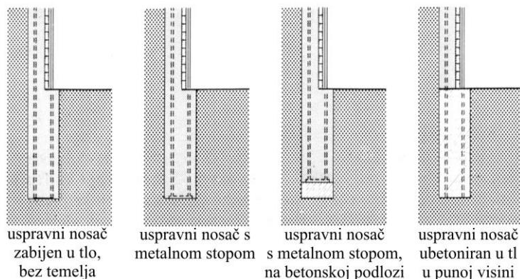
Slika 8.30 Učvršćenje uspravnih nosača berlinskog zida u tlo
