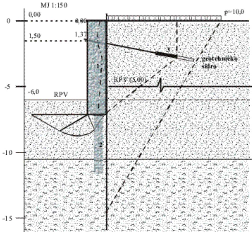
Slika 1.11 Primjena suvremene tehnologije: 1 mlazno-injektirani stupnjaci  $\Phi=150$  cm s preklopom od 20 cm; 2 mlazno-injektirane lamele  $d=40$  cm; 3 sidro, (Keller, 2003.).
