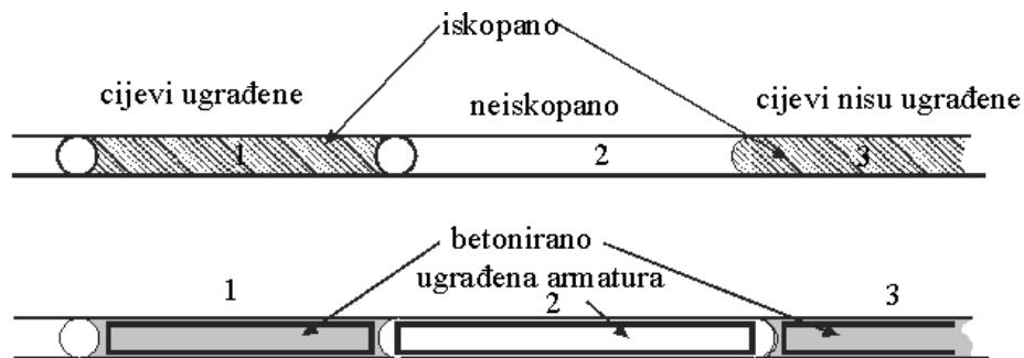
Slika 5.42 Tlocrt s redoslijedom izvedbe armiranobetonske dijafragme
