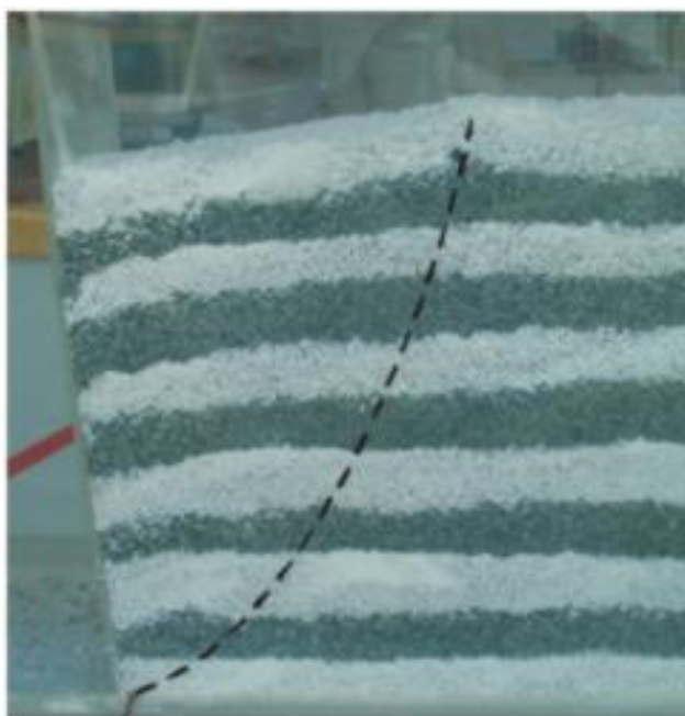
Slika 2.12 Laboratorijski model s rekonstruiranom kliznom plohom pri zaokretu podupore oko točke B, aktivno stanje (model autora)
