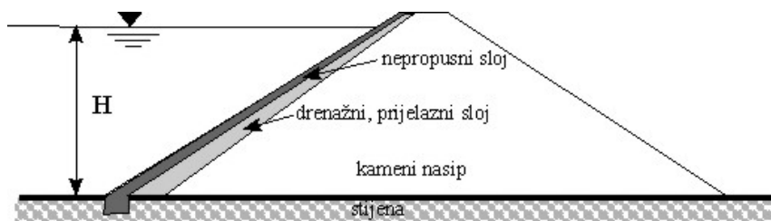
Slika 11.78 Nasip s nepropusnom membranom na uzvodnoj strani
