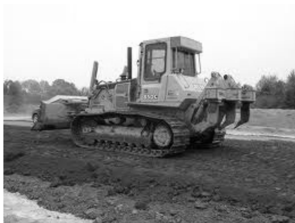
Slika 11.63 Dozer s rijačem za razastiranje i sitnjenje tla
