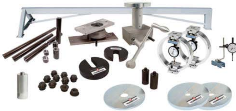
Slika 4.26 Oprema za CBR pokus na terenu
