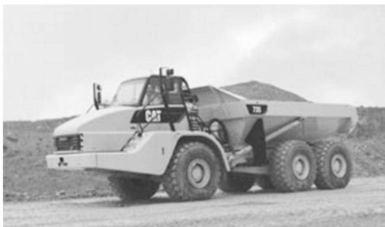
Slika 10.8 Namjensko vozilo za prijevoz i grubo razastiranje
