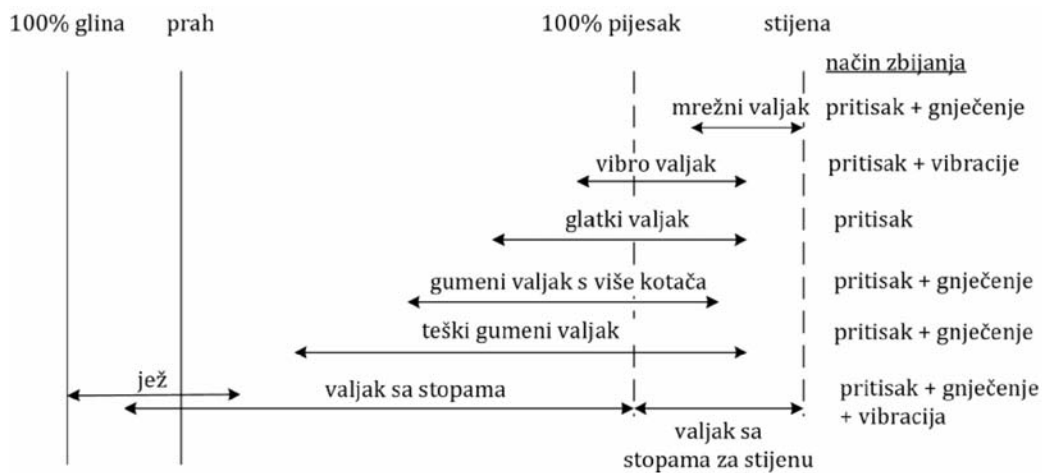
Slika 11.62 Prilagodba strojeva za zbijanje vrsti tla (Coduto 2010.)
