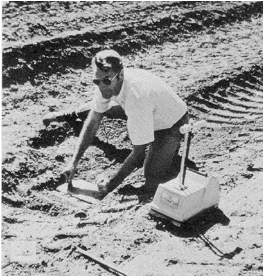
Slika 11.92 Mjerenje gustoće tla nuklearnim densimetrom
