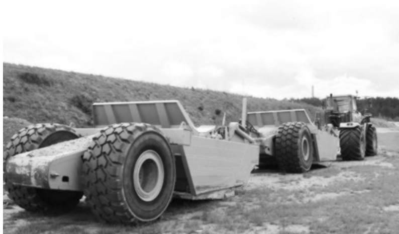
Slika 8.14 Skrejšper vučen traktorom s dva sanduka
