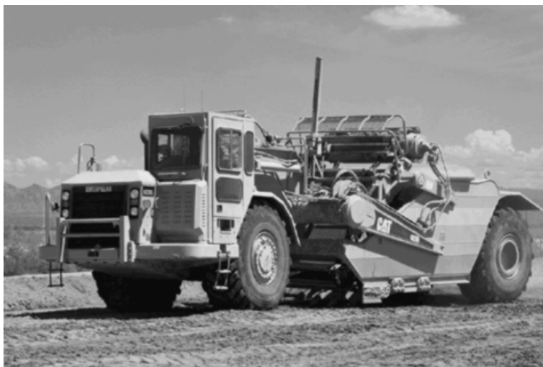
Slika 8.13 Noviji model skrepera s vlastitom vučom
