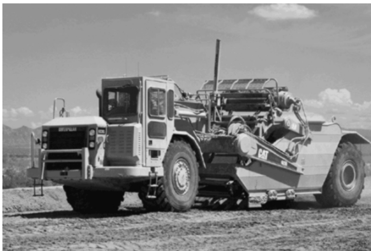
Slika 8.13 Noviji model skrepera s vlastitom vučom
