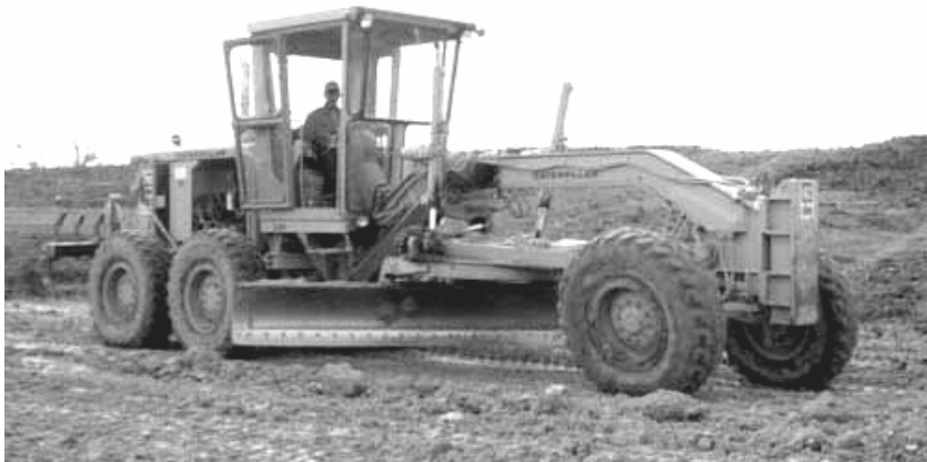
Slika 10.10 Greder za fino planiranje razastrtog tla
