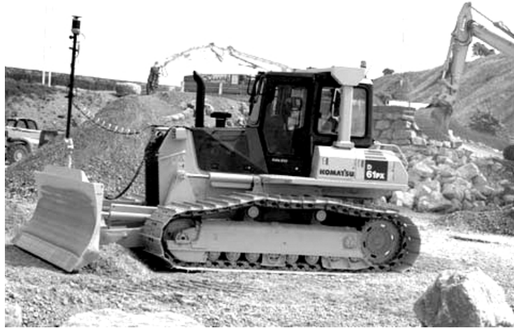
Slika 11.53 Anglozer za razastiranje i guranje tla istovarenog na hrpe
