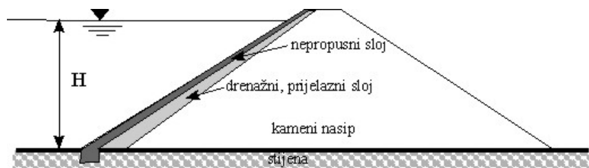
Slika 11.78 Nasip s nepropusnom membranom na uzvodnoj strani
