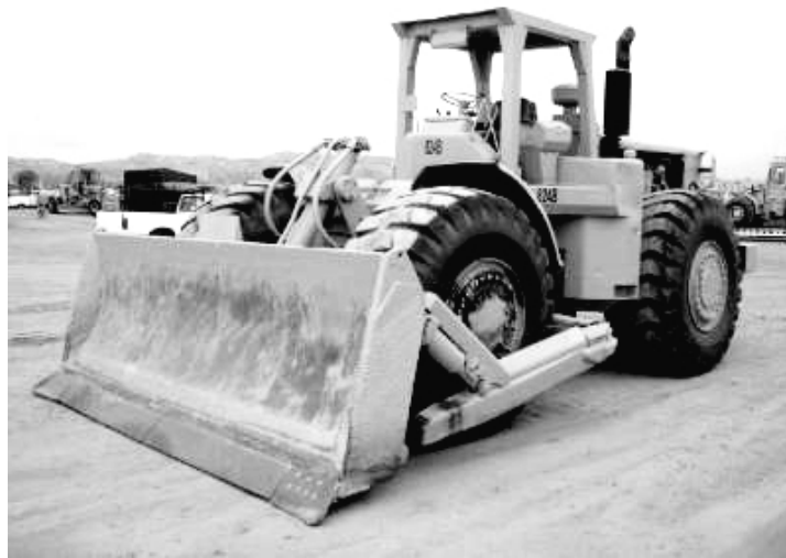
Slika 8.7 Dozer na kotačima
