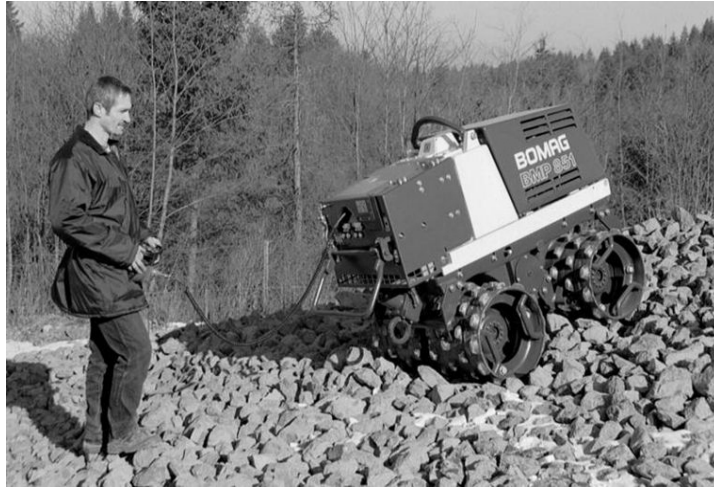
Slika 11.67 Valjak za nabijanje kamenog nasipa
