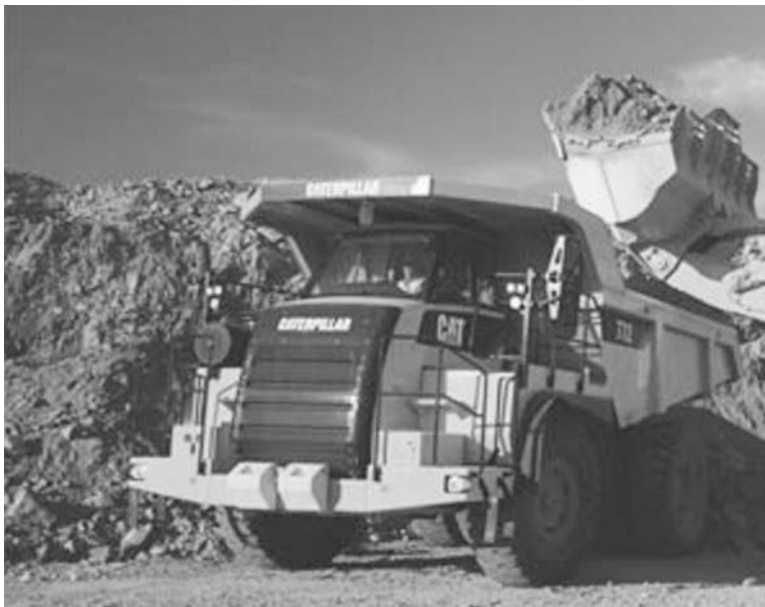
Slika 10.5 Utovar iskopanog tla u vozilo za prijevoz utovarivačem
