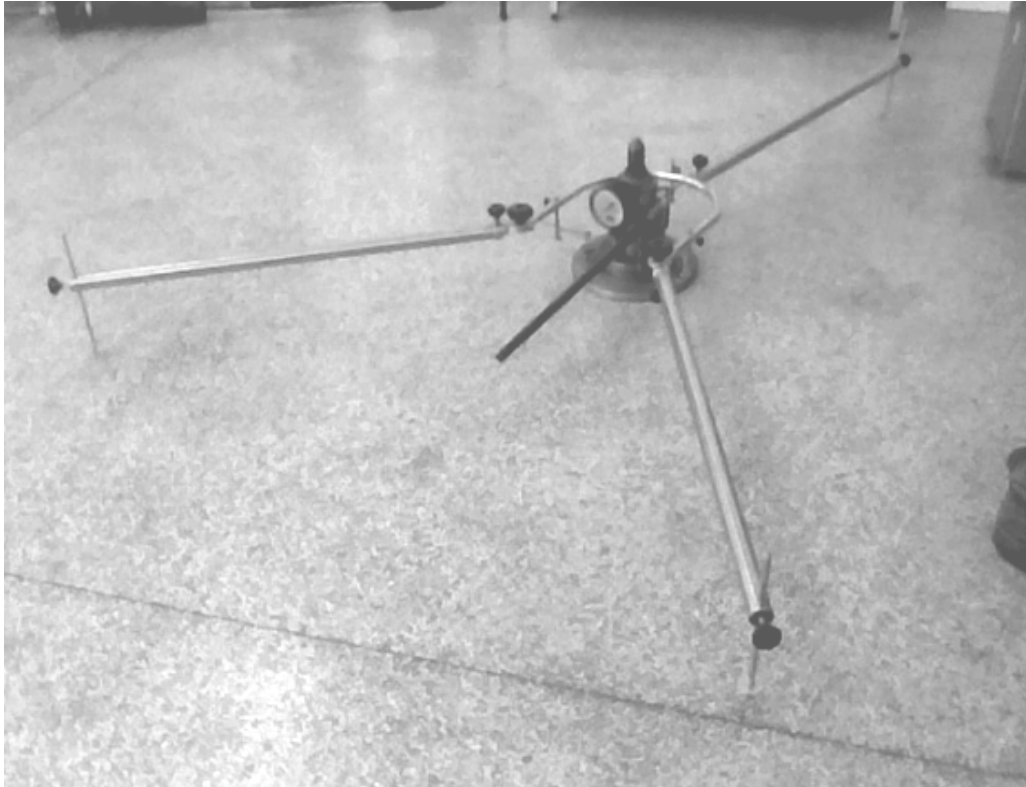
Slika 3.36 Oprema za ispitivanje probnom pločom
