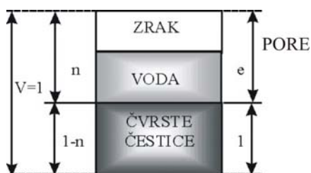
Slika 4.14 Model trodjelnog sustava tla
