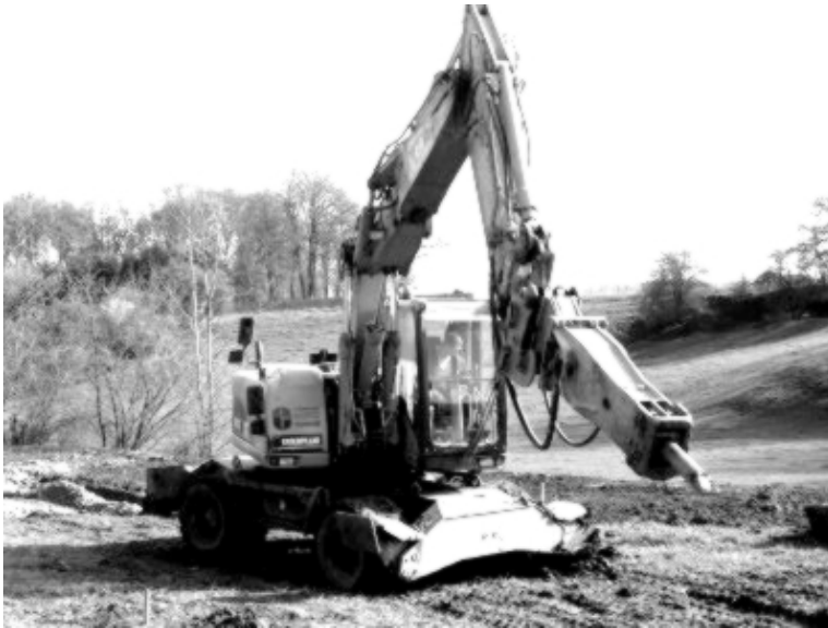
Slika 8.22 Pneumatski čekić (montaber) priključen na granu stroja na gusjenicama
