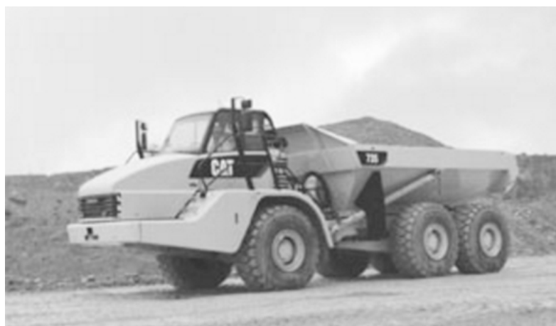
Slika 10.8 Namjensko vozilo za prijevoz i grubo razastiranje
