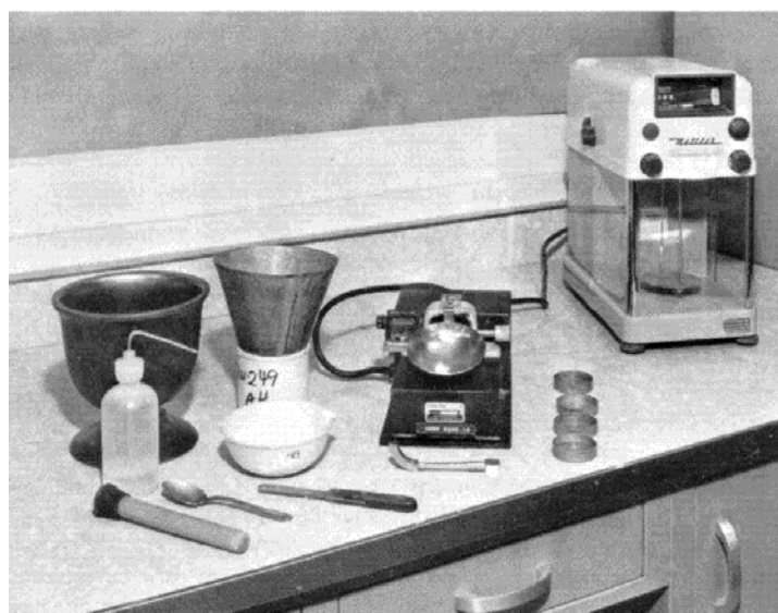
Slika 4.7 Pribor za ispitivanje granice tečenja
