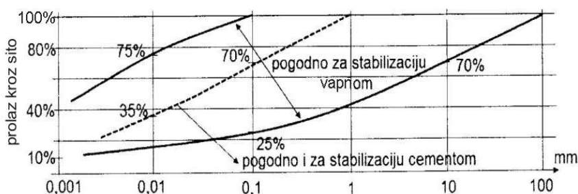
Slika 11.6 Granulometrijsko područje tla pogodnog za stabilizaciju vapnom
