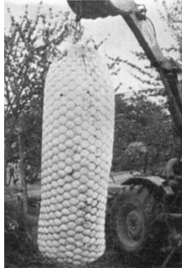
Slika 14.21 Tonjača (sa slike 14.19) od geosintetika, punjena šljunkom
