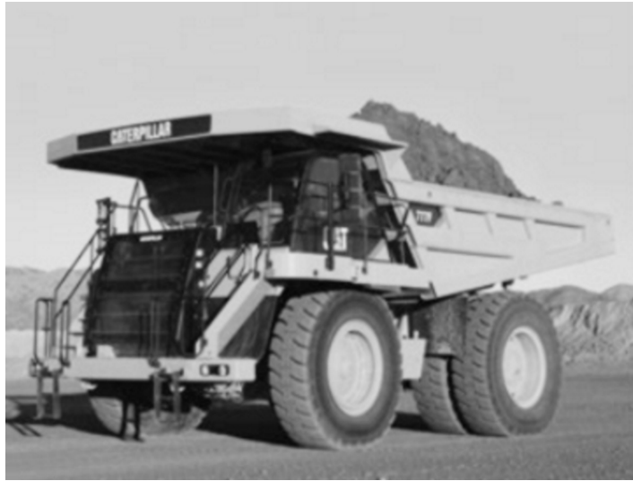
Slika 10.4 Damper velikih dimenzija, za prijevoz po gradilištu
