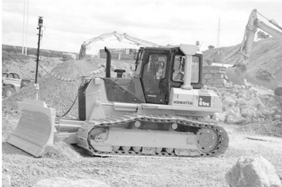
Slika 8.6 Angldozer na gusjenicama
