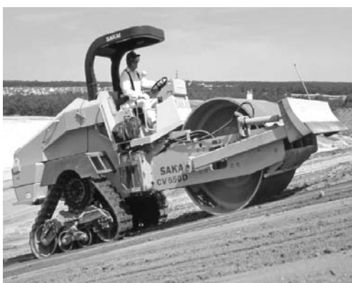
Slika 11.65 Glatki valjak s nožem dozera, za fino planiranje
