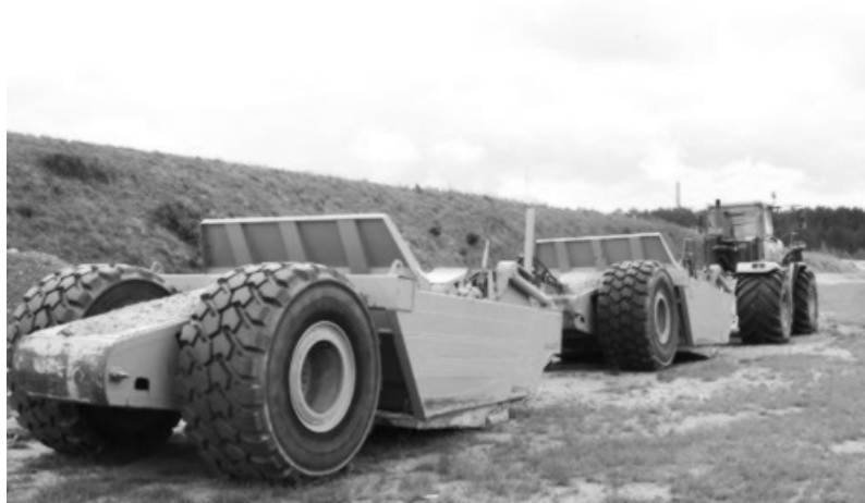
Slika 8.14 Skrejšper vučen traktorom s dva sanduka
