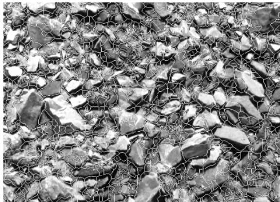
Slika 9.11 WipFrag – automatski generirana mreža fragmenata (Lukić 2011.)
