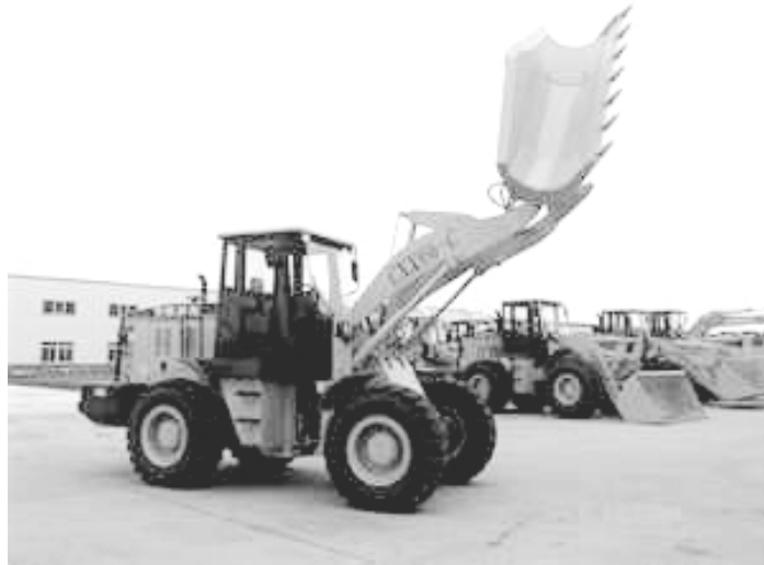
Slika 8.18 Utovarivač s zaokretnim košem
