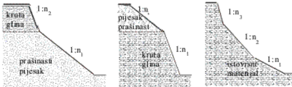
Slika 12.9 Iskopi promjenjivih nagiba pokosa u tlu različitih svojstava, lijevi i u sredini i u homogenom tlu, desno
