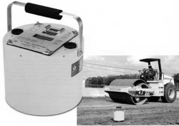
Slika 11.91 Elektronska zamjena za probnu ploču
