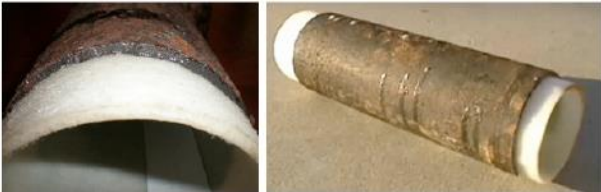
Slika 31. Primjer cijevi obnovljene CIPP metodom [11]
