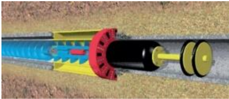
Slika 24. Alat za pipe eating metodu [15]
