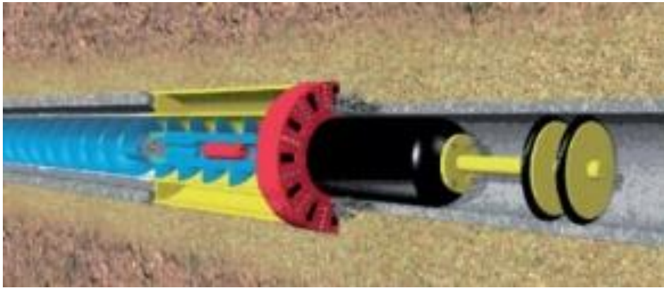
Slika 24. Alat za pipe eating metodu [15]
