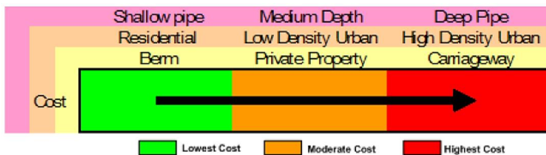
Slika 39. Shematski dijagram koji prikazuje ovisnost lokacije projekta i dubine kopanja o cijeni projekta, za tradicionalnu metodu obnove [11]
