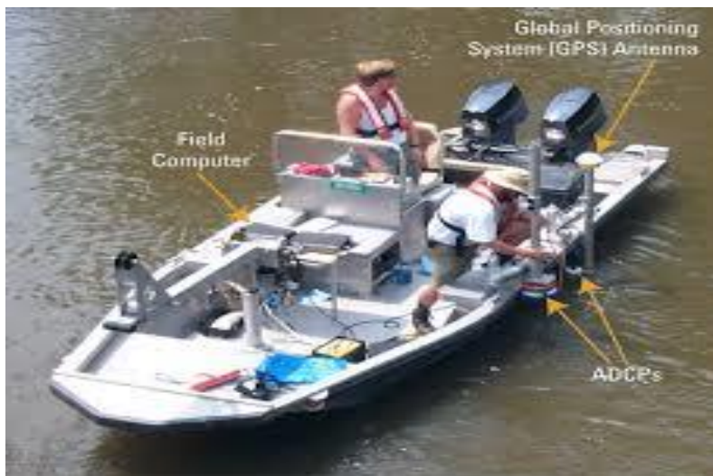
Slika 15. Mjerenje protoka ADCP-om
