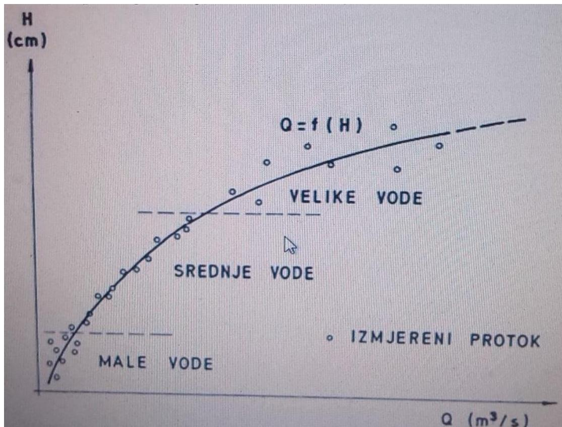
Slika 17. Rasipavanje vodomjerena oko protočne krivulje
