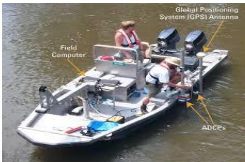
Slika 15. Mjerenje protoka ADCP-om
