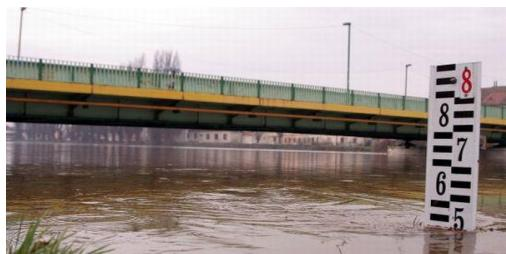
**Slika 4.** Vodomjerna letva
