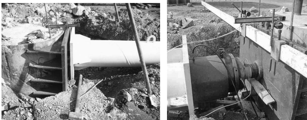
Slika 5.31 Tijesak (desno) i suprotni ležaj (lijevo) za vodoravno opterećeni, pokusni pilot
