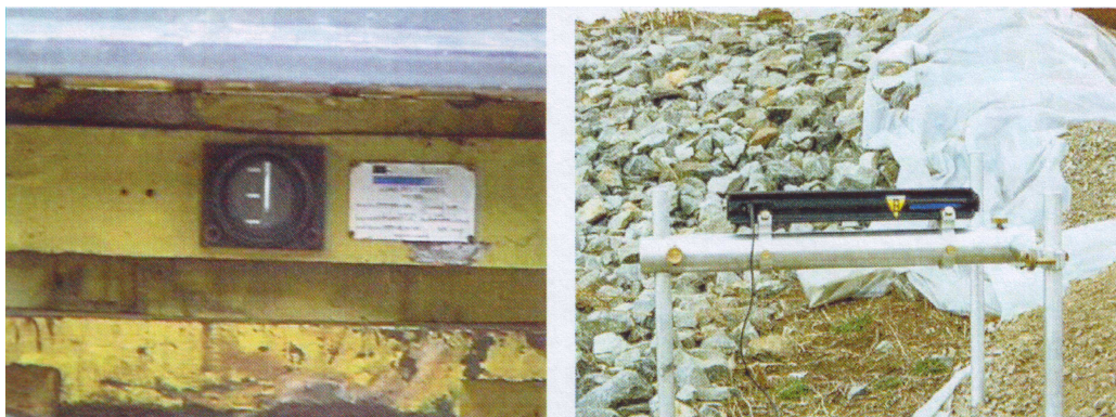
Slika 5.39 Fotonaponski pretvarač, lijevo i daljinski izvor laserske zrake, desno
