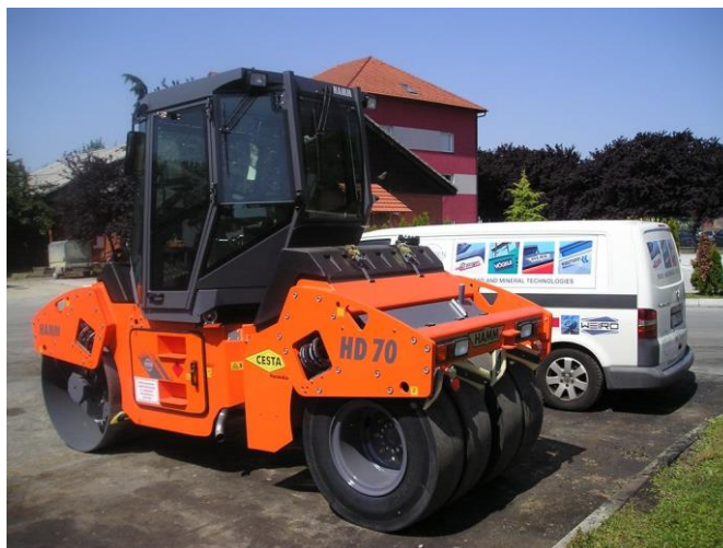
Valjak HAMM HD 70K kombinirani tandem valjak za sabijanje asfalta 7 do 15 tona (Slika 1.10.) 9
