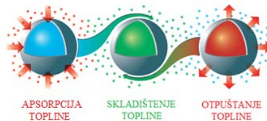
Slika 26. Mehanizam rada PCM-a, [17]
