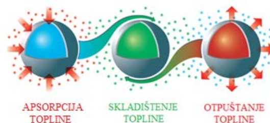
Slika 26. Mehanizam rada PCM-a, [17]
