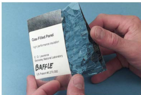
Slika 21. Uzorak unutrašnjosti GFP-a, [12]
