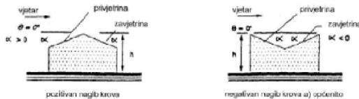
(1) Koeficijenti vanjskoga tlaka  $c_{pe}$  za građevine i dijelove građevina ovise o veličini opterećene plohe  $A$ . Oni su prikazani u mjerodavnim tablicama za odgovarajuće oblike zgrada za opterećene plohe ploštine od  $1 m^2$  i od  $10 m^2$  kao  $c_{pe,1}$ , tj.  $c_{pe,10}$ . Za druge veličine opterećenih ploha dobiju se promijenjene vrijednosti iz slike 10.2.1.
