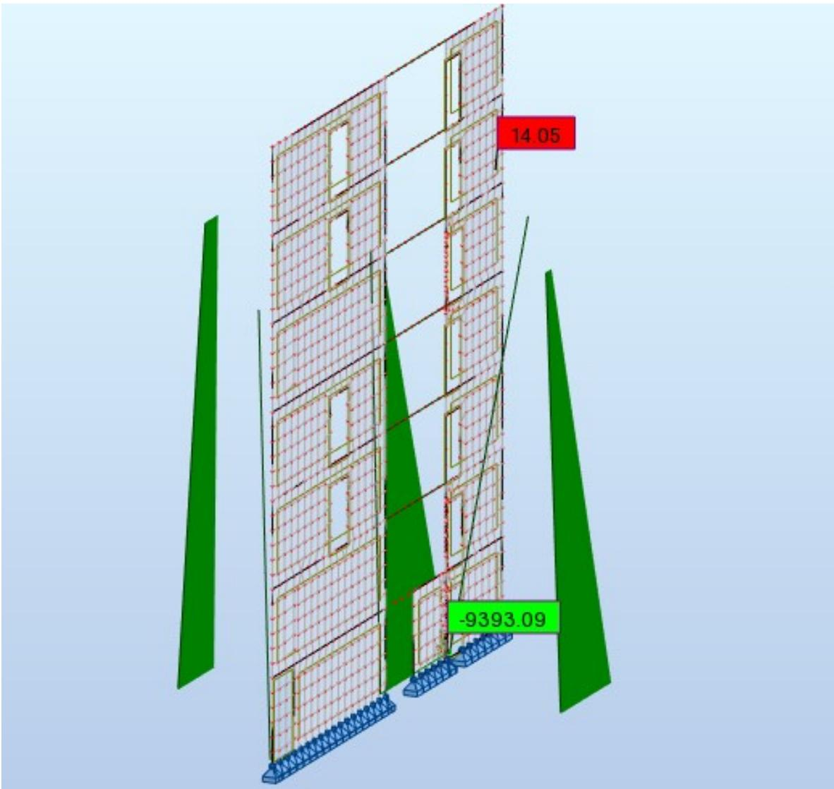
Slika 5.5. Moment savijanja u karakterističom zidu
