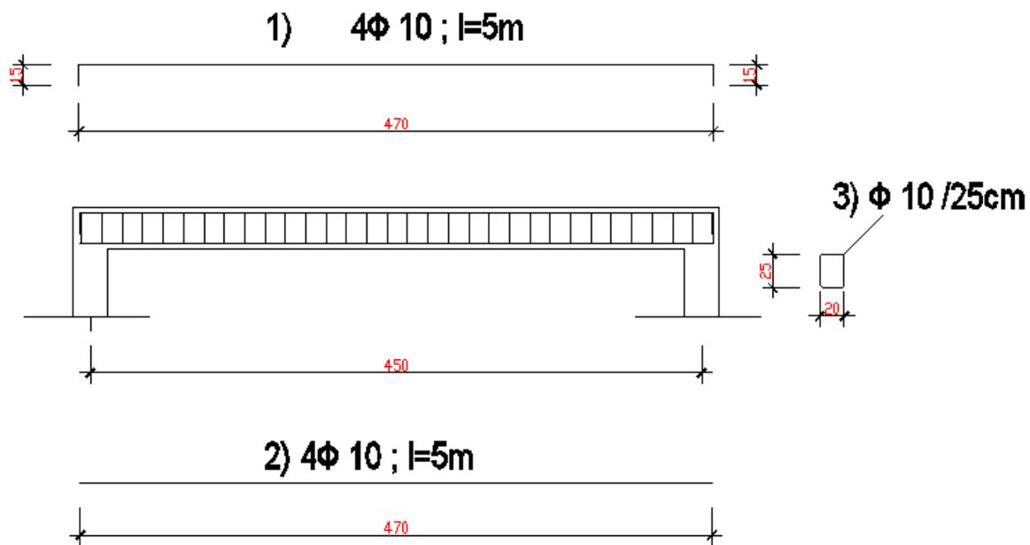
Slika 4.1.7. Armatura grede uzdužni presjek POZ 101
