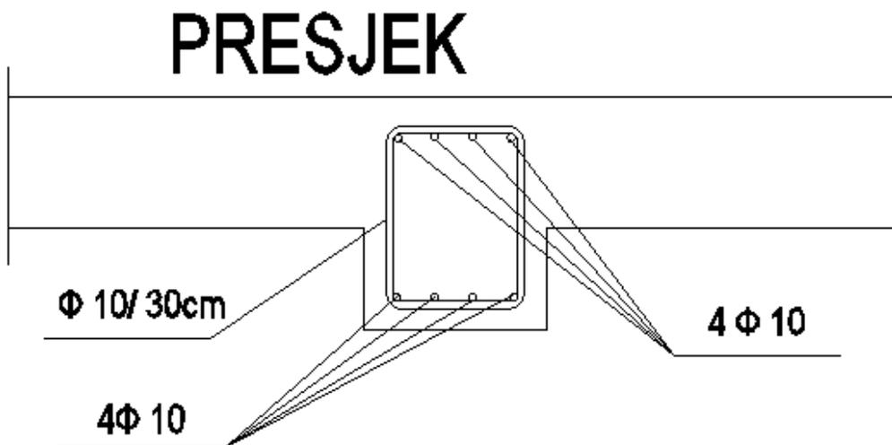
Slika 4.2.8. Armatura grede poprečni presjek -POZ 201
