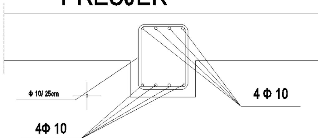
Slika 4.1.8. Armatura grede poprečni presjek POZ 101
