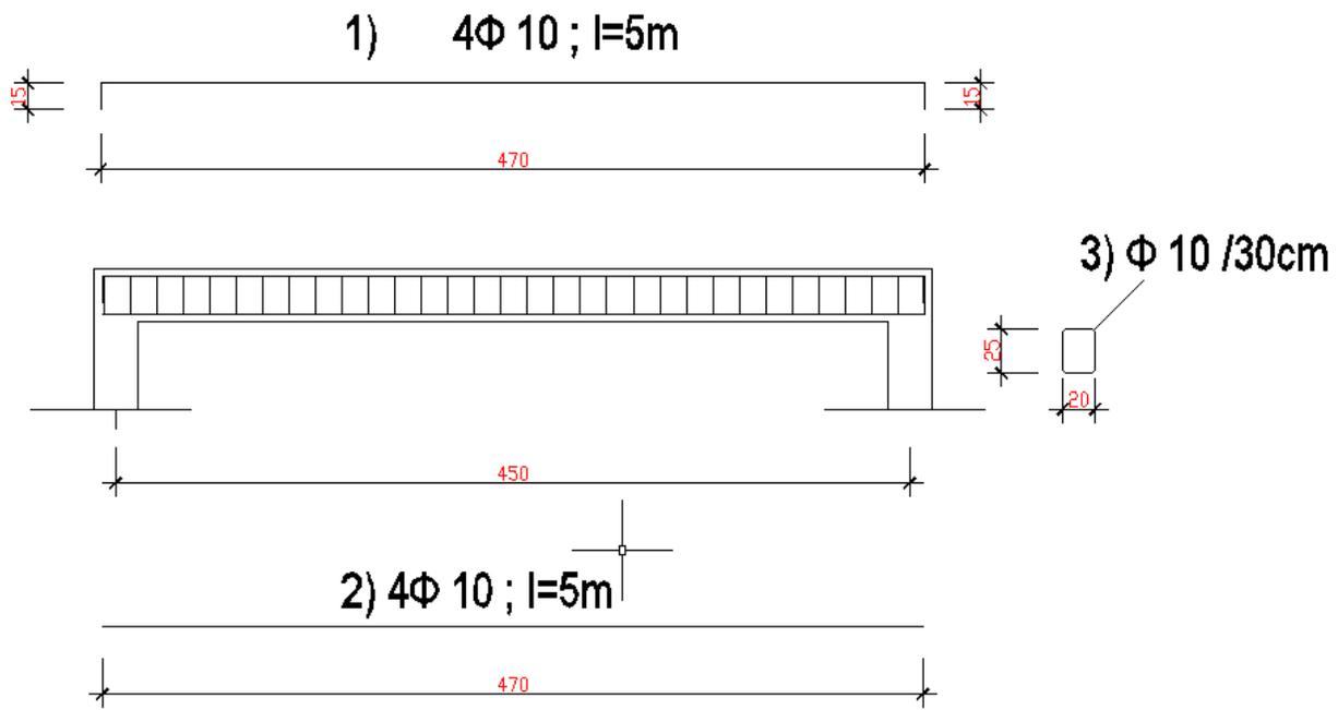
Slika 4.3.7. Armatura grede uzdužni presjek POZ 301
