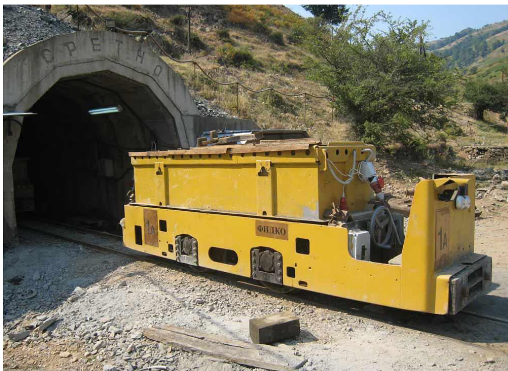
Slika 5.1.: Fidko električna lokomotiva [11]
