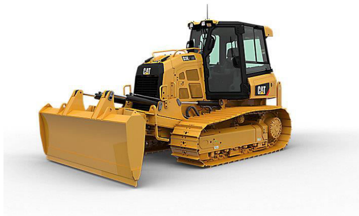
Slika 10.1.: Dozer CAT D3K2 [18]
