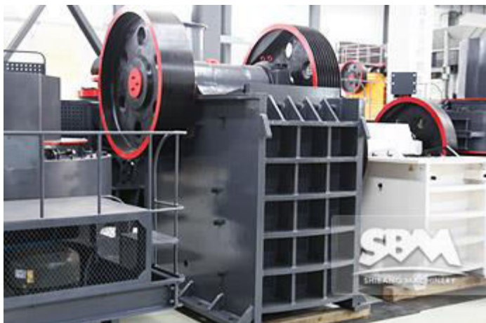
Slika 7.1.: Čeljusna drobilica SBM PE500x700 [15]
