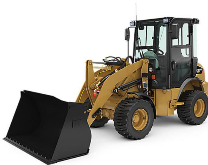
Slika 3.1.: Utovarivač CAT 903D [12]
