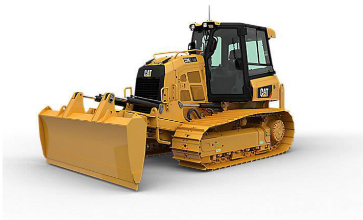
Slika 10.1.: Dozer CAT D3K2 [18]
