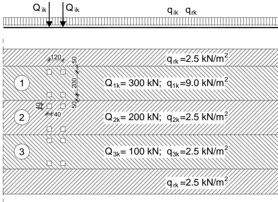
Slika 13. Prikaz načina opterećenja mosta pokretnim opterećenjem
