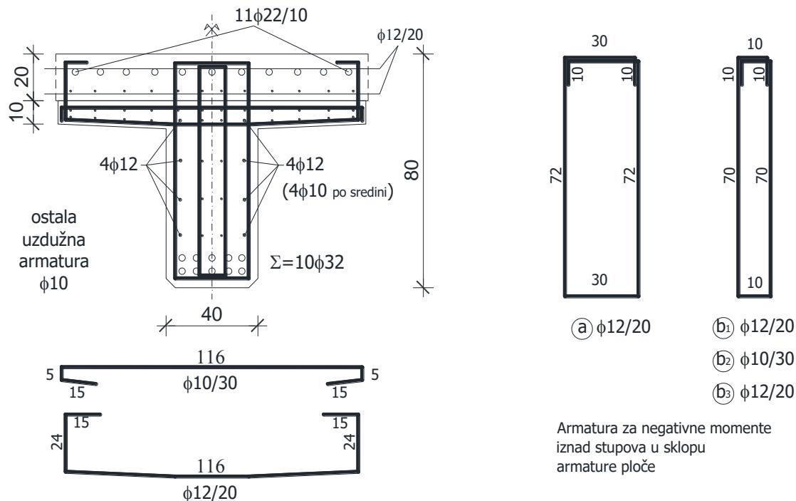
Slika 33. Prikaz armiranja nosača u presjeku a-a
