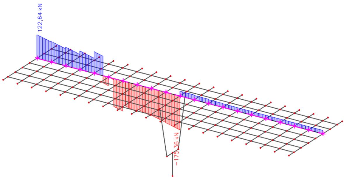
Slika 17. Pokretno - maksimalni moment u prvom polju – poprečne sile ( $Vz$ ) u  $\text{kN}$
