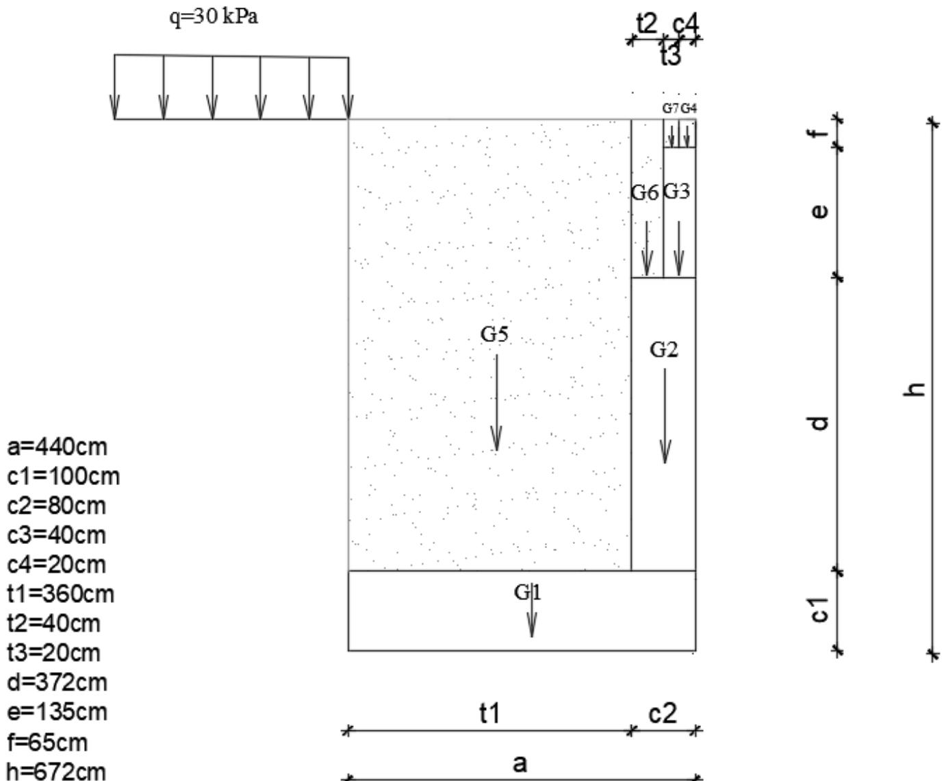
Slika 1. Karakteristični poprečni presjek potpornog zida
