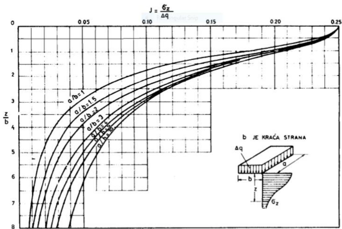
Slika 3. Steinbrenner-ov dijagram za proračun uspravnih dodatnih naprezanja
