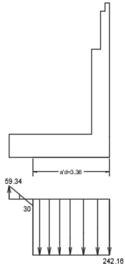
Slika 5. Raspodjela naprezanja tla ispod temeljne stope uzrokovanih statičkim opterećenjem
