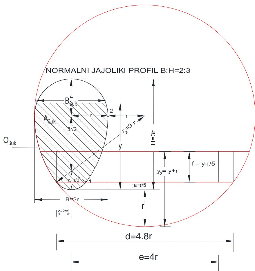
Slika 13. Traženi  $A, O$  i  $B$  zadanoj jajolikoj poprečnog presjeka
