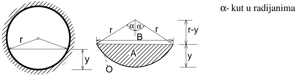
Slika 4. Poprečni presjek kanala i dubina y u kanalu
