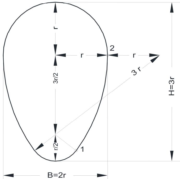
Slika 2. Jajoliki poprečni presjek kanala
