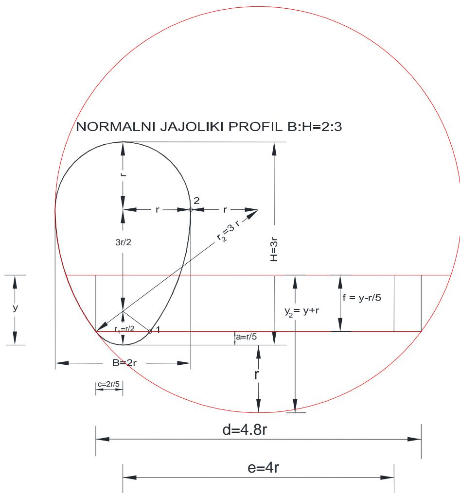
Slika 3. Jajoliki poprečni presjek unutar kružnice promjera  $3r$
