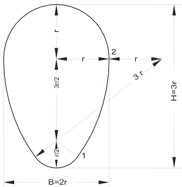
Slika 1. Normalni poprečni presjek kanala
