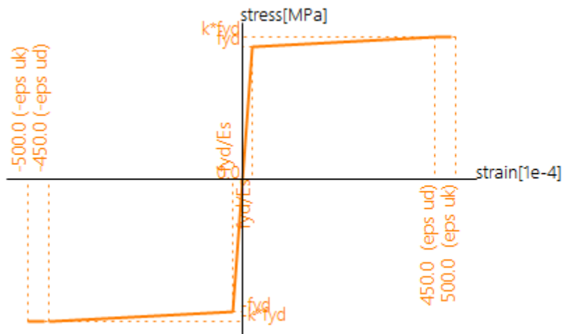
Slika 3.2: Radni dijagram čelika
