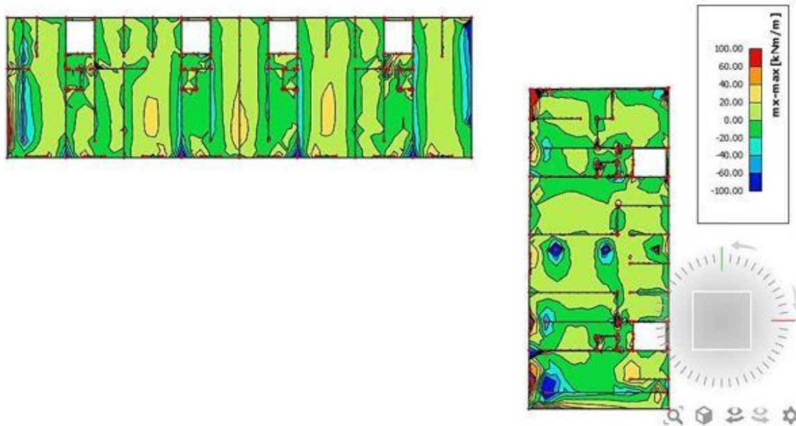
Slika 10.9. Prikaz momenata savijanja -m_x
