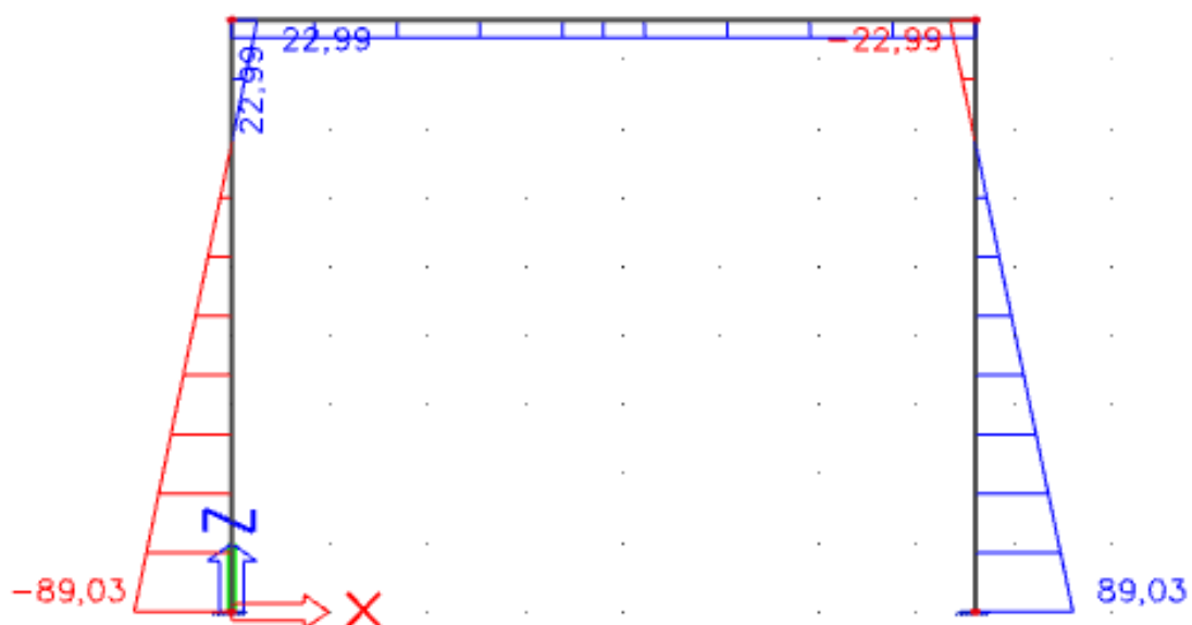
Slika 3.14. Moment savijanja od skupljanja betona (kNm)
