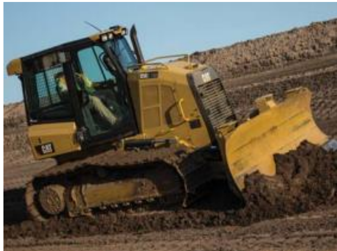
Slika 4.10. Buldozer Cat D5K2 [13]
