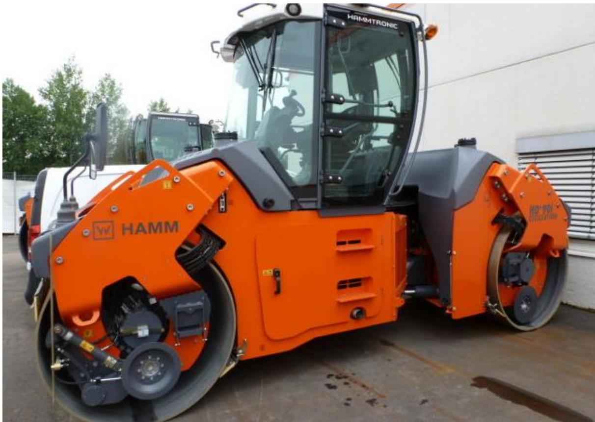
Slika 4.5. Valjak za asfalt HAMM HD+ 90i [9]
