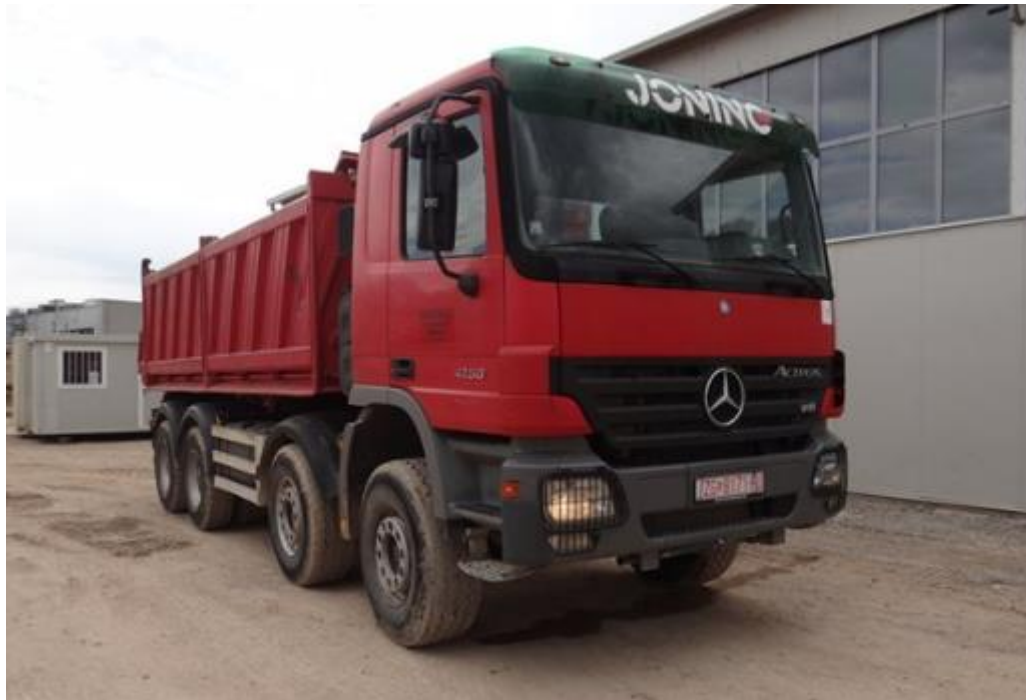
Slika 4.6. Kamion kiper Mercedes-Benz Actros 4150 [10]
