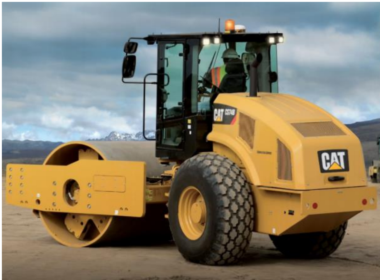
Slika 4.4. Vibro valjak Cat CP44B [8]
