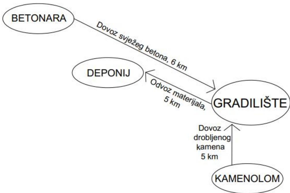
Slika 1.1. Udaljenost gradilišta u odnosu na kamenolom, betonaru i deponij
