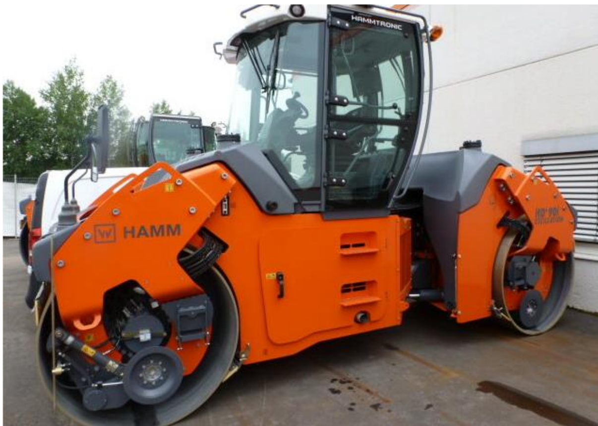
Slika 4.5. Valjak za asfalt HAMM HD+ 90i [9]
