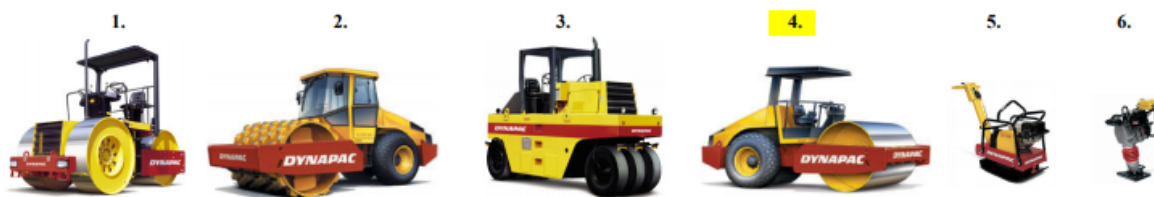
Slika 4.3. Izbor i primjena strojeva za zbijanje obzirom na vrstu materijala [7]
