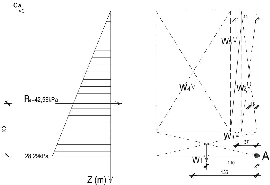
Težina zida podijeljenog na elemente ( $\gamma_{\text{bet}} = 25 \text{ kN/m}^3$ ):
