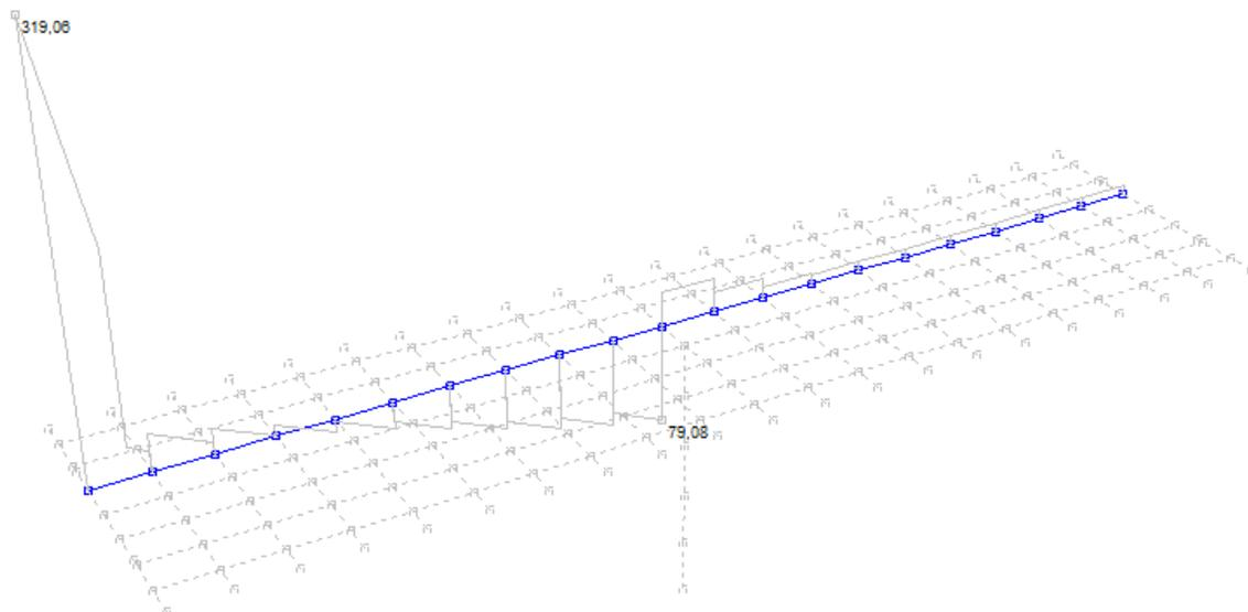
Slika 23: Pokretno opterećenje – maksimalne poprečne sile pri upornjaku – poprečne sile  $T_z$  (kN)
