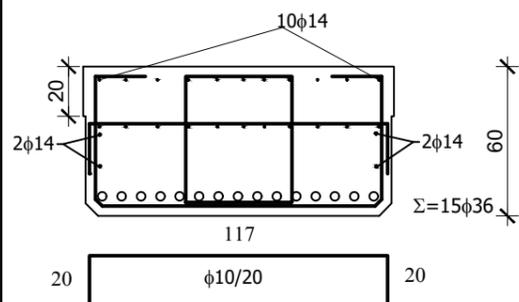
Poprečni presjek nosača(stup)
