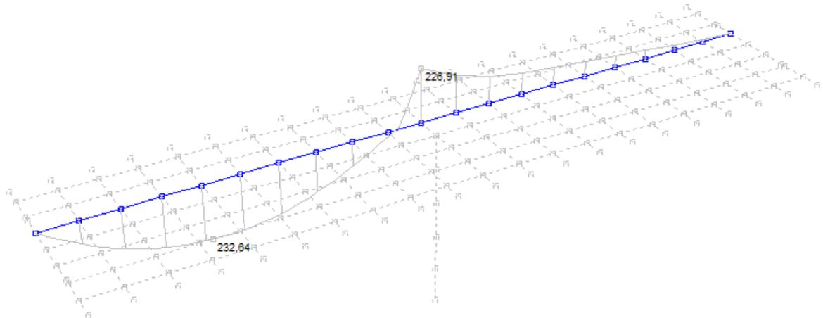
Slika 19: Pokretno opterećenje – maksimalne poprečne sile pri stupu – momenti  $M_y$  (kNm)
