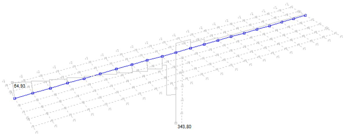
Slika 20: Pokretno opterećenje – maksimalne poprečne sile pri stupu – poprečne sile  $T_z$  (kN)
