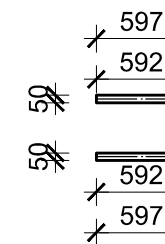
VERTIKALA (V3) 50X50X4, l=597mm, kom=2x11
