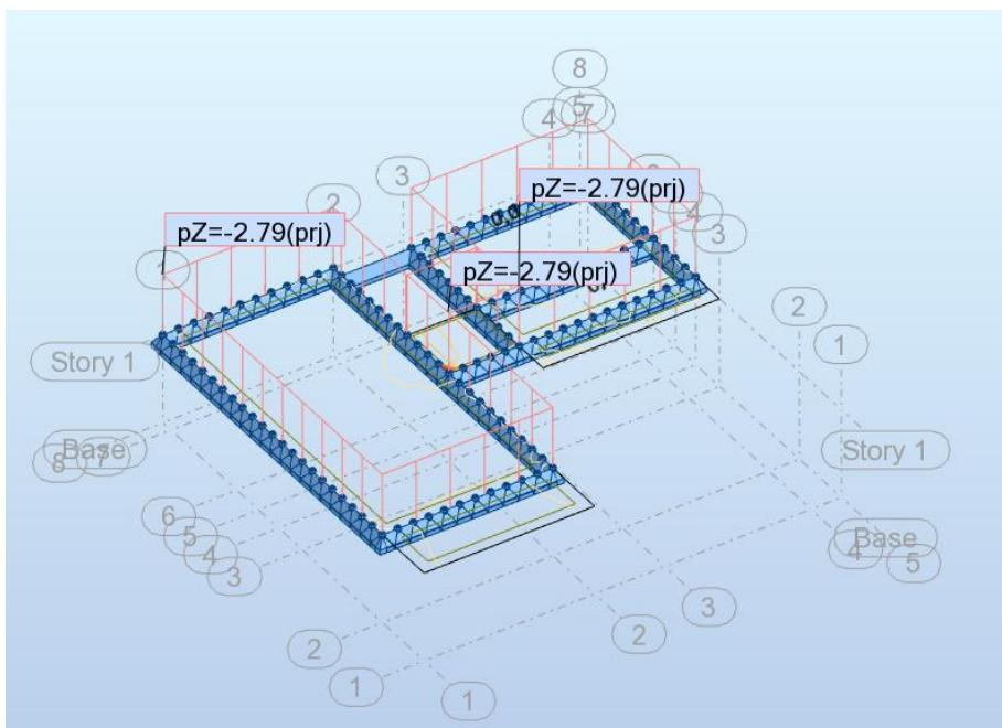
Slika 3.9. Prikaz dodatnog stalnog opterećenja pozicije 100 -zatvoreni dio
