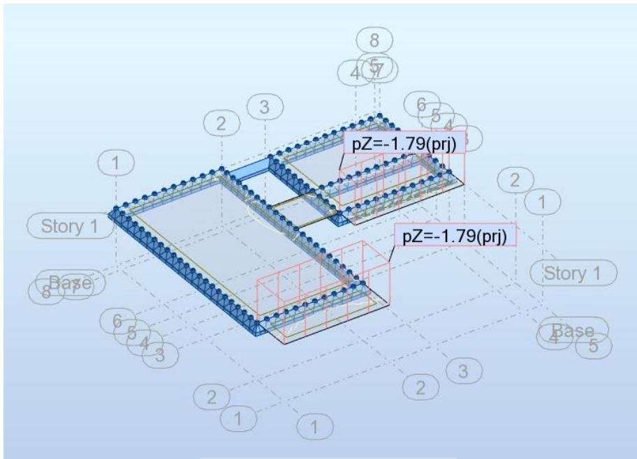
Slika 3.10. Prikaz dodatnog stalnog opterećenja pozicije 100 - balkoni
