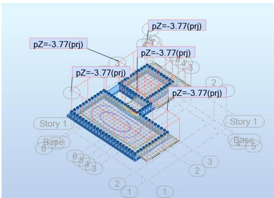
Slika 3.5. Prikaz dodatnog stalnog opterećenja pozicije 200
