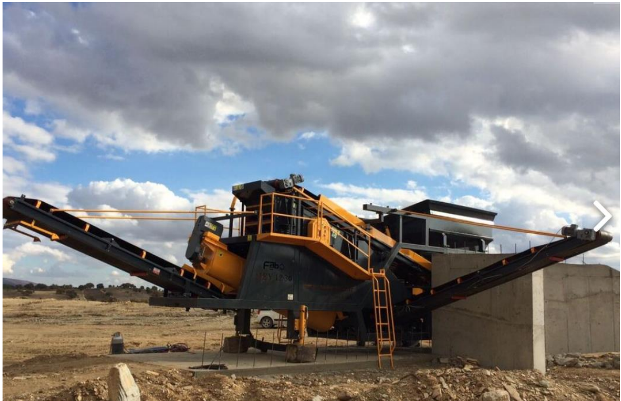
Slika 9. Čeljusna drobilica FABO MEY-1230 [11]
