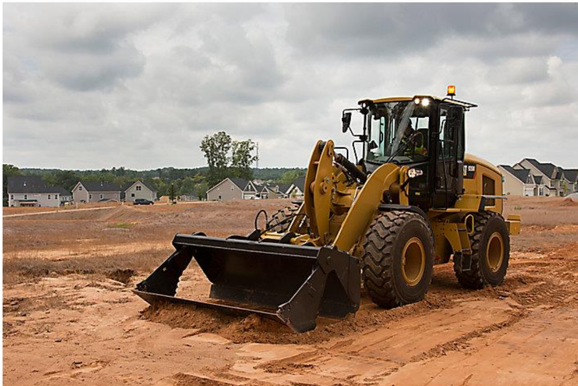
Slika 7. CAT 926M Wheel Loader [9]
