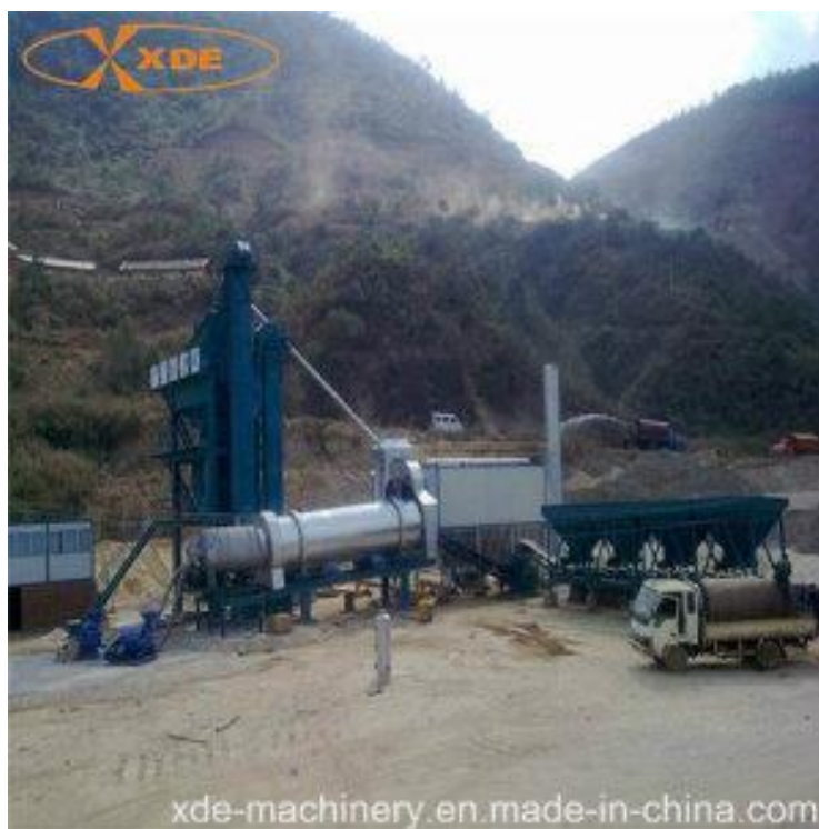
Slika 15. Postrojenje za proizvodnju asfalta LB 1000 [19]
