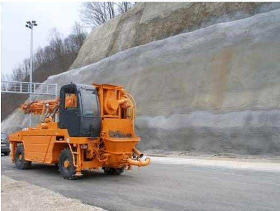
Slika 11. Stroj CIFA SPRITZ SYSTEM CSS-2 za torkretiranje
