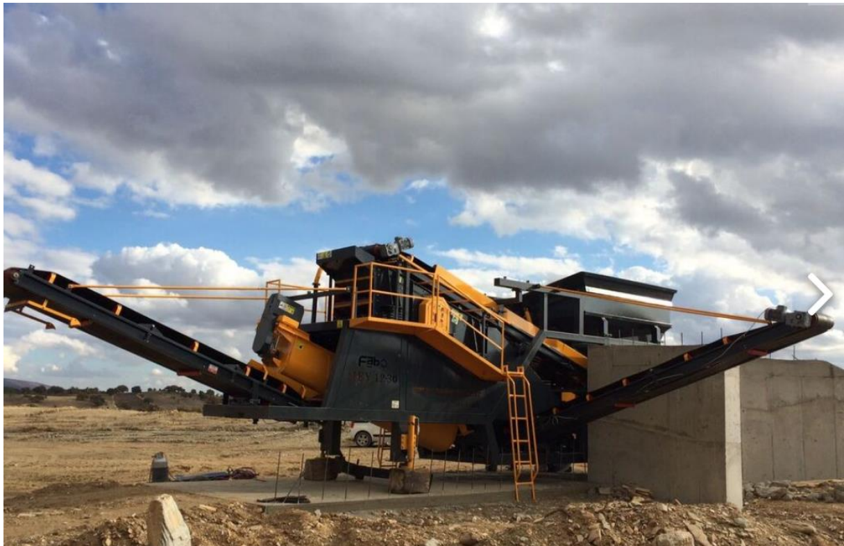
Slika 9. Čeljusna drobilica FABO MEY-1230 [11]
