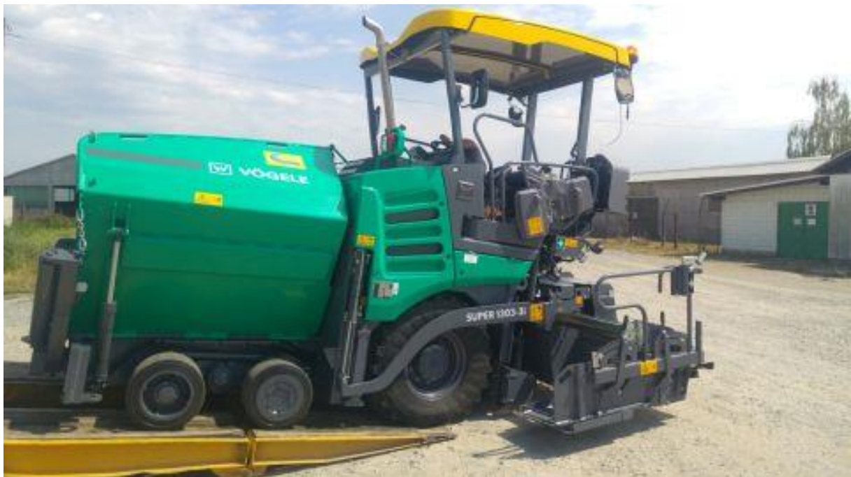
Slika 16. Finišer na gusjenicama VÖGELE SUPER 1303-3i [20]
