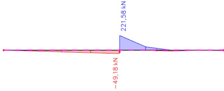
Slika 7.8. Poprečne sile  $T_z$  (kN)
