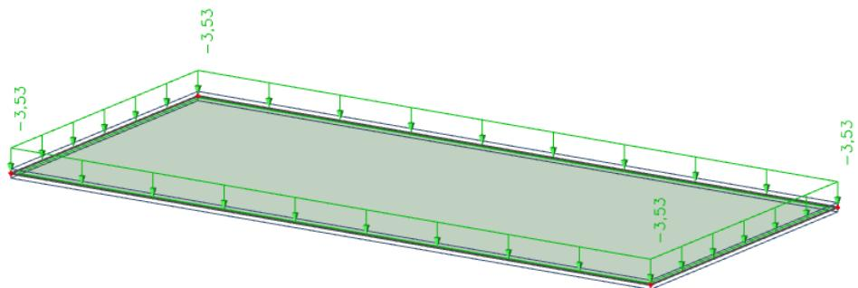
Slika3.1. Prikaz dodatnog stalnog opterećenja  $\Delta g_{200}$
