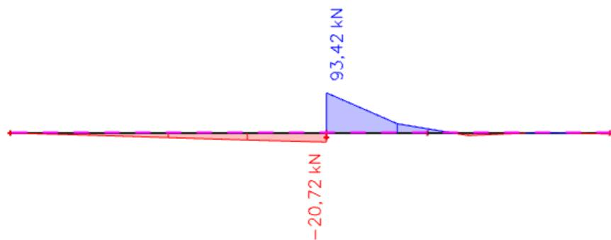
Slika 7.2. Poprečne sile  $T_z$  (kN)
