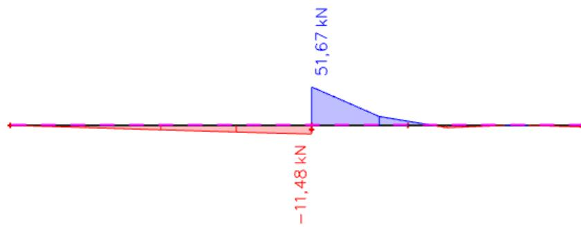
Slika 7.4. Poprečne sile  $T_z$  (kN)
