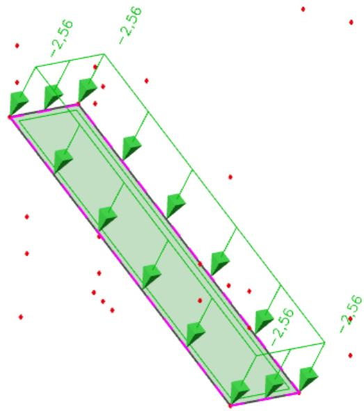
Slika 3.6 Prikaz dodatnog stalnog opterećenja  $\Delta g$
