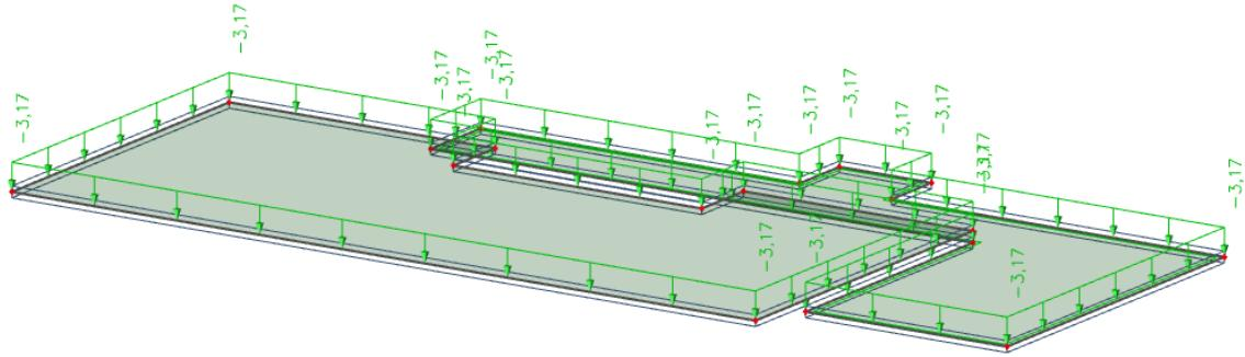
Slika 3.3 Prikaz dodatnog stalnog opterećenja  $\Delta g100$
