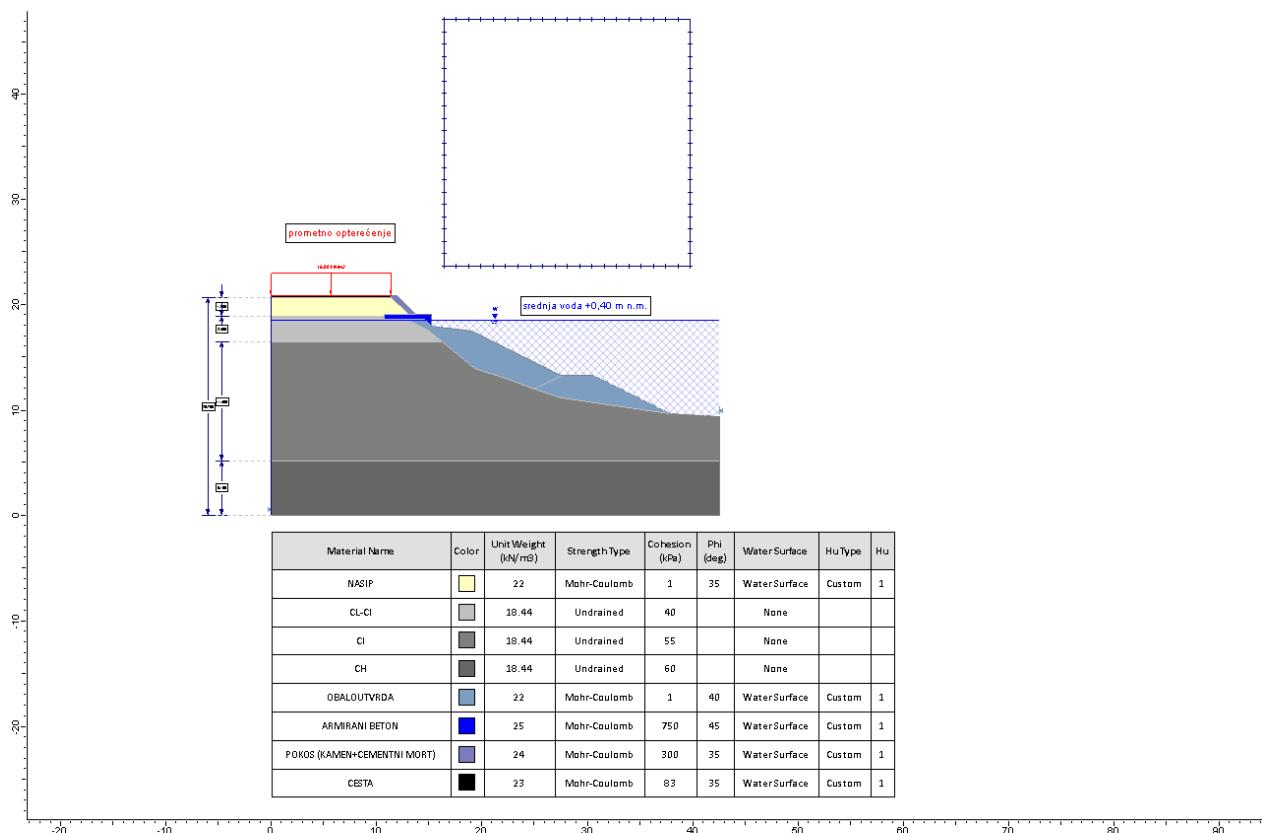
Slika 3.2. Opterećenje srednjom vodom na koti +0,40 m n.m.
