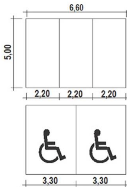
Slika 21 Prikaz dimenzija parkirališnih mjesta za osobe s invaliditetom u Grčkoj [12]
