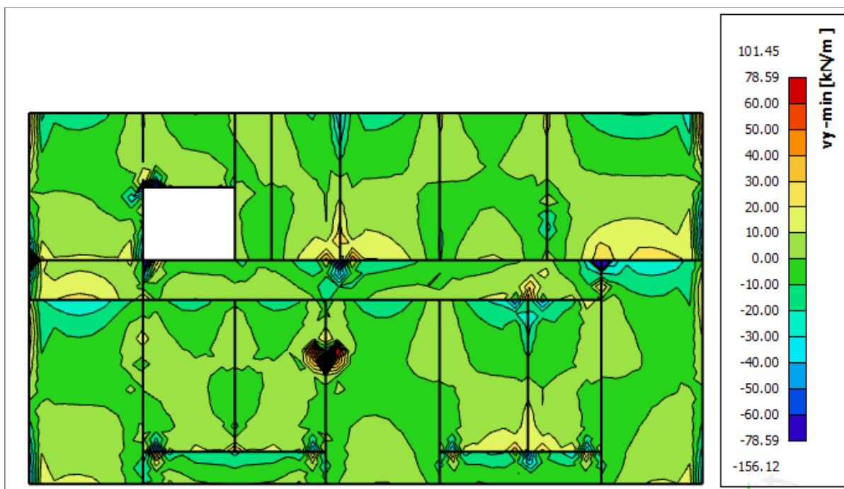
Slika 18. Poprečne sile V_{Ed,y} (kN/m) za GSN
