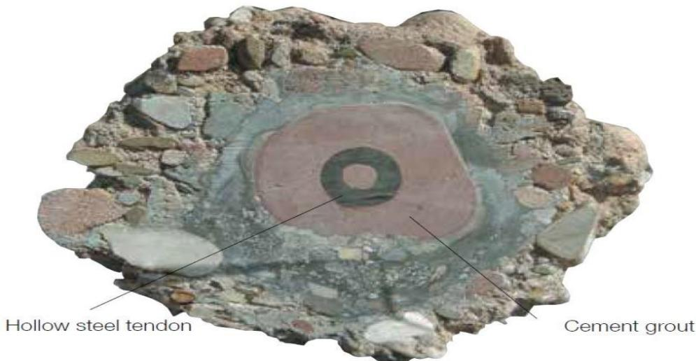
*Slika 12. Presjek samobušivog injektiranog sidra*
