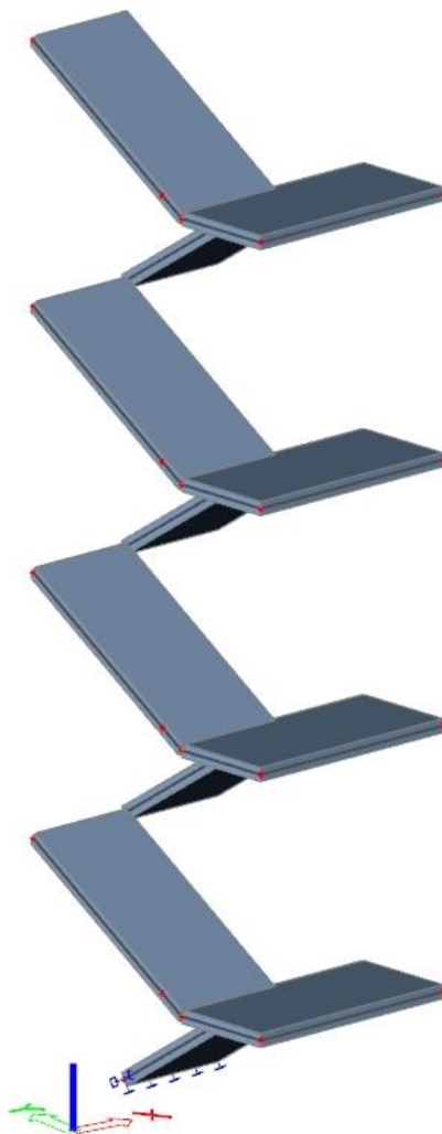
Slika 6.1. Prikaz statičkog sustava kraka stubišta
