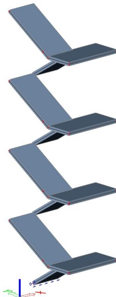
Slika 6.1. Prikaz statičkog sustava kraka stubišta
