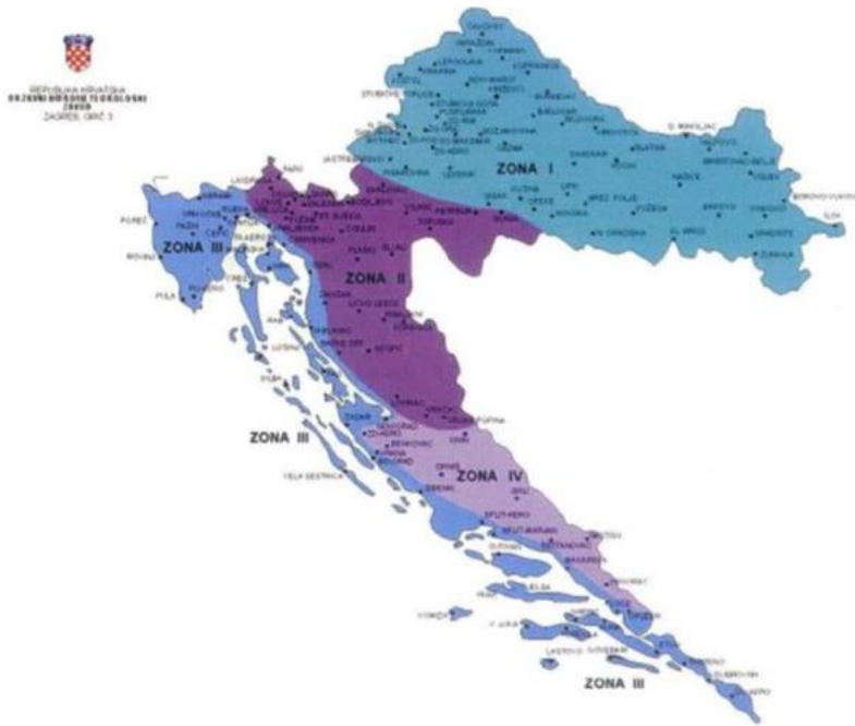
Slika 3.4. Klimatske zone karakterističnog opterećenja snijegom s_k (kN/m 2 )
