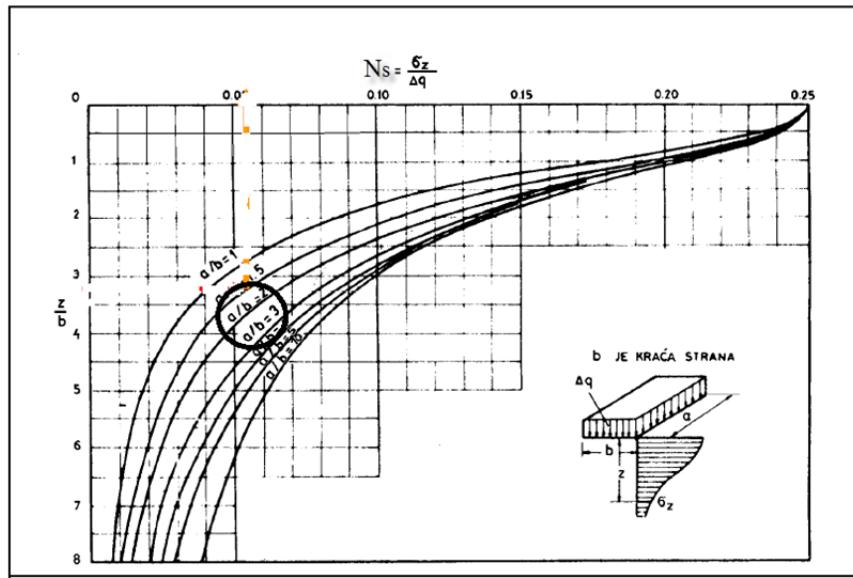
Slika 19. Steinbrenner-ov dijagram za proračun uspravnih dodatnih naprezanja
