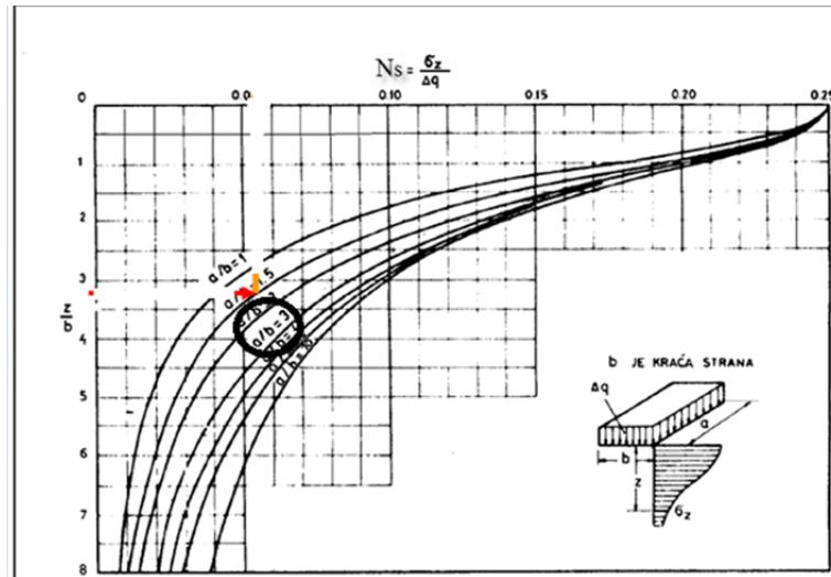
Slika 13. Steinbrenner-ov dijagram za proračun uspravnih dodatnih naprezanja
