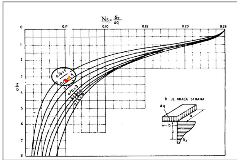
Slika 26. Steinbrenner-ov dijagram za proračun uspravnih dodatnih naprezanja
