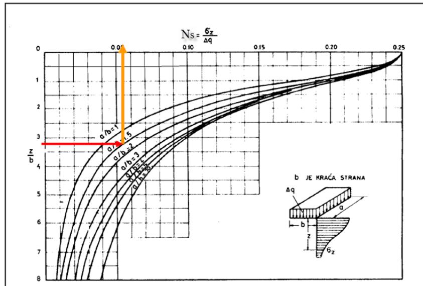
Slika 23. Steinbrenner-ov dijagram za proračun uspravnih dodatnih naprezanja
