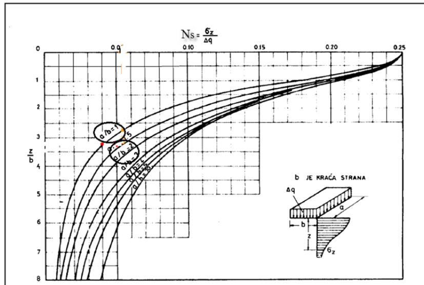
Slika 16. Steinbrenner-ov dijagram za proračun uspravnih dodatnih naprezanja
