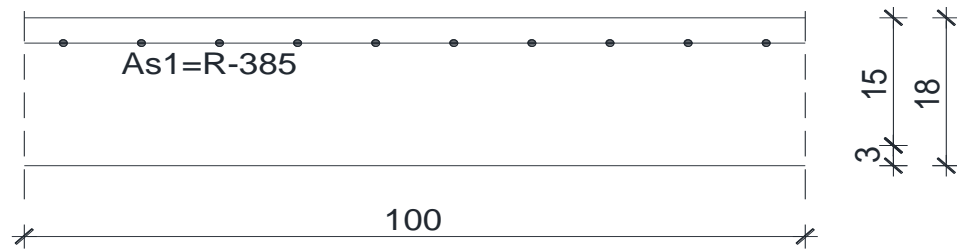
Slika 10.30 Skica armature ploče na ležaju
