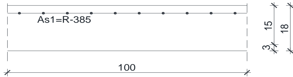
Slika 10.30 Skica armature ploče na ležaju
