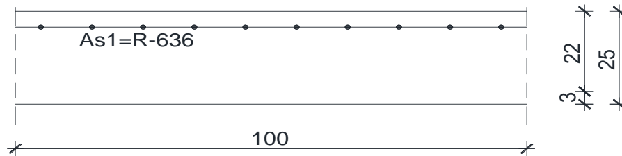
Slika 10.7 Skica armature ploče na ležaju
