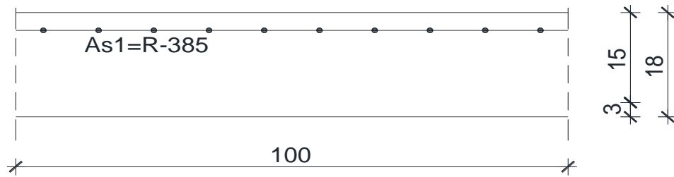
Slika 10.30 Skica armature ploče na ležaju
