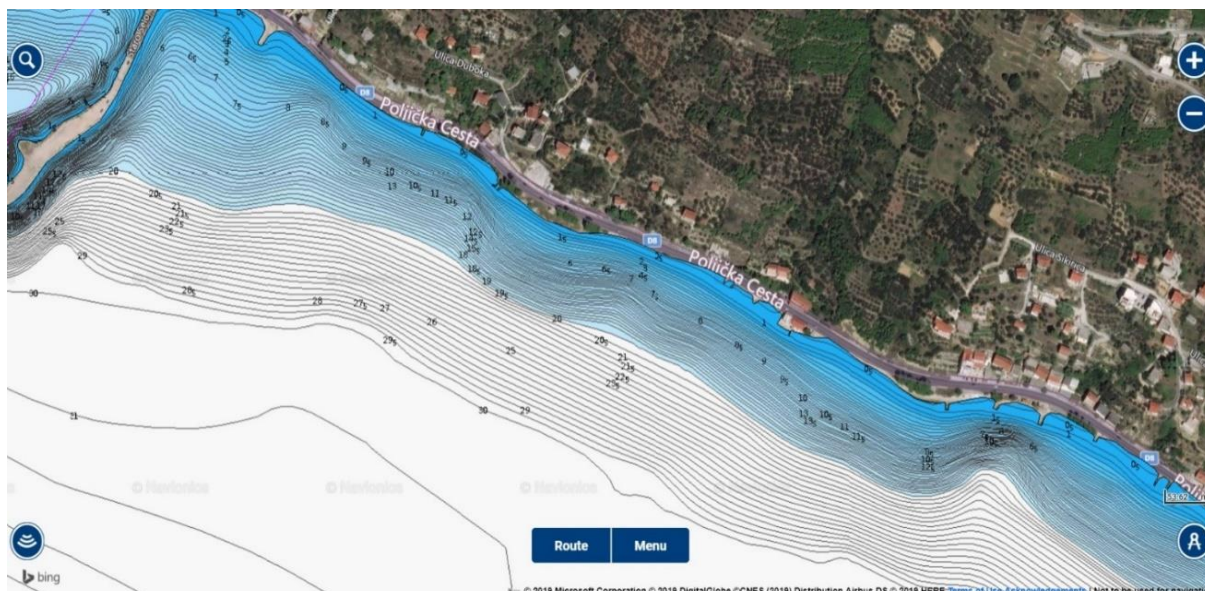
Slika 10. Batimetrija područja lukobrana [9]
