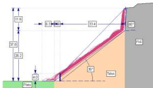
(f) Trajektorije blokova sa barijerom h=4 m.
