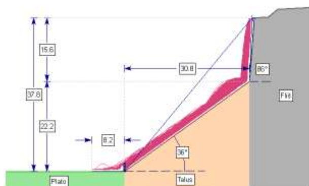
(d) Trajektorije blokova sa barijerom h=2 m.
