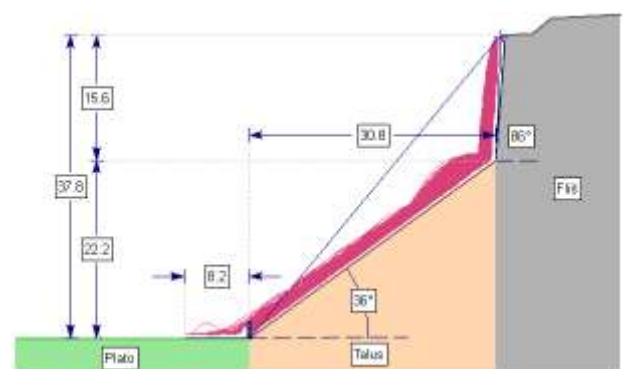
(d) Trajektorije blokova sa barijerom h=2 m.
