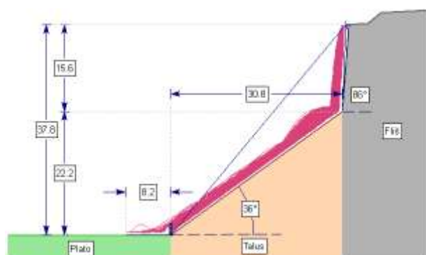
(d) Trajektorije blokova sa barijerom h=2 m.
