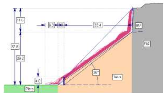
(f) Trajektorije blokova sa barijerom h=4 m.
