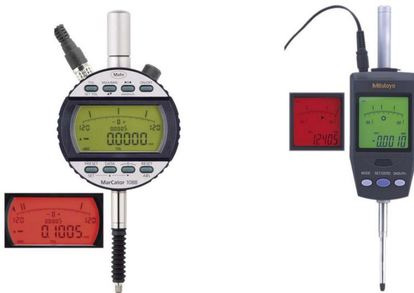
Fotografija 4.11: Elektronske mikroure točnosti 1/10000 mm
