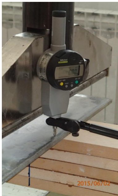
Fotografija 4.8: Postavljanje mehaničke mikroure s digitalnim očitanjem
