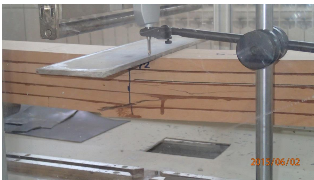
Fotografija 4.16: Slom i kraj ispitivanja grede G-2
