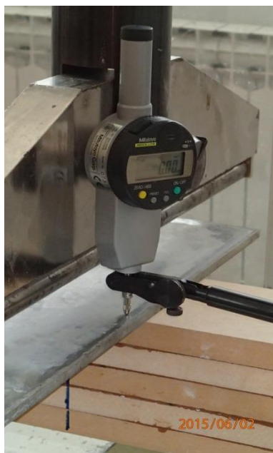
Fotografija 4.8: Postavljanje mehaničke mikroure s digitalnim očitanjem
