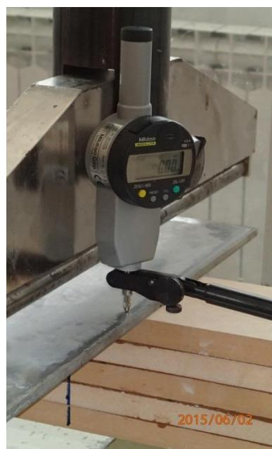
**Fotografija 4.8:** Postavljanje mehaničke mikroure s digitalnim očitanjem
