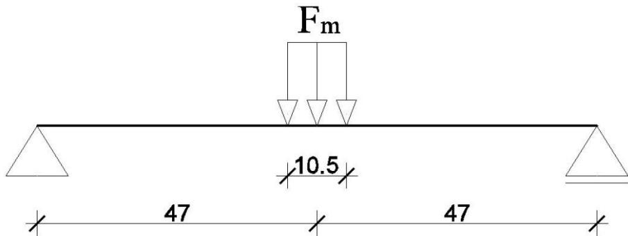
**Crtež 2.5:** Opterećenje modela za izračun mjerila sila
