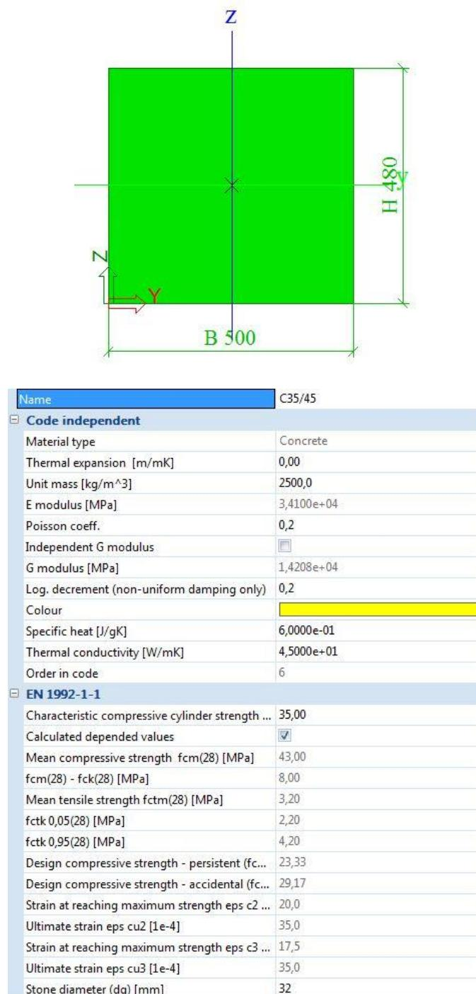
Slika 3.2: Materijalne i geometrijske karakteristike prototipa
