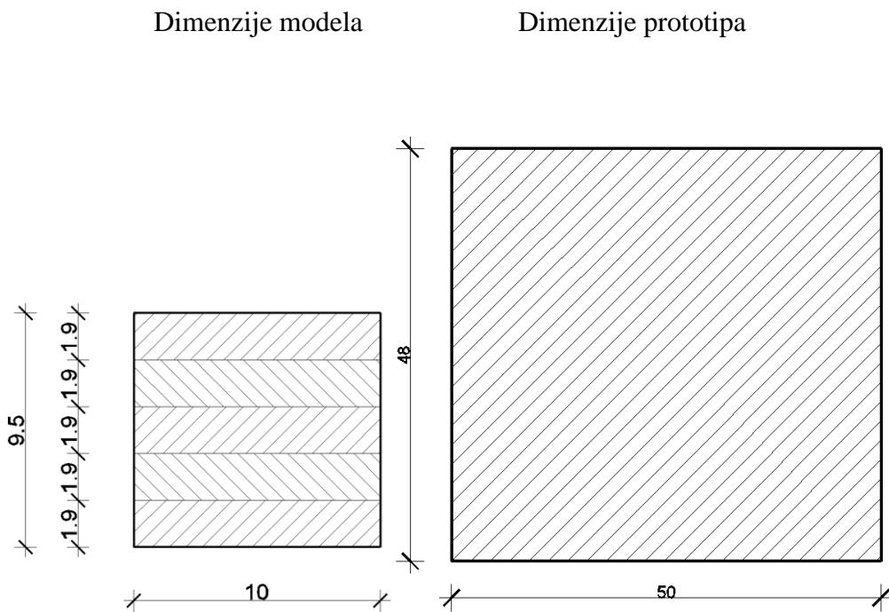
**Crtež 2.1:** Prikaz dimenziya poprečnog presjeka modela i prototipa
