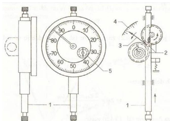
**Fotografija 4.9:** Dijelovi mehaničke mikroure s analognim očitanjem
