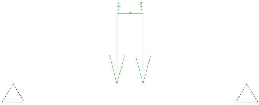
**Slika 3.3:** Opterećenje modela raspodijeljenim opterećenjem od  $q_m= 19,04 \text{ kN/m'}$
