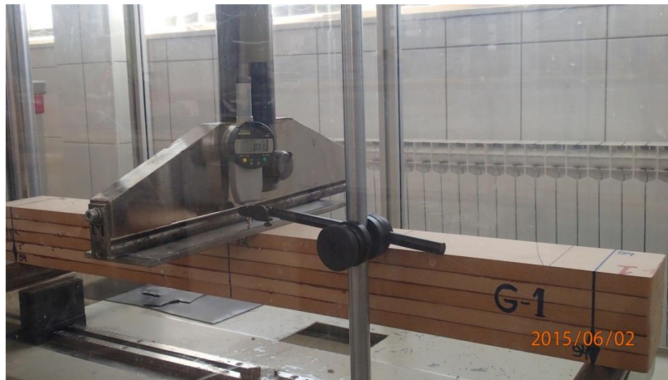
Fotografija 4.12: Početak opterećenja grede G-1
