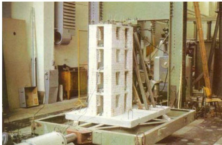
**Fotografija 1.2:** Dinamičko ispitivanje modela zgrade na potresnoj platformi
