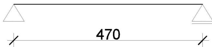
**Crtež 2.3:** Prikaz statičkog sustava i dimenziye prototipa
