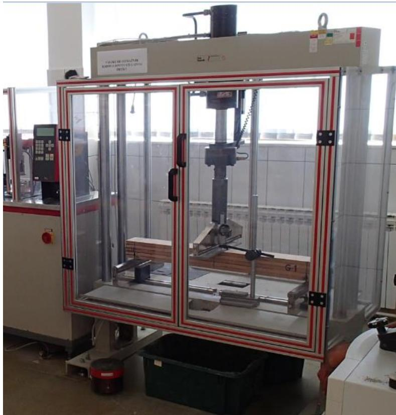
**Fotografija 4.5:** Izgled uređaja za ispitivanje proizvođača Zwick/Roell
