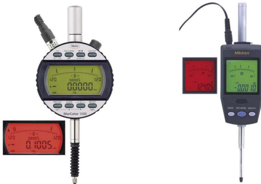
Fotografija 4.11: Elektronske mikroure točnosti 1/10000 mm
