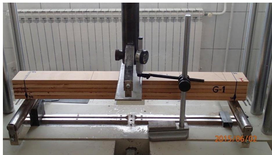
**Fotografija 4.4:** Postavljanje grede i mikroure
