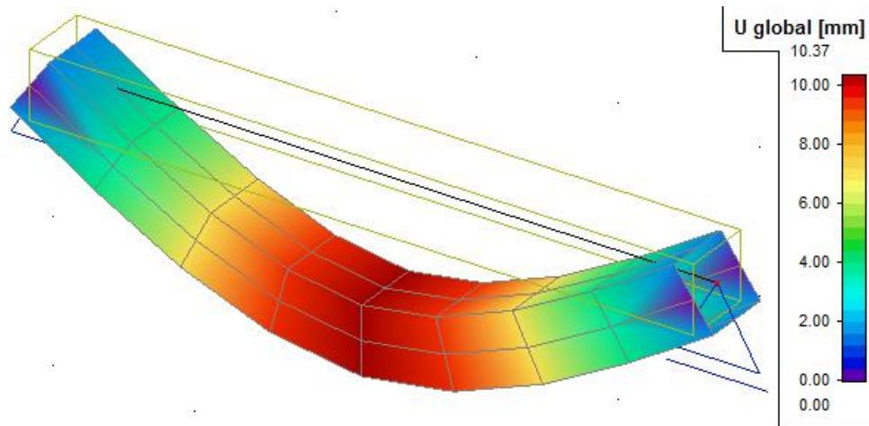
**Slika 3.7:** Prikaz progiba prototipa pri opterećenju od  $F_p = 714,28 \text{ kN}$
