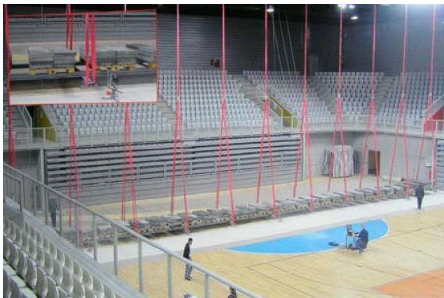
**Fotografija 1.1:** Statičko ispitivanje rešetkaste konstrukcije sportske dvorane
