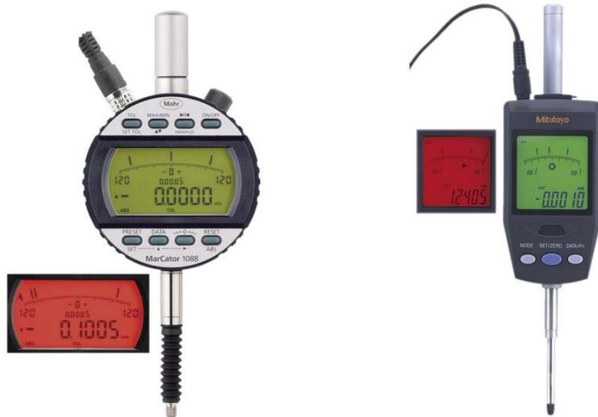
**Fotografija 4.11:** Elektronske mikroure točnosti 1/10000 mm
