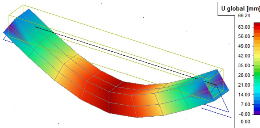
**Slika 3.8:** Prikaz progiba prototipa pri opterećenju od  $F_p = 4657,14 \text{ kN}$
