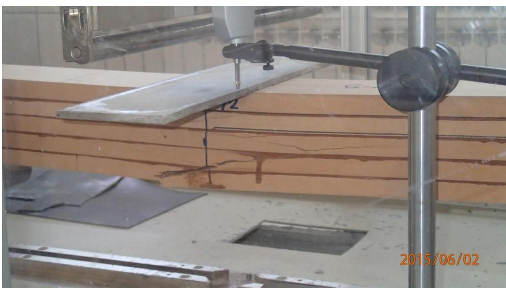
**Fotografija 4.16:** Slom i kraj ispitivanja grede G-2
