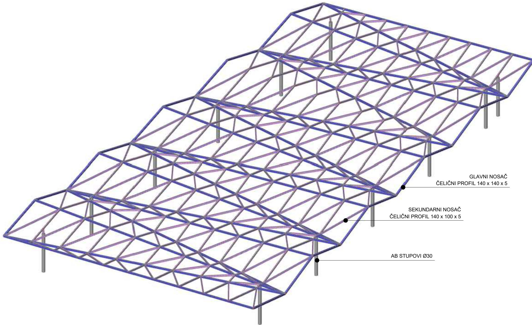
Model konstrukcije izrađen je programu je SCIA Engineer 2019. Na modelu su vidljivi glavni nosači - čelični profili  $140 \times 140 \times 5$  - plavo, koji formiraju trokute. Sekundarni nosači  $140 \times 100 \times 5$  - ružičasto, postavljeni su unutar tih trokuta kako bi dodatno ukrutili čeličnu konstrukciju te napravili preraspodjelu opterećenja duž nosača. Krovna konstrukcija oslanja se na spoju tri glavna nosača na armirano-betonske stupove  $\varnothing 30$  - sivo.
