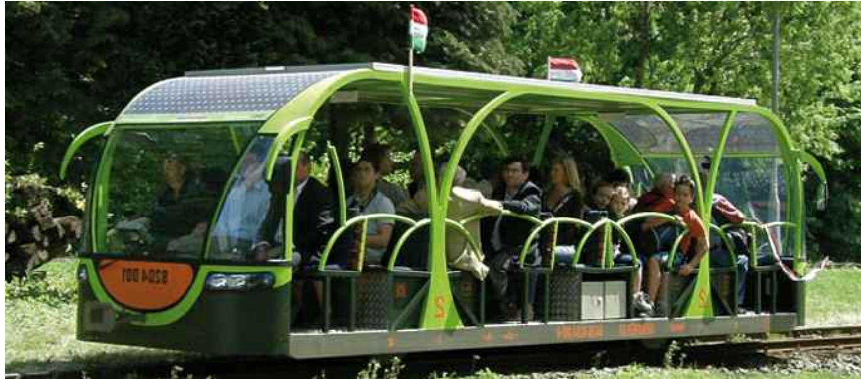
Vili - lokomotiva u Mađarskoj na solarnu energiju
