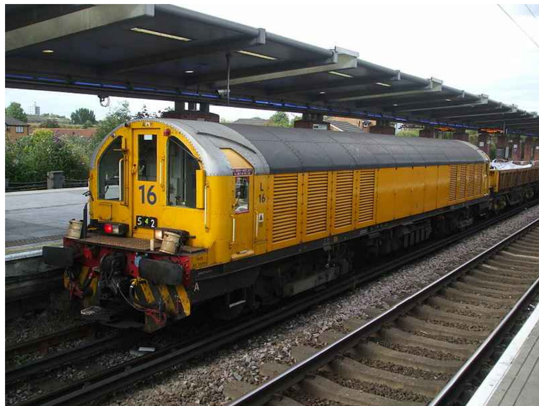
lokomotiva na baterije, služi za popravke na London Undergroundu
