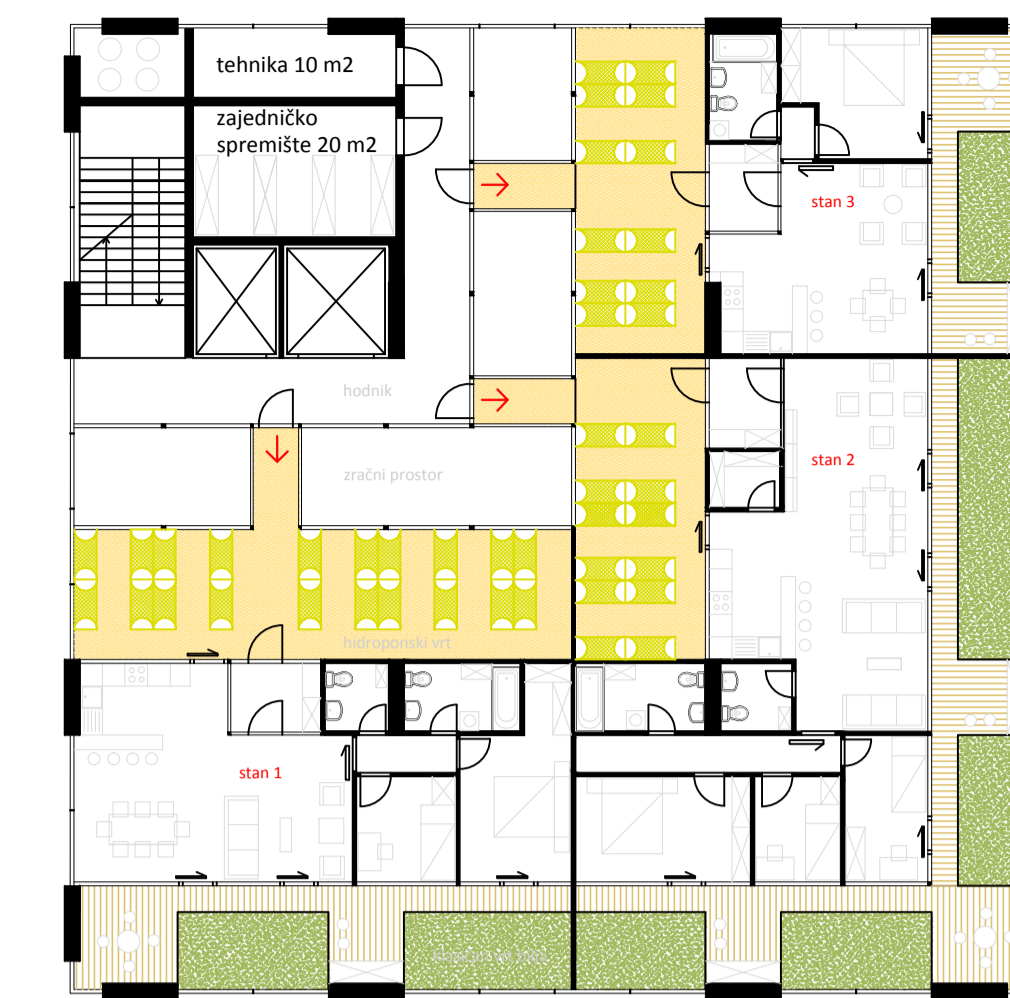
tlocrt karakteristične etaže / stanovanje + hidroponski vrt
