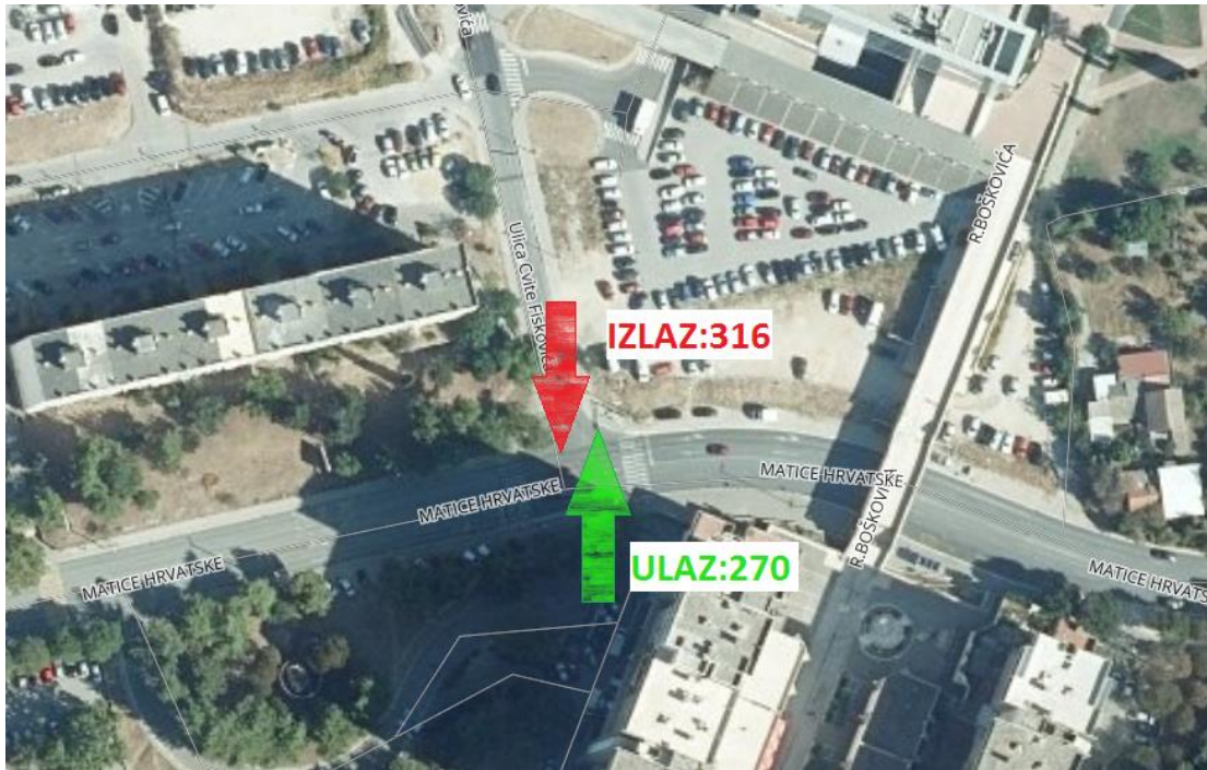
Slika 26. Ukupan broj vozila u vršnom satu na ulazu s ulice Matice hrvatske
